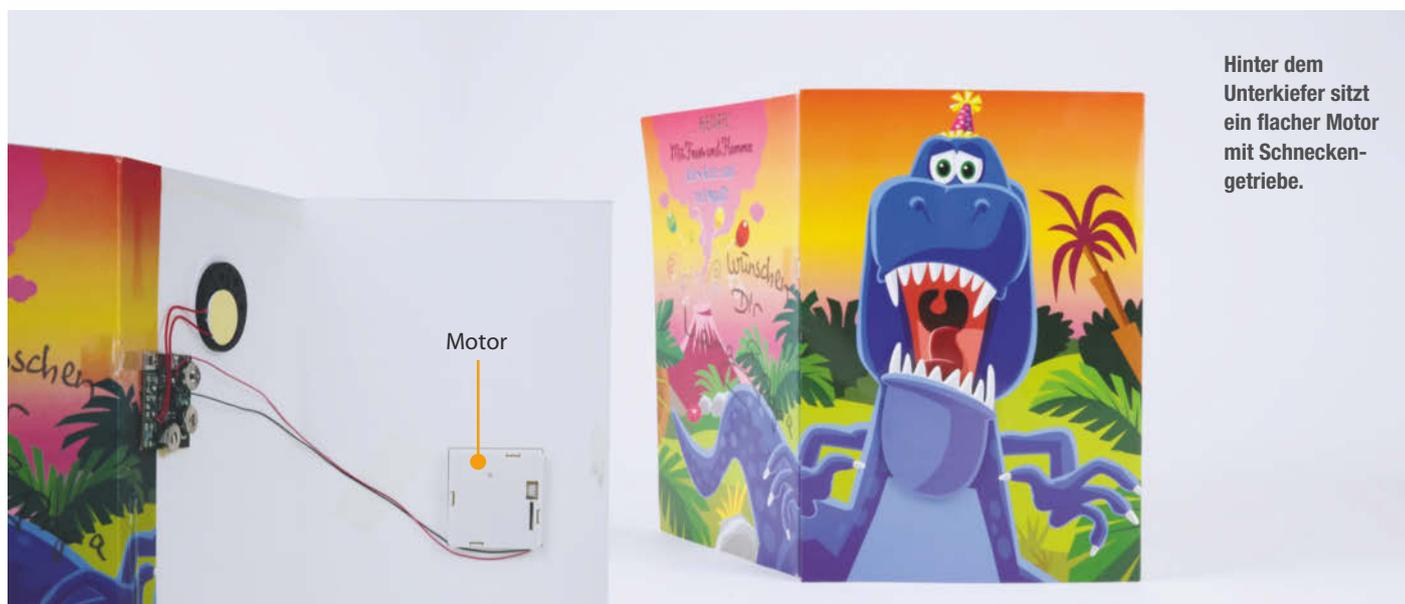
Hinter dem Unterkiefer sitzt ein flacher Motor mit Schneckengetriebe.
