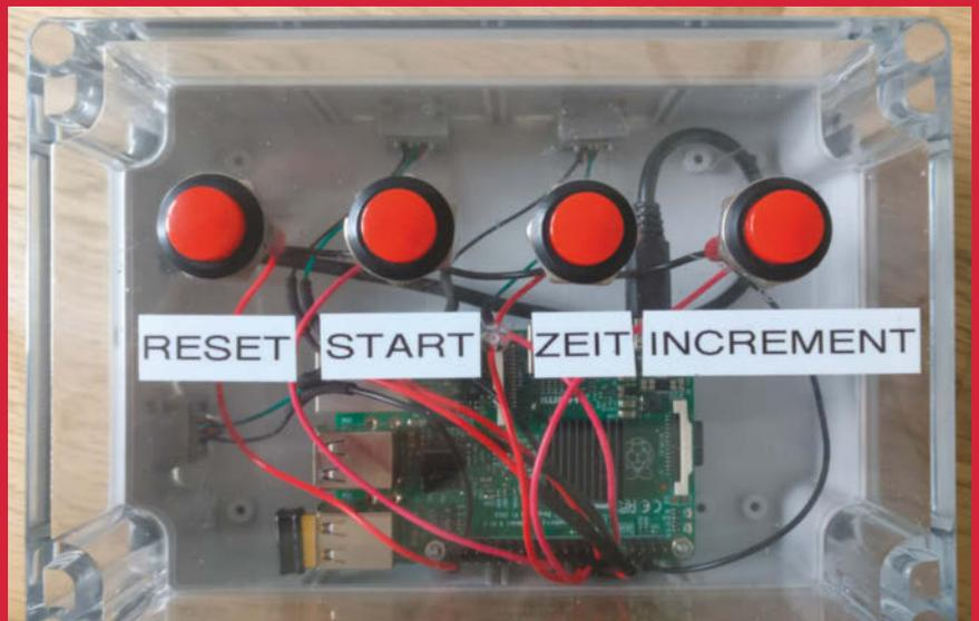
Der Raspberry Pi und die Taster zum Stellen der Uhr sind in einem großen Gehäuse untergebracht.
