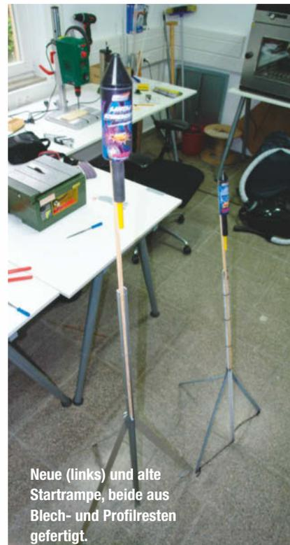
Neue (links) und alte Startrampe, beide aus Blech- und Profilresten gefertigt.
