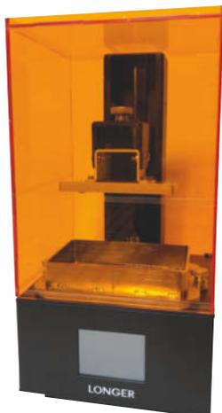
Die verwendeten Matrix-LEDs verursachen zwar ein leichtes Verwaschen der Ränder des projizierten Bildes, aber der kurze Abstand zwischen LED und Harz sowie die diffuse Belichtung härten das Material sehr schnell aus und verhindern Einschlüsse flüssigen Harzes zwischen belichteten Pixeln. Im Test gelang jeder Druck mit dieser Maschine, das ist auch bei Resin-3D-Druckern keine Selbstverständlichkeit.
