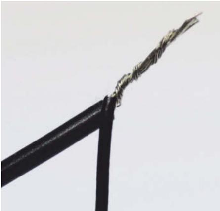
Verzwirbeln ist eine einfache Art, Kabel zu verbinden.
