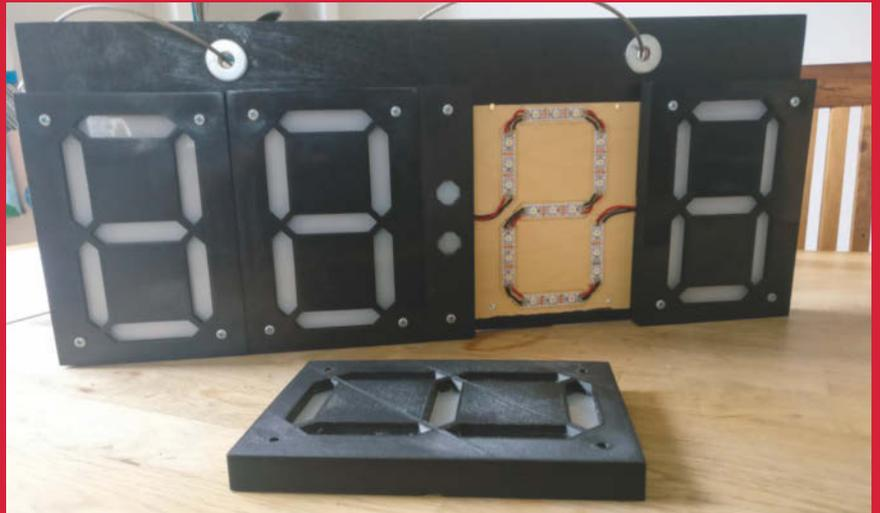
Die 3D-gedruckten Module der 7-Segment-Anzeige werden auf Sperrholzplatten geschraubt.
