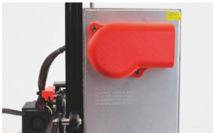
Die selbstgedruckte Lüfterabdeckung des Netzteils lenkt die Schallabstrahlung nach hinten.
