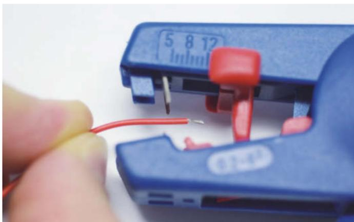
Zum Freilegen der Kabel kann man eine Abisolierzange ...
