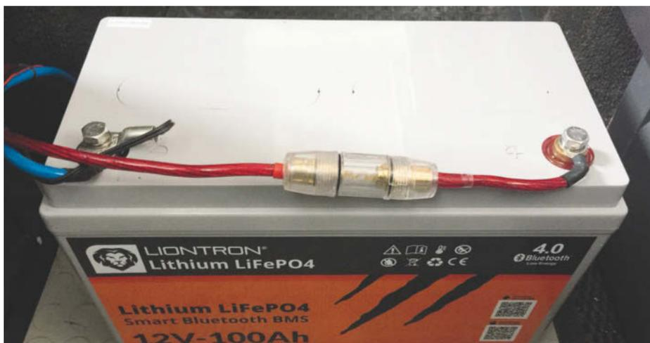
Wichtig bei der Verwendung eines derart leistungsstarken Akkus ist eine Verwendung dicker Kabel und eine Absicherung möglichst dicht am Pluspol. Gut zu erkennen auch der Temperatursensor am Minus-Pol zur Optimierung der Ladekennlinie des Solar-Ladereglers.
