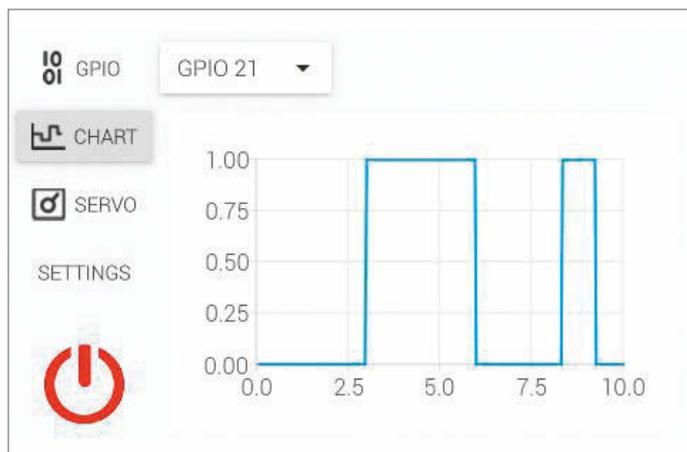
31 Die Anzeige ist um ein kleines Diagramm mit Pin-Zuständen ergänzt.
