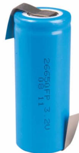
Verwechslungsgefahr: LiFePO4-Zellen, hier in Bauform 26650, unterscheiden sich kaum von gängigen Li-Ion-Akkus.
