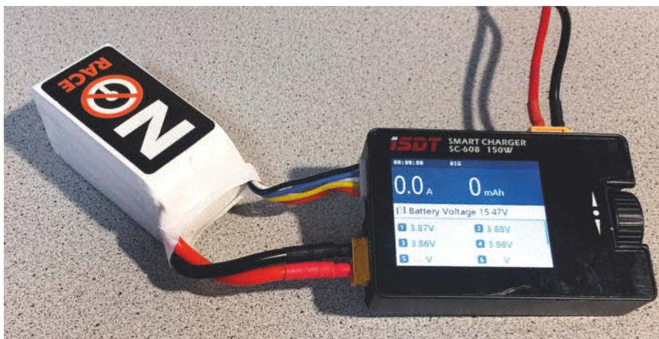
Das Ladegerät muss aufgrund der geringeren Zellspannung unbedingt ein spezielles Programm zum Laden von LiFePO4-Akkus aufweisen. Die dünneren Kabel zum Akku führen zum Balancer-Anschluss des Ladegerätes.
