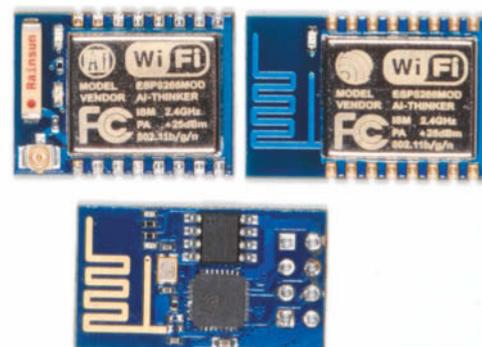
**1** Genau genommen steht die Bezeichnung ESP8266 nur für den Chip. Im Kombination mit weiterer Hardware und anderen ICs werden dann Module draus, etwa das ESP-12.
