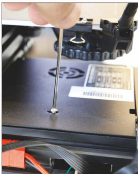
**5** Zum Öffnen des Elektronikfachs müssen drei Schrauben entfernt werden. Die dritte ist nur erreichbar, wenn der Drucktisch ganz vorn steht.
