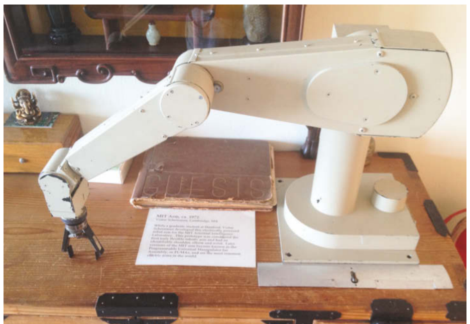
Vorläufer des weit verbreiteten PUMA-Roboters (Programmable Universal Machine for Assembly) war der MIT-Arm, den Victor Scheinman 1972 vorstellte.
