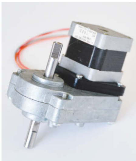
Schrittmotor-Gelenkantrieb eines älteren SCARA-Roboters. Durch die niedrige Drehzahl des Schrittmotors genügt eine mäßig hohe Untersetzung, hier realisiert durch ein präzises Stirnradgetriebe.
