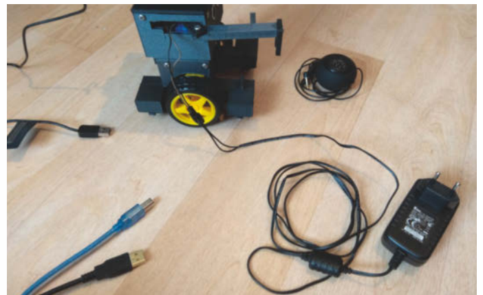
9 Die Stromversorgung des Motor-Treibers erfolgt über ein 12V-Netzteil anstelle einer 9V-Batterie.
