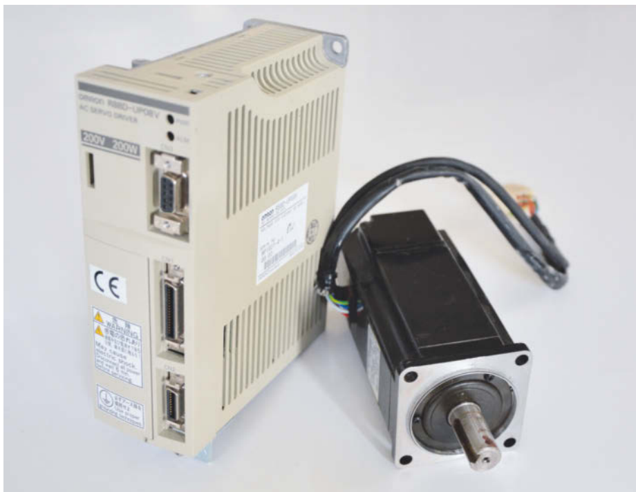
Servomotor mit Regeleinheit für kleinere Industrieroboter. Für den Bahn-Controller, der die Bewegungen koordiniert, verhält sich die Servo-Steuerung ähnlich wie ein Schrittmotor, angesteuert mit Schritt- und Richtungsimpulsen.
