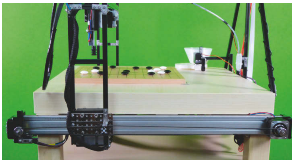
Die Mechanik der Z-Achse links und rechts vom Tisch basiert auf kugelgelagerten Schlitten und wird durch einen Zahnriemen per Schrittmotor angetrieben.
