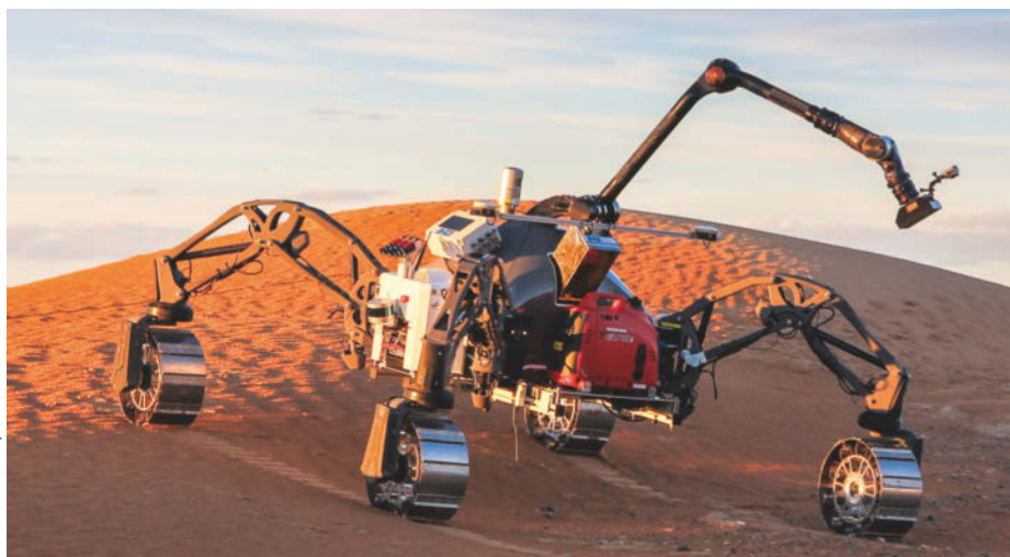
1 Der SherpaTT des DFKI ist ein hybrider Schreit-Fahrrover mit einem aktiven Fahrwerk für hohe Geländegängigkeit. Mit seinem erheblich kleineren Partner Coyote III (siehe Seite 16) bildet er ein Team.
