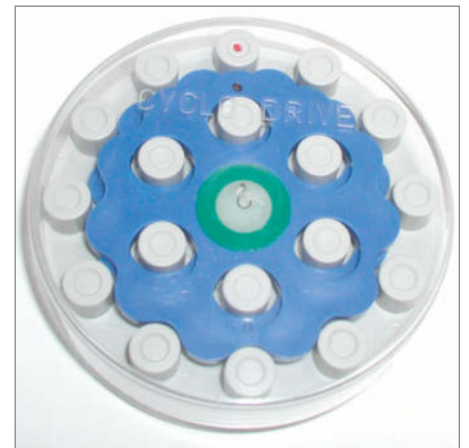
Zykloidgetriebe (hier ein Modell) erreichen ihre hohe Untersetzung (bis 200:1) über den von einer Exzentrerscheibe bewegten Rotor-Ring.
