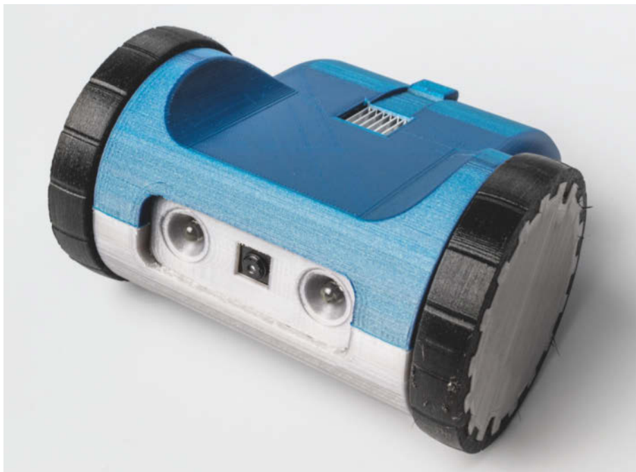
7 Der ZeroBot Pro ist als rollende Webcam mit LED-Scheinwerfern sicher schon praktisch, um den Hamster unterm Sofa hervorzuscheuchen – der Raspi Zero W in seinem Inneren schreit allerdings geradezu nach Erweiterungen und etwas Autonomie.
