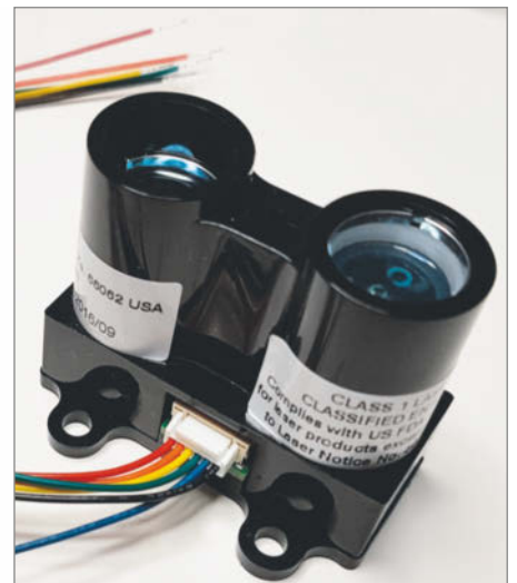
Ein klassischer LIDAR zur Entfernungsmessung. Eine Optik dient dem Senden, die andere dem Empfang des Laserstrahls.
