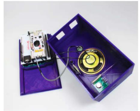
16 So passen die Einzelteile ins 3D-Druck-Gehäuse.
