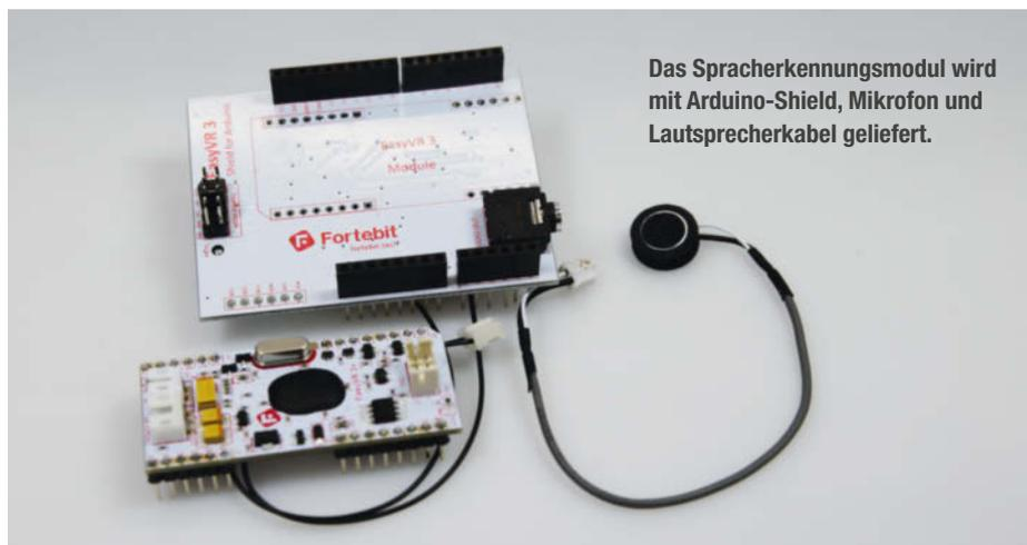
Das Spracherkennungsmodul wird mit Arduino-Shield, Mikrofon und Lautsprecherkabel geliefert.
