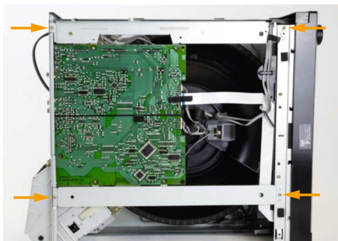
**3** Beim Ausbau der Platine nur diese vier Schrauben lösen.
