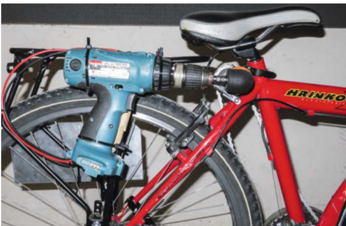
10 Erste Montage des Akkuschraubers an der rechten Seite des Lastenträgers
