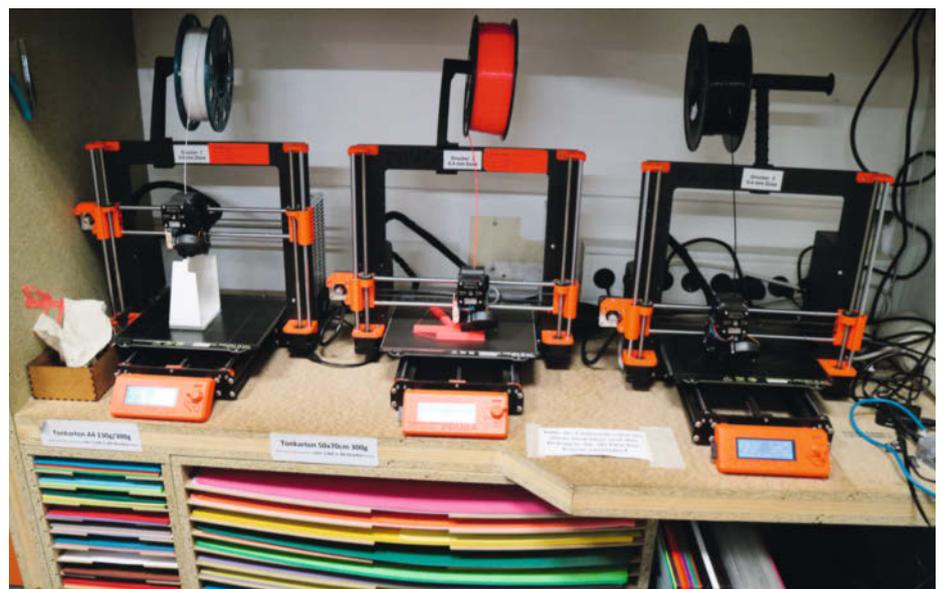
**!** Im Freiburger Makerspace *FREILab* stehen mehrere 3D-Drucker des Typs Prusa i3 MK3S, die für verschiedene Einsatzzwecke mit Düsen unterschiedlicher Durchmesser bestückt sind.
