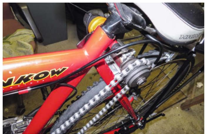
**7** BMX-Freilaufnabe montiert am zusätzlichen Tretlager
