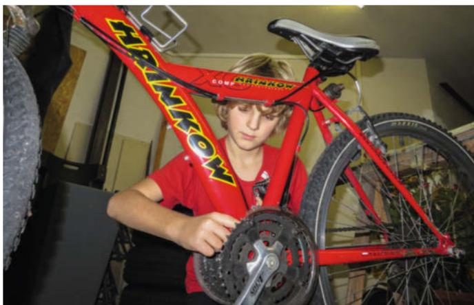
2 Einbau des zweiten Kettenblatts am Tretlager
