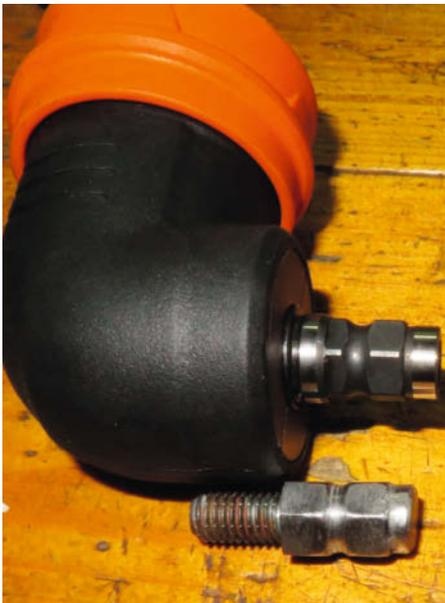
9 Selbst gefeilter Adapter für das Winkelgetriebe
