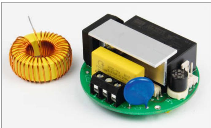
So sollte unsere Platine nach der Bestückung auf der Bauteilseite aussehen. Der Kühlkörper für Q1 ist ein kurzes Stück Aluprofil.
