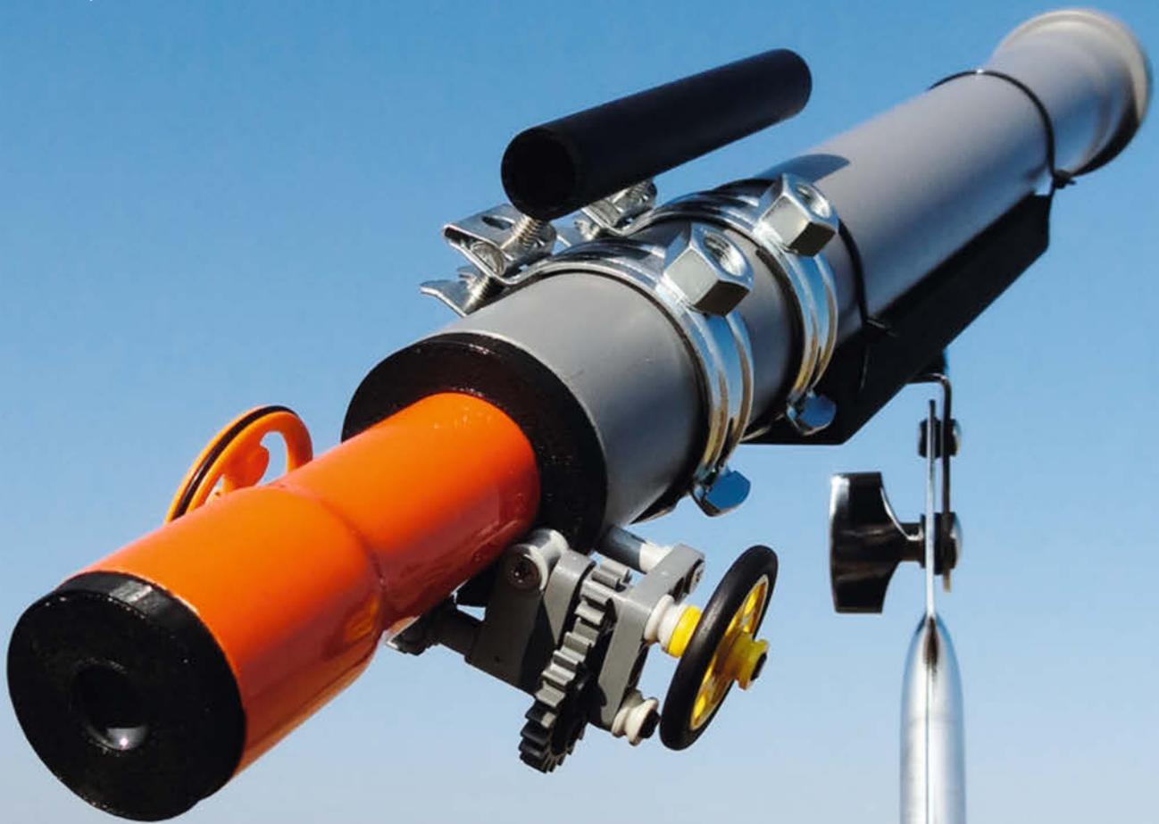
Einfache HT-Abflussrohre sind die Ausgangsbasis für das günstige „Baumarkt-Teleskop“. Zusammen mit dem Bausatz eines Versandhändlers kann man sich daraus in kurzer Zeit ein hochwertiges Teleskop zum Preis einer CD selber bauen. Die optische Qualität der Linsen ist beeindruckend, nur das präzise Einstellen des Instruments für wirklich scharfe Bilder ist schwierig.
