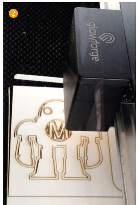
und 3. Der Lasercutter wird auf volle Leistung und Geschwindigkeit 1000 gestellt. In den Links in der Kurzinformatik gibt es die Vektor-Dateien im Illustrator- oder SVG-Format zum Herunterladen. Die Teile fügt man mit einem Acrylkleber auf Dichlormethan-Basis zusammen. Dies macht man am besten in einem gut gelüfteten Raum 4. Die Klebestellen müssen vollständig ausgehärtet sein, bevor der Stempel Lebensmittel berührt.
