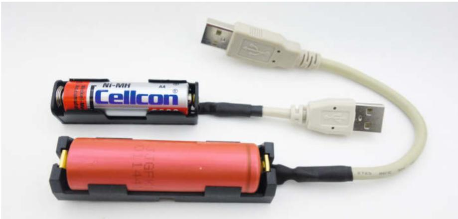
Ladeschalen mit USB-Steckerverbinder: Für die verschiedenen Bauformen der Akkus kann man für einen schnellen Wechsel einen Batteriehalter mit einem USB-Stecker versehen. Es bieten sich ausgediente USB-Kabel an, die man auf ein Minimum kürzt.
