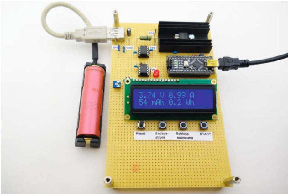
Messung der Kapazität einer Lithium-Ionen-Zelle 18650 mit unserem Prototyp
