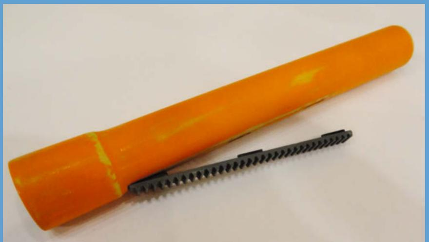
Ein verkürztes Elektro-Stangenrohr wird das neue Okularzugrohr
