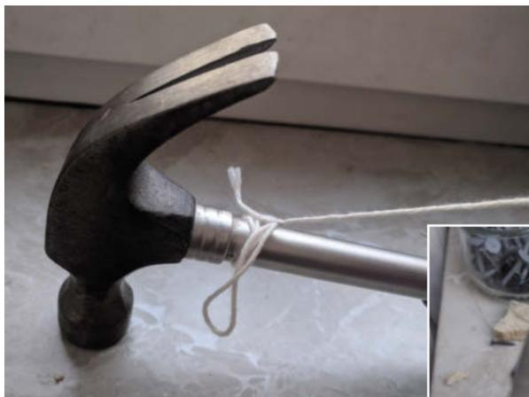
Wenn wir die Schnur so um den Hammer winden, dass sie an beiden Seiten des Griffs nach hinten führt, ist der Hammer stabiler.
