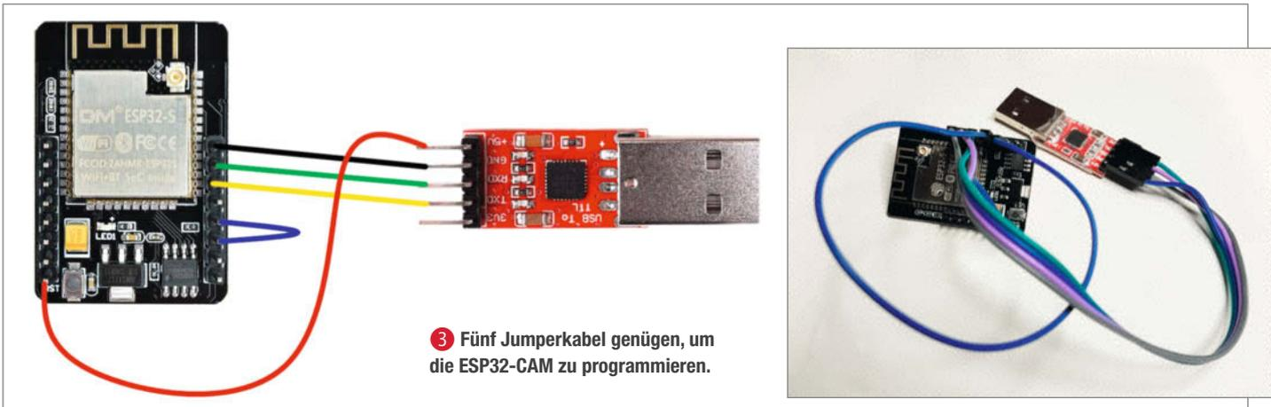
3 Fünf Jumperkabel genügen, um die ESP32-CAM zu programmieren.
