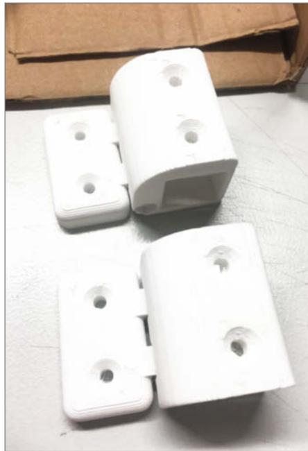
30 Die Scharniere (hier eine weiß gedruckte Variante) bekommen eine Achse aus einer Gewindschraube und gehören zu den wenigen Verbinderteilen, die mit Schrauben am Möbel befestigt werden müssen.
