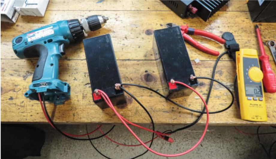
8 Erster Testlauf des Akkuschraubers mit den Blei-Gel-Akkus
