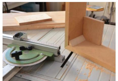
Gehrungsschnitte lohnen sich nur bei beschichteten oder furnierten Platten, um Klebefugen zu kaschieren. Längere Schnitte werden mit Heimwerker-Tischkreissägen oft unpräzise.
