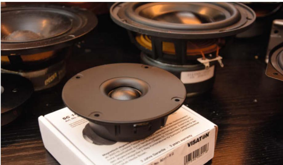
Kalottenhochtöner SC-10 von Visaton: Die kuppelförmige Membran aus einem imprägnierten Gewebe sorgt für eine breite Streuung des Schalls.
