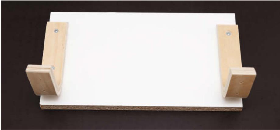
**2** Beim Anschrauben der Halter an das Napfbrett auf die Ausrichtung achten!
