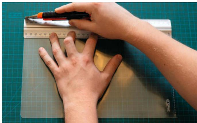
nativ kann man die Mittelfalte akzeptieren und dadurch die doppelte Fläche nutzen. Für den regelmäßigen Einsatz sind dickere Kunststofffolien allerdings vorzuziehen. Diese kann man bei größeren Stückzahlen am besten mit einem Lasercutter zuschneiden. Alternativ kann ein normaler Locher für die Löcher verwendet werden. Mit einer Schere oder einem Cutter kann man dünnere Folien zuschneiden.
