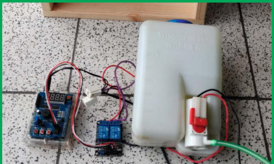
Im Projekt stecken ein Arduino mit Multi-Function-Shield, ein Relais und der Wassertank mit integrierter Pumpe.
