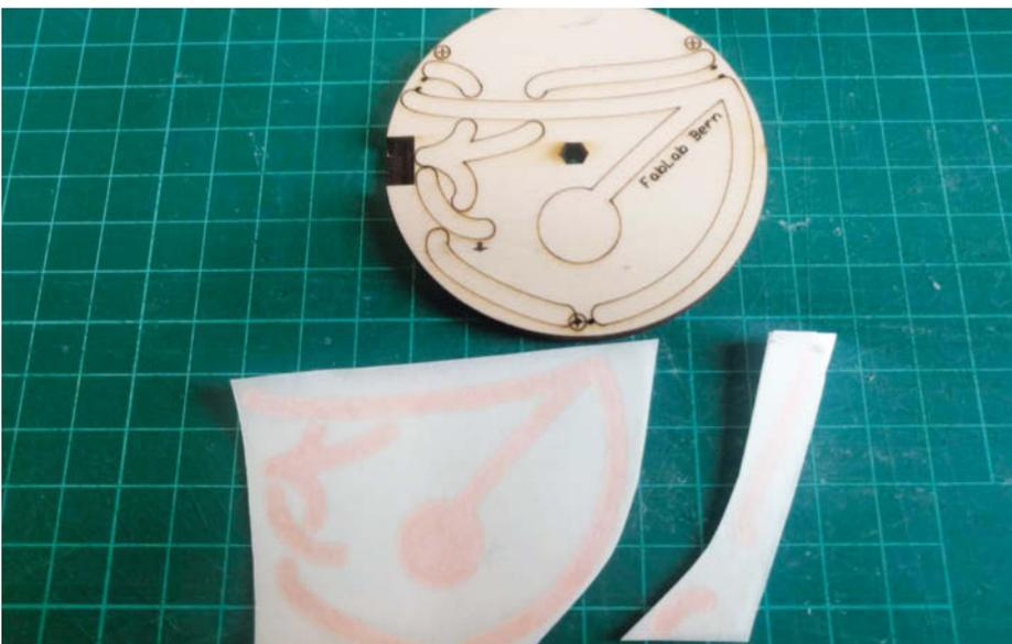
6 Schneidet man die Form in kleinere Abschnitte, ist es einfacher, die Folie gleichmäßig aufzukleben.
