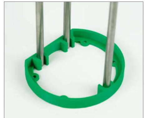
② Die Metallstangen werden von 3D-gedruckten Teilen zusammengehalten.
