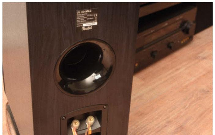
Der Bassreflex-Tunnel kann als Röhre oder als quadratischer Schacht ausgelegt sein – dem Schall ist die Bauform ziemlich egal.
