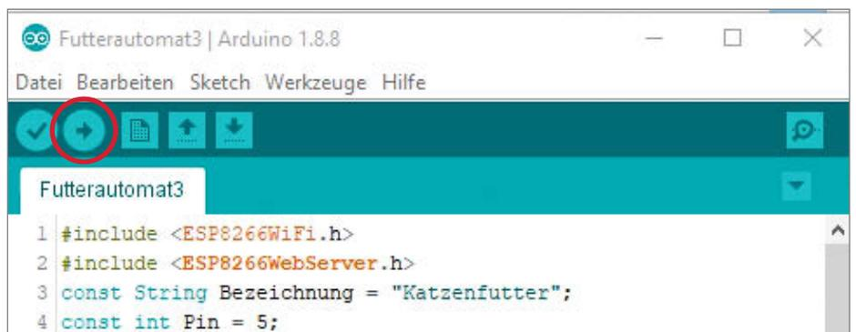
**13** Mit einem Klick auf den Pfeil wird das Programm übersetzt und aufs Board übertragen.
