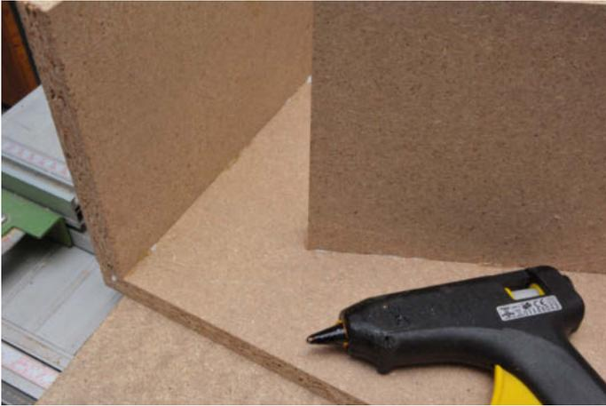
Nach der ersten Stellprobe wird an den Stoßkanten großzügig Leim aufgetragen und zusammengefügt. Damit das Ganze beim weiteren Zusammenbau nicht verrutscht, heftet man die Bretter einseitig mit einem Tropfen Heißkleber an.
