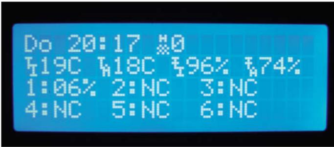
5 Die Statusanzeige, von links oben nach rechts unten: Wochentag, Uhrzeit, Heizleistung, Temperatur innen, Temperatur außen, Luftfeuchtigkeit innen, Luftfeuchtigkeit außen, Bodenfeuchtigkeit Sensor 1, alle anderen Sensoren sind nicht angeschlossen (NC)
