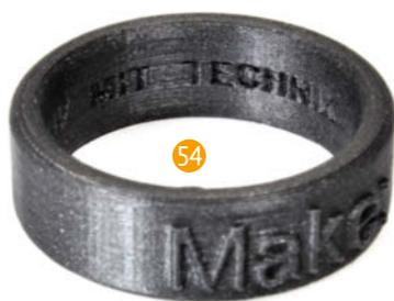
dern eher einem Vieleck gleicht. Das Dateiformat STL besteht nur aus Punkten, Kanten und Flächen dazwischen (kurz Mesh genannt), deshalb werden runde Körper durch Vielecke ersetzt. Bestehen die aus zu wenigen Punkten, entstehen störende Kanten.
