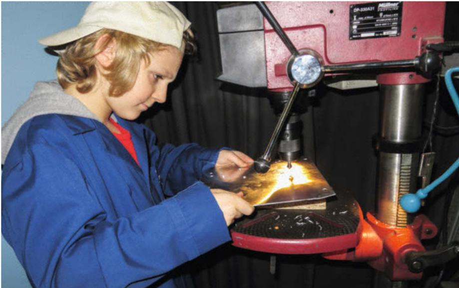
6 Anfertigen der Halterung für die Elektronik: Anzeichnen, Körnen, Bohren und Senken
