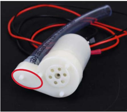
9 Nur an dieser Stelle darf Kleber aufgetragen werden. Die Ansaugschlitze müssen frei bleiben.
