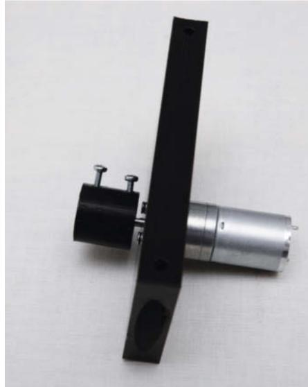
**7** Die Kupplung so auf die Motorachse aufstecken, dass die Schraube auf die abgeflachte Stelle der Achse weist. Die Kupplung muss etwa 2mm Abstand zu den Schraubenköpfen haben.
