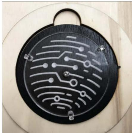
15 Sobald die Acrylglasplatte sitzt, kann man die Position der LEDs noch mal kontrollieren.
