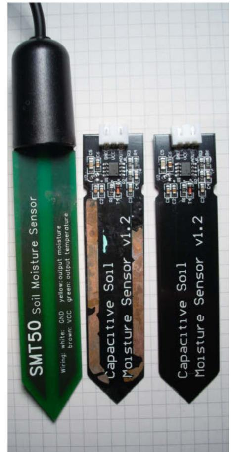
② Direkter Vergleich zwischen dem SMT50 (links) und dem China-Sensor nach etwa sechs Monaten Dauerbetrieb. Der SMT50 weist keinerlei Anzeichen von Korrosion auf, wohingegen der mittig gezeigte Billigsensor stark angegriffen ist. Ganz rechts ist ein fabrikneuer Sensor dargestellt.
