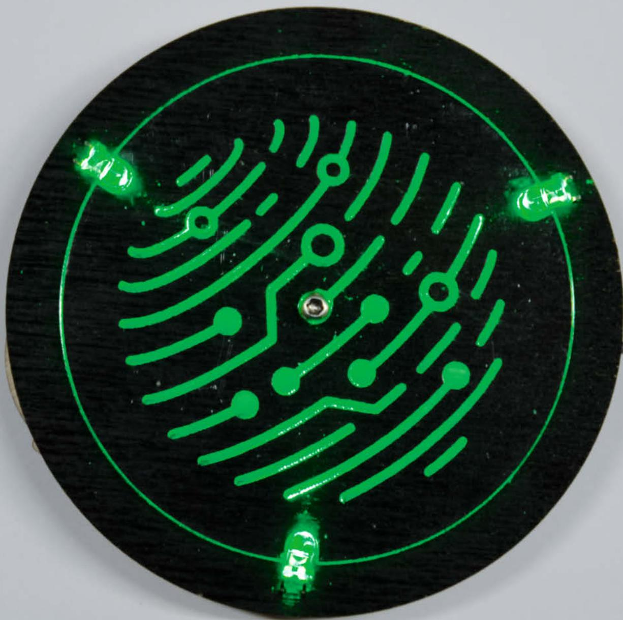
Zum Bau des Badge benötigt man zwar nur einfache Materialien, das Ergebnis kann sich aber trotzdem sehen lassen. Die Grundform besteht aus Sperrholz. Die Leiterbahnen aus Kupferfolie kleben auf der Holzbasis. Sie verbinden drei LEDs, die das Acrylglas indirekt beleuchten. Der faszinierende Leuchteffekt entsteht dank eines Displays aus graviertem Acrylglas. Das Badge eignet sich besonders gut als Übungsobjekt, um Gruppen Lötten beizubringen.
