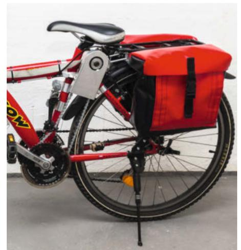
**15** Kettenspanner und Schutzblech für die zusätzliche Kette
