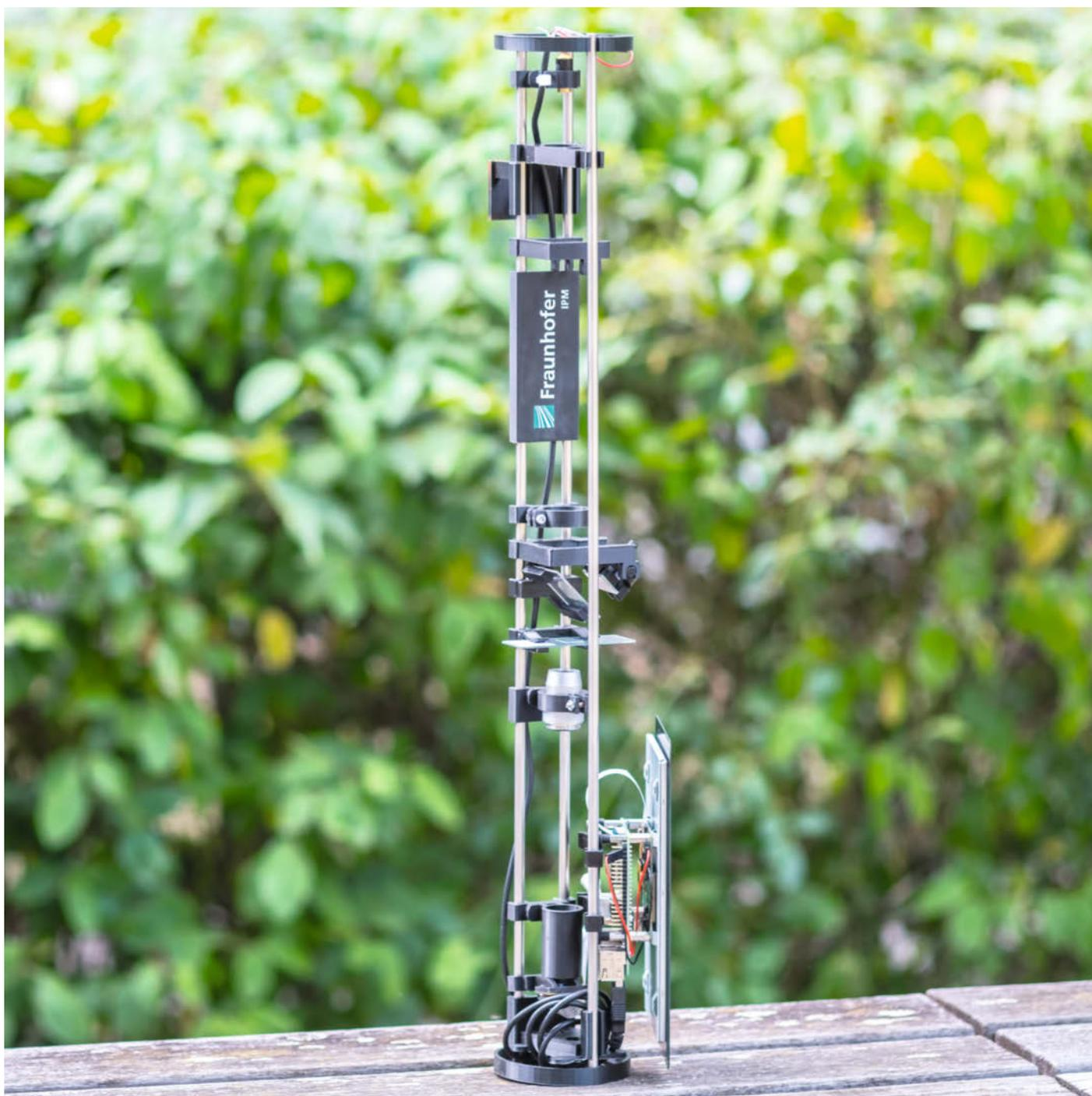
**W**ährend man bei herkömmlichen Mikroskopen seine Proben oft färben und präparieren muss, ist die Vorarbeit bei 3D-Mikroskopen auf Basis der digitalen Holographie überflüssig. Mit digital-holographischen Mikroskopen lassen sich etwa durchsichtige Objekte wie lebende Nervenzellen live beobachten. So können mit unserem 3D-Mikroskop HolMOS biologische Prozesse nicht nur gefilmt, sondern an jedem Kamerabild auch Messungen in allen drei Dimensionen durchgeführt werden.
