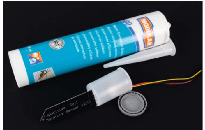
**6** Nicht unbedingt notwendig: Die Elektronik der Sensoren kann man durch Eingießen mit Silikon in Filmdöschen schützen. Den herausstehenden Elektrodenteil kann man mit Klarlack vor seitlich eindringendem Wasser schützen.
