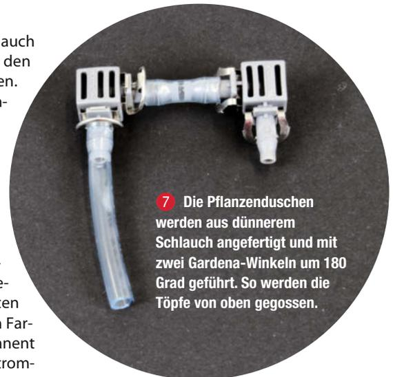
**7** Die Pflanzenduschen werden aus dünnerem Schlauch angefertigt und mit zwei Gardena-Winkeln um 180 Grad geführt. So werden die Töpfe von oben gegossen.
