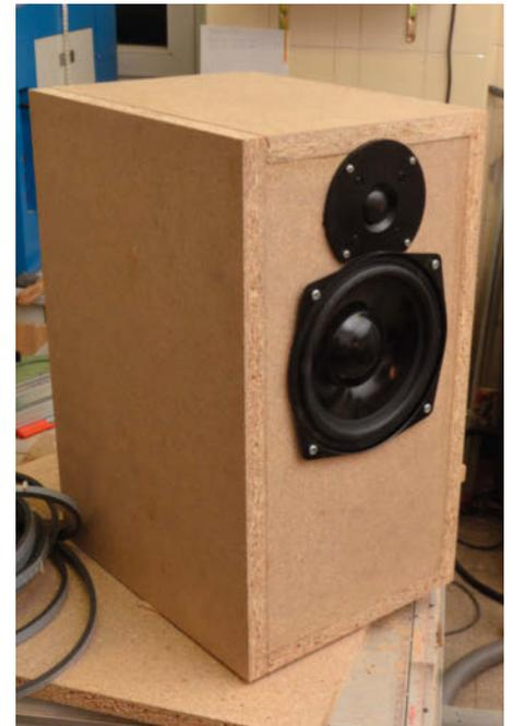
Damit Hoch- und Tieftöner vorteilhaft eng beieinander liegen, haben wir dem Hochtöner mit Stichsäge und feinem Sägeblatt einen bogenförmigen Ausschnitt verpasst – sein Kunststoffrahmen lässt solche Modifikationen ohne weiteres zu. Der Tieftöner muss mit einem Schaumstoff-Dichtungsband montiert werden, das auch Resonanzerscheinungen verhindert.
