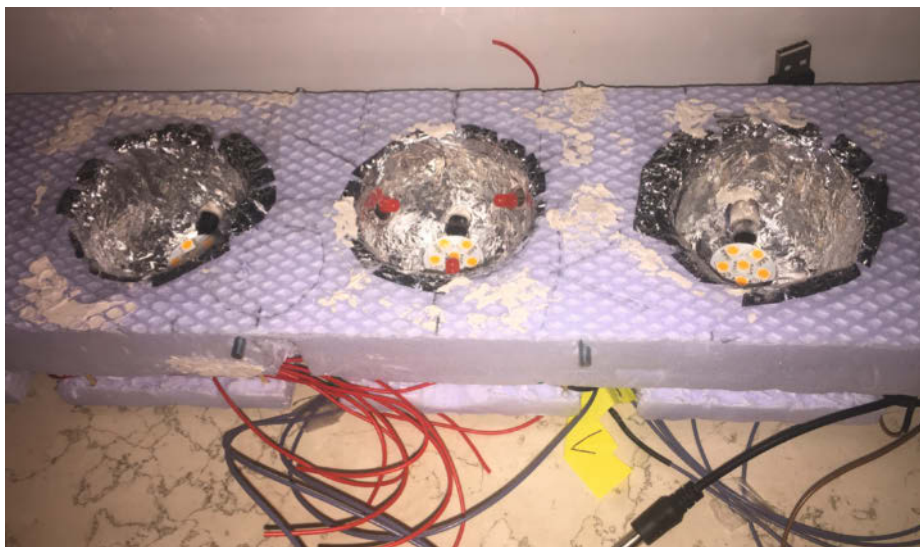
4 Hier sind die Alureflectoren und die roten LEDs für die Mondfinsternisanzeige zu sehen.
