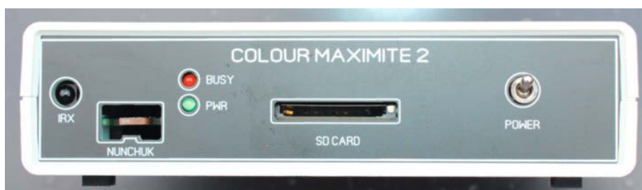
Auf der Vorderseite bietet der CMM2 Platz für einen IR-Empfänger, einen Wii Nunchuk und eine SD-Karte.
