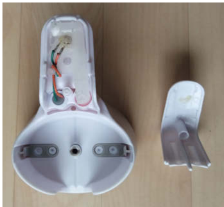
3 Die beiden Litzen an der IR-Sendediode müssen abgelötet werden.
