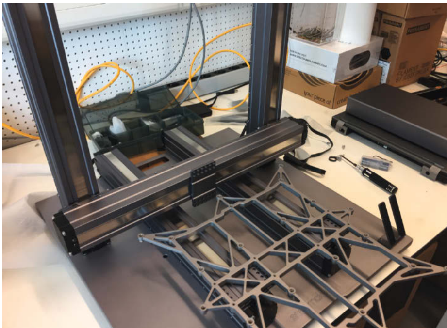
Das Druckbett oder die Opferplatte zum Fräsen ruht auf einem verwindungssteifen Skelett aus Alu-Druckguss.
