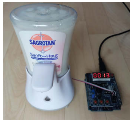
5 Das Flachbandkabel des Seifenspenders wird am MFS angeschlossen.
