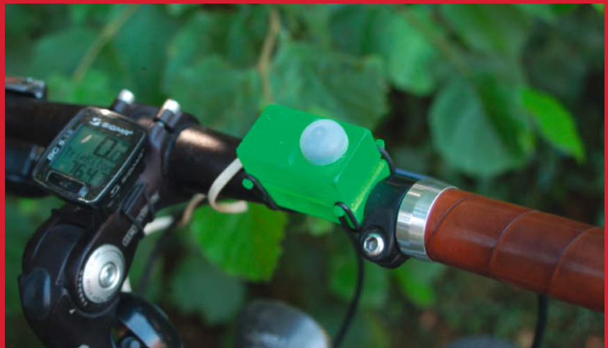
Zum zeitweiligen Ausschalten der Automatik gibt es einen Knopf am Lenker.
