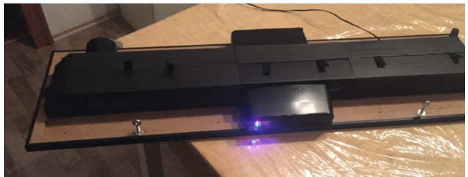
9 Kompletter Korpus mit Verkleidung und Sichtfenster für den ESP32
