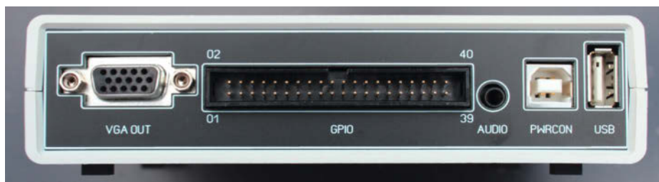
Der GPIO-Anschluss dominiert die Rückseite des Geräts.
