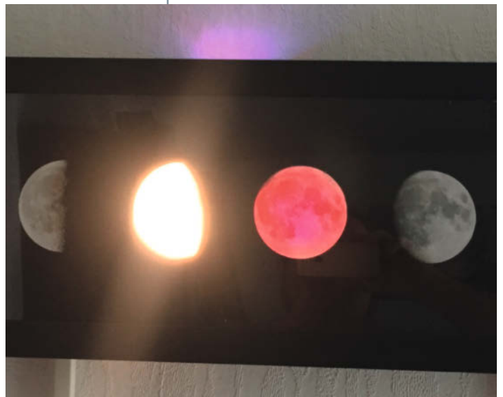
15 Doppelte Beleuchtung aufgrund eines Fehlers in der ersten Firmwareversion
