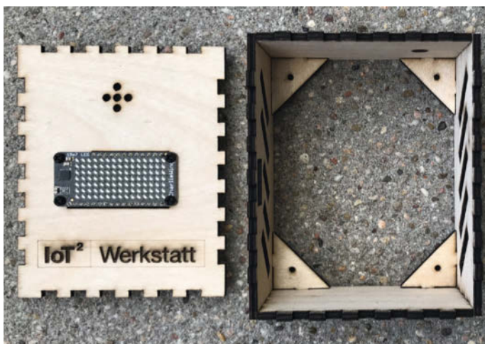
Der Sperrholzrahmen zusammengesteckt und das Display bereits montiert
