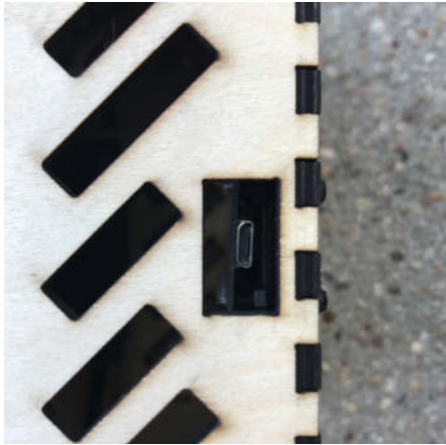
Die Stromversorgung erfolgt über die seitliche USB-Steckbuchse.
