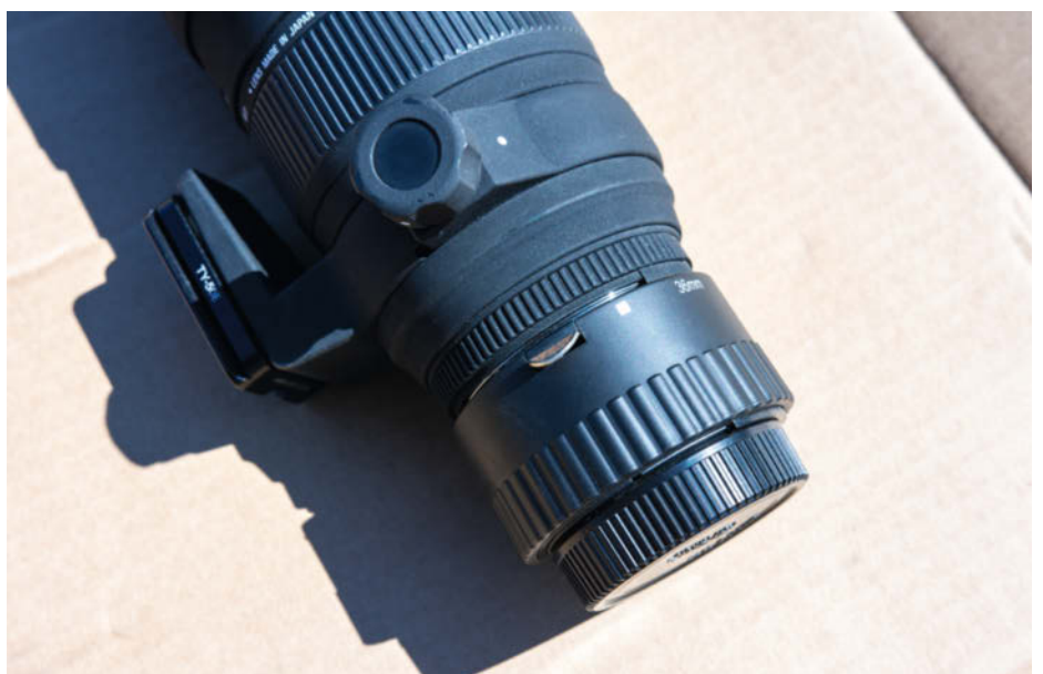
1 Ein Makro-Adapter kann ein herkömmliches Teleobjektiv zu einem eingeschränkten Makro-Objektiv machen – für den DIY Diascanner reicht das auf jeden Fall aus.
