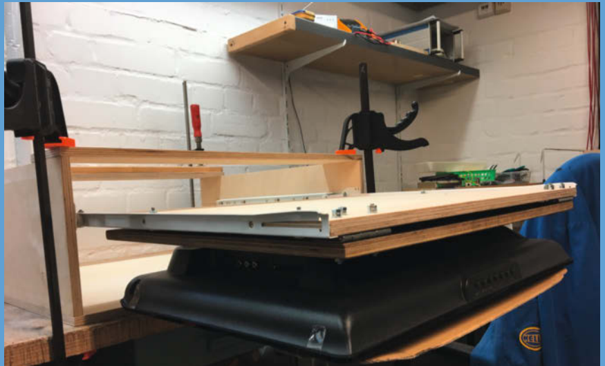
Ausgefahrener Fernseher in der frisch gebauten Schublade
