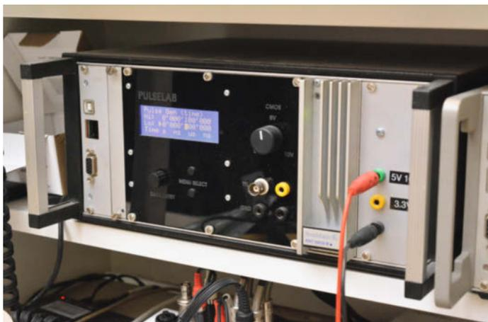
Mein Impulsgenerator enthält eine modifizierte c't-Lab-FPGA-Platine. In das Gehäuse passte noch ein Konstantspannungs-Netzteil (rechts).
