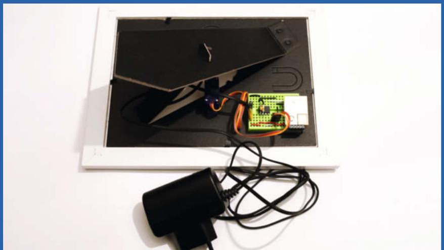
Die fertige Schaltung haben wir einfach auf ein Breadboard gesteckt und dieses auf den Bilderrahmen geklebt.
