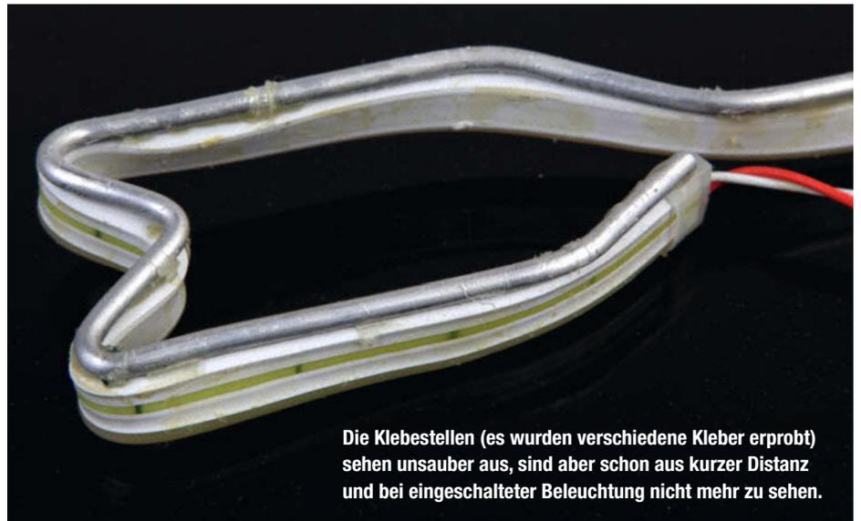
Die Klebestellen (es wurden verschiedene Kleber erprobt) sehen unsauber aus, sind aber schon aus kurzer Distanz und bei eingeschalteter Beleuchtung nicht mehr zu sehen.
