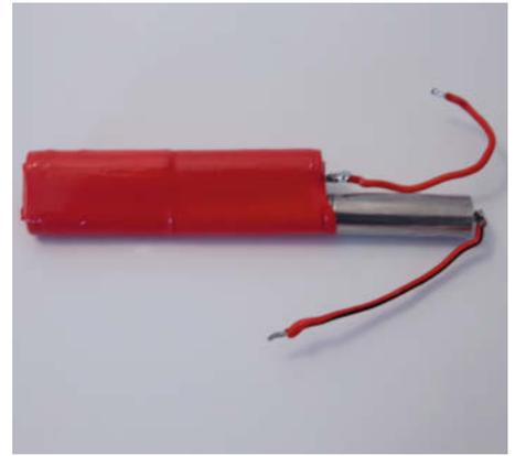
**5** Die zwei restlichen Zellen neben den 3er-Pack klappen und alles mit größerem Schrumpfschlauch isolieren.
