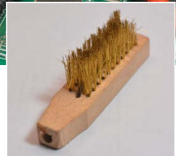
Durch das 4mm-Loch für das Messkabel führt ein dünner Kupferdraht, der um die Drahtbüschel gewunden wird.
