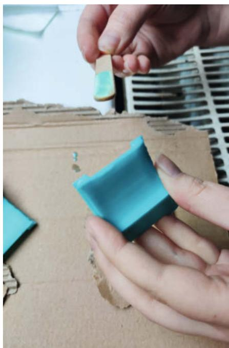
Resin wird auf den ausgehärteten Druck aufgetragen.
