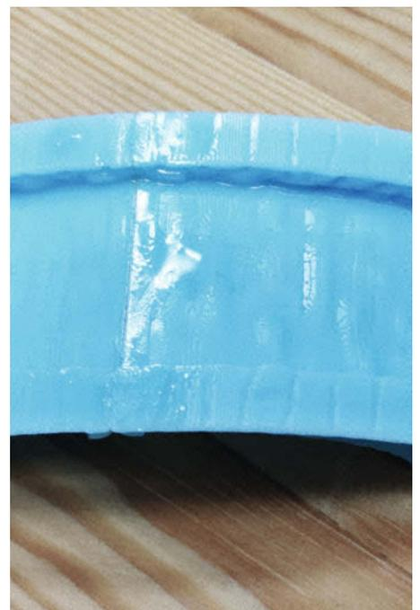
Glanz des als Kleber aufgetragenen und ausgehärteten Resin
