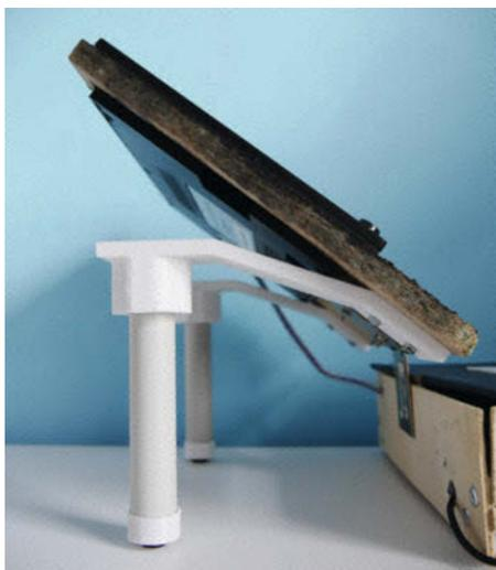
Hinten stützen zwei PVC-Rohre das Display ab.
