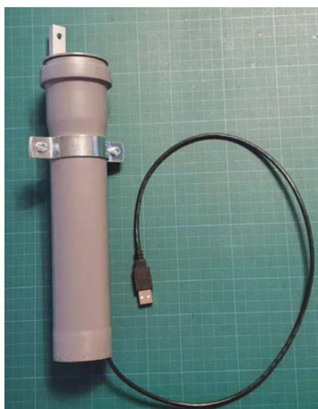
Gehäuse-Variante für den dauerhaften Außeneinsatz
