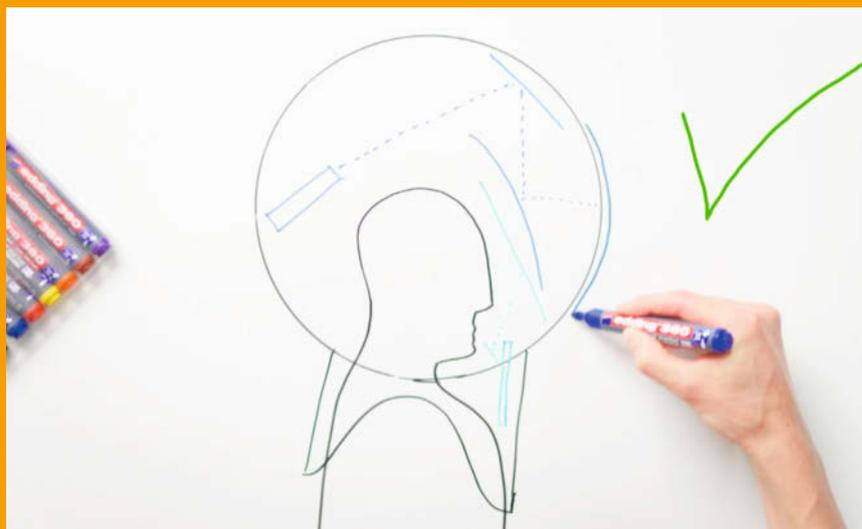
Die grundlegende Konstruktion aus Beamer, Spiegeln und Smartphone im Helm
