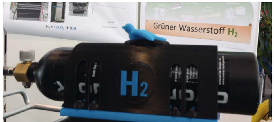
Der Metallhydrid-Wasserstoffbehälter ist auf dem Gepäckträger des Rads befestigt.
