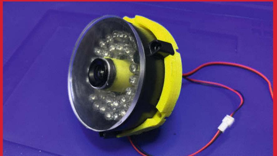
Der funktionale Kameraaufbau mit Infrarot-Beleuchtung und Objektiv auf dem Adapterring
