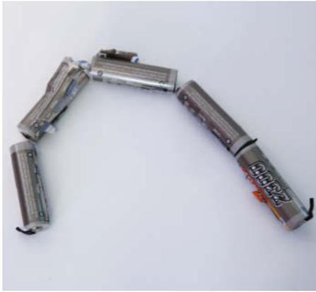
**3** Beim Zerlegen des Conrad-Akkupacks wird die Isolierung beschädigt. Vorsicht, die Kurzschlussgefahr ist gross!
