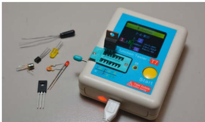
**Bauteiltester T7:** Das akkubetriebene Gerät identifiziert die Pinbelegung diskreter Bauteile und liefert sogar überschlägige Kenndaten von Transistoren.
