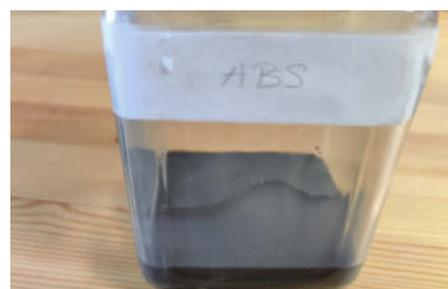
Der fertige ABS-Glue riecht stark nach Aceton und sollte gut verschlossen gelagert werden.
