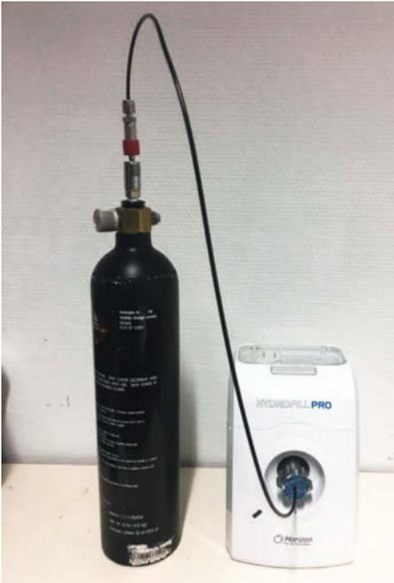
Diese Tisch-Tankstelle erzeugt aus Wasser durch Elektrolyse Wasserstoff und füllt direkt den Metallhydrid-Behälter.
