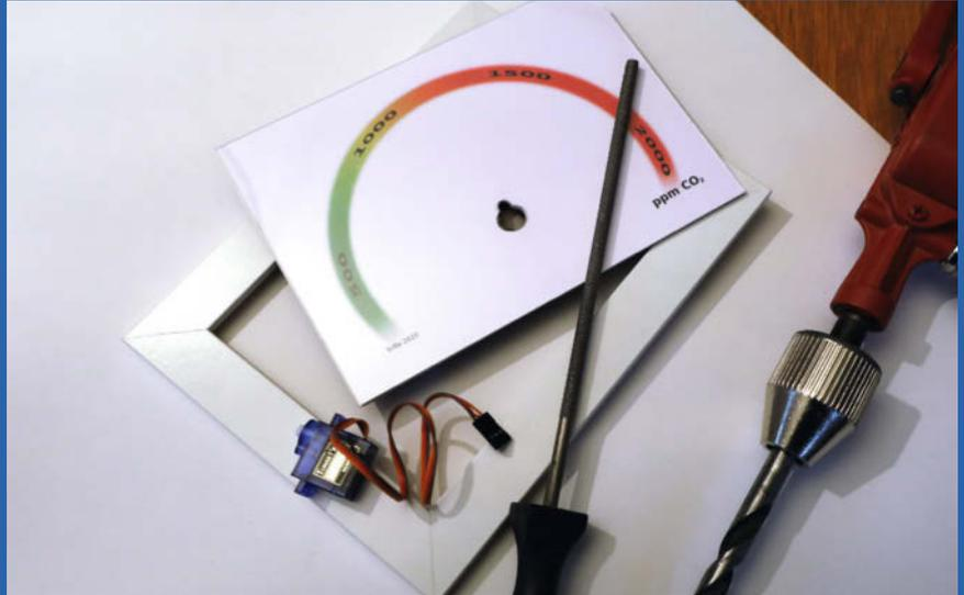
Das Loch in der Skala muss zum Servo passen.
