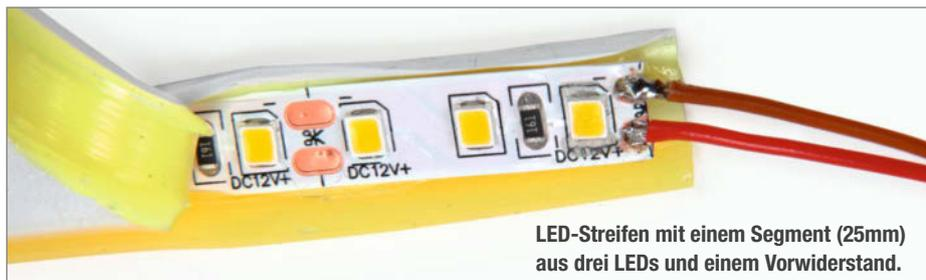
LED-Streifen mit einem Segment (25mm) aus drei LEDs und einem Vorwiderstand.
