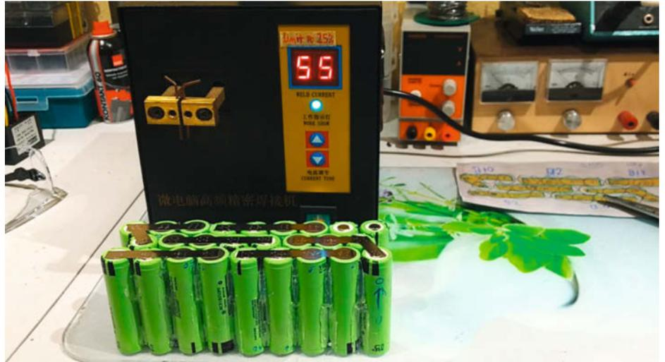
Das Pufferakku-Pack habe ich aus Panasonic-NCR18650PF-Li-Ion-Akkus selbst geschweißt. Es besteht aus 26 Zellen, je 13 in Reihe, die wiederum parallel geschaltet sind.
