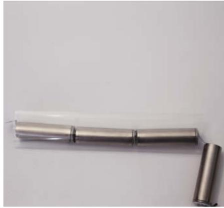
**4** Der neue Akkupack wird zunächst in zwei Teilen mit Klarsicht-Schrumpfschlauch isoliert. Am linken Ende sitzt der Minuspol.
