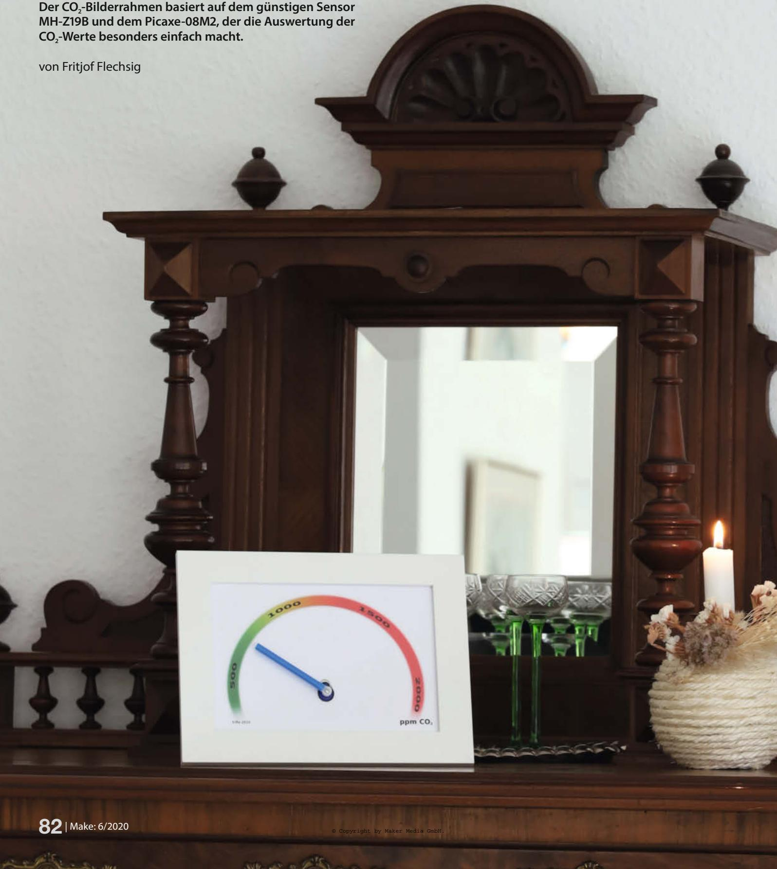
Dieser CO<sub>2</sub>-Warner ist einfach und schnell zu bauen: Als Anzeige verwenden wir einen Bilderrahmen und einen Servo-gesteuerten Strohhalm, während ein Picaxe-08M2 die Auswertung des CO<sub>2</sub>-Sensors MH-Z19B übernimmt. Nötig sind nur noch das Nano-Axe-Board, das es mit dem Make Picaxe Special gibt (oder wenige elektronische Bauteile) und ein Netzteil.
