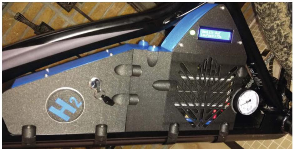
Auch das Gehäuse für das komplette System aus Schüsselschalter, Brennstoffzelle, Pufferakku, Elektronik und Arduino Mega stammt aus dem 3D-Drucker. Es sitzt zwischen Oberrohr und Unterrohr zentral im Rahmen des Rads.
