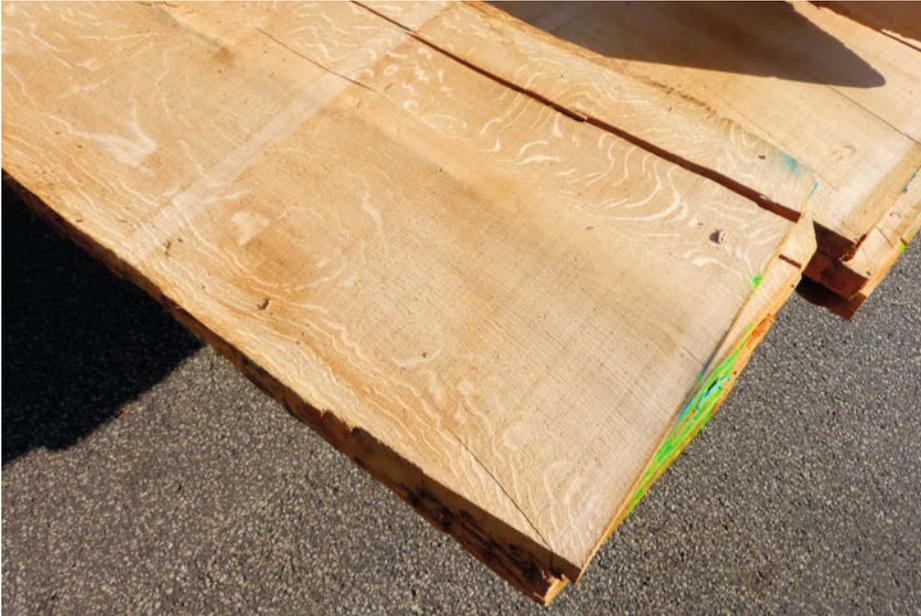
**Eiche-Bohlen mit sehr auffälliger Maserung. Dieses Holz muss noch zugeschnitten, abgerichtet und ausgehobelt werden.**
