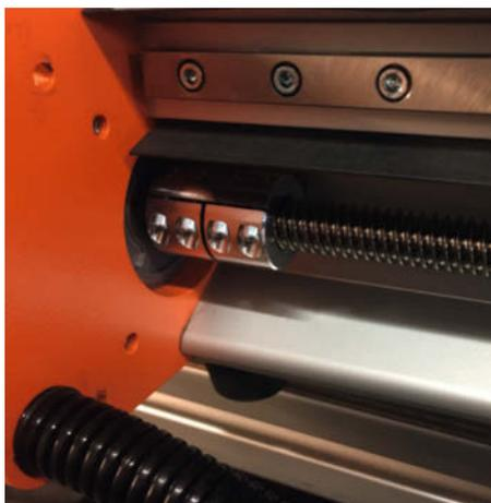
Die Dryspin-Spindeln unserer Maschine sind pflegeleicht, aber etwas kritisch bezüglich der Spindelmuttern-Vorspannung. Gänzlich ohne Tadel: Die hochwertigen Linearführungen von Bosch-Rexroth.
