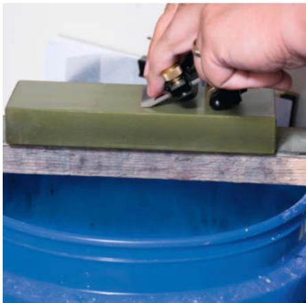
2 Beim Abziehen müssen sowohl die Walze der Hilfe als auch die Fase des Eisens auf dem Schleifstein aufliegen, während man das Eisen darüber hin und zurück führt.
