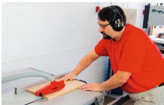
Seitlich neben der Maschine, da ist der sicherste Platz. Sollte ein Werkstück weggeschleudert werden, stehen Sie außerhalb seiner Flugbahn.
