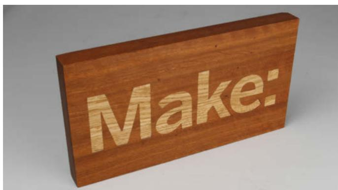
2 Auch solche Einlegearbeiten aus verschiedenen Holzarten sind mit der CNC-Fräse drin – mit klassischen Holzbearbeitungsmaschinen geht so etwas nicht.
