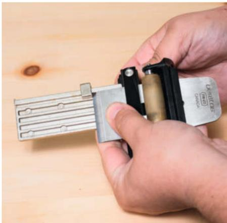
1 Das Eisen wird in die Schleifhilfe (oft auch Schleifführung oder Schärfhilfe genannt) eingespannt und auf den gewünschten Winkel eingestellt.
