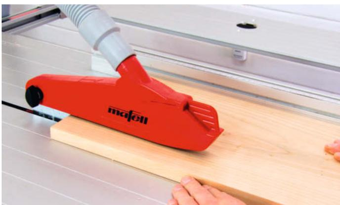
Wird die Schutzhaube bis auf die Werkstückoberfläche abgesenkt, verbessert das nicht nur die Absaugung. Sie verringert auch deutlich die Gefahr, dass Ihre Finger zu nahe an das laufende Sägeblatt kommen.
