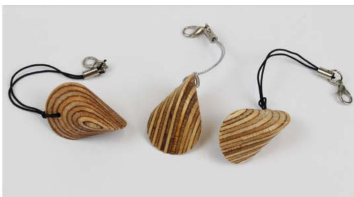
1 Oloiden als Schlüsselanhänger. Die nur wenige Zentimeter großen 3D-Objekte wurden in zwei Durchgängen aus Multiplex gefräst, was die schicke Streifenoptik ergibt.
