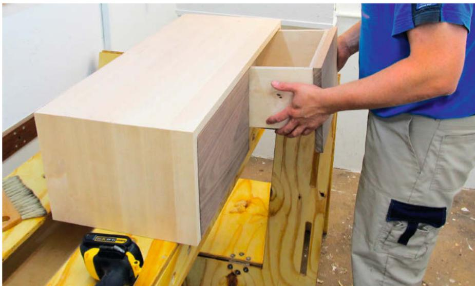
Die Schublade ist aus Multiplex, die Front aus massivem Nussbaum und der Außenkorpus aus Birke-Leimholz. Dieser Materialmix spart Materialkosten und erleichtert das Anfertigen des Möbelstückes.
