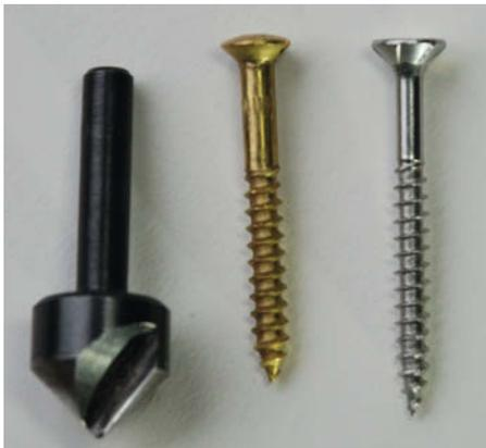
In der Mitte eine klassische Holzschraube mit dickem Schaft, die eine Stufenbohrung braucht, rechts eine Spanplattenschraube, die man mit nur einem Durchmesser vorbohren muss. Links der Senker, den man für beide braucht.
