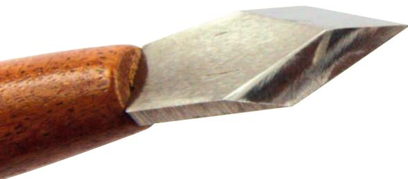
Durch den speziellen Anschlag kann ein Anreißmesser an einer Kante entlang geführt werden. Und das von allen Seiten.
