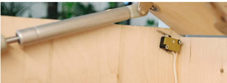
3 Der Mikroschalter in der linken hinteren Ecke schaltet die gesamte Elektronik aus, wenn der Deckel der Werkbank geschlossen wird.
