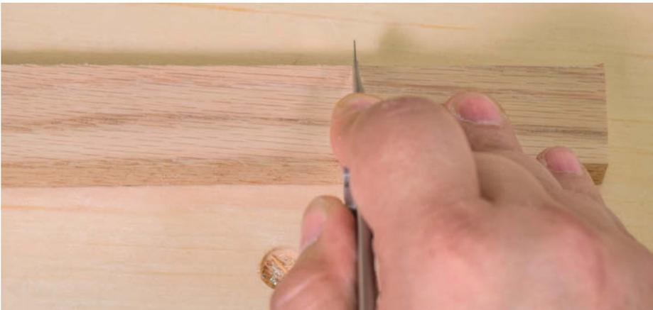
Setzen Sie einen Messerriss an, indem Sie das Anreißmesser kräftig in die Kante des Materials drücken.
