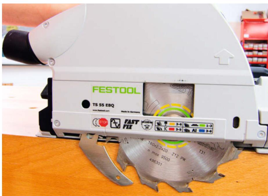
Ein Anblick, den man immer seltener sieht: eine Handkreissäge mit vollwertigem Spaltkeil. Bei Tauchsägen muss dieser federnd gelagert sein, damit das Eintauchen überhaupt möglich ist.
