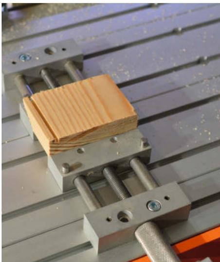
**Für kleinere Teile lohnt sich ein flacher Maschinenschraubstock, wie er speziell für CNC-Fräsen angeboten wird. Dieser passt perfekt zum Nutenabstand (50mm). Vorteil: Es stehen bei der Bearbeitung keine Spannpratzen im Weg.**
