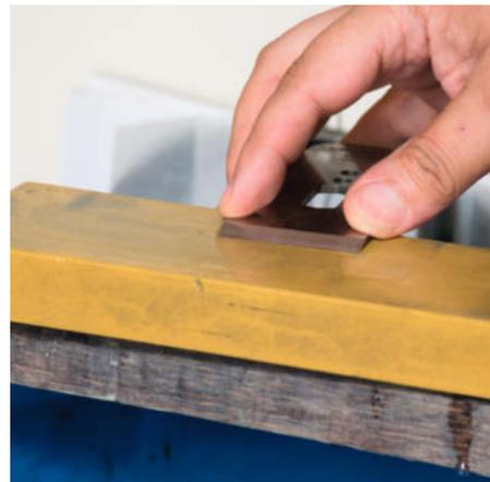
3 Nach dem Abziehen der Fase wird das Eisen umgedreht und man nimmt mit wenigen Strichen über den Stein den Grat an der Spiegelseite ab – auf dem feinsten Schleifstein.
