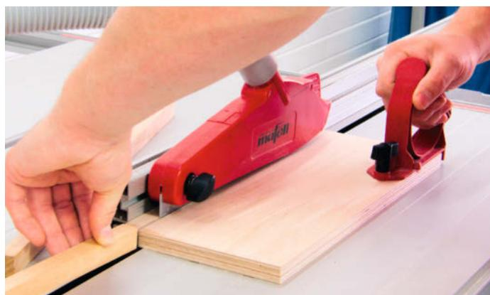
Wenn es für die Benutzung eines Schiebstockes schon zu eng ist, kann man mit einem solchen Schiebebrett auch schmale Werkstücke sicher am Parallelanschlag entlang schieben.
