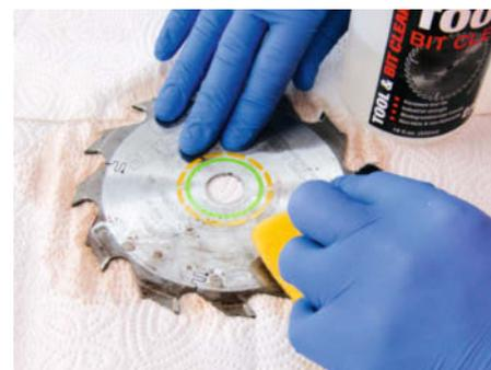
Bei der Anwendung der zum Teil sehr aggressiven Reiniger sollten Sie lösemittelfeste Handschuhe tragen. Ein Küchenschwamm eignet sich sehr gut, um die Rückstände zu entfernen.
