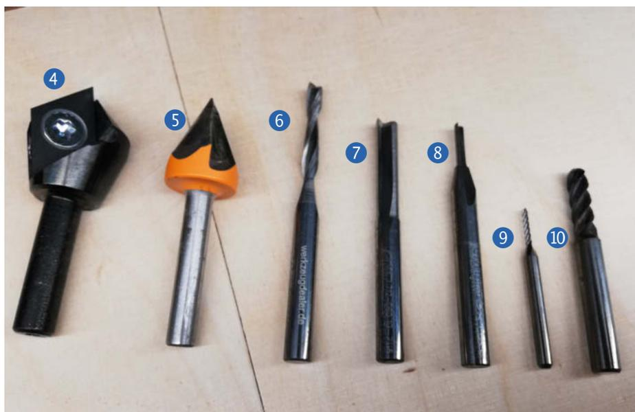
Fräser für unterschiedliche Bearbeitung von Holz, von links nach rechts: 4 Wendeplatten-V-Nutfräser 90 Grad und 5 V-Nutfräser 60 Grad, beide für Gravuren und Inlays; 6 Spiral-Nutfräser mit zwei Schneiden; 7 großer und 8 kleiner Nutfräser mit zwei geraden Schneiden, 9 kleiner diamantverzahnter Nutfräser für Sperrholz; 10 Radius- bzw. Kugelfräser für 3D-Bearbeitung
