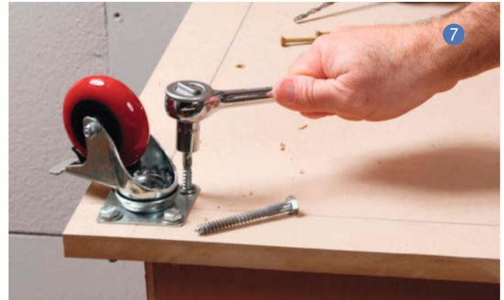
**5 Die Rollen auf der Unterseite platzieren.** Schneiden Sie noch ein Stück MDF zu, rundherum 5cm größer als der Schrankboden, damit Sie die Rollen anbringen können. Zeichnen Sie Linien ein, die den Umriss des Schrank markieren und platzieren die Rollen mittig auf den Ecken des Schrank, um die Bohrlöcher anzuzeichnen. Dann bohren Sie diese.
