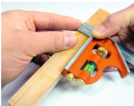
Durch Abtasten wird die Materialstärke, beispielsweise beim Dickenhobeln, geprüft.
