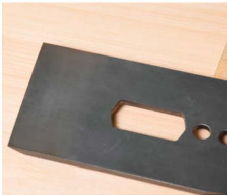
Mit einem Schleifstein werden etwa 25mm der Spiegelseite abgerichtet. Wenn die Schleifspuren hier ein gleichmäßiges Muster ergeben, ist der Abschnitt eben.
