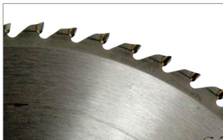
60 Zähne bei einem Durchmesser von 250 Millimetern, dazu noch eine Wechselbezaugung: Mit einem solchen Blatt werden Schnitte in empfindlichen Materialien und quer zur Faser gemacht.
