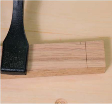
Eine gute Sägekerbe erleichtert es, das Sägeblatt genau dort anzulegen, wo Sie sägen möchten. Schneiden Sie zuerst einen einfachen Riss an.
