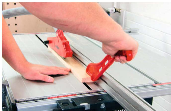
Auch wenn man seitlich zur Maschine steht, kann ein Schiebestock benutzt werden.
