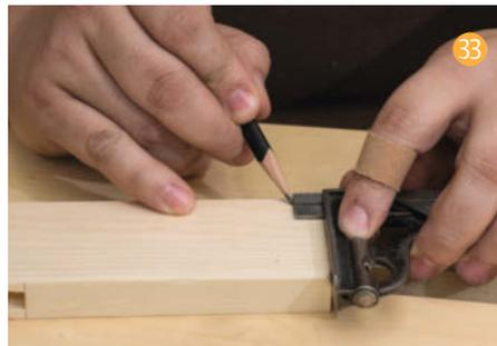
34 Markieren Sie die Mittellinie des Fußes und bringen Sie 12mm von der Unterkante entfernt auf der Mittellinie eine Markierung an.
