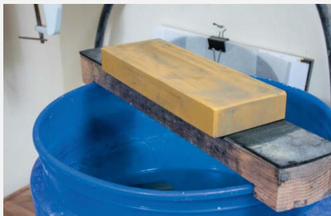
Es ist leicht, die Steine abzurichten, indem man sie einfach über dem Eimer hält und bei Bedarf ins Wasser taucht. Ich habe eine Brückenhalterung hergestellt, die ich auf den Eimerrand lege, damit der Stein während der Arbeit gehalten wird. Diese Brücke erlaubt es, die Steine einfach mit Wasser zu spülen, ohne sich Sorgen darüber machen zu müssen, dass man ringsum alles nass macht. Wenn die Steine nicht mehr gebraucht werden, nehme ich die Brücke ab und lege den Deckel des Eimers wieder auf.
