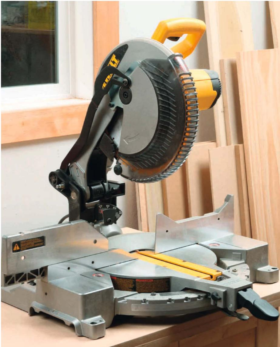
Die Kappsäge ist das Geld wert. Dieses Werkzeug schneidet jedes Brett schnell und sicher auf jede Länge mit perfekten 90 Grad (oder jedem anderen Winkel). Sparen Sie Geld und kaufen Sie eine Version ohne Zugsystem, die für Schrägschnitte nur in eine Richtung kippt, aber nehmen Sie eine mit 30cm-Sägeblatt (anstatt 25cm), damit sie breitere Bretter schneiden können.
