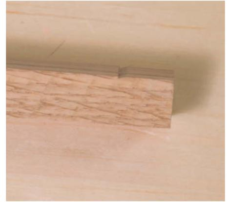
Die breite, flache Kerbe führt das Sägeblatt am ursprünglichen Riss entlang. Das Sägeblatt liegt an der senkrechten Kante an.
