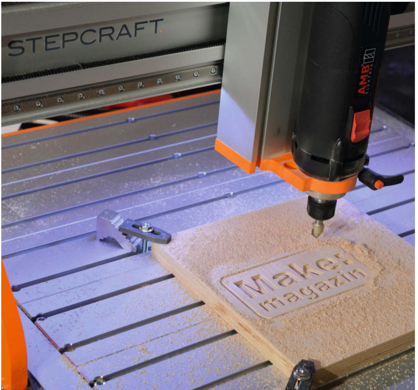
**D**rei neue Maschinen stellte Stepcraft in diesem Jahr vor: Die M.500, M.700 und M.1000, wobei die Zahl für den gerundeten Verfahrenweg in Längsrichtung steht. Im Unterschied zur D-Serie kommen bei den neuen Fräsen nicht mehr simple, direkt auf den Alu-Profilen laufende Rollen zum Einsatz, sondern hochwertige Linearschienen aus geschliffenem Stahl, zusätzlich kann man gegen Aufpreis auch Kugelumlaufspindeln ordern.
