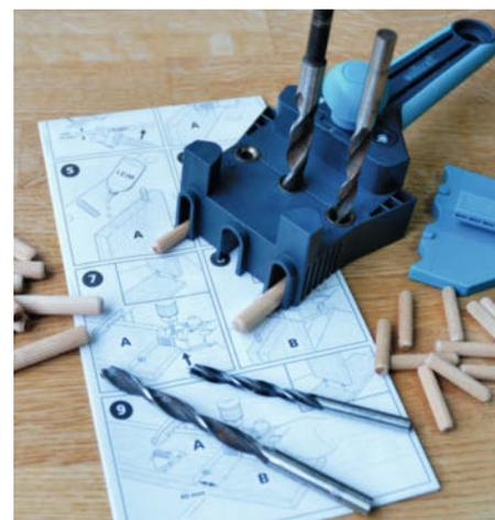
Für Holzdübel gibt es diverse Bohrhilfen im Handel. Diese hier hat Führungen für Dübellöcher der Durchmesser 6, 8 und 10mm.
