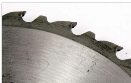
Große Zahnzwischenräume, wenige schneidende Zähne und dazwischen Räumzähne zeichnen ein Sägeblatt für Längsschnitte in Massivholz aus.
