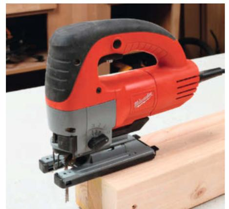
Noch eine mehr. Die ersten beiden Sägen können keine Kurven schneiden, aber die Stichsäge kann es. Nehmen Sie eine in Profi-Qualität, dann schneidet sie schneller, glatter und genauer.
