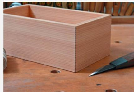
Auftrennen und erneute Aushobeln des Bretts bedeutet. Der kleine Säge Trick mit zwei Anschlägen stellt sicher, dass drei der vier Ecken eine fortlaufende Holzstruktur zeigen. Bei ruhig gewachsenem Holz wird auch Ecke Nr. 4 kaum Versatz zeigen.
