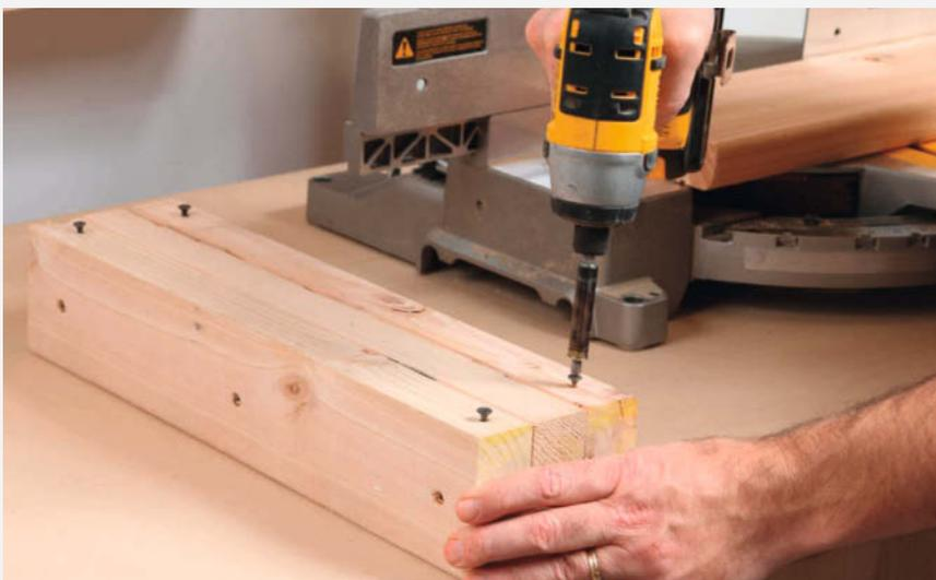
**Sicheres Sägen.** Um lange Bretter gerade zu halten, schrauben Sie ein paar Kantholzstücke zusammen und bringen dann ein paar Schrauben an den unteren Ecken an, um die Höhe zu justieren.
