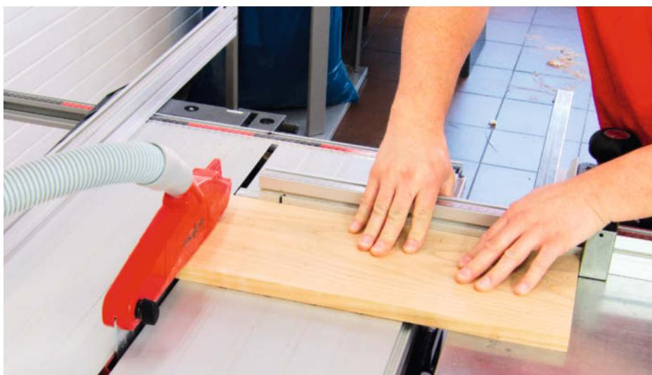
Sicheres Ablängen: Die längste Werkstückkante liegt am Queranschlag an.
