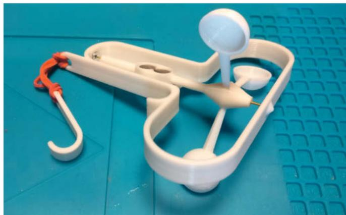
Das fertig zusammengebaute Anemometer
