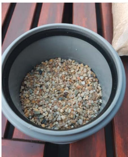
Befüllung des Sandfilters mit Kies und Sand
