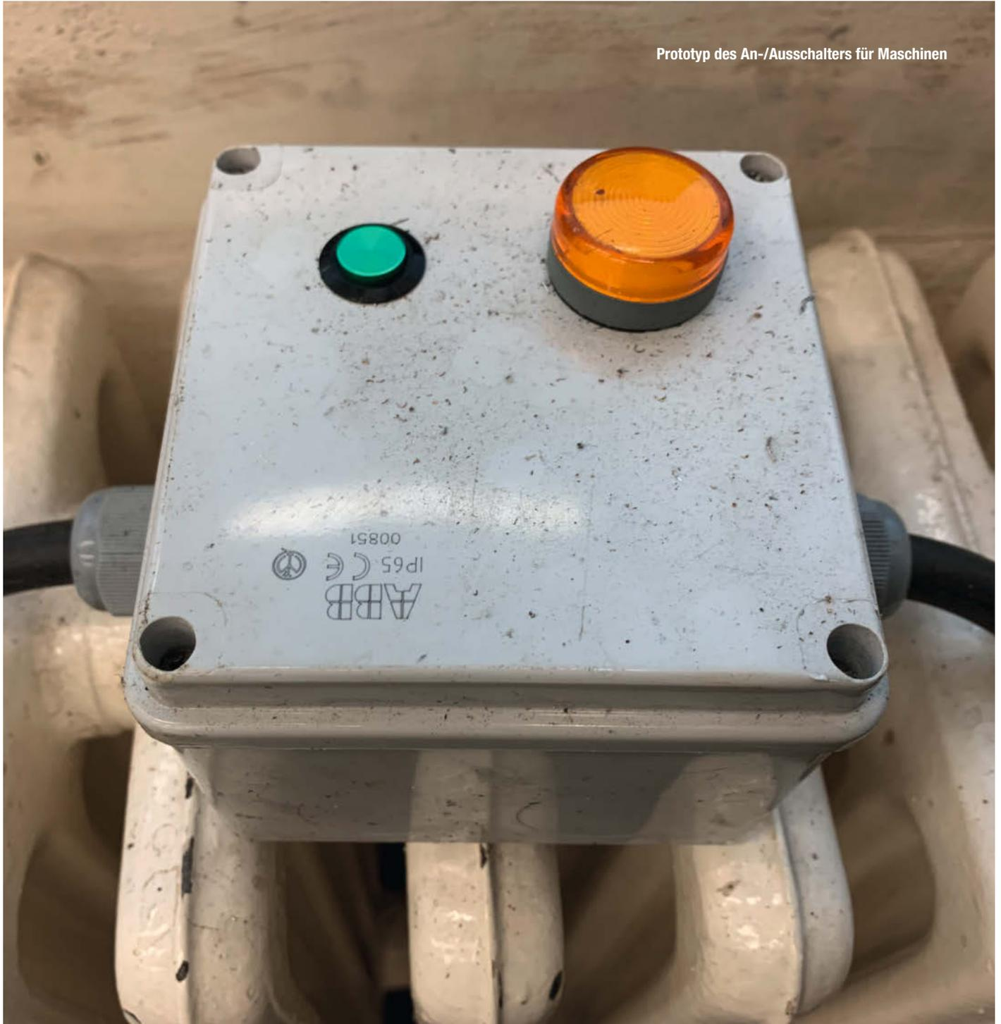
Prototyp des An-/Ausschalters für Maschinen
