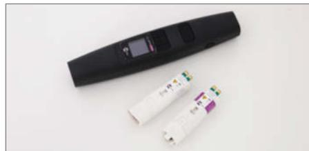
Bei Versuchen in der Redaktion konnte das Warming von 3-Drucken aus ABS deutlich verringert werden. Allerdings zeigte sich dabei auch, dass für die Arbeit mit dem PZ3 eine Abzugsvorrichtung dringend zu empfehlen ist, die das in großer Menge entstehende Ozon noch in Düsennähe des Geräts absaugt.
