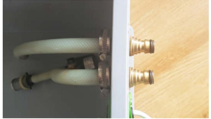
Anschlüsse zum ablaufenden Schlauch (oben) und 12-Volt-Pumpe (unten) im Innenraum der Tankbox
