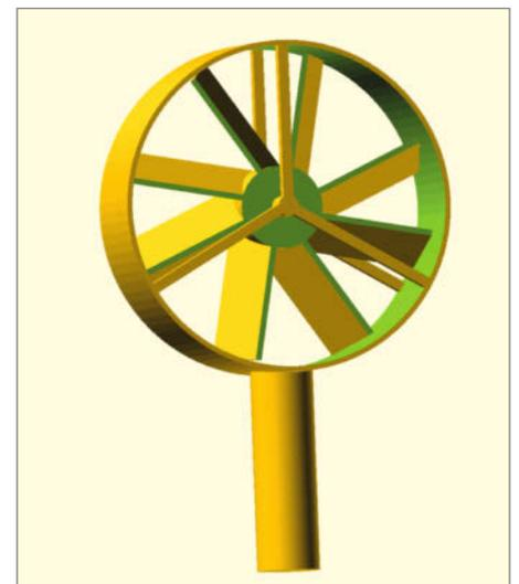
Das Flügelradanemometer – eine weitere mögliche Form
