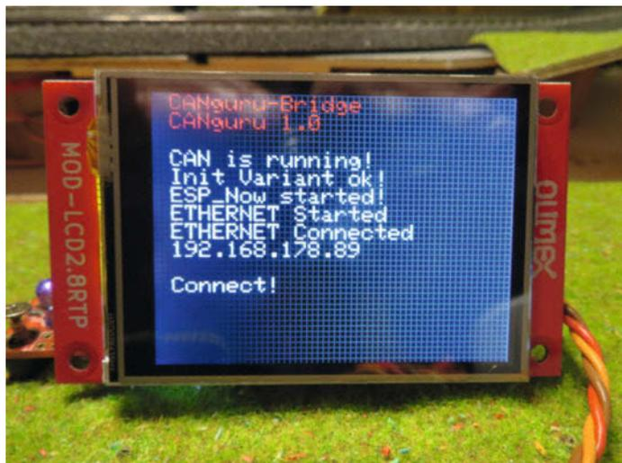
Die CANguru-Bridge verteilt alle Kommandos an die Decoder – hier mit großem LC-Display aufgebaut. Alternativ ginge aber auch ein kleines Display.
