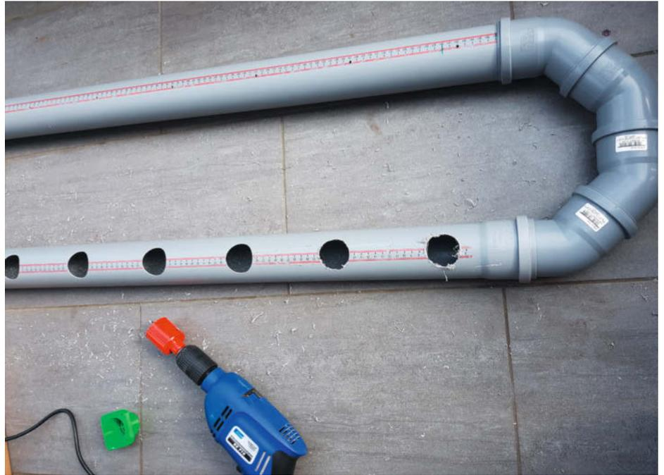
Vorbohren der HT-Rohre (oben), dann langsames Aussägen der Pflanzhalterungen mit einer Lochsäge (unten)
