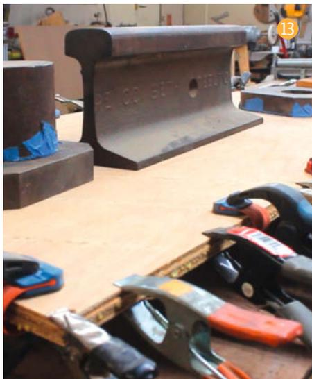
menfügen von Schichten in abwechselnden Richtungen zum Beispiel entstehen vielfältige Muster – hier kann man recht kreativ werden. Ich leime mir aus etlichen Schichten dünnem Sperrholz diverse Rohlinge zusammen, die ich dann in verschiedenen Winkeln zersäge und abschleife – so ergeben sich alle möglichen interessanten Wellenmuster. Aus dem resultierenden Material habe ich schon mehrere Gitarren und andere Gegenstände gebaut **16**.
