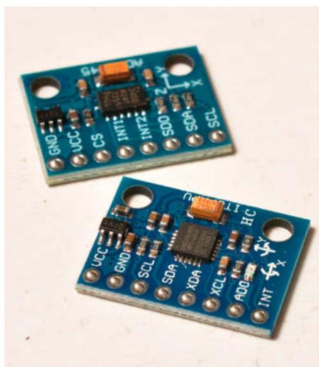
Bei Drohnen-Selbstbauern wohlbekannt: Der Gyro-Sensor MPU6050 auf dem Breakout-Board GY-521 (ab 2,60 €). Hinten eine Ausführung mit dem ADXL345, der nur Beschleunigungen aufnimmt (ab 2,50 €).
