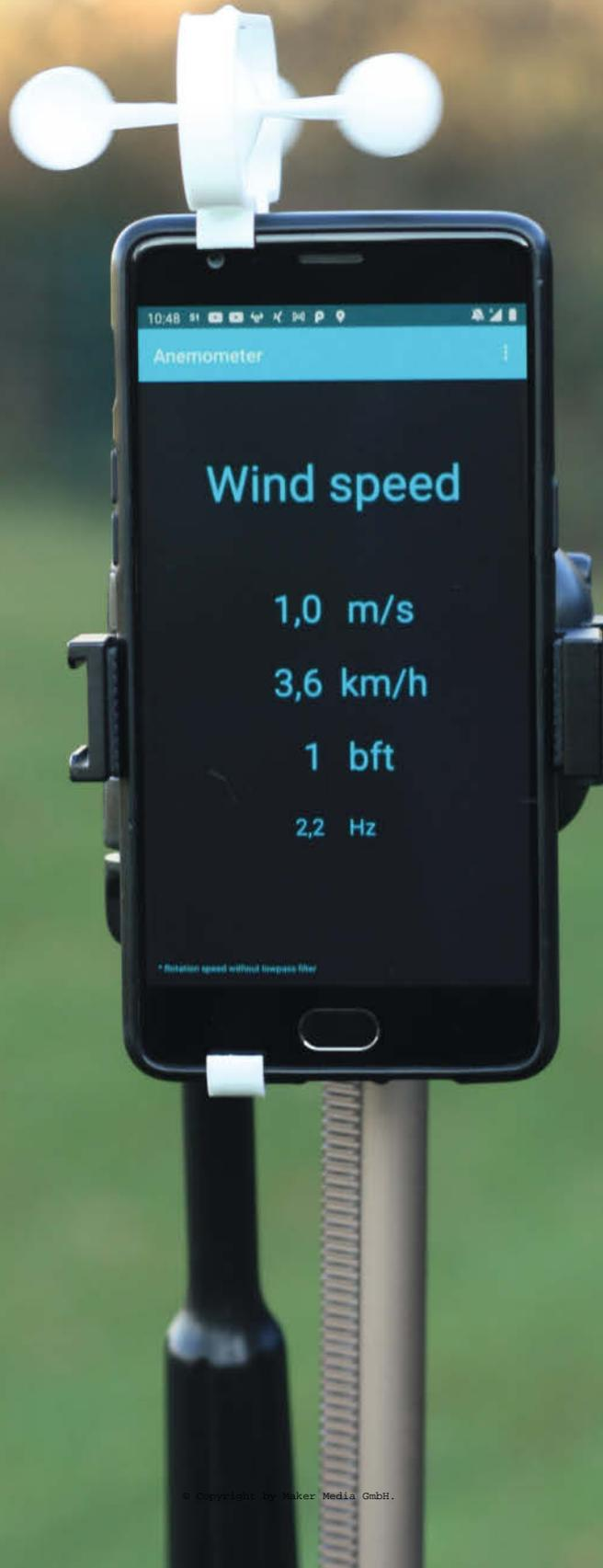
**D**ie Idee: Drei halbkugelförmige Schalen sind an einer vertikalen Rotorachse montiert und lassen ein Magnetfeld in der Achse rotieren. Die Rotation des Magnetfelds wird vom Android-Handy mit dem eingebauten Magnetfeldsensor erfasst und so die Drehfrequenz der Achse ermittelt. Aus der Rotation kann im Handy dann die Windgeschwindigkeit errechnet und auf dem Display dargestellt werden.
