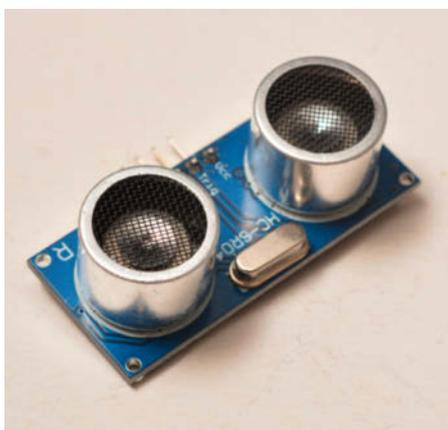
Der Distanzsensor HC-SR04 (3 bis 4 €) arbeitet nach dem Ultraschall-Prinzip, er ist einfach aufgebaut und anzusteuern.
