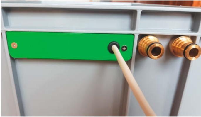
Griffstück mit Elektronik und Wasserein- und -ausgang. Das Kabel zur Steuerplatine wird durch den Deckel des Griffstücks nach außen geführt.
