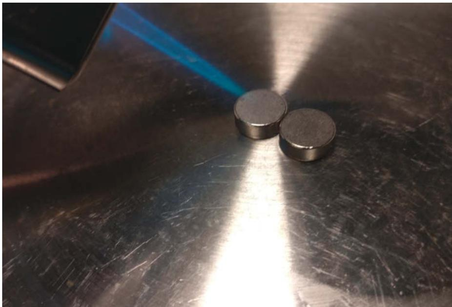
Die Neodyme durch kurzes Erhitzen etwas entmagnetisieren.
