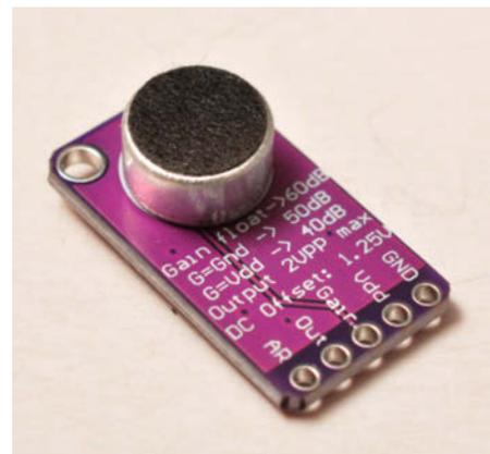
Das MAX9814-Breakout-Modul AGC Preamp 1713 (5 bis 15 €) von Adafruit macht eine Anpassung der Verstärkung an unterschiedliche Lautstärken überflüssig.
