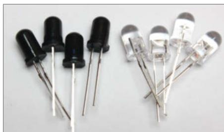
Infrarot-Photodioden mit schwarzem Gehäuse und IR LEDs mit glasklarem Gehäuse
