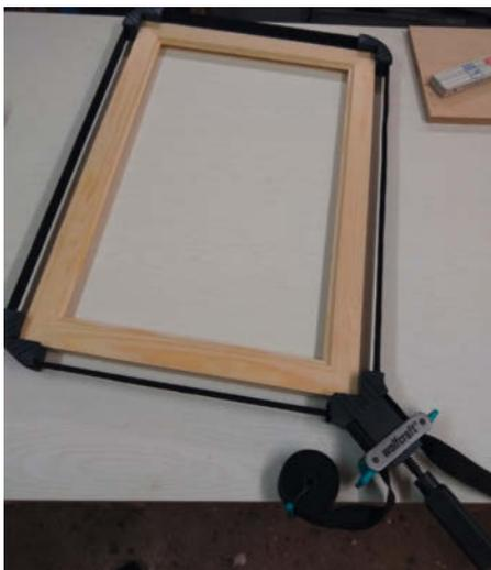
Ein Rahmen-Bandspanner erleichtert das Verkleben sehr, da der Rahmen in einem Rutsch geklebt werden kann.
