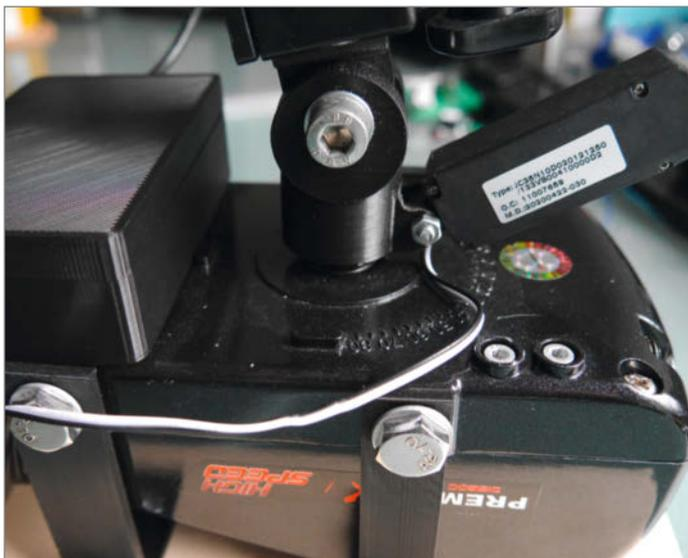
Montiertes Gelenk am Prototyp
