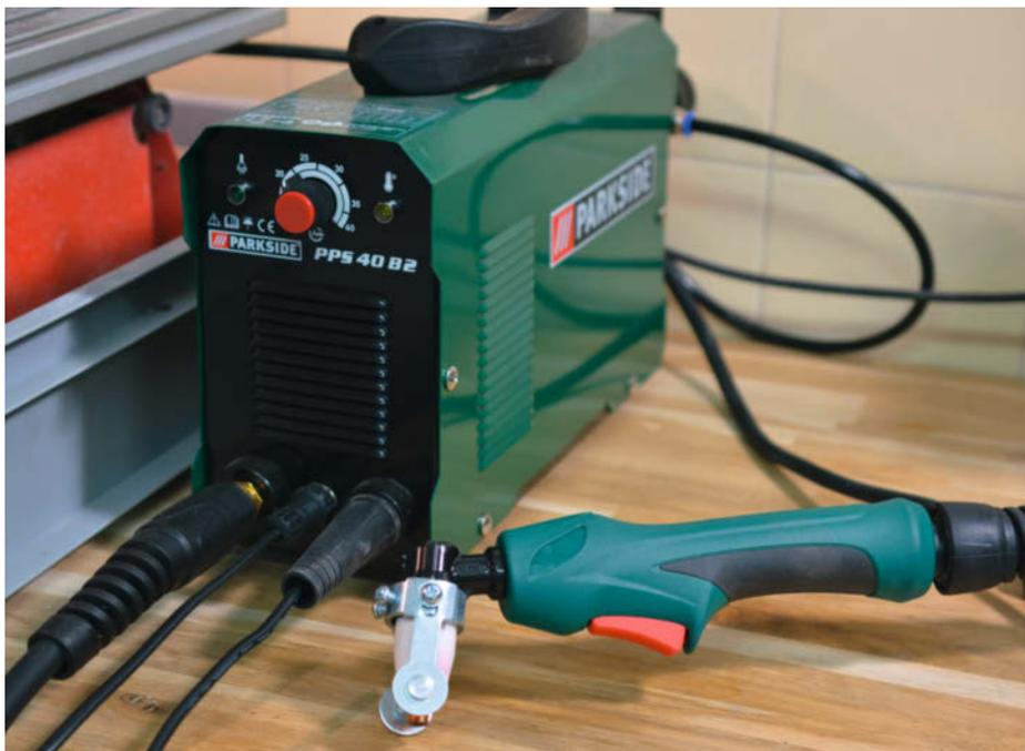
Dem Discounter-Angebot von Lidl liegt ein praktischer Abstandshalter für gerade Schnitte bei, außerdem ist es schon mit einem Wasserabscheider ausgestattet.
