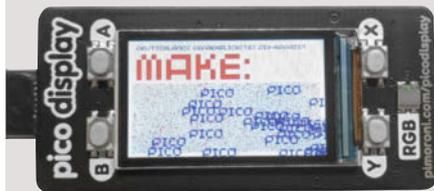
Das Pico-Display von Pimoroni ist 1.14" klein (25mm × 15mm), aber dank eines 240 × 135 Pixel großen IPS-LCD mit 18-Bit-Farben auch fein. Hat der eigene Raspberry Pico schon eingelötete Header-Pins, so steckt man das Display einfach auf, die Ausrichtung ist auf dem Board gekennzeichnet. Weiterhin bietet das Board noch vier Buttons und eine RGB-LED.
