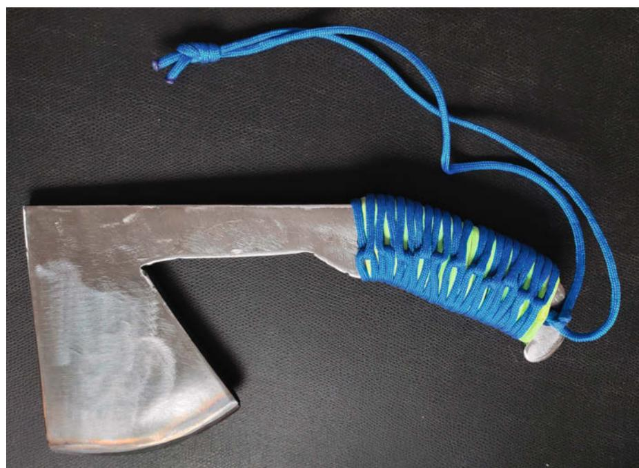
Fertige Axt: Die Schneide wurde durch Auftragsschweißen erzeugt und auf einen Winkel von 30° geschliffen.
