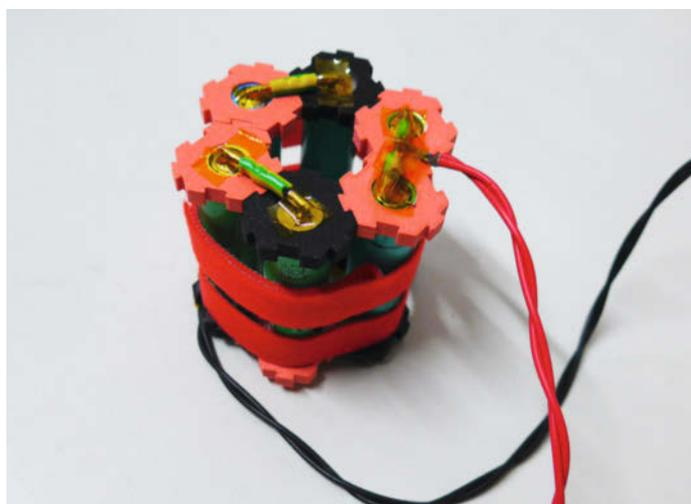
3S2P-Akku mit selbstgedruckter Halterung
