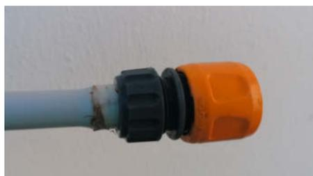
Mit etwas Isolierband passt die Schlauchkupplung auf das dickere Ende des Elektrorohrs.
