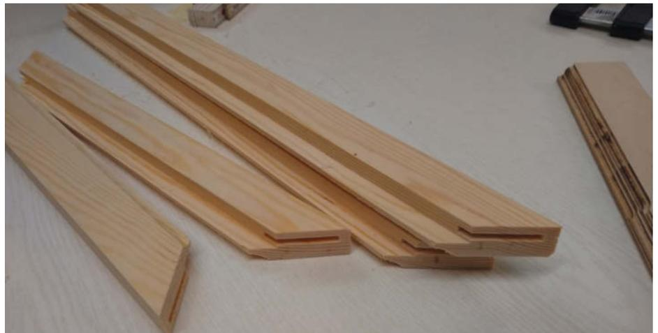
Die Rahmenleisten werden mit Flachdübeln verstärkt.
