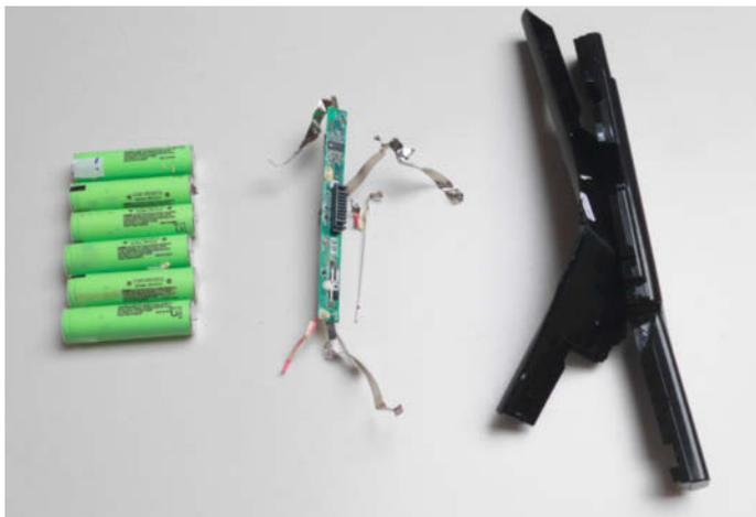
Die ausgebauten Zellen, Ladeelektronik und Plastikgehäuse
