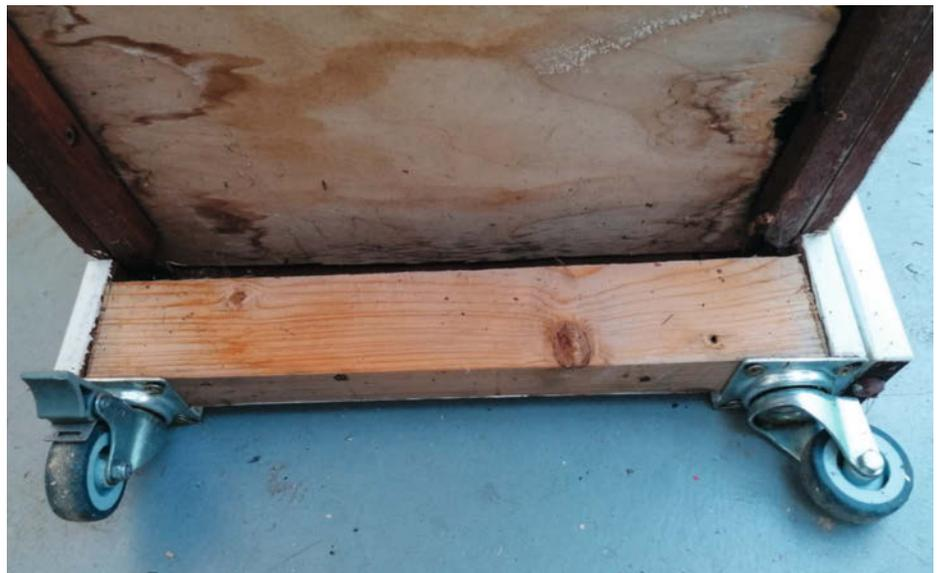
Bodenplatte und Verstärkung für die Rollen (mit Gebrauchsspuren nach 7 Monaten Außendienst)
