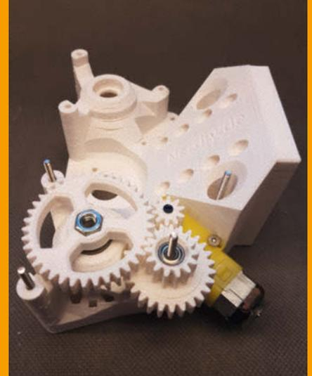
Das erste von zwei Getrieben des Bremsaktors. Auch Teile des Generators sind 3D-gedruckt, beide Elemente werden später zusammengefügt.
