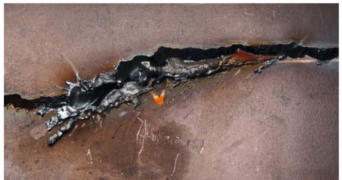
Treten Funken senkrecht aus, führt man den Brenner zu langsam. Gut erkennbar ist die große Menge an geschmolzenem Material an der Unterseite.
