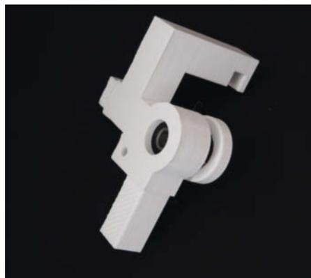
3 In die hinteren Eckstücke müssen die Kugellager hineingedrückt werden, bis sie am Anschlag anliegen.
