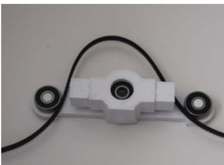
8 Beim Mittelstück die Kugellager und Riemen vor dem Zusammenbau einsetzen.
