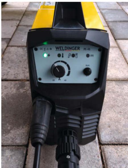
Das PS45 pro hat an der Front einen Schalter zum Öffnen des Druckluft-Ventils im Inneren – dies vereinfacht das Einstellen des Drucks an der Wartungseinheit.
