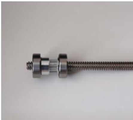
2 Positionieren Sie das Zahnrad so, dass die Spindel 4mm aus dem linken Kugellager herausragt.
