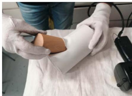
Rohr mit Heißluftpistole über und unter dem Schlitz erhitzen und den Keil einschieben.
