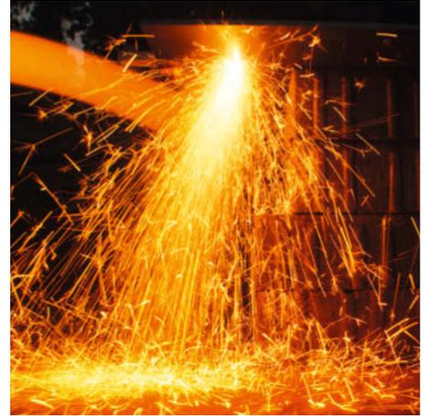
Optimal ist beim Schnitt ein leicht schräger Funkenaustritt. Der Brenner bewegt sich hier nach rechts.
