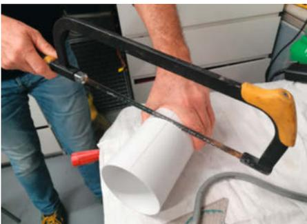
Mit einem flexiblen Lineal die Sägemarkierung anzeichnen und sägen, bis das Sägeblatt ganz verschwindet.
