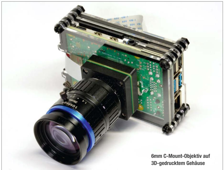
6mm C-Mount-Objektiv auf 3D-gedrucktem Gehäuse
