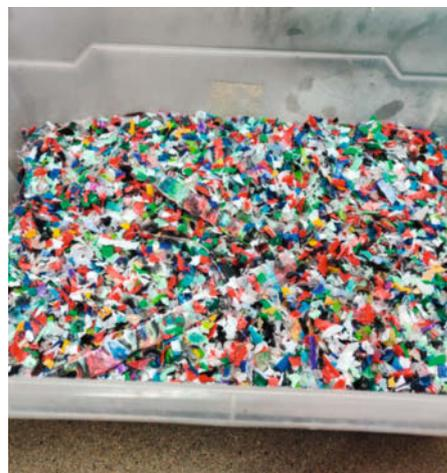
**Das zerkleinerte Material ist zu Flakes geworden.**
