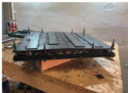
Die Form ist nun fertig mit Federn verschraubt und kann in den Ofen geschoben werden.
