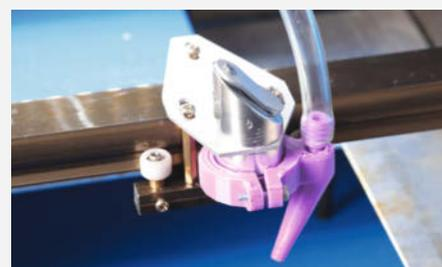
15 Wenn der Schlauch einer solchen Airassist-Düse nicht am Schneidkopf befestigt ist, kann er den Linsenhalter oder den ganzen Kopf lösen.
