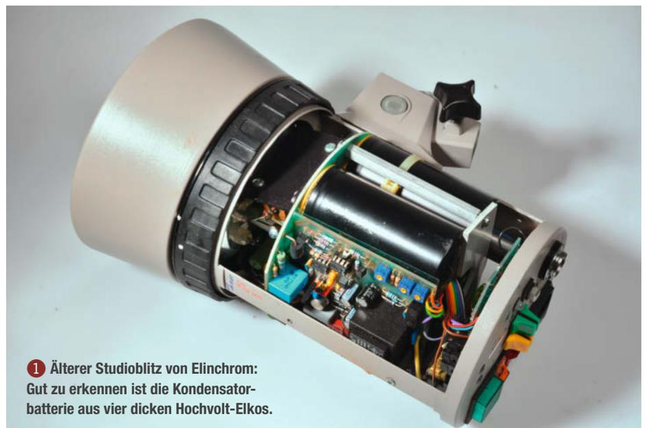
**1** Älterer Studioblitz von Elinchrom: Gut zu erkennen ist die Kondensatorbatterie aus vier dicken Hochvolt-Elkos.
