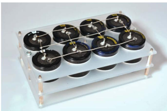
3 Unser erster Kondensatorbank-Entwurf passte leider nicht in das vorgesehene Stroboskop-Gehäuse – das Prinzip wird aus der Abbildung trotzdem klar: Oben der Minus-Anschluss, unten Plus sowie die Anzapfung in der Mitte.
