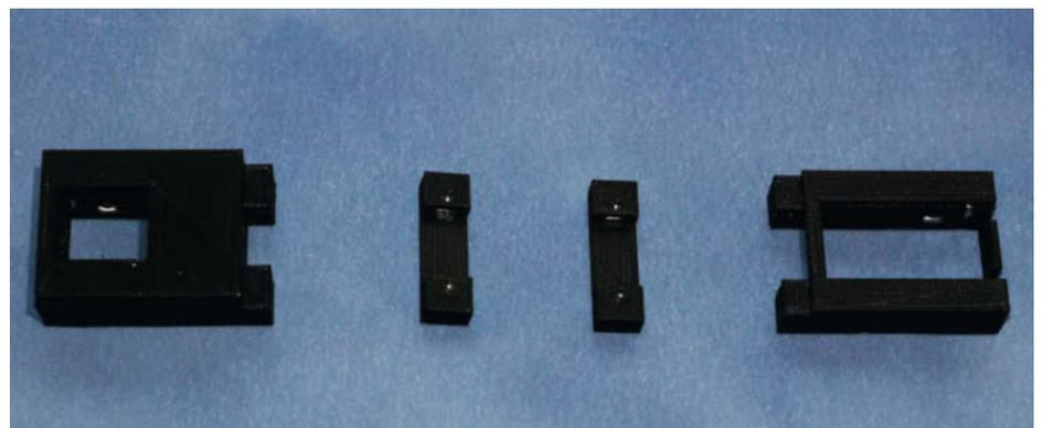
5 Die 3D-Druckteile für das Gehäuse
