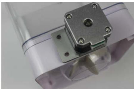
13 Den Halter parallel zur Plastikante ausrichten und die Bohrlöcher anzeichnen.
