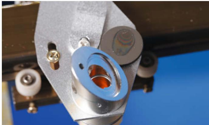
6 Der Spiegel aus dem Schneidekopf mit deutlich sichtbaren Ablagerungen
