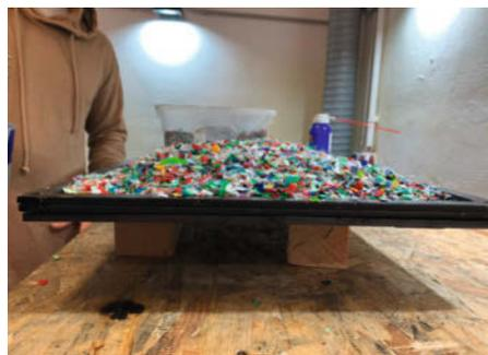
Die Flakes bilden einen kleinen Berg. Sie sollen sich im Ofen gleichmäßig verteilen und keine Luftblasen hinterlassen.
