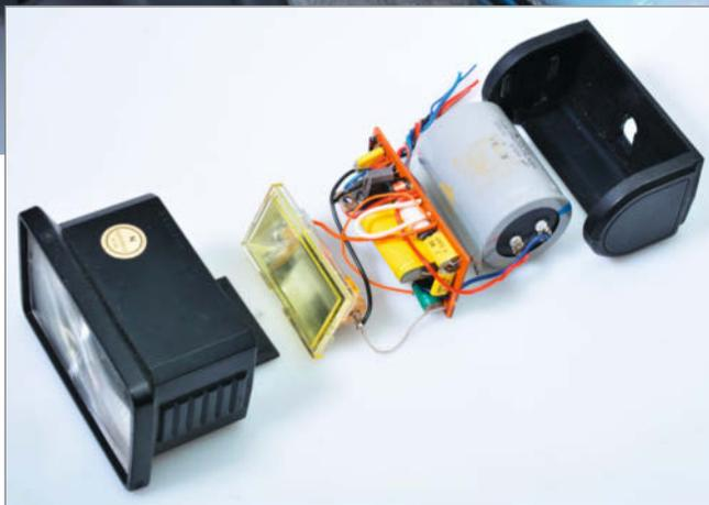
1 Kopfteil eines Automatik-Blitzes mit Blitzröhre (im Reflektor), Thyristor-Platine und Blitzkondensator
