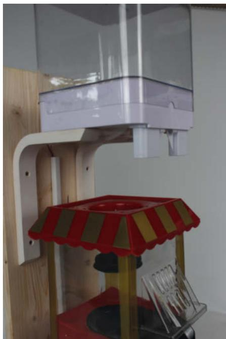
15 Der Ausgang des Spenders muss genau über dem Einfüllloch liegen.
