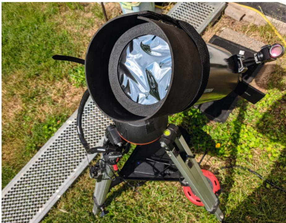
Sonnenfilter am Teleskop. Die Folie darf nicht straff sein und sie ist so dünn, dass die Falten optisch keine Rolle spielen.
