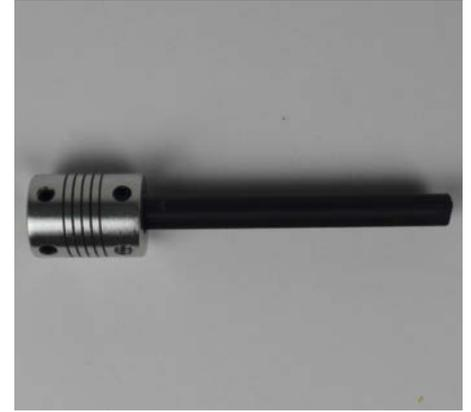
**9** Steckt die Achse zu tief in der Kupplung, kann diese später nicht mehr federn und so Ungenauigkeiten nicht mehr ausgleichen.
