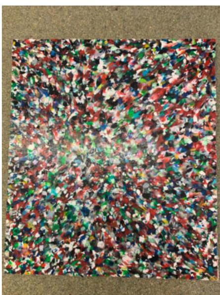
Fertiges Sheet. Die Oberfläche glänzt unabhängig vom Blickwinkel leicht.
