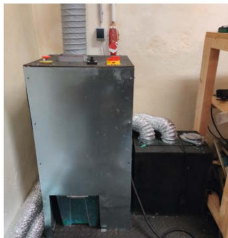
**Motorbetriebener Schredder. Darunter steht eine Kiste als Auffangbehälter.**
