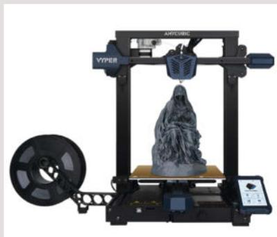
Auf den ersten Blick bietet der *Anycubic Vyper* nicht viel anderes als andere günstige FDM-3D-Drucker: einen Bauraum von 24,5cm × 24,5cm × 26cm, einen Bowden-Extruder mit maximaler Hotend-Temperatur von 260 °C und Filament-Sensor, ein bis 110 °C heizbares Druckbett mit Level-Automatik sowie einen 4,3-Zoll-Touchscreen zur Steuerung am Gerät.
