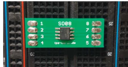
6 Ein SMD-MOSFET auf einer Adapterplatine für Breadboards
