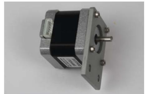
**12** Die Schrauben des Motorhalters nur leicht anziehen, sonst wird das Gewinde beschädigt.
