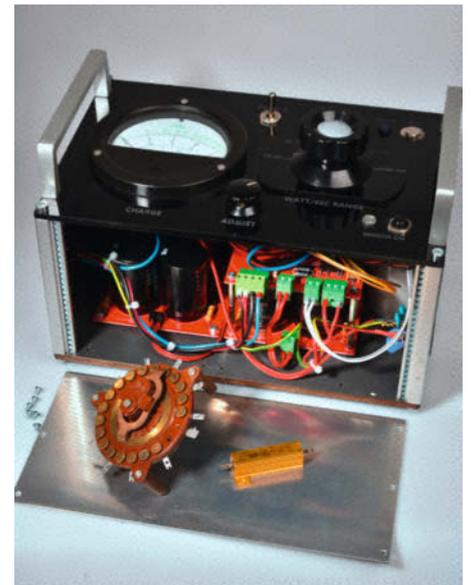
8 Um verschiedene Blitzköpfe einsetzen zu können, haben wir Ladeschaltung und Kondensatorbank bei einem zweiten Mustergerät als „Blitzgenerator“ in einem separaten Gehäuse aufgebaut. Vorn der verwendete Schalter aus unserem Fundus zur Umschaltung der Kondensator-Bänke und der 50W-Hochlastwiderstand R1.
