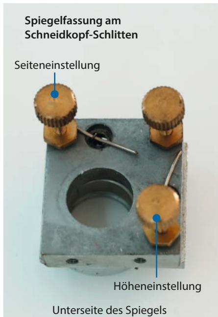
13 Die Schrauben beim Spiegel auf dem Schneidkopfschlitten
