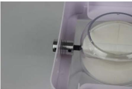
**10** Achten Sie darauf, dass die Bohrung groß genug ist und die Kupplung nicht schleift.
