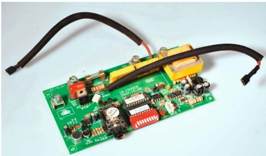
2 Die Stroboskop-Elektronik wird bis auf die enthaltene Zündspule (hier bereits ausgelötet, Platinaufdruck „TRGL“) nicht mehr benötigt. Aus dem einzelnen Anschluss links kommt der Hochspannungsimpuls.
