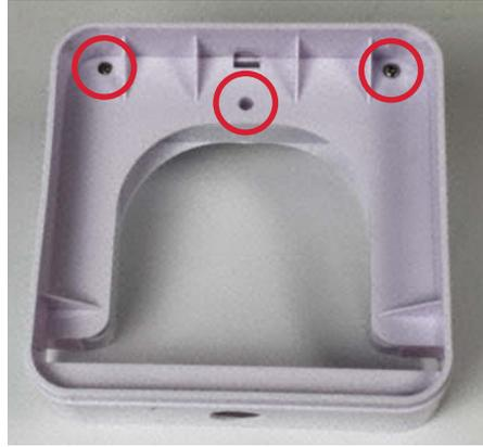
**8** Diese drei Schrauben müssen raus. Dadurch kann man später den Mais-Vorratsbehälter zum Reinigen abnehmen.
