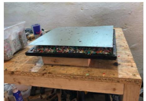
Vor dem Einfüllen der Flakes wurden die Bleche mit Silikonspray beschichtet, damit sich das fertige Sheet gut von der Form lösen lässt.
