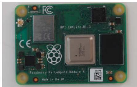
**1** Das Compute Module 4, ein nackter Raspberry ohne Anschlussbuchsen
