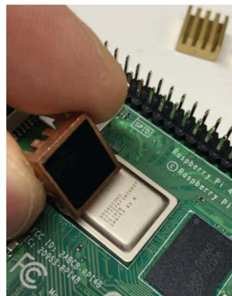
Kühlkörpermontage mit speziellem Klebeband: Befestigung und Wärmeweiterleitung in einem
