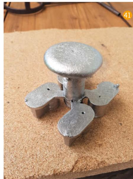
schwimmt, kann man diese nun mit einem Metall-Löffel abschöpfen. Die Qualität des Gießprozesses wird durch Schlacke aber in der Regel wenig beeinflusst. Sie bleibt im Tiegel zurück oder schwimmt oben auf.
