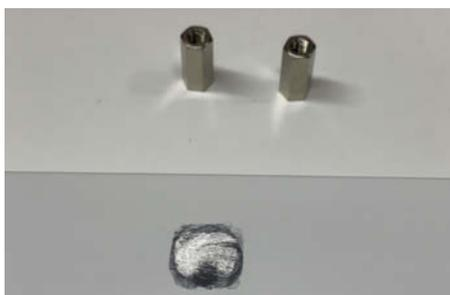
Die Klebung gelingt am besten, wenn man das Werkstück zuerst anschleift.
