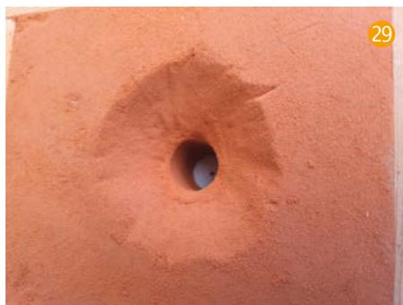
und die Form dann mithilfe von Schrauben in den Stempel hineingezogen. Dadurch bleiben die inneren Strukturen der Rolle sauber in der Sandform.
