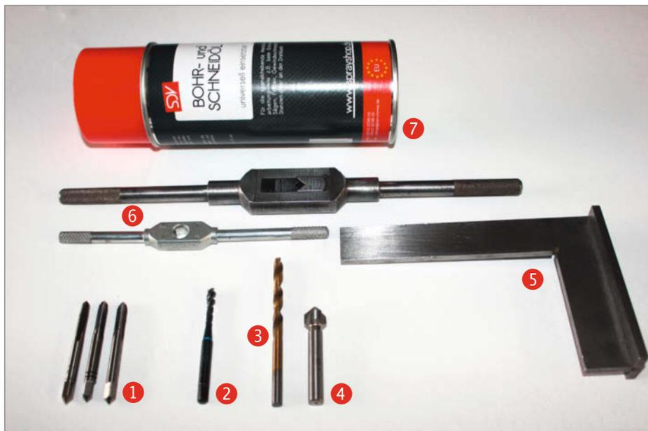
nur einem Ring am Schaft. Diesen führen wir in das Bohrloch ein und drehen ihn mit dem Windeisen zwei bis drei Umdrehungen in das Bohrloch. Dabei wird er vermutlich „wie ein nasser Kuhschwanz“ hin und her wedeln. Unsere Aufgabe ist es jetzt, den Gewindebohrer immer wieder in die Senkrechte zu bringen. Das Wedeln wird normalerweise immer kleiner, je tiefer wir im Bohrloch sind.
