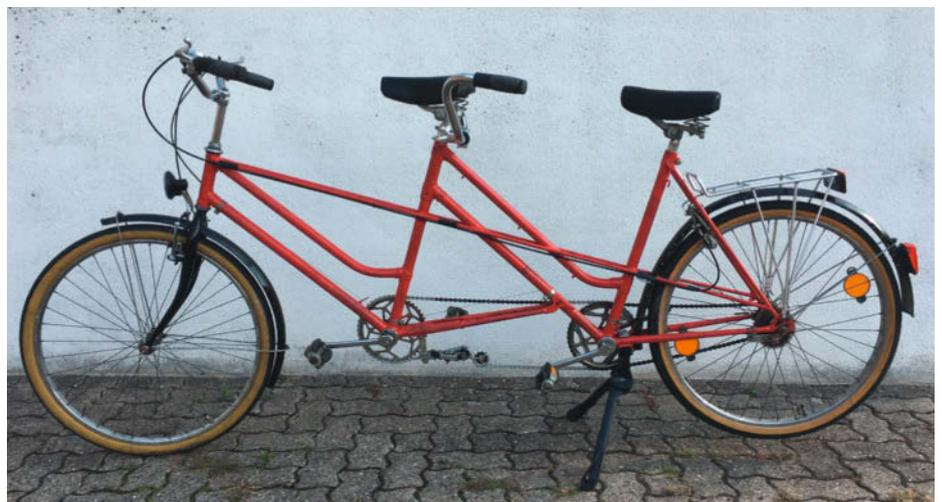
16 Gesamtansicht des fertigen Tandems. Gut zu erkennen ist die durch ein ausgedientes Schaltwerk gespannte Synchronkette.
