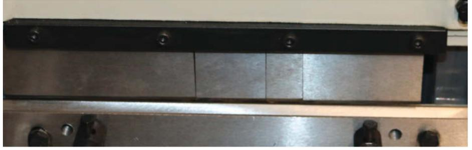
4 Bei dieser Biegevorrichtung für freies Biegen sind die einzelnen Segmente gut zusehen.
