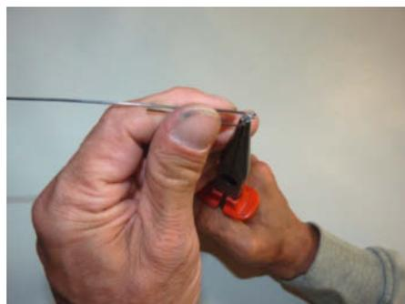
7 Durch diese Öse wird später das Oberteil gefädelt. Der kurze Drahtabschnitt hält das Nasen-Pad.
