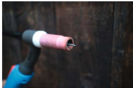
Das WIG-Verfahren nutzt eine nicht abbrennbare Wolfram-Elektrode, die immer gut gespitzt sein sollte. Zusatzwerkstoff wird per Hand zugeführt.
