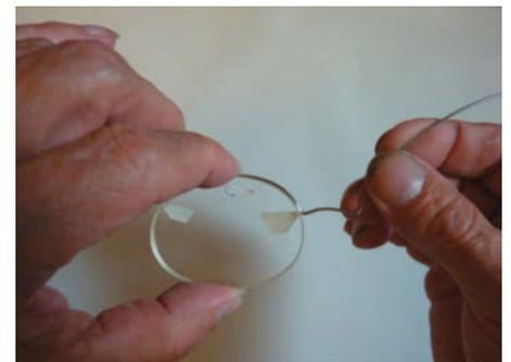
**4** Draht formen direkt an den Gläsern: Da der Draht ja später in der Nut der Gläser liegt, wäre eine Umrisszeichnung hier zu ungenau.
