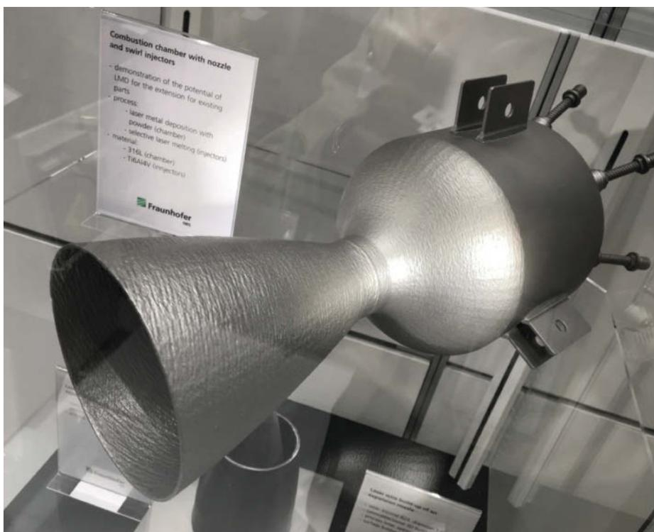
3D-gedrucktes Triebwerksteil vom Fraunhofer IWS, zu sehen auf der 3D-Druck-Messe Formnext 2018
