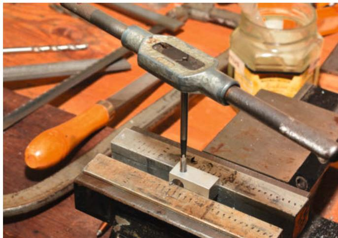
Beim Gewindeschneiden auf einen senkrechten Ansatz des Gewindebohrers achten. Alle zwei Umdrehungen eine halbe Umdrehung zurück, damit die Späne brechen. Auch hier hilft Spiritus für ein müheloses Schneiden.
