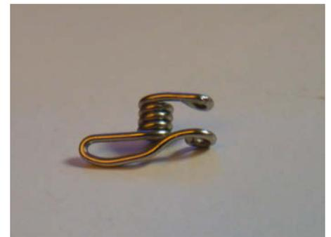
13 Links der Bügelansschlag, rechts die Ösen für die Verschraubung von Ober- und Unterteil
