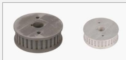
Schrumpfende Teile: Vom Grünteil (links) bis zum fertigen Metallteil (rechts)
