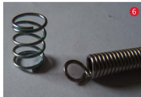
Überdehnen der Feder in Längsrichtung können die Windungen mehr oder weniger auseinander gezogen werden, um eine Druckfeder **4** zu erhalten. Die Schenkelfeder **5** hat nur wenige Windungen und gestreckte Enden.
