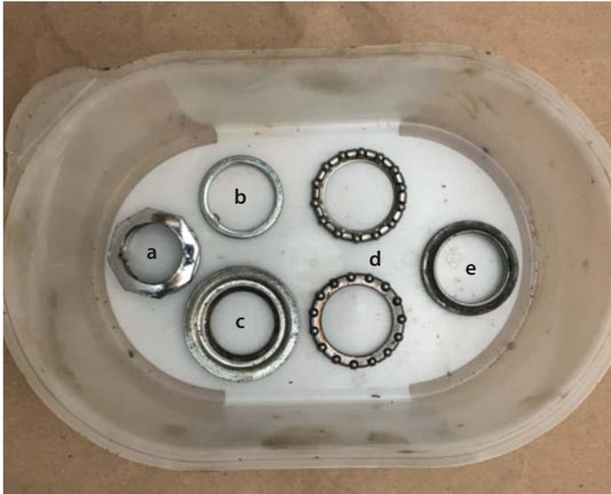
**7** Die Einzelteile der demontierten Gabelhalterung, übersichtlich in einer Kunststoffschale: Abschlussmutter (a), Nasenscheibe (b), Gewindekonus (c), Kugelhalter (d), Gabelkonus (e)
