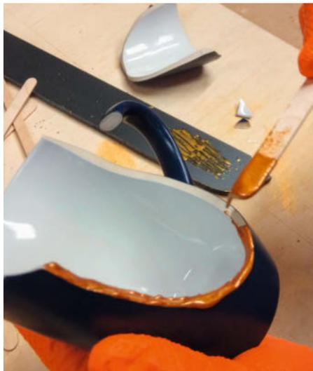
Klebmasse auf die Bruchstelle auftragen.
