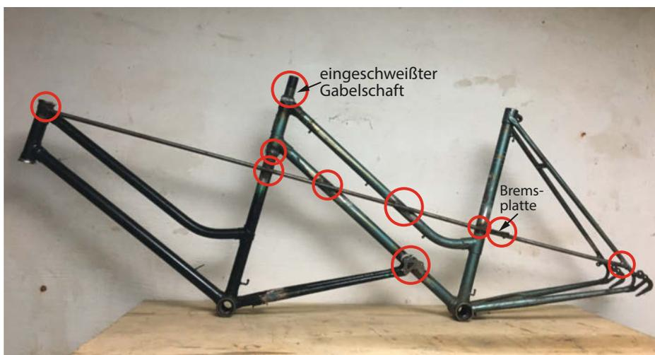
5 Die verschweißten Rahmen mit dem eingeschweißten Gabelschaft und der angeschweißten Bremsplatte, die später leider entfernt werden musste. Alle Schweißstellen sind rot markiert.
