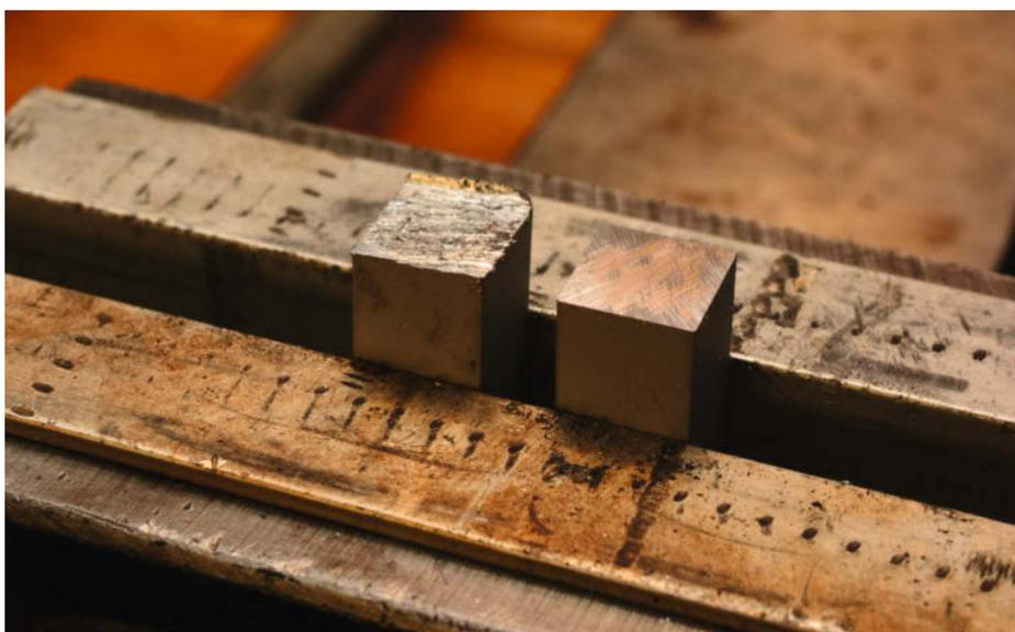
Handsägeschnitte sind rau und selten maßhaltig (links). Nach dem Feilen sieht die Sache anders aus (rechts); in der Struktur der Oberfläche erkennt man noch die zwei Feil-Richtungen. Zum Schutz der Werkstücke haben wir in unseren Schraubstock Alu-Winkel eingelegt.
