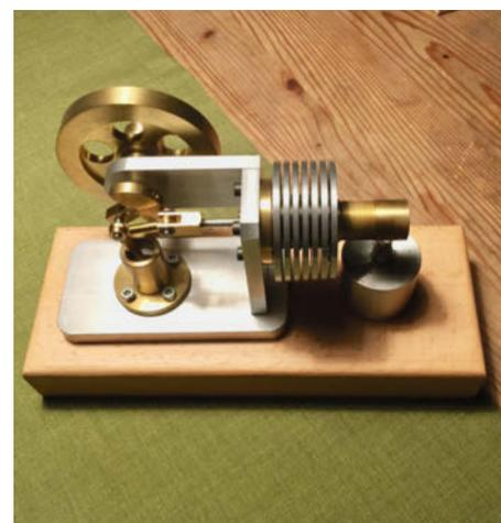
9 Selbst gebauter Heißluftmotor – für solche Projekte braucht man eine Drehbank und eine Fräsmaschine.
