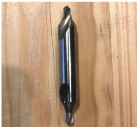
Der Zentrierbohrer ermöglicht exaktes Bohren ohne Ankörnen.
