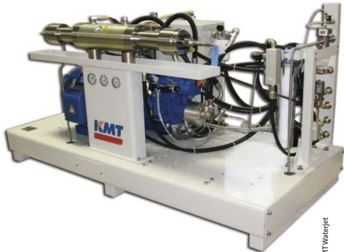
Teuer, weil High-Tech: Hochdruckpumpe und Druckübersetzer mit rund 4000 bar für eine Wasserstrahl-Schneideanlage.
