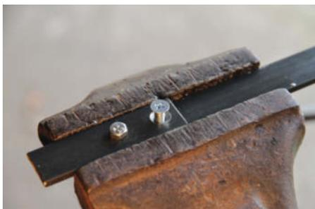
Die Senkung sollte etwas größer als der Schraubenkopf sein, damit die Schraube komplett versinkt.
