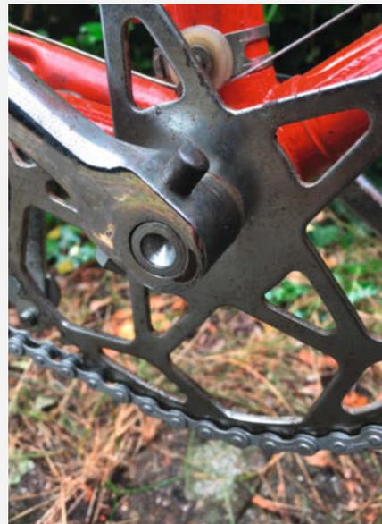
Tretkurbelbefestigung mit Keilen; die ausgebauten Keile sind auf Bild 8 bei (e) zu sehen.
