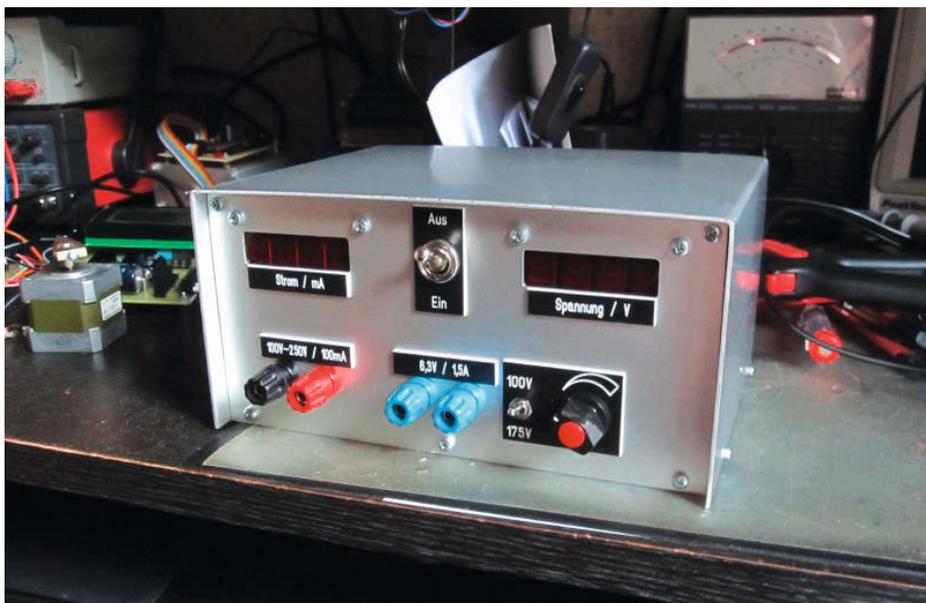
15 Röhren-Netzgerät-Gehäuse aus zwei U-förmig gebogenen Blechen
