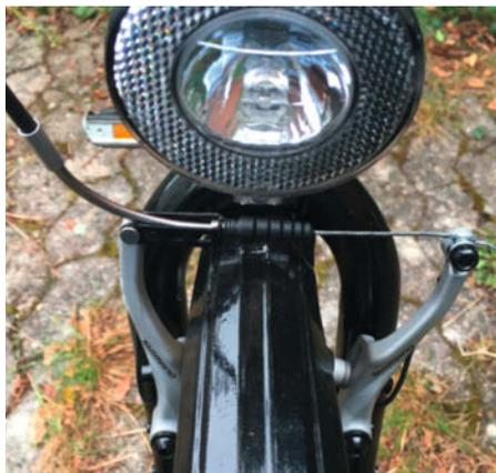
**19** Cantileverbremse an der Vorderradgabel
