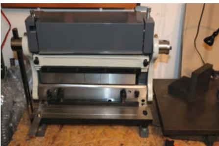
7 Eine 3in1-Kombi-Vorrichtung fürs Schneiden, Kanten und Rollen von Blechen
