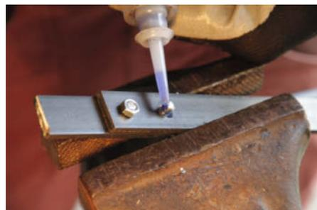
Der Einsatz von Schraubensicherungslack lohnt sich bei jeder Verschraubung.
