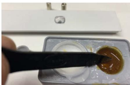
Hier wird zum Beispiel Metall mit Zwei-Komponenten-Epoxidkleber auf Metall geklebt.
