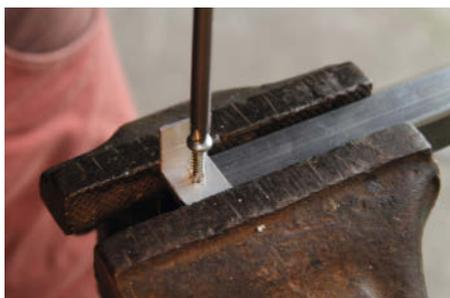
Der Gewindeschnitt passiert während der Verschraubung.
