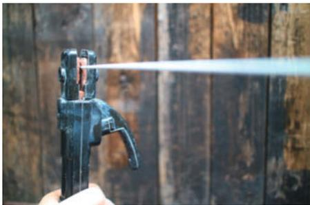
Beim E-Hand-Verfahren wird eine wunderkerzenartige, abbrennende Elektrode in ein Handstück geklemmt.
