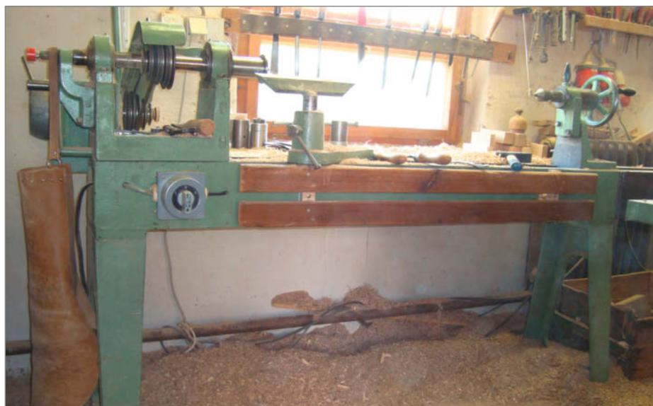
**10 Auch eine Drechselbank, die ausschließlich Holz bearbeiten kann, ist eine Drehmaschine.**
