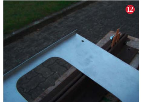
Die überstehende Blechkante kann nun mit leichten Hammerschlägen über die Kante des Winkelprofils getrieben werden **9**. Um Schlagmarken zu vermeiden, verwendet man ein Stück Hartholz als Hilfsmittel. Die Abkantung erfolgt in mehreren Durchgängen längs der Kante **10**, bis der freie Schenkel des Bleches am Schenkel des Winkelstahls anliegt **11**.
