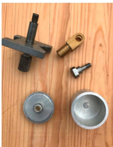
1 Typische, auf einer Drehmaschine hergestellte Teile
