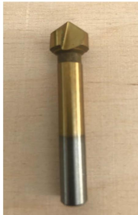
Der Senkbohrer dient zum Entgraten und zum Versenken des Bohrlochs, um Senkkopfschrauben aufzunehmen.
