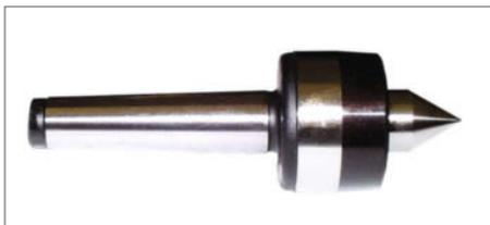
**6** Bei einer mitlaufenden Zentrierspitze findet die Drehung und damit die Reibung nicht in der Zentrierbohrung sondern im Lager der Spitze statt.
