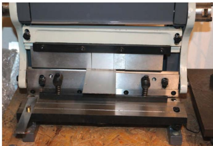
**1** Blech in die Biegemaschine eingelegt und ausgerichtet
