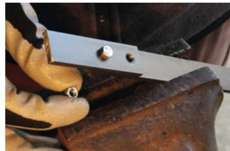
M5-Schraube mit Sechskantkopf und passender Kontermutter verschrauben.
