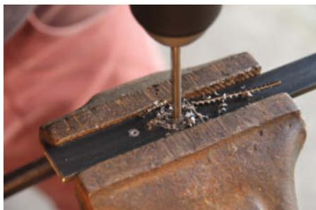
Zunächst muss man vorbohren, um eine optimale Schraubverbindung zu erhalten.
