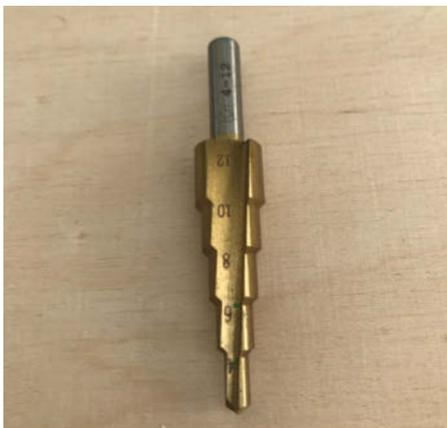
Ein Stufenbohrer zum Aufweiten eines Bohrlochs
