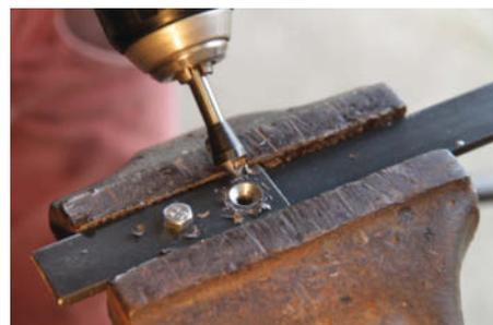
Mit dem Senker eine passend große Senkung für den Senkschraubenkopf schneiden.
