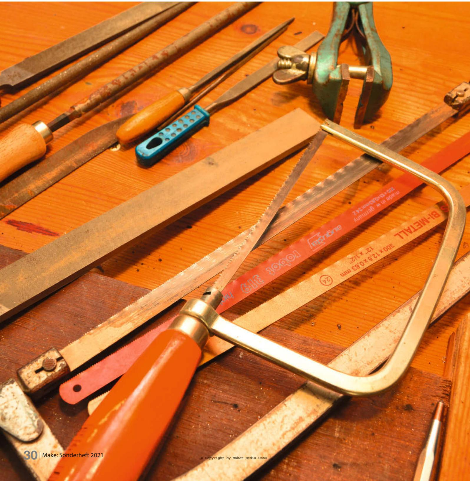
**Z**u den ersten Lernschritten in der Laufbahn von Schlossern, Metallbauern und Feinmechanikern gehört der Umgang mit Feile und Säge. Unser kurzer Artikel kann natürlich nicht die anstrengenden Lehrjahre in einer Metaller-Werkstatt ersetzen, in denen oft wochenlang an einem einzigen Werkstück gefeilt und gesägt wird, aber er wird Sie in die Lage bringen, diese elementaren Fertigkeiten für kleinere Projekte erfolgreich einzusetzen.
