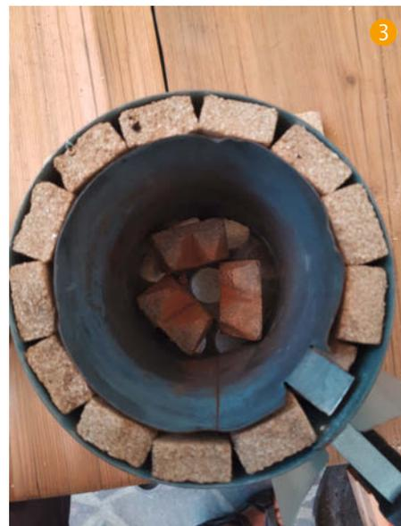
Streifen isoliert, die wir aus einer Platte zurechtschneiden. Die Längsseiten der Streifen kann man noch etwas anschrägen (Gewölbeprinzip), sodass sie beim Einfügen in den Grillkamin bündig abschließen. Alternativ wird die Isolierung innen mit Blech, zum Beispiel einem Stück Ofenrohr, ausgekleidet, damit die Isolierstreifen nicht nach innen fallen können. Eine Wandstärke von ca. zwei Zentimetern ist als Dämmschicht vollkommen ausreichend.
