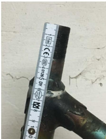
4 Der in das Sattelrohr des vorderen Rahmens eingeschweißte Gabelschaft schaut als Stutzen für den vorderen Sattel und hinteren Lenker hervor. Der Stutzen ist hier noch zu lang, er wurde auf 4cm gekürzt.
