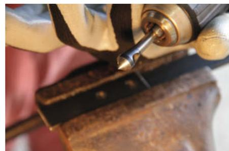
Dann entfernt man mit einem 90°-Kegelsenker den Grat vom Bohrloch.
