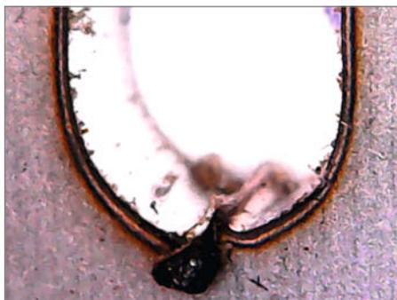
An der Unterseite bildet sich ein kleiner Grat von ausgeblasenem Material, hier als dunkler (oxidiertes) Streifen erkennbar. An der Einstichstelle (unten im Bild) entsteht ein etwas größerer Grat.
