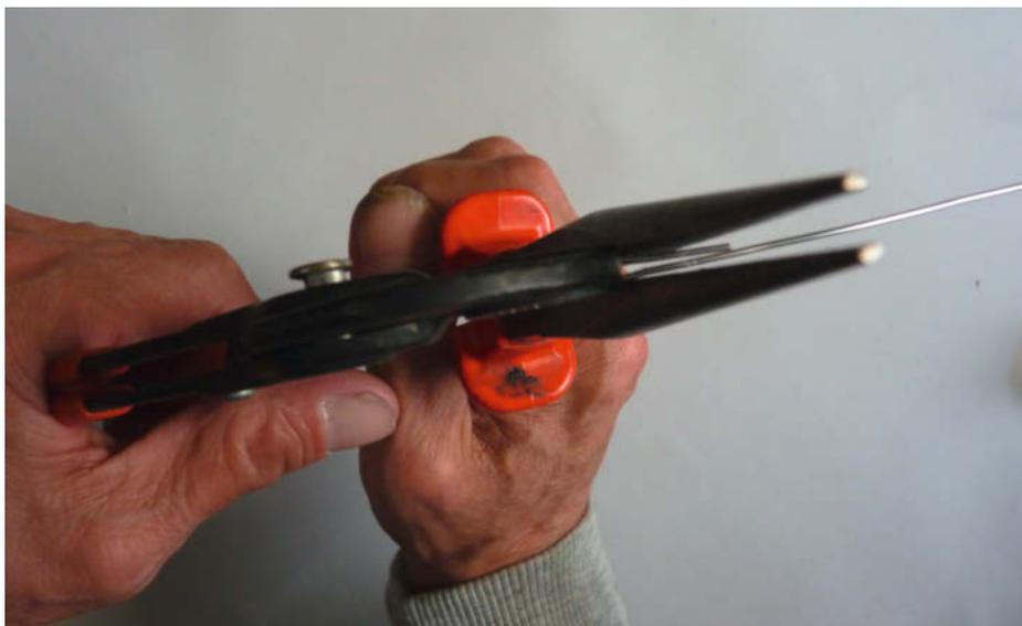
14 Um die beiden Drahtenden richtig zusammenzubringen, sind Rohr- und Spitzzange im Einsatz.
