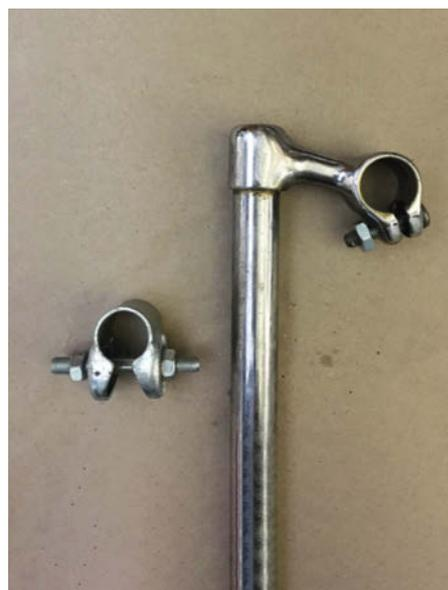
**12** Lenkerhalterung mit langem Vorbau: An ihr wird nicht nur der hintere Lenker befestigt, sondern auch der vordere Sattel. Mit der linken Schelle wird die Halterung am angeschweißten Stutzen „festgeknallt“.
