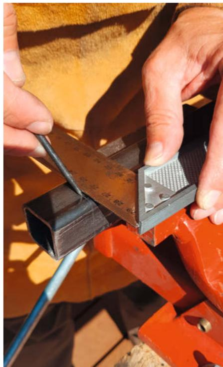
**6** Mit der Reißnadel markiert man die Trennlinie, an der das Profil abgeflex werden soll.
