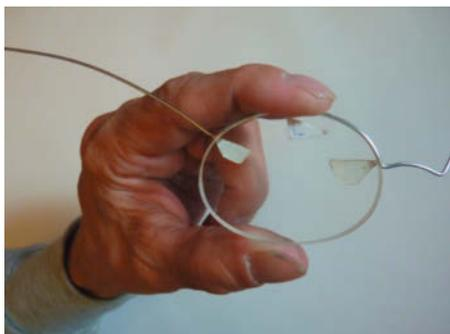
5 An der Stelle, wo der Draht die Nut verlässt, darf kein Spalt entstehen, sonst sitzen später die Gläser locker.
