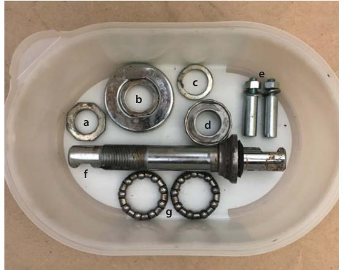
**8** Die Einzelteile des Tretlagers: Kontermutter (a), Staubschutzdeckel (b), Nasenscheibe (c), Gewindekonus (d), Befestigungskeile (e), Tretlagerwelle (f), Kugelhalter (g)
