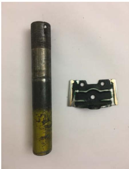
3 Kleinteile zum Anschweißen: Links der von einer Gabel abgesägte Schaft, rechts die vom Hinterbau des ersten Rahmens herausgeschnittene Bremsplatte zur Montage der Felgenseitenbremse hinten
