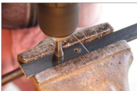
Die gratfreie Bohrstelle ist optimal für Schraubverbindungen.
