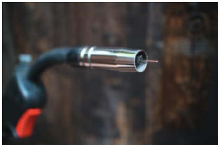
Durch das Schlauchpaket eines MAG-Brenners wird ein Schweißdraht transportiert, dazu Schutzgas aus der Schweißdüse.
