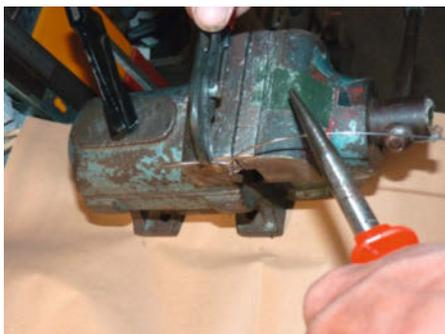
6 Für die kleine Schlinge des Unterteils am Steg braucht man etwas Kraft und einen Schraubstock zum Halten.
