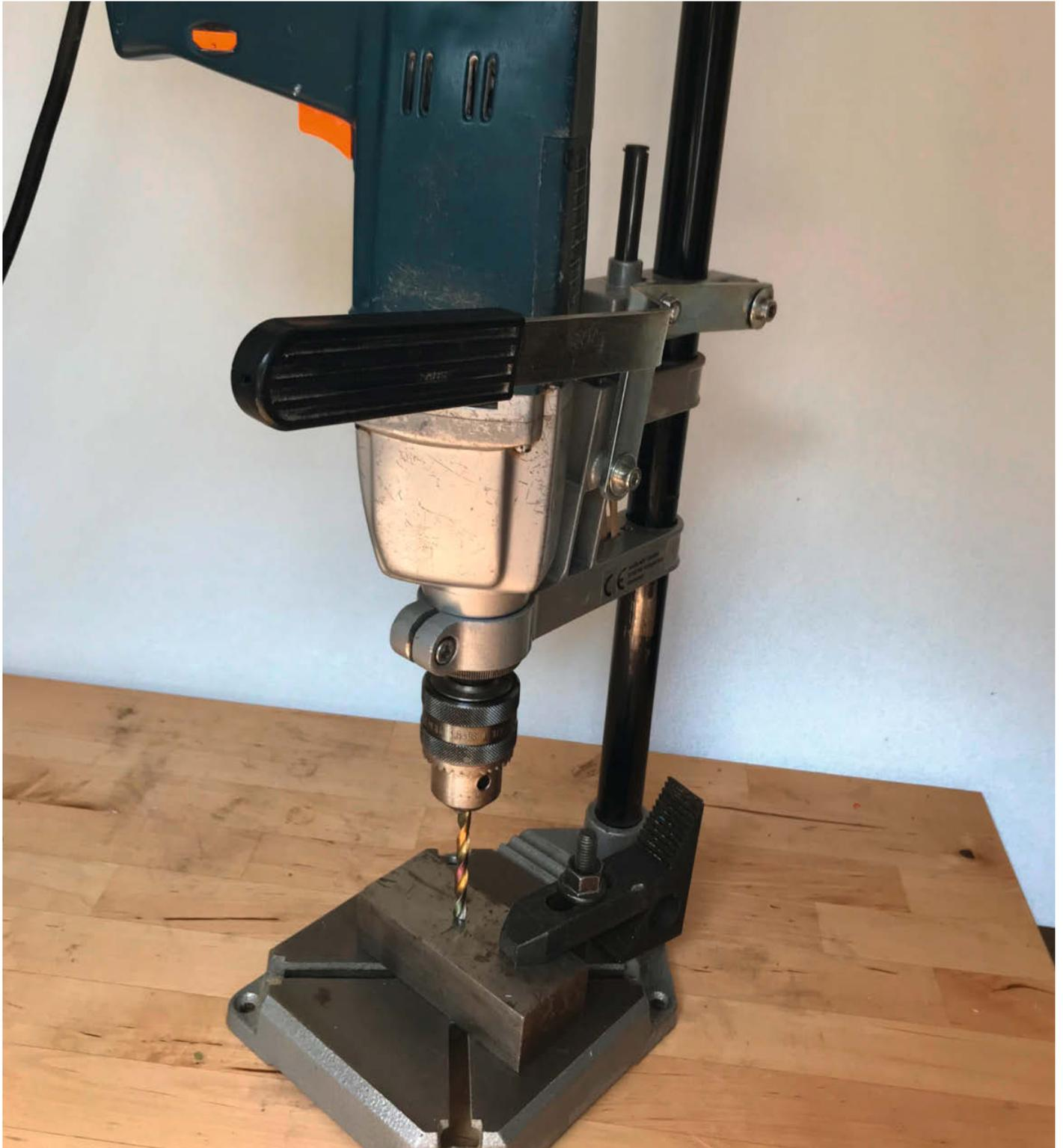
**W**ir gehen im Artikel davon aus, dass es sich bei den zu bearbeitenden Metallen um Aluminium, Messing oder Stahl handelt. Dies sind die im Maker-Bereich häufig verwendeten Metalle. Um ein Loch manuell exakt zu bohren, muss man es auf der Oberfläche des Werkstücks zunächst genau anzeichnen. Gibt man dem Metallbohrer dann noch ein wenig Führung, kann er nicht so leicht abrutschen und die Löcher lassen sich auf einen Zehntelmillimeter genau bohren.
