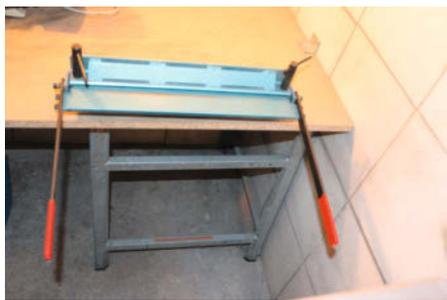
9 ... und im geöffneten Zustand, bereit zum Einspannen des Werkstücks.
