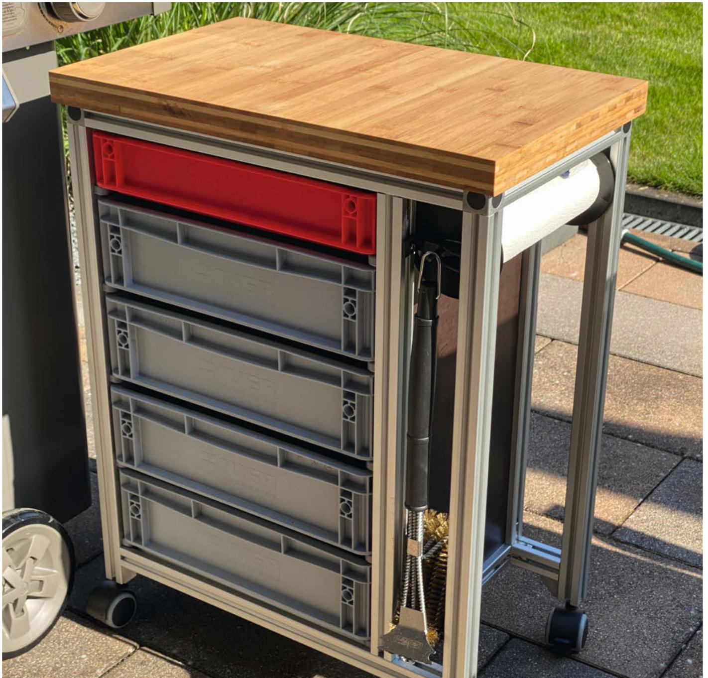
Mit den klassischen Konstruktionsprofilen aus Aluminium, landläufig auch *Bosch-Profile* genannt, kommt man schon ganz schön weit: Rahmen, Kästen, Gestelle, selbst komplexe Konstruktionen sind dank standardisierter Verbindungselemente kein Problem. Ihren Ursprung haben diese Profile in der Industrie. Dort werden die Profile als eine Art Baukasten verwendet, um Prüfplätze, Maschinengestelle und sogar ganze Fertigungslinien ① zusammenzubauen und diese immer wieder anpassen zu können.
