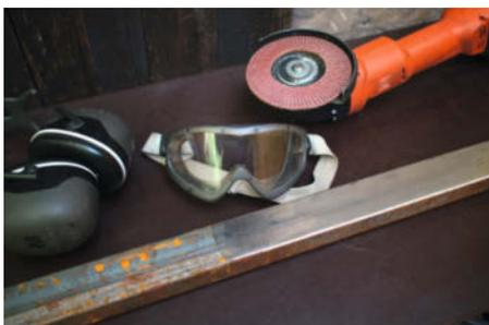
Vor dem Schweißen sollte beschichteter oder rostiger Stahl erst blankpoliert werden, z.B. mit einer Fächerscheibe am Winkelschleifer. Ohren- und Augenschutz ist Pflicht.
