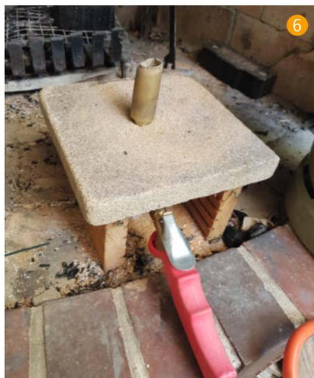
andererseits strömt zu viel kalte Luft durch den Kamin und der Tiegel wird nur ineffizient geheizt. Im hier verwendeten Aufbau hat sich ein Abstand von ca. 3mm zwischen Tiegelfwand und Isolierung bewährt. Die Feinregulierung des Luftstroms erfolgt über das Drosselventil des Brenners.
