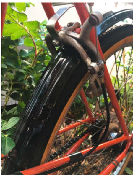
**10** Die Hinterradbremse ist an ihrem angestammten Ort angebracht. Besser wäre es, wenn man die ursprünglich an der Versteifung vorgesehene Bremsplatte hätte nutzen können, damit der Bowdenzug linear verläuft.
