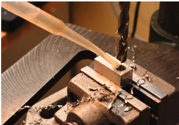
Beim Bohren von Aluminium gibt man für ein besonders riefenarmes, glattes Ergebnis ein paar Tropfen Spiritus auf Bohrer und Bohrloch. Beim 6mm-Loch eine geringe Geschwindigkeit wählen, sonst rattert der Bohrer.
