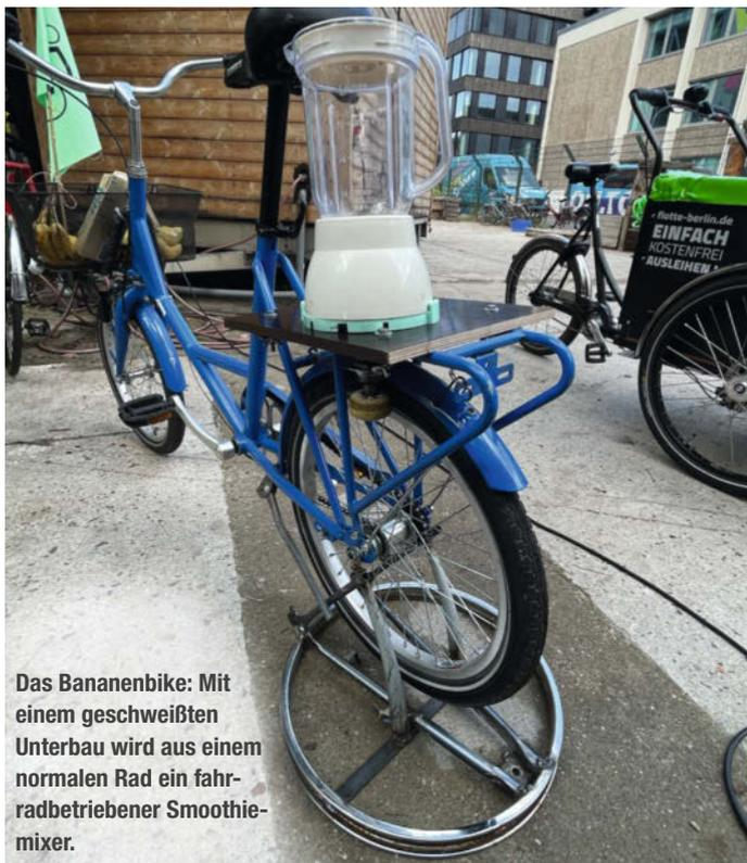
Das Bananenbike: Mit einem geschweißten Unterbau wird aus einem normalen Rad ein fahradbetriebener Smoothie-mixer.
