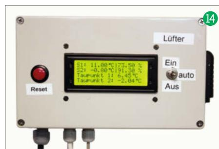
der Lüfter angesteuert wird oder wie groß der Abstand von Ein- und Ausschaltzeitpunkt sein soll, damit der Lüfter nicht dauernd an- und gleich wieder abgeschaltet wird.
