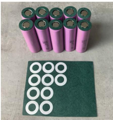
10 Fish-Paper (Isolierpapier) schützt zusätzlich die Plus-Pole der Zellen.
