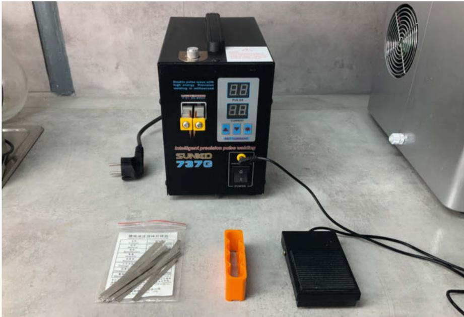
9 Das Schweißgerät Suunko 737G: Ausgelöst wird der Schweißvorgang mit dem Fußtaster (rechts vorn).
