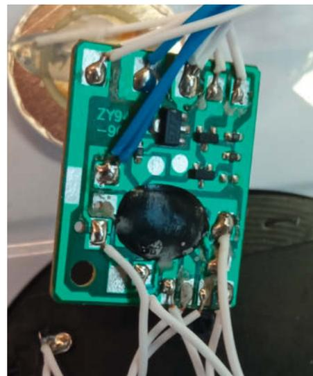
**Die Steuerelektronik: Der Motor des Unterkiefers wird über den Transistor (oben in der Mitte) direkt vom Contoller-Chip (unter der Vergussmasse) angesteuert.**
