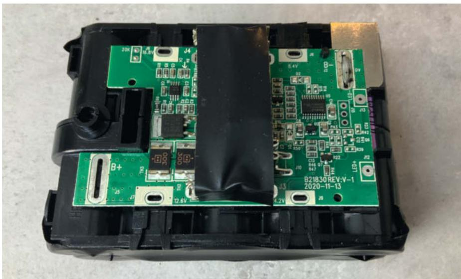
16 Unter dem schwarzen Isolierband verbergen sich die Kontaktklemmen des Akku-Packs. Hier kommt es leicht zu Kurzschlüssen bei Berührung mit Werkzeug.
