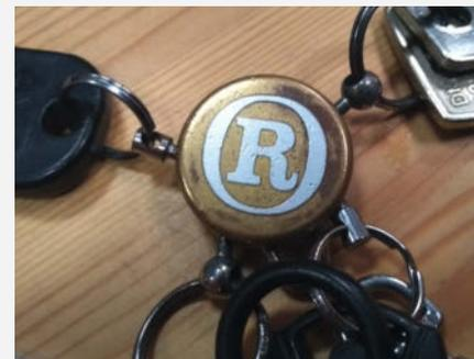
Spannende zweifarbige Ergebnisse entstehen bei beschichteten Metallen.
