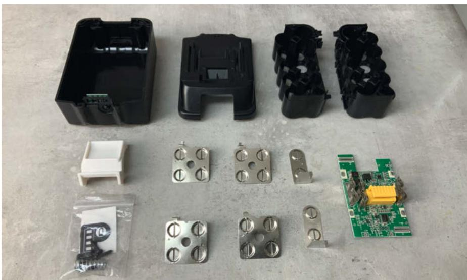
8 Leergehäuse mit Bauteilen: Hier sind Bleche zum Schweißen bereits dabei.
