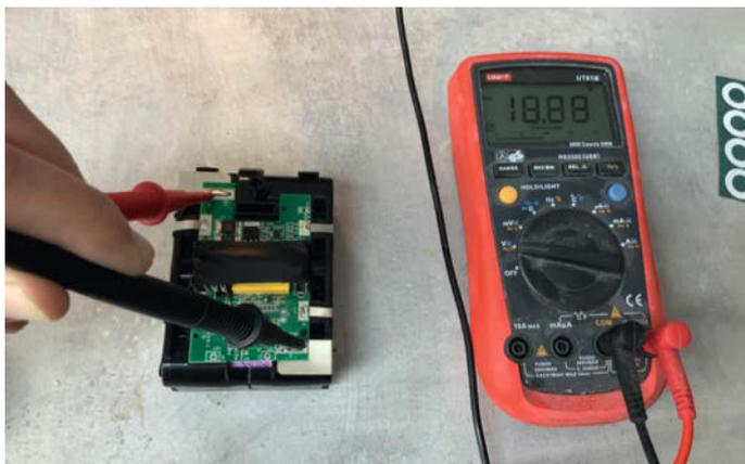
17 Komplett bestückt und verdrahtet sollte man die Nenn-Spannung des Packs messen können.
