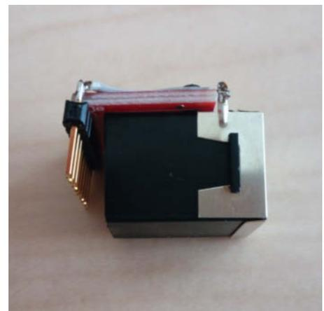
In das RJ45-Breakout-Board für den Empfänger wird die Stiftleiste leicht schräg eingelötet.
