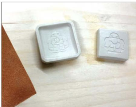
Bereits nachbearbeiteter 3D-Druck mit glatter Oberfläche
