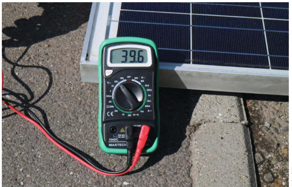
Messung der Leerlaufspannung mit Multimeter an Standardmodul
