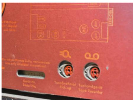
DIN-Buchsen („Diodenbuchsen“) an einem alten Röhrenradio: Am Tonabnehmer-Eingang kann – gegebenenfalls mit einem Adapter – das Signal des Bluetooth-Moduls zugeführt werden.
