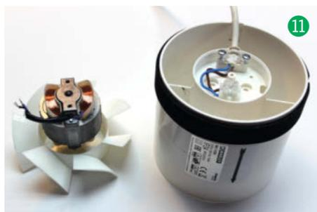
Testbetriebs zeigten sich nämlich unregelmäßig Systemabstürze, jedenfalls solange der Lüfter angeschlossen war – ohne ihn blieben die Abstürze aus. Es sieht somit danach aus, dass der Lüfter unregelmäßig Störungen zum Arduino sendet, obwohl durch das Relaismodul eine galvanische Trennung besteht.
