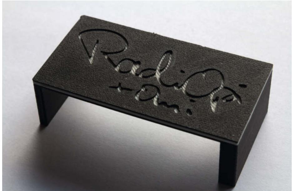
Mit Filamentwechsel gedruckte Abdeckung für einen guten Kontrast
