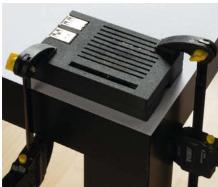
Das Gehäuse wird zusammengeklebt.
