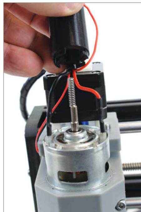
15 Wenn man den Magnet auf die Achse legt und die Feder darauf, kann man beides leicht ins Gehäuse einfädeln.
