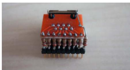
Beim Sender werden zwischen der Stiftleiste und dem RJ45-Breakout-Board Serienwiderstände eingelötet.
