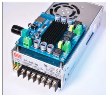
Mit einem Schaltnetzteil erreicht man einen sehr kompakten Aufbau, der sogar in Regalboxen passt. Bedenken Sie, dass ein zweiter Lautsprecher aus genannten Gründen über Kabel an den Verstärker der ersten Box angeschlossen werden muss.
