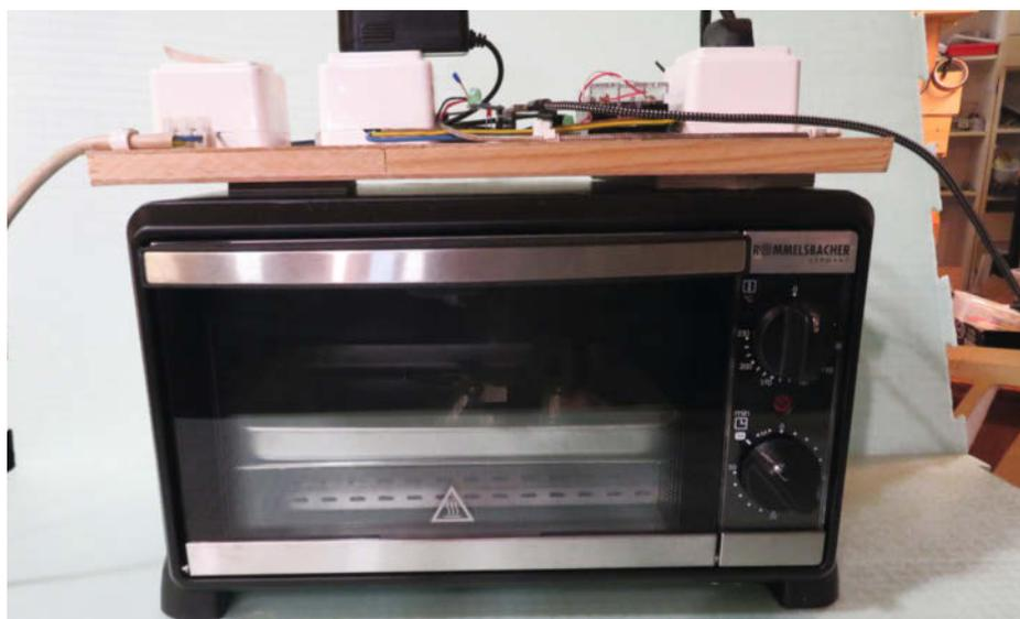
So sieht der Mini-Backofen aus, den wir mit wenigen Maßnahmen zu einem Reflow-Ofen mit Browser-Fernsteuerung umbauen.
