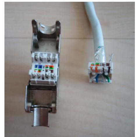
Wenn die Adern korrekt in den Kunststoffeinsatz eingefädelt sind, wird dieser auf das Modul gesteckt und durch Zusammendrücken des Gehäuses die Adern gecrimpt.
