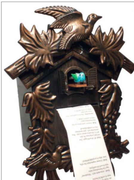
Kaum zu glauben, die ersten Projekte mit dem Raspberry Pi erschienen erst in den Ausgaben 3/13 und 4/13. Hier der Druckkuck, der Tweets per Thermoprinter ausgibt.
