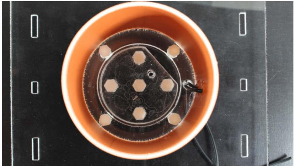
7 In diese ringförmige Nut passt die Sekundärspule, die ebenfalls eingeklebt wurde.
