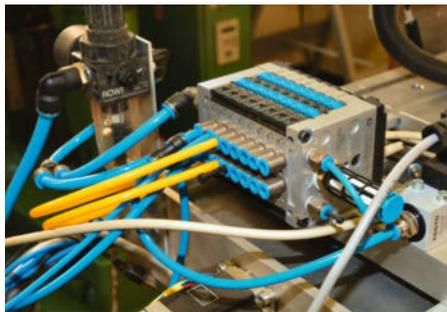
Festo-Ventilinsel CPV-10 in unserer Maschine, bestückt mit acht 5/3-Wege-Ventilen Mit den blauen Schiebern auf der Oberseite kann man die Ventile im Notfall oder zum Test auch von Hand betätigen.
