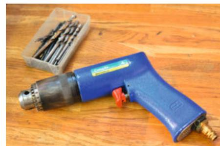
**Anwendung eines Druckluft-Motors in einer kleinen Bohrmaschine.**
