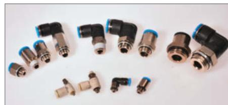
Steckverschraubungen zum Schlauchanschluss an Aktoren und Ventile: Vorn die kleineren metrischen Gewinde M3, M5 und M7, hinten die zölligen Ausführungen 1/8", 1/4" und 1/2" mit verschiedenen Dichtungen.
