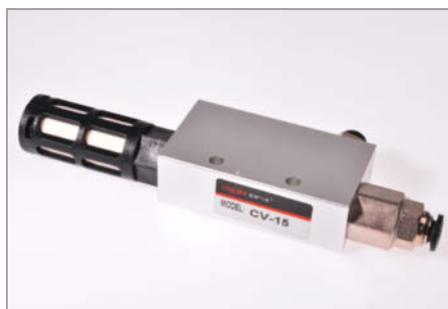
**Saugdüse als eigenständiges Bauteil:** Über ein Venturi-Röhrchen erzeugt sie aus Druckluft einen Unterdruck, oft benötigt zum Anheben von Verpackungsgut und Bauteilen mit Saugern. Die „verbrauchte“ Luft entweicht über einen Schalldämpfer.
