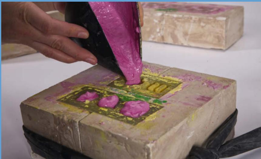
Einfüllen von Betonguss in die stabilisierten Latex-Formen
