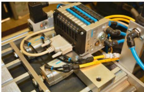
**Pneumatische Steuerung an einer CNC-Fräse:** Die von einem Arduino gesteuerte Ventilinsel gibt Druckluft für die luftgelagerte Spindel samt Werkzeugwechsler, die Werkstückeinspannung und die Minimalmengenschmierung frei.
