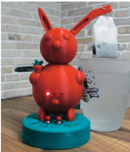
Eines der beliebtesten und häufig nachgebauten Projekte: Der Teehase. Sein Ohr tunkt in den Beutel Arduino-gesteuert ins Wasser.
