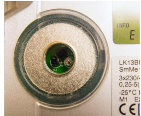
Der Metallring am Zähler zum Aufsetzen des Sensors. Deutlich sind die Empfangs- und Sendediode zu erkennen.
