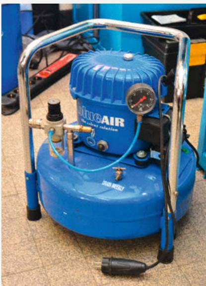
**Sehr leise Kompressoren arbeiten mit einem gekapselten Verdichter ähnlich dem Kältemittel-Kompressor in Kühlschränken. Links am Gerät erkennt man den Druckminderer mit Wasserabscheider.**
