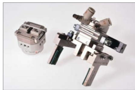
**Präzise Greifer und Drehantriebe gehören zu den teuren Bauteilen in der Handhabungstechnik.** Für den Maker lohnt hier nur der Gebraucht-Kauf.
