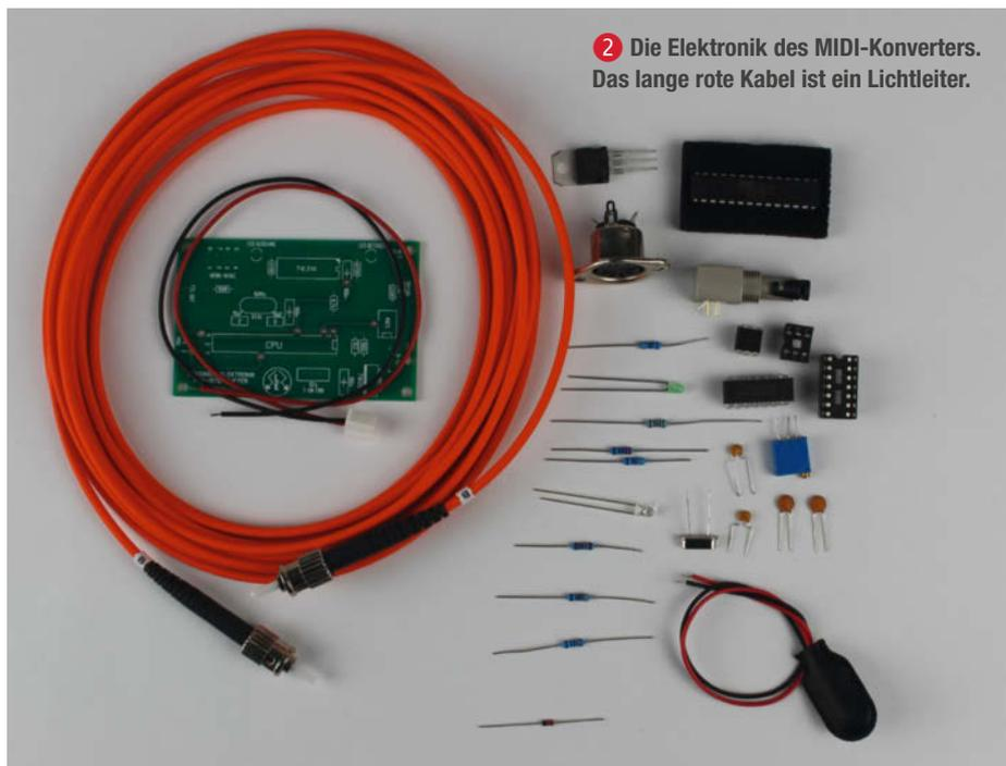
2 Die Elektronik des MIDI-Konverters. Das lange rote Kabel ist ein Lichtleiter.
