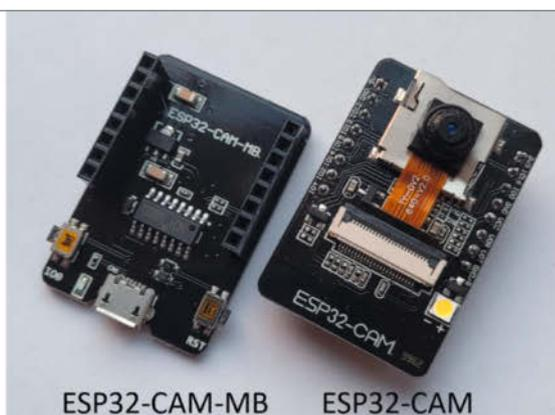
Die ESP32CAM lässt sich mit einem USB-zu-seriell-Konverter programmieren. Einfacher macht es das Development Board für die ESP32CAM, das eine Spannungsversorgung und einen Button für Pin 100 mitbringt.
