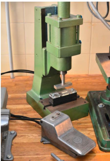
Pneumatisch betätigte Presse mit als Fußschalter ausgeführtem 4/2-Wege-Ventil: Unbetätigt wird der Kolben und der Pressstempel nach oben gedrückt. Der 80mm-Kolben liefert bei 6 Bar eine Kraft von rund 3000N.
