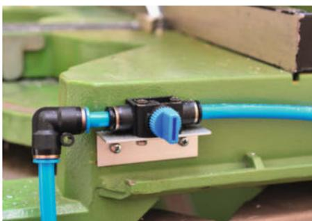
Handbetätigtes 3/2-Wege-Ventil an einer Aluminium-Kreissäge. Hier wäre auch ein reines Absperrventil ausreichend, da kein Aktor angeschlossen ist, sondern nur eine Luftdüse für die Nebelkühlleinrichtung.
