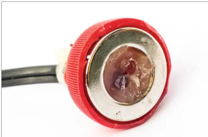
Unser Sensor besteht aus IR-Fototransistor, IR-LED und einem Ringmagneten in einem Getränkeverschluss, vergossen mit Heißkleber. Die Bauteile ragen noch minimal aus der Klebmasse heraus.
