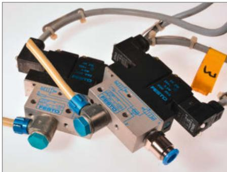
Einzelne, größere Mehrwege-Ventile werden elektrisch gern über Würfelstecker angeschlossen, die es in verschiedenen Standard-Größen und auch mit LEDs zur Anzeige des Schaltzustands gibt.
