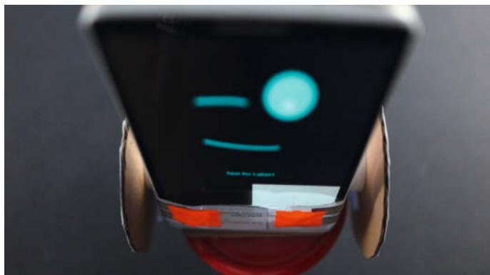
Unter dem roten Klebeband sitzen die Lichtsensoren, die auf die Helligkeit des Smartphone-Screens reagieren.
