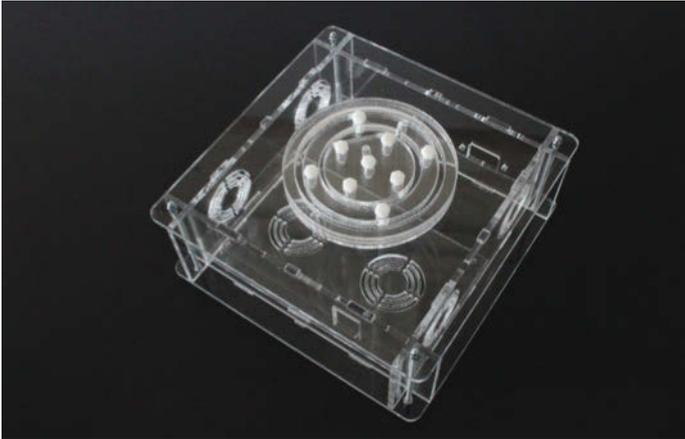
5 Beim Selbstbau-Plexiglas-Gehäuse wurde für gute Belüftung gesorgt. Oben die ringförmige Befestigung zum Einkleben der Primär- und Sekundärspulen.
