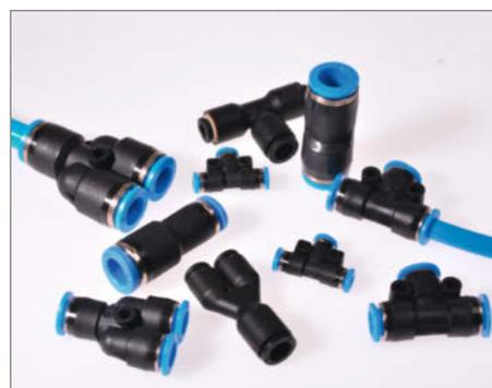
Außendichtende Pneumatik-Steckverbinder, die kompatibel zum Festo-QS-System sind, gibt es auch preiswert von Zweierherstellern. Die Steckverbindung kann durch beherzten Druck auf den (bei Festo immer blauen) Kunststoffring wieder gelöst werden.
