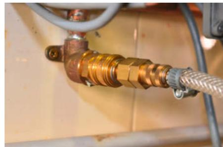
Bei Druckluft-Schnellkupplungen zum Anschluss an den Kompressor oder an ein Druckluft-Netz sind 7,2 und auch 5mm Nennweite (Innendurchmesser) gängig.
