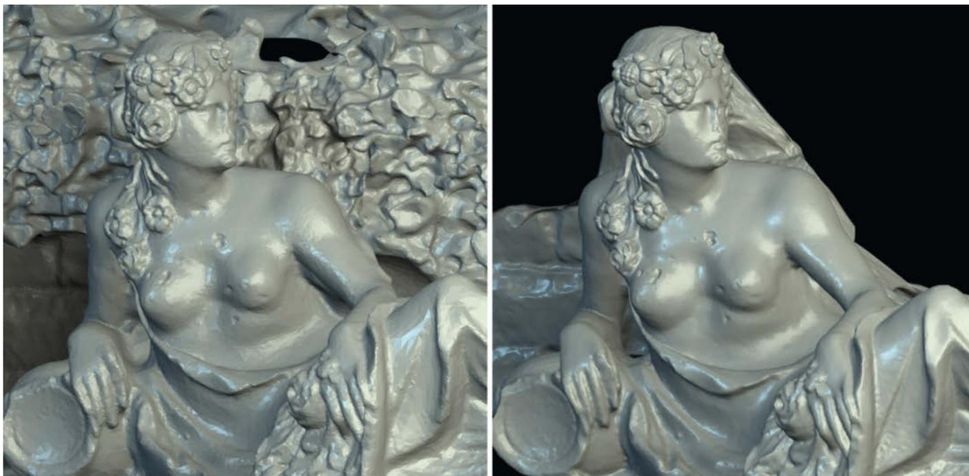
Unterschiedliche Photogrammetrie-Software kann aus identischem Bildmaterial durchaus unterschiedliche 3D-Ergebnisse erzeugen, etwa in Bezug auf die Grenzen des Modells oder die Oberflächengüte: Links die Rekonstruktion einer barocken Brunnenfigur durch 123D Catch vor rund zehn Jahren mit 330.000 Polygonen, rechts das Ergebnis der *OpenScan Cloud* von heute mit 200.000 Polygonen, aber glatterer Oberfläche.
