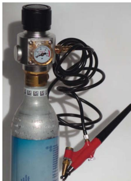
Auch eine Airbrushpistole funktioniert mit CO<sub>2</sub>.
