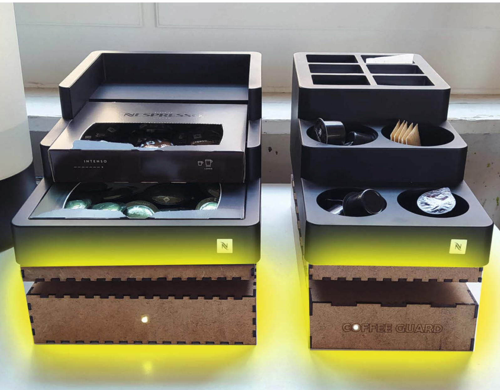
Das Zählen von Teilen über ihr Gewicht ist eine altbewährte Methode und wird auch in der Industrie rege benutzt, zum Beispiel beim Zählen von Schrauben, Unterlegscheiben oder ähnlichen Teilen. Die Herausforderung dabei besteht eigentlich einzig im Installieren einer genügend genauen Waage. Denn wenn die Genauigkeit nicht genügend fein ist, dann kann nicht zuverlässig gezählt werden. Logisch.
