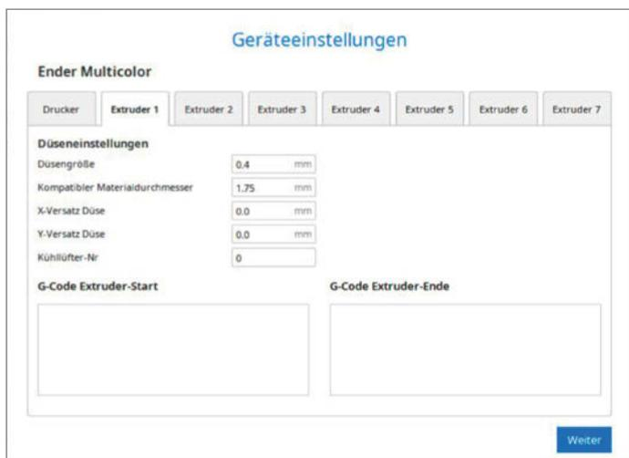
17 Der Filament-Durchmesser muss bei allen Extrudern 1,75mm sein.
