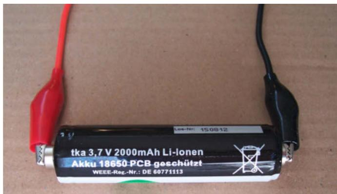
Mit Magneten lässt sich eine 18650er Zelle gut kontaktieren. Bei Lipo-Akkus ist besondere Vorsicht geboten!
