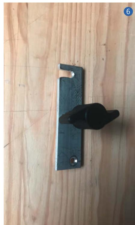
Anschließend befestigt man die *Auflage* auf der *Oberplatte*. Dazu wird sie an die geeignete Position gestellt (siehe Abbildungen 4 und 5) und man reißt dann die Schraublöcher an. Mit 1,5mm-Spiralbohrer vorbohren und anschließend mit Holzschrauben 2,5 x 15mm festschrauben.
