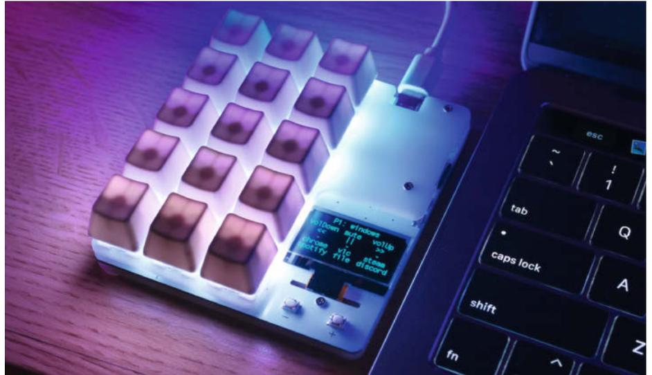
duckyPad als Ergänzung für einen Laptop: Das Display zeigt in fünf Zeilen die Belegung der 15 Tasten.
