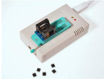
**Ausgelötete und bereits programmierte Chips lassen sich mit einem kleinen Programmiergerät wiederbeleben, etwa diesem TL866-II Plus für rund 60 Euro. Bestellen Sie die zu Ihrem Controller passenden Nullkraft-Fassungen gleich mit.**
