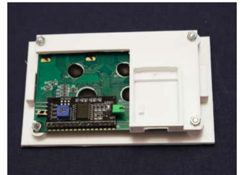
**6** Der Rahmen mit dem Halter für das ESP-Modul muss mit Muttern festgeschraubt werden.
