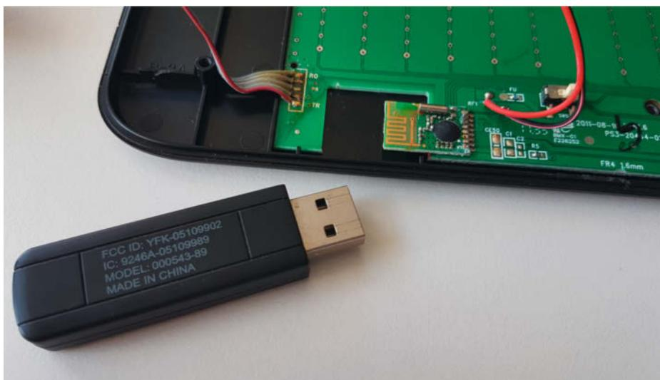
Das Funkmodul des Tablets und der Dongle tauschen Daten auf 2,4GHz aus.
