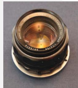
Bei diesem Fotoobjektiv ist die hintere Linse radioaktiv.
