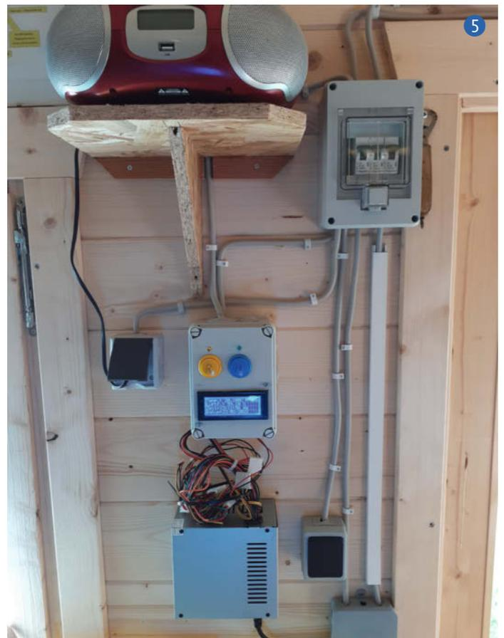
Eine Besonderheit ist noch im Zusammenhang mit der Ansteuerung der Relais zu beachten: Sie sind *Low-aktiv*, schalten also durch, wenn ein *Low*-Signal anliegt und sind im Ruhezustand beim Anliegen eines *High*-Signals. Angeschlossen sind übrigens alle vier Relais, obwohl bisher nur zwei genutzt werden.
