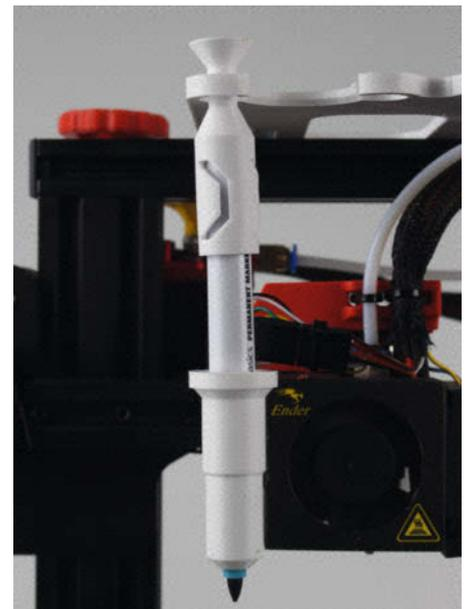
13 Der Stift darf in diesem Schritt die Halteöffnung nicht berühren, sondern muss genau in der Mitte stehen.
