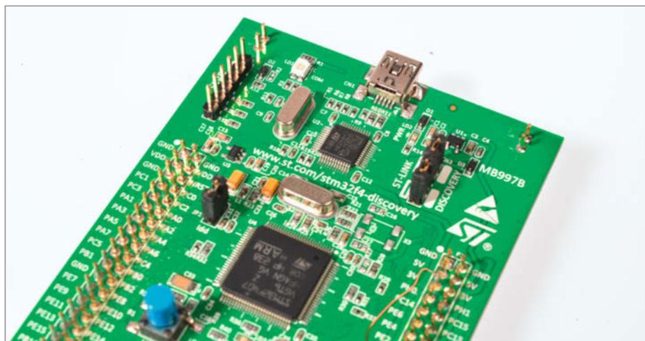
Programmer/Debugger für lau: Auf den Nucleo- oder Discovery-Boards von STM ist bereits einer enthalten, hier realisiert mit dem Chip unter der USB-Buchse.
