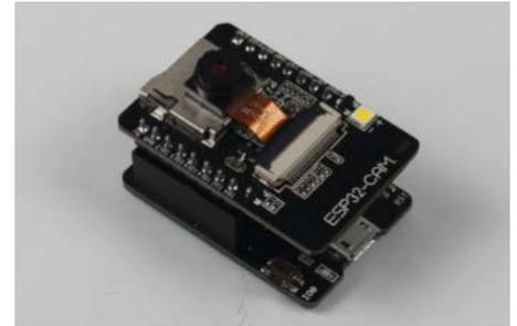
**6** Die ESP32-CAM auf der USB-Platine, die als Programmer dient.
