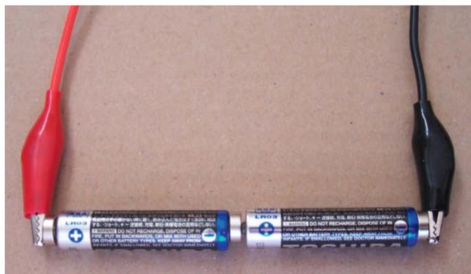
Auch eine provisorische Reihenschaltung von Batterien ist mit Magneten möglich.
