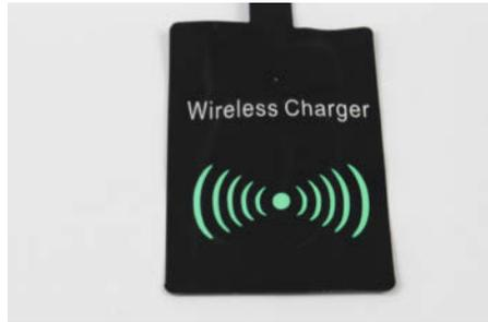
**5** Falls eine Seite des Qi-Empfängers so markiert ist, muss diese Seite beim Laden zum Ladegerät zeigen.
