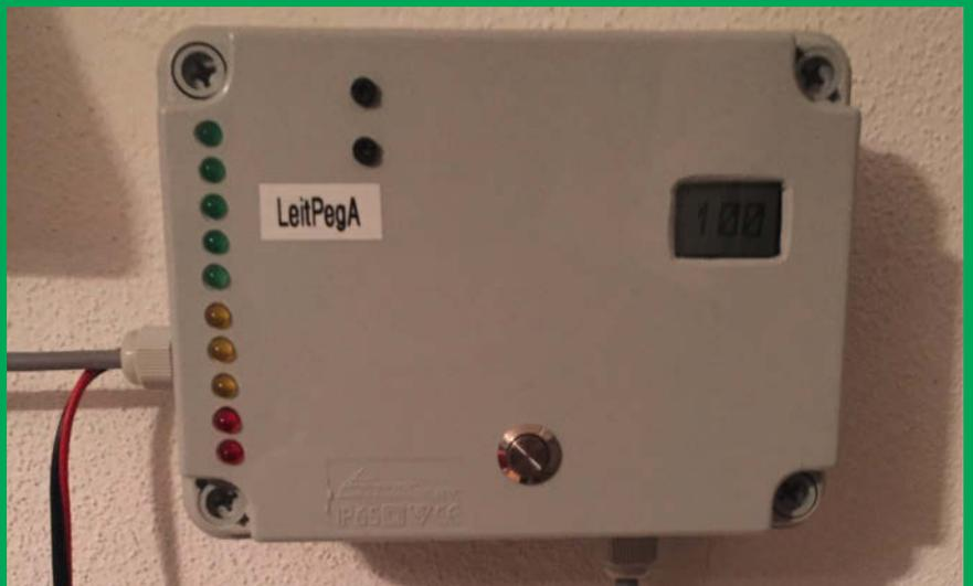
Die Anzeige und Steuereinheit des Pegel-Sensors
