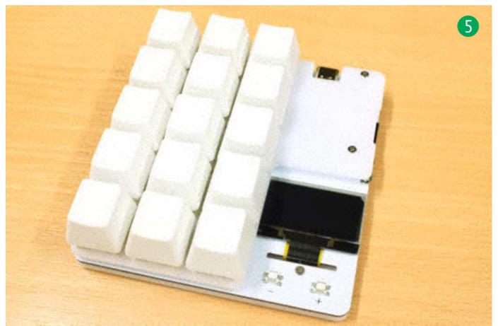
Oberseiten der Tasten müssen sich nach der Montage alle auf gleicher Höhe bzw. auf einer Ebene befinden. Ziehen Sie zum Schluss noch die Schutzfolie des OLED-Bildschirms ab, und schon sind Sie fertig. Herzlichen Glückwunsch!
