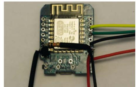
**8** Die vier Drähte zum Display gehören an D1, D2, GND und 5V.
