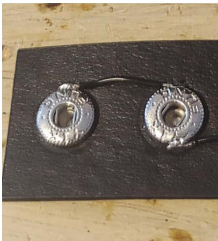
Im ersten Schritt werden die Druckköpfe und der Minuspol der Knopfzellenhalterung verlötet.
