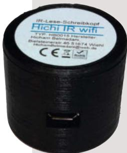
Für etwa 30 Euro bekommt man bei *eBay* direkt vom Hersteller den WLAN-fähigen IR-Schreib-Lese-Kopf *Hichi IR*, der nicht nur die Daten eines smarten Stromzählers ausliest, sondern auch die *Tasmota*-Firmware enthält und damit
