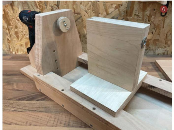
dem Niveau der Materialoberfläche des Bankbetts liegen. Andernfalls würde der Reitstock und die Werkzeugauflage beim Verschieben an den Schraubenköpfen hängen bleiben.
