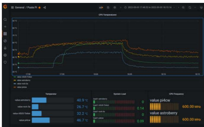
Vergleich der thermischen Reaktion von vier Probanden auf Spitzenlast (CPU)
