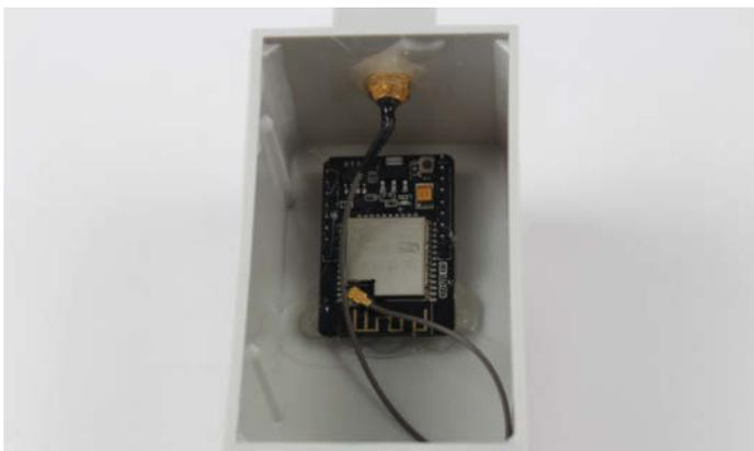
**11** Die Kameraplatine wird mit Heißkleber befestigt.
