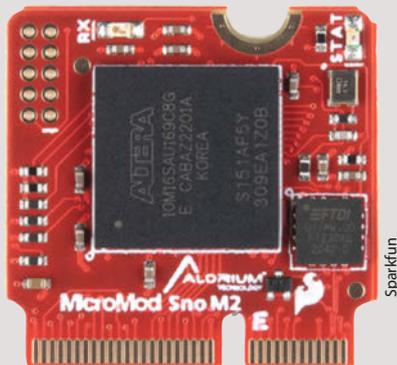
Der in der Maker-Szene bekannte US-Hersteller *Sparkfun* hat in Zusammenarbeit mit dem FPGA-Spezialisten *Alorium* ein neues Prozessormodul im *MicroMod*-Formfaktor vorgestellt, das statt eines Mikrocontrollers einen MAX10M16-Gatterbaustein der Intel-Tochter *Altera* enthält.
