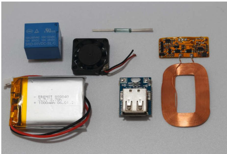
3 Diese Teile gehören in den Deckel (von links): Akku, Relais, Lüfter, Reed-Kontakt, Laderegler und Qi-Empfänger.
