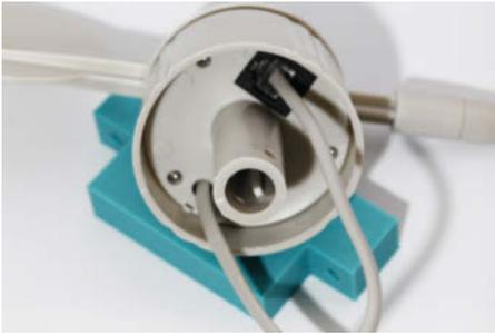
11 In diese Buchse gehört das Kabel des Windgeschwindigkeits-Sensors.
