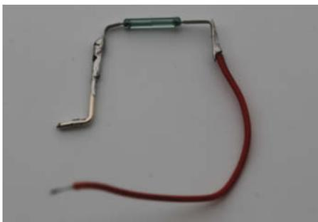
11 An einer Seite des Reed-Kontakts wurde massiver Schaltdraht verwendet: Er hält den Kontakt sicher in Position.
