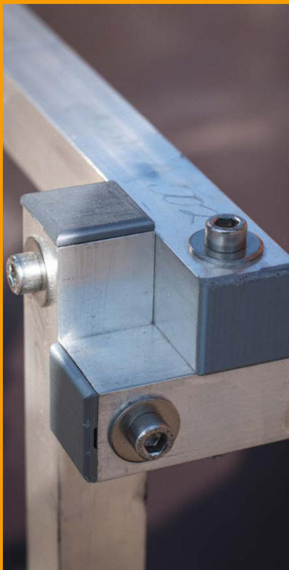
Das XYZ-Prinzip stabilisiert *TrudeTrailer*, auch ohne Schweißgerät.
