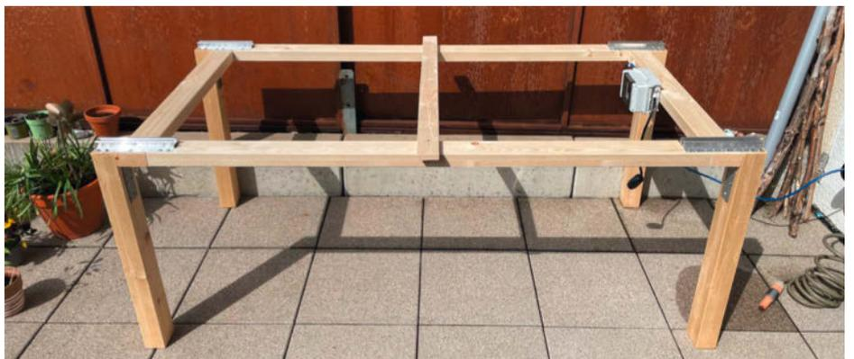
**12** Fertiger Rahmen mit Montageschienen und optionalem Schaltkasten
