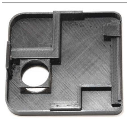
4 Der Deckel muss wegen der Halterungen unbedingt mit Stützstrukturen gedruckt werden.
