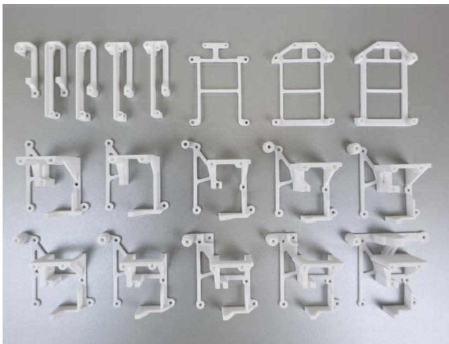
5 Entwicklungsstufen des Rumpfs: Die filigranen Teile erforderten einige Tests und Anpassungen.
