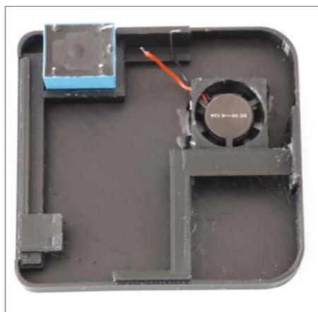
5 Beim Lüfter muss der Kleber sparsam dosiert werden, damit der Rotor nicht verklebt.
