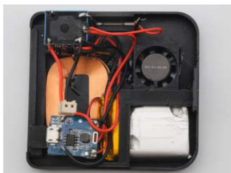
14 Die Buchse für den Raspi: Parallel zu deren Anschlüsse sollten Sie auch die beiden Drähte des Lüfters anschließen.
