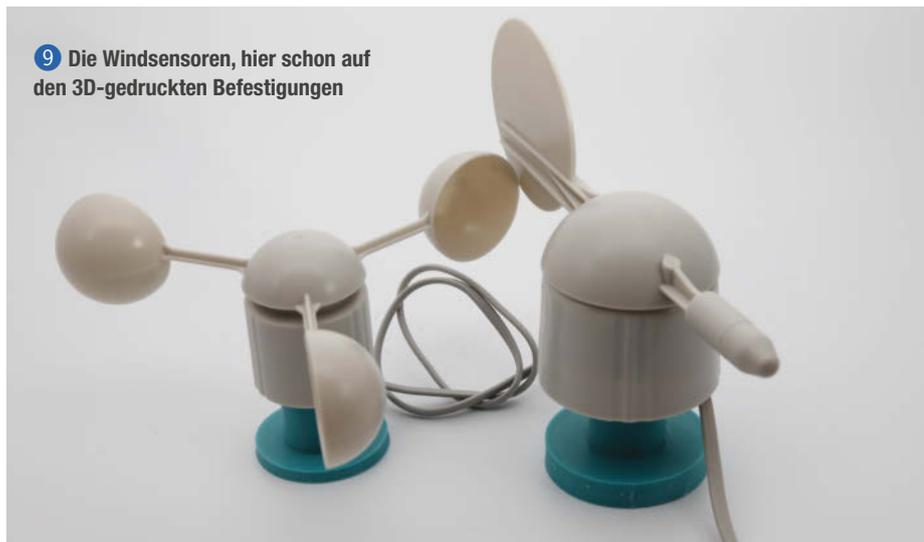
kommen die 3D-gedruckten Adapter für den Windgeschwindigkeits- und den Richtungs-sensor 15.
