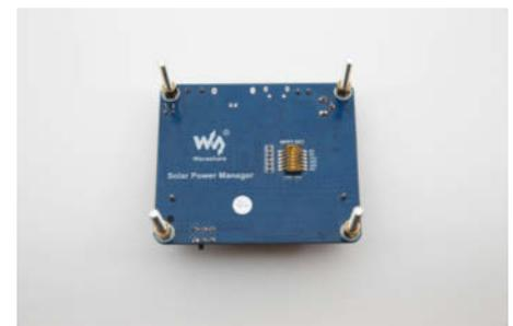
16 Diese langen Schrauben werden durch die Panel-Rückwand gesteckt.
