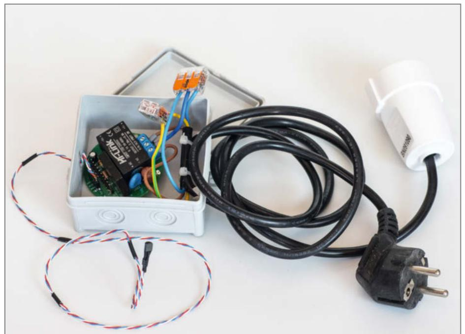
**5** Beim Musteraufbau haben wir für den Pumpen-Anschluss Schuko-Steckverbinder vorgesehen, sodass zum Test eine 230V-Glühlampe angeschlossen werden kann; auch die Pumpe bekam einen Schukostecker verpasst.
