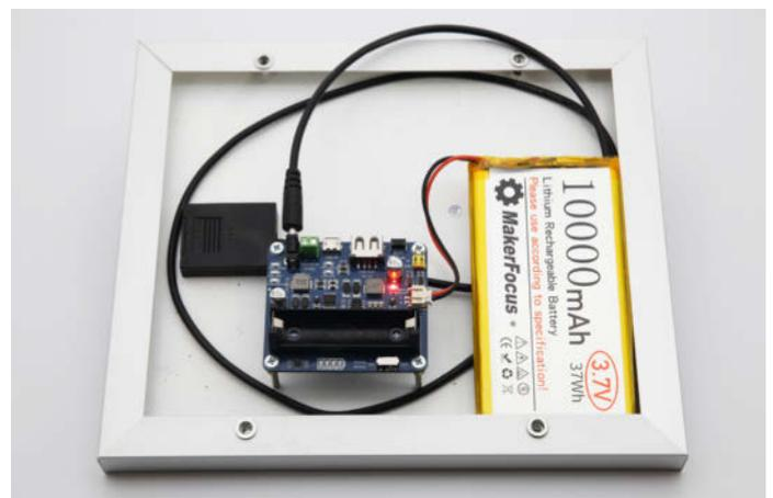
5 Akku und Paneel in den Laderegler einstecken, das reicht für die Schaltung der Solar-Anlage.
