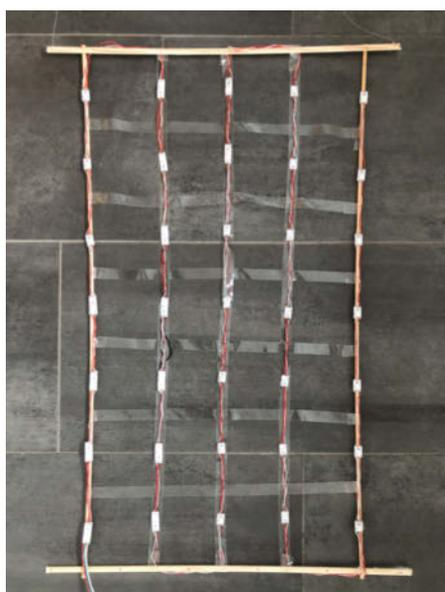
Die Leisten habe ich an den Enden durchbohrt und mit Klingeldraht fixiert, um ein Gitter für die 35 LEDs zu bilden.
