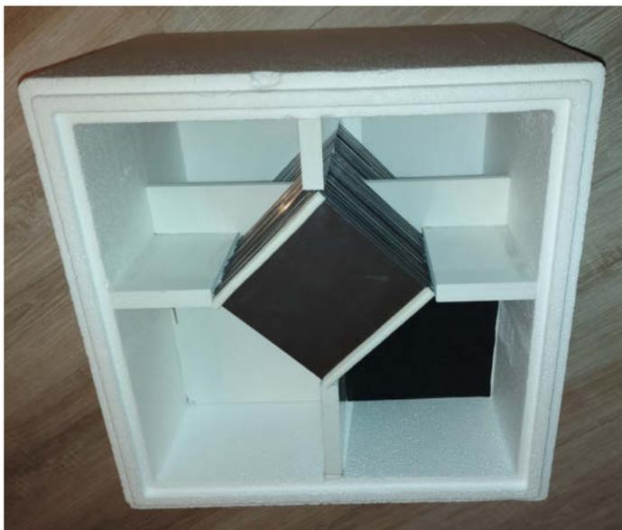
11 Der fertige Wärmetauscher von innen bei abgenommenem Deckel
