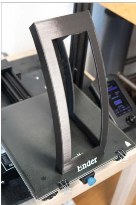
Ein fertiger Bogen nach etwa 20 Stunden Druck
