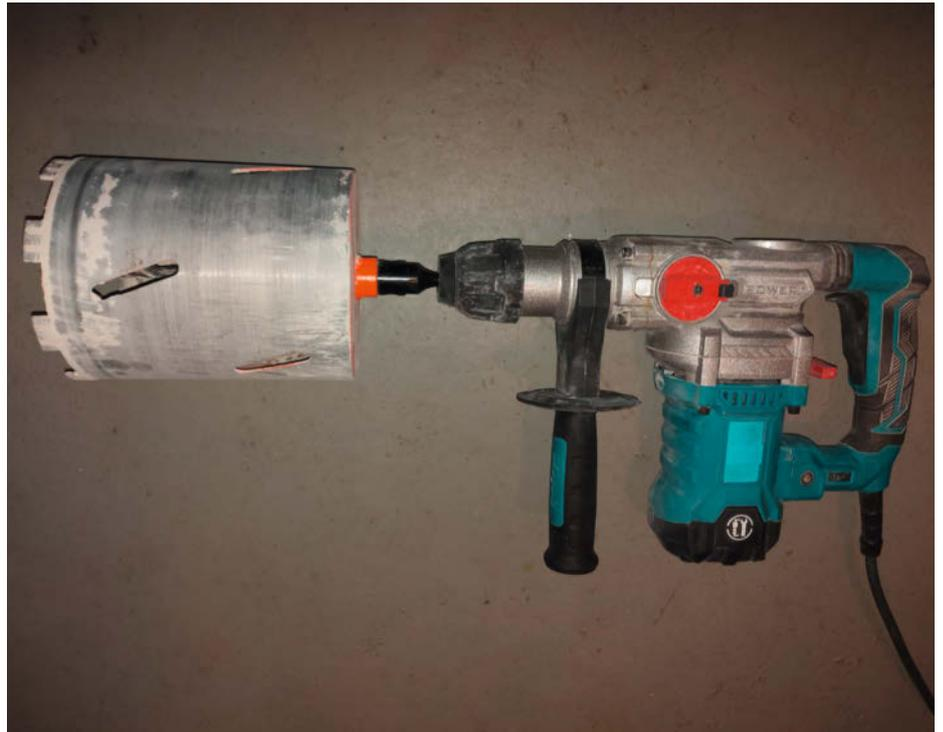
**13** Wer sich für Wanddurchbrüche entscheidet, braucht eine 1500-Watt-Bohrmaschine mit Kernbohrer.
