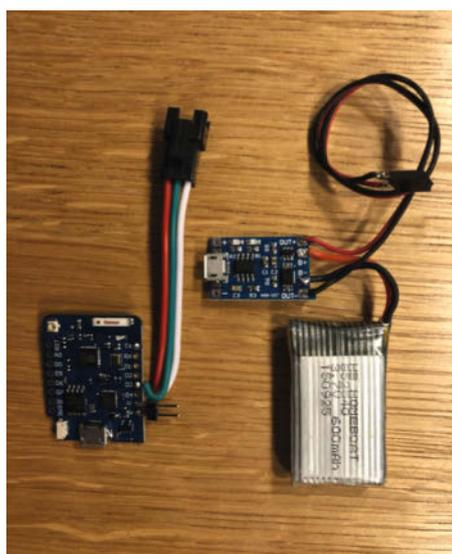
Von links nach rechts: Controller Wemos D1, Lader und Akku. Hier sieht man den Stecker für die LEDs und einen kleinen Stecker für die Stromversorgung, den ich aus Stifteleisten hergestellt habe.
