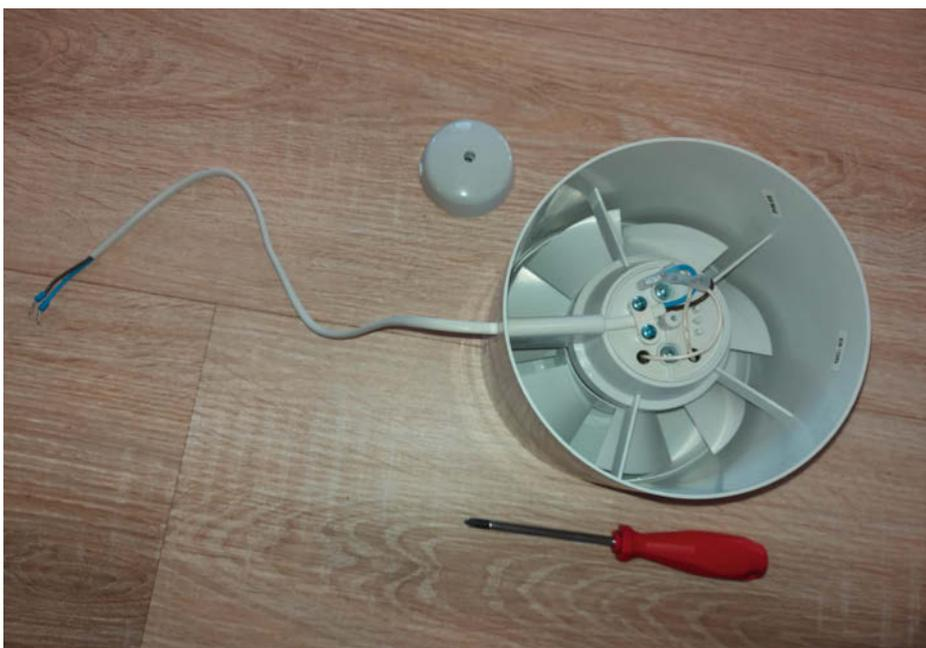
**16** Öffnen des Ventilators zum Verlängern des Anschlusskabels
