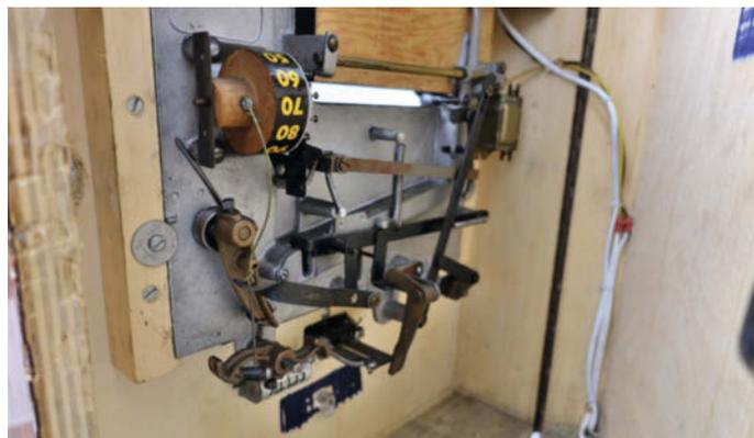
16 Und so sieht der Kicker-Catcher auf der anderen Seite aus. Von Elektronik keine Spur, dafür Walzen, Nägel, Hebel und Federn.
