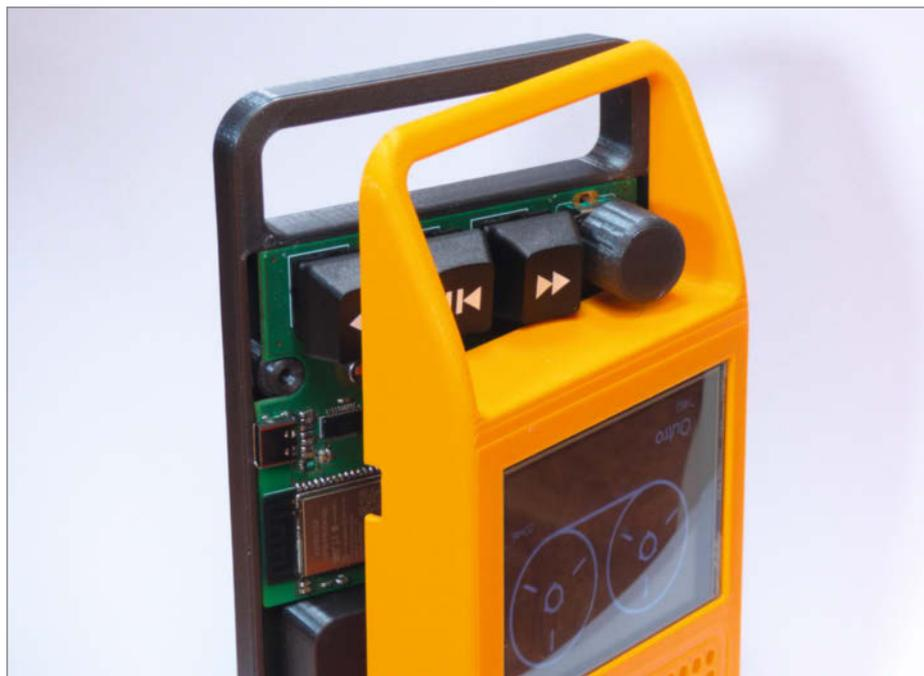
3 Tasten und SMD-Bauteile passen zusammen auf eine Leiterplatte und so in das kompakte Gehäuse.
