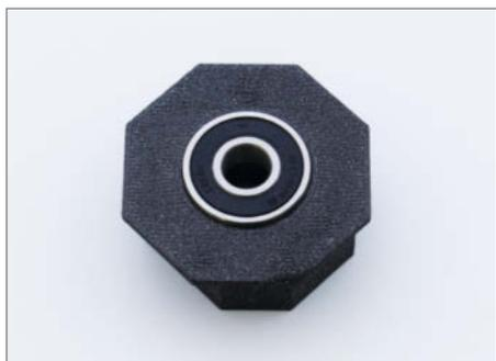
8 Dieses Kugellager hält später die Achse und die Kappe der Mühle.
