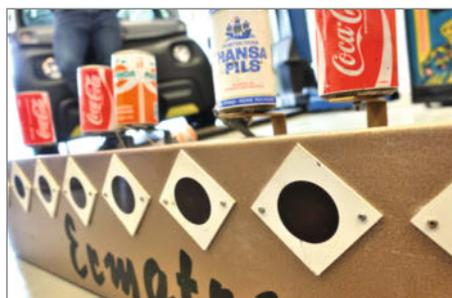
[23](#) Unter den Dosen sind Fotodioden angebracht, die Treffer mit dem Lichtgewehr registrieren ...
