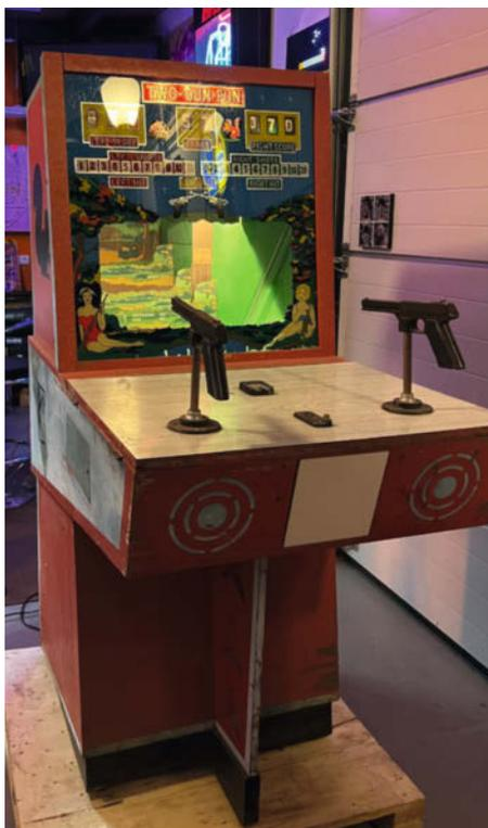
26 Wie bei vielen elektromechanischen Arcade-Automaten erweitert auch bei diesem Exemplar ein um 45 Grad gekippter Spiegel das Revier für die beiden Jäger-Spieler optisch über die Rückwand des Geräts hinaus.
