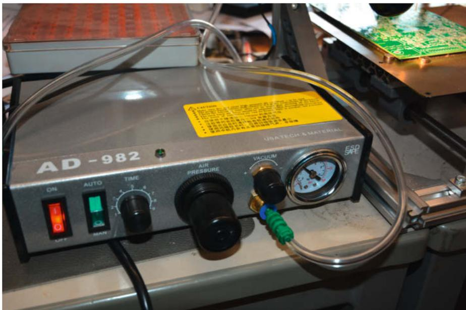
Der Universal-Dispenser AD-982 benötigt zur Funktion einen kleinen Airbrush-Kompressor mit mindestens 4 bar.
