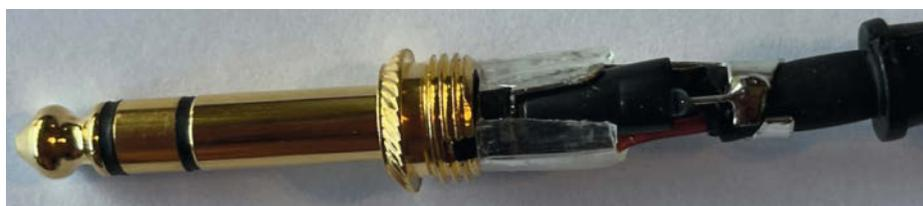
Dann das Ganze mit Schrumpfschlauch isolieren – fertig!
