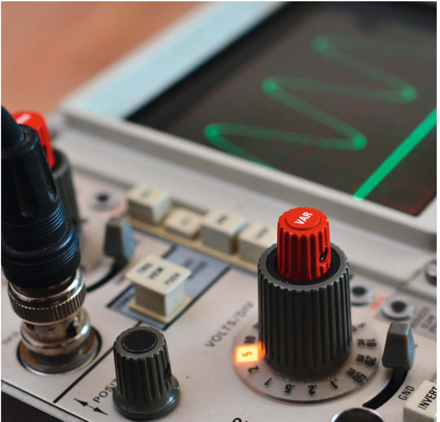
**D**igitale Speicheroszilloskope haben längst ihre analogen, mit einer Kathodenstrahlröhre ausgestatteten Vorgänger ersetzt – nicht zuletzt, weil ein paar Chips und ein TFT-Display deutlich billiger herzustellen sind als das feinmechanische Meisterwerk, das im Innern einer Bildröhre (CRT, *cathode ray tube*) den Elektronenstrahl erzeugt und ablenkt.
