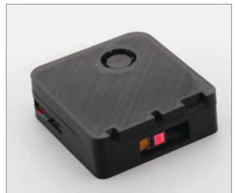
**1** Die Speicherkarte ist von außen zugänglich und kann ohne Öffnen der Kassette gewechselt werden.
