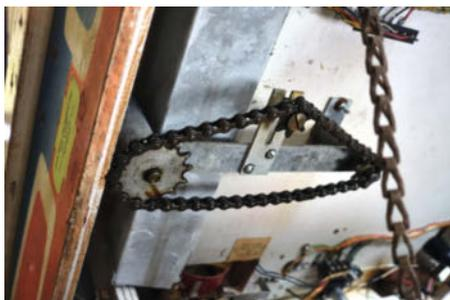
4 Ein Kettenantrieb koppelt im Hockeyautomat den Controller mit der Spielfigur ...
