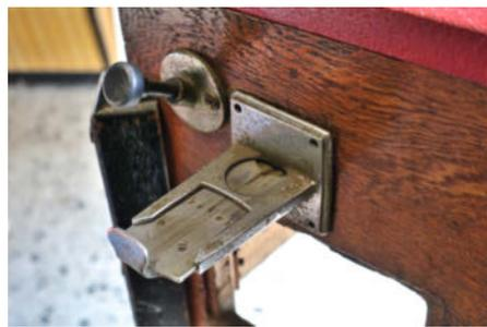
6 Schwerkraft reicht aus: Der Schieber für die Münzen am Hockeyautomat.
