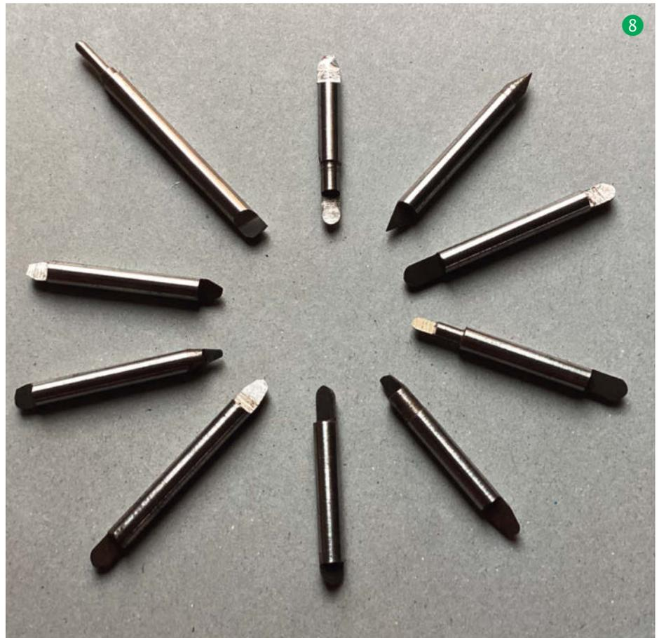
Zahnrad sein, welches mit dem Zahnformfräser **9** neu angefertigt werden soll. Beim Schleifen der Schneide muss diese wieder nach hinten freigeschliffen (Freiwinkel) werden.
