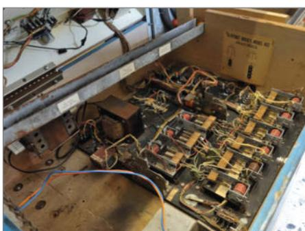
8 Die Schaltungstechnik im Inneren des Hockeyautomaten funktioniert noch rein analog und elektromechanisch.
