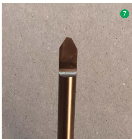
waagerechte Nut kann alternativ ein Kreisschneider eingesetzt werden. Die Hälften werden verschraubt oder verlötet. Dann wird der Halter rund gedreht und mit einem Spannanzapfen versehen.
