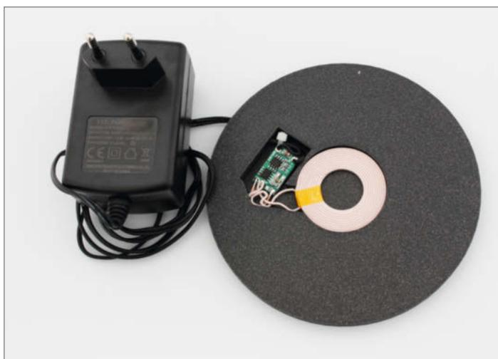
**15** Die Ladeplatte mit Netzteil: ein Kabelbinder dient hier als Zugentlastung.
