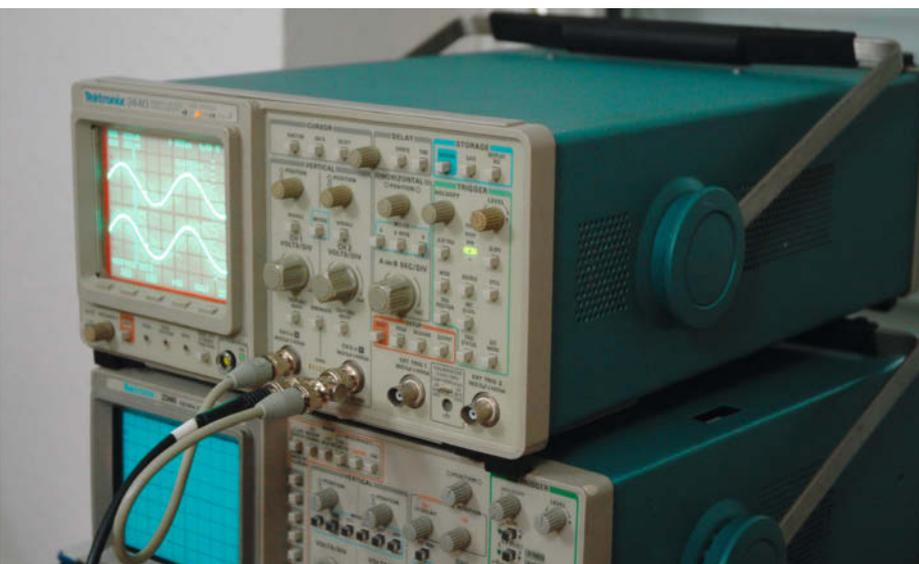
Zwischenschritt: Das Digital-Oszilloskop Tektronix 2440 aus dem Jahre 1988 speicherte aufgezeichnete Signale vor der A/D-Wandlung in analogen Eimerketten-ICs (CCDs).
