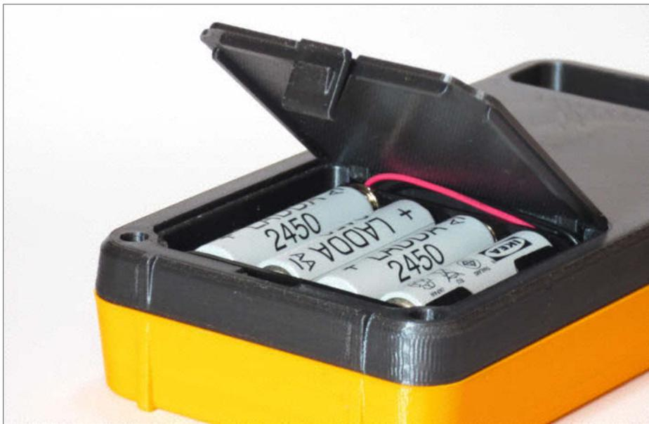
2 Ein Schnapphaken verriegelt den Deckel des Batteriefachs.
