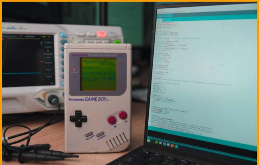
Programmiert wurde die Cartridge mit der Arduino IDE und zum Teil mit Assembler.
