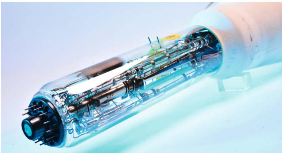
Das komplizierte Innenleben der Bildröhre, dem mit Abstand teuersten Bauteil des Oszilloskops, wird von außen kaum ersichtlich. Man erkennt hier nur die Elektronenkanone mit den XY-Ablenksplatten, hinten rechts im Röhrenhals noch eine der Flood Guns (helle Scheibe).
