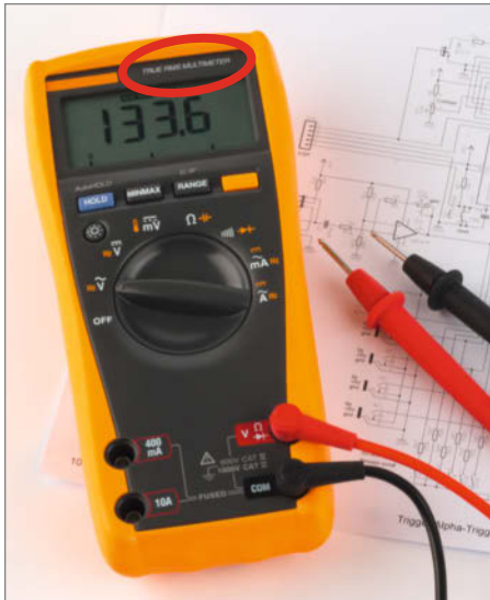
Gute Multimeter zeigen den Effektivwert von Wechselstrom zuverlässig an, zu erkennen am Kürzel TrueRMS.
