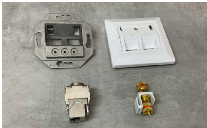
5 Keystone-System: Die Stecker (unten) werden in den Montagerahmen (links-oben) eingeklinkt.
