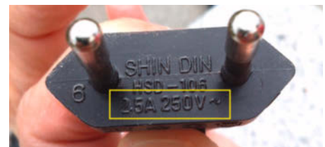
⑤ Solch ein Kabel reicht für einen Haartrockner nicht aus.
