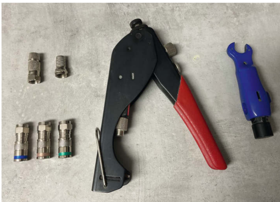
7 Verschiedene F-Stecker und die dazugehörige Kompressionszange. Das Werkzeug rechts hilft beim Abisolieren und Verschrauben.
