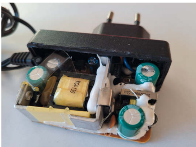
7 Mit viel Mumppe bleibt alles an seinem Platz: Das Innenleben eines Stecker-Schalt-Netzteils.
