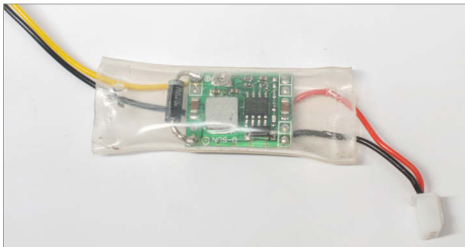
9 Eine unrühmliche Ausnahme: Dieser DC-DC-Wandler sollte auf der Leiterplatte Huckepack genommen werden und eine Steckerverbindung war nicht möglich. Die Plastikhülle sorgt für Isolierung und Fixierung der Kabel.
