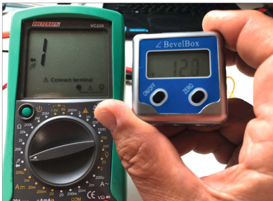
7 Das Ohmmeter versorgt den Winkelmesser mit Energie.
