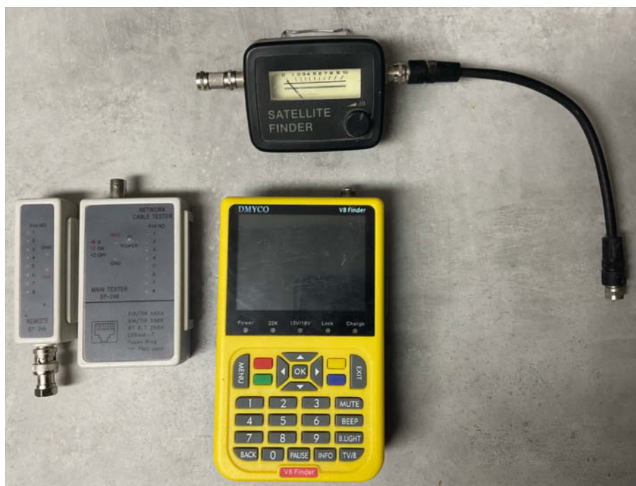
10 Nützliche Helfer: links LAN-Kabeltester, rechts ein analoger (oben) und ein digitaler Sat-Finder (unten)
