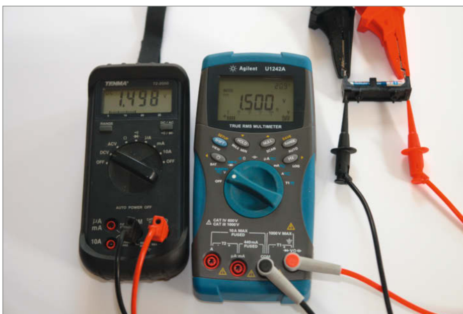
Vergleich der Messwerte zweier Multimeter an der Spannung an einer Batterie
