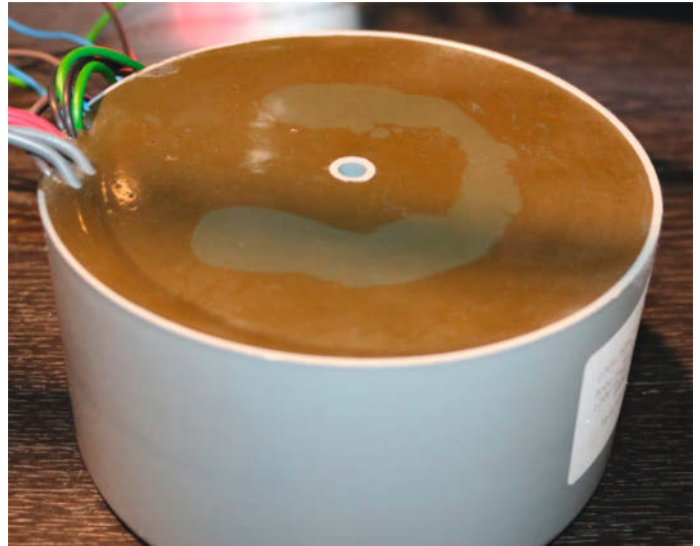
Schutzisolierter 400-VA-Ringkerntrafo: In dieser Leistungsklasse muss man schon mit einem recht hohen Gewicht rechnen (hier 9kg).
