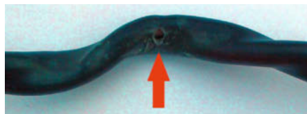
② Ist erst die äußere Isolierung durchgeschuert, folgt auch bald die innere.
