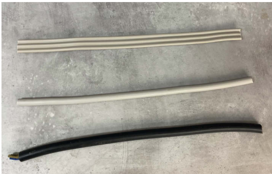
6 Von oben nach unten: NYIF-J (Stegleitung), NYM-J (Feuchtraumleitung mit Schutzleiter) und NYY-J (Erdkabel)
