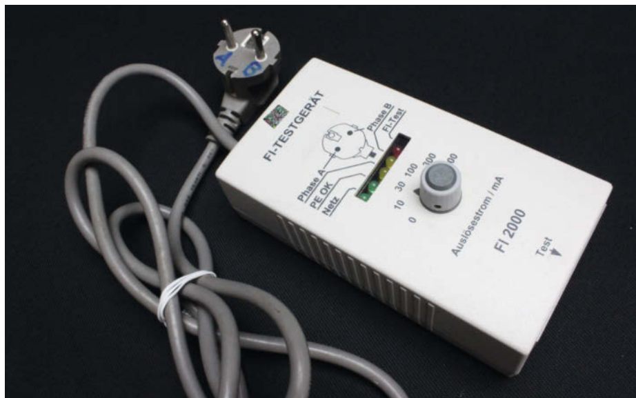
9 Testgerät für den FI: Damit können verschiedene Auslöseströme getestet werden. Zusätzlich prüft dieses Gerät auch, ob die Steckdose richtig verkabelt ist.
