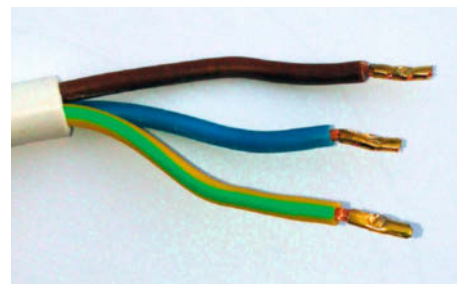
⑥ Aderendhülsen vermeiden brandgefährliche Übergangswiderstände durch Drahtbrüche.
