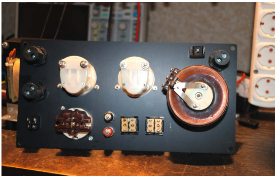
Rückseite der Frontplatte, zur Verdrahtung bereit
