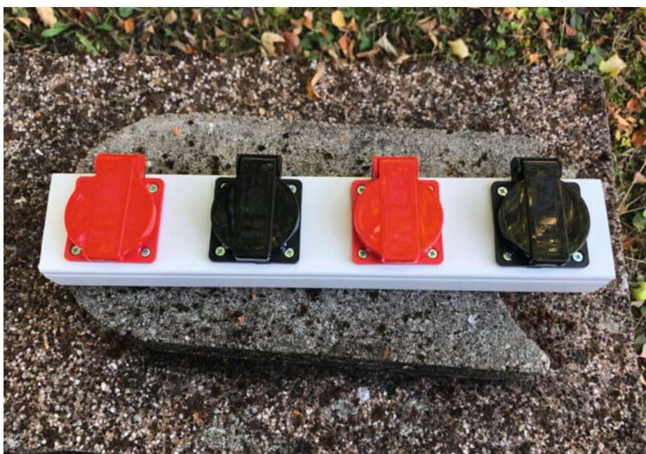
Selbstgebaute Vierfach-Verteiler aus Industrie-Steckdosen und einem abgedichteten Kabelkanal.
