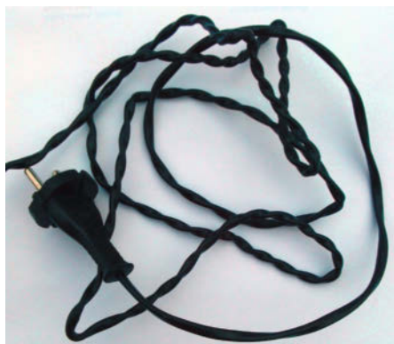
① Mit der Dauerwelle beginnt oft ein Kabelschaden.
