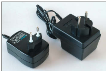
5 Steckernetzteile: Links Schaltnetzteil (20W), recht Trafonetzteil (3,6W).
