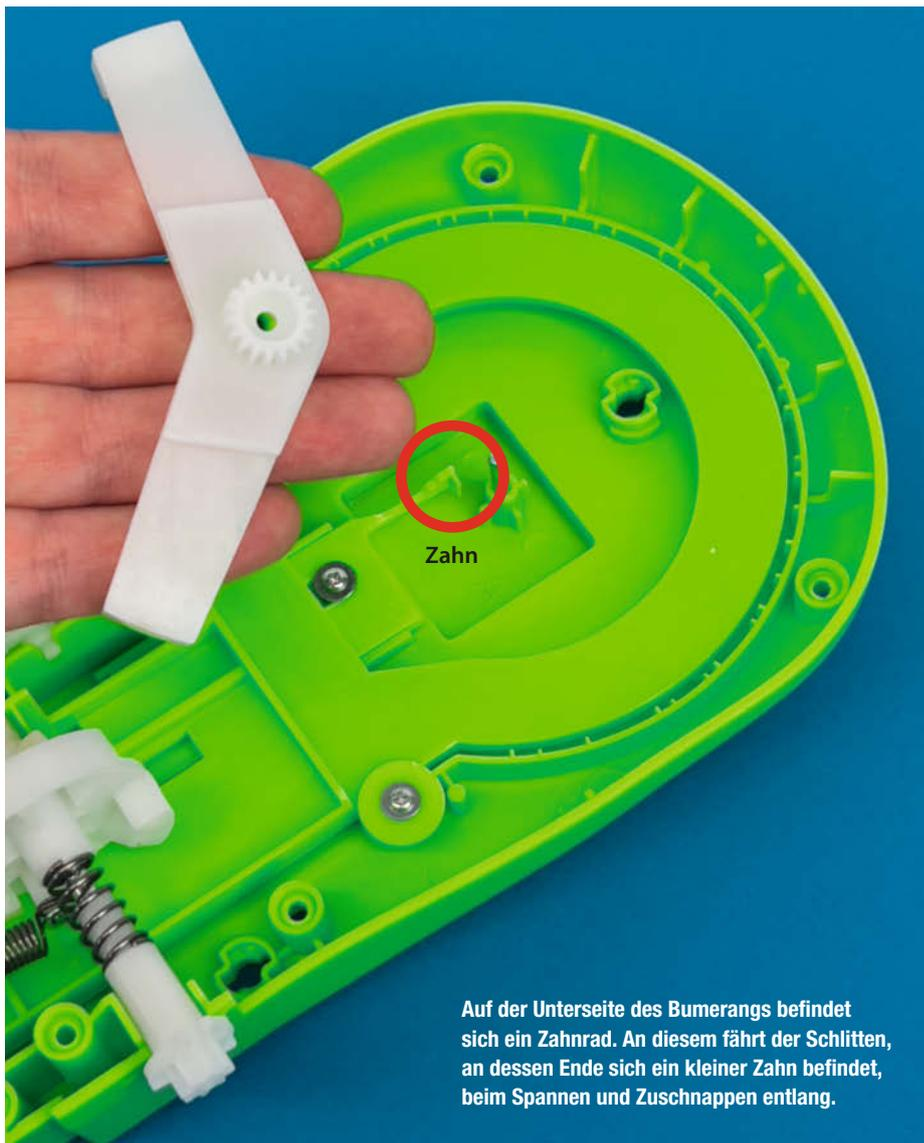
Auf der Unterseite des Bumerangs befindet sich ein Zahnrad. An diesem fährt der Schlitten, an dessen Ende sich ein kleiner Zahn befindet, beim Spannen und Zuschnappen entlang.
