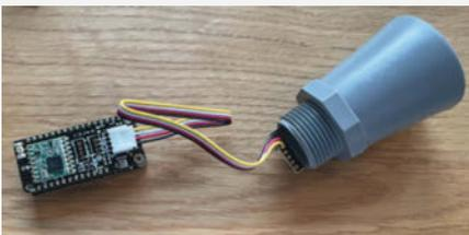
Wenn man den Solarregler nicht braucht, ist auch ein kompaktes Sandwich-Design möglich: ESP8266 und LoRaWAN Wing, direkt mit dem Ultraschallhorn verbunden, ideal für die rechts gezeigte Rohr-Variante.
