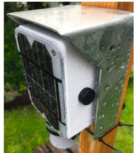
8 Die fertige Box mit Solarzelle an der Front draußen montiert, der Metallwinkel bildet ein kleines Schutzdach.
