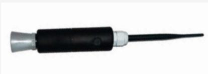
Bei der Rohr-Bauvariante sieht man die Druckausgleichsschraube in der Mitte. Das 3D-gedruckte Gehäuse wird einfach zusammengesteckt und enthält alle notwendigen Gewinde, als Batterie kommt eine Li-SOCI2-Zelle zum Einsatz.
