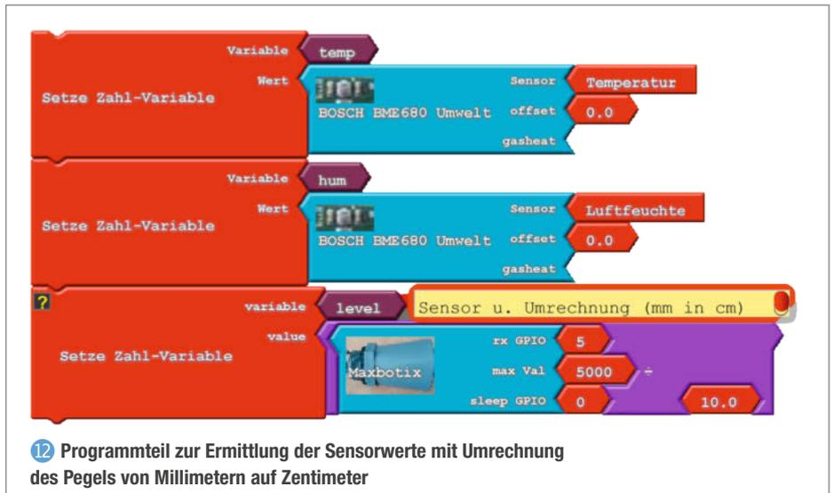
12 Programmteil zur Ermittlung der Sensorwerte mit Umrechnung des Pegels von Millimetern auf Zentimeter
