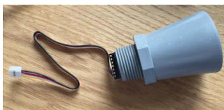
4 Der Maxbotix MB7369 ist ein Ultraschallsensor mit Horn und optimiert für Pegelmessung. Er kann seriell oder analog angeschlossen werden.
