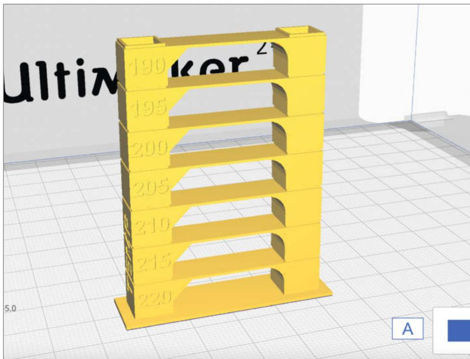
8 Ein Temperature Tower testet das Material etagenweise mit verschiedenen Temperaturen.
