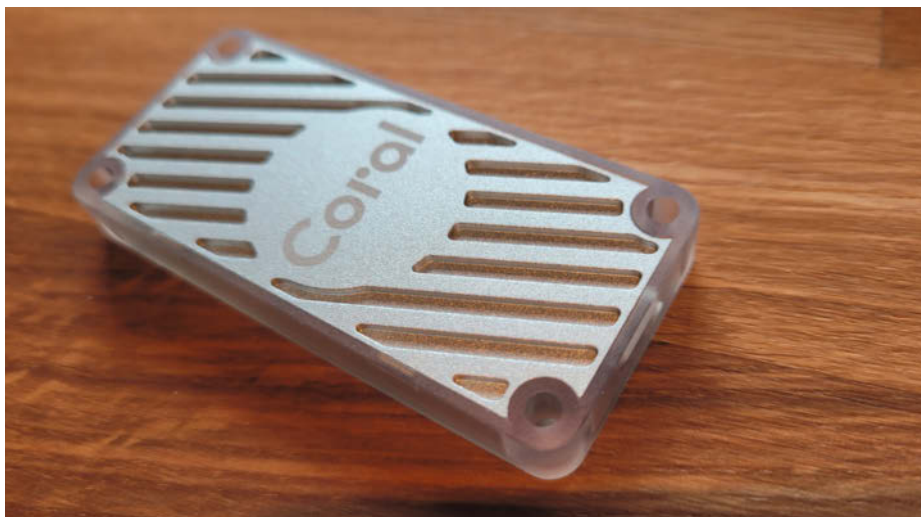
Bild 2: Mit Googles Coral USB Accelerator lassen sich Objekte schneller erkennen.
