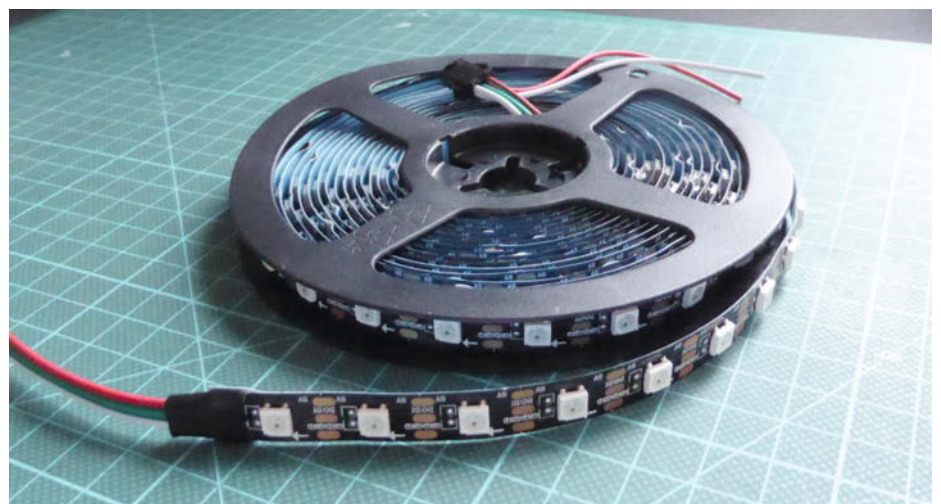
RGB-LEDs auf dem Streifen auf der Rolle
