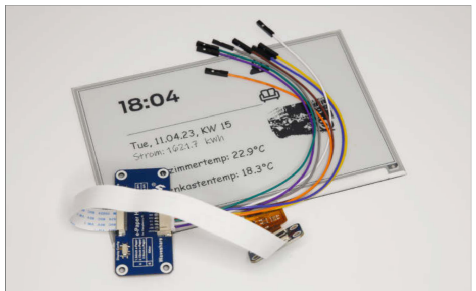
1 Das Display-Set enthält auch die Steuerelektronik und den Kabelsatz.
