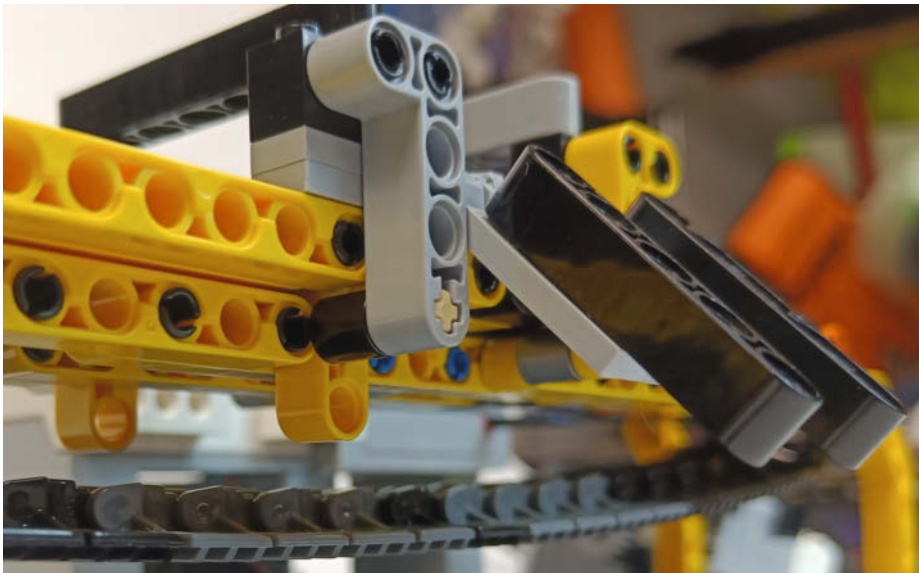
8 Detail des X-Achsen-Schlittens
