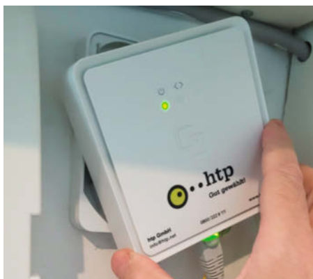
Bild 4: Der Deckel des FiberTwist enthält das Glasfasermodem.
