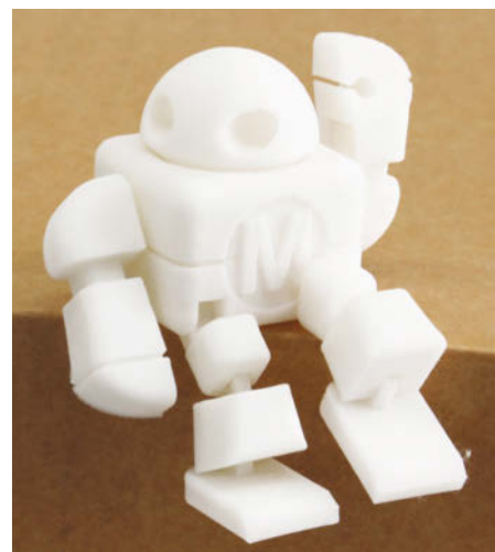
Früher war der bewegliche, in einem Stück gedruckte Test-Makey für viele 3D-Drucker eine harte Nuss, der AnkerMake M5 schafft ihn sogar im Schnellgang.
