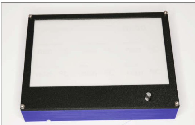
5 Nur wenn das Display richtig im Rahmen liegt, kann das Frontteil lückenlos angeschraubt werden.
