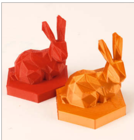
Roter Hase: Schnellmodus aus PLA, rund 15 Minuten Druckzeit, Kupferhase: Normalmodus aus BioFusion, 30 Minuten (Höhe jeweils 45mm)
