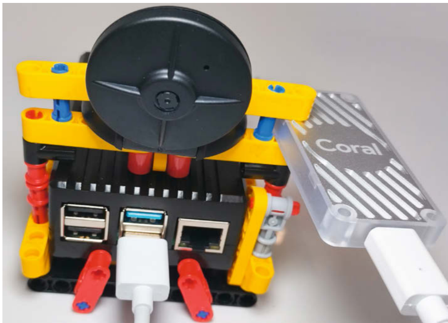
Bild 3: Lego-Technics-Komponenten halten unseren Hardware-Aufbau zusammen.
