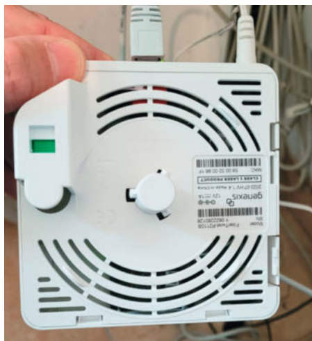
Bild 4: Der Deckel des FiberTwist enthält das Glasfasermodem.
