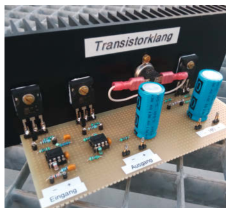
Röhren kann jeder – bei diesem Audio-Verstärker prägen die Transistoren den Klang.
