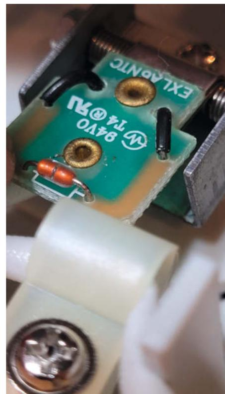
Der NTC wird mit einer Feder an die Gummirolle gepresst.
