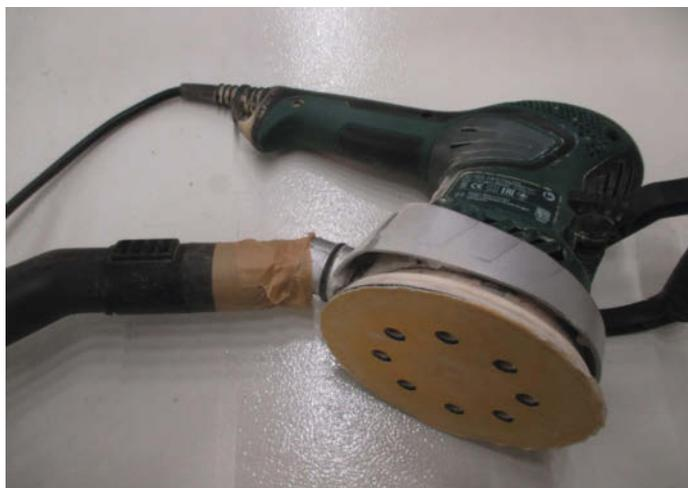
Staubsaugeranschluss am Rotationsschleifer früher: Mit Klebeband hält es nicht lange und der Schlauch ist starr verbunden.
