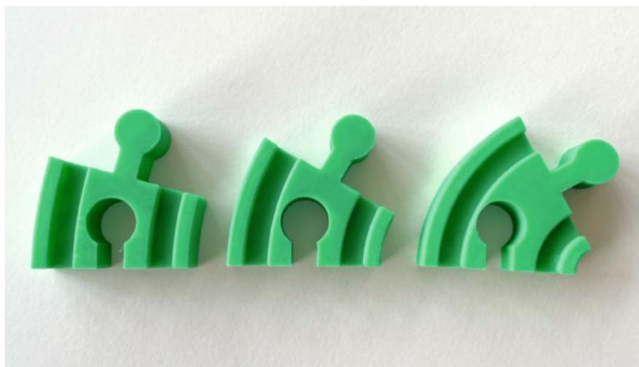
**Wer kleine Physikexperimente zum Entgleisen von Zügen machen möchte, ist mit dem Adapter ganz rechts gut bedient: Der Radius ist zu eng gewählt. Der linke und mittlere Adapter funktionieren dagegen, sind aber – Achtung Wortspiel – weniger flexibel als die biegsamen Gleise.**
