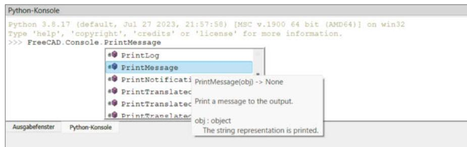
Autovervollständigung mit PrintMessage und Hilfe im Tooltip
