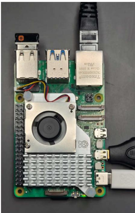
Unser Pi 5 im Praxisbetrieb mit Kühlkörper. Der USB-C-Stecker des Netzteils kommt sich mit dem Micro-HDMI-Adapter ins Gehege. Besser sind spezielle Micro-HDMI-zu-HDMI-Kabel.
