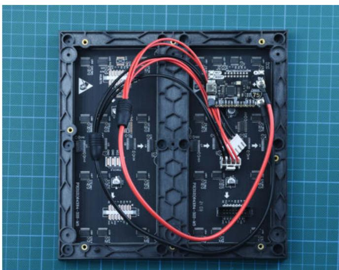
Strom erhält die LED-Matrix über die zwei Schraubklemmen.
