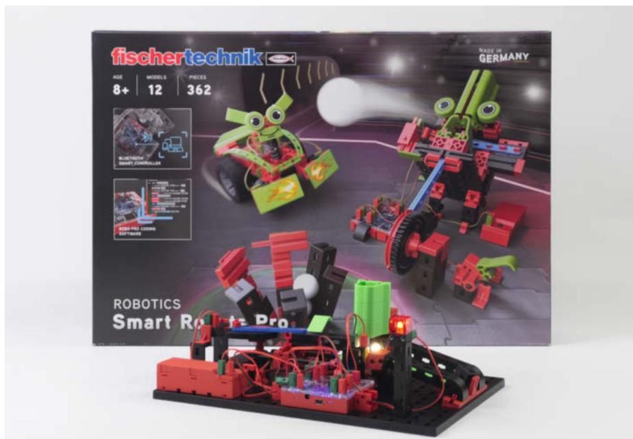
Der Bausatz, davor der Bauteilespender, der mit Hilfe einer Lichtschranke erkennt, wann er ein Bauteil in Richtung Rampe schieben darf.
