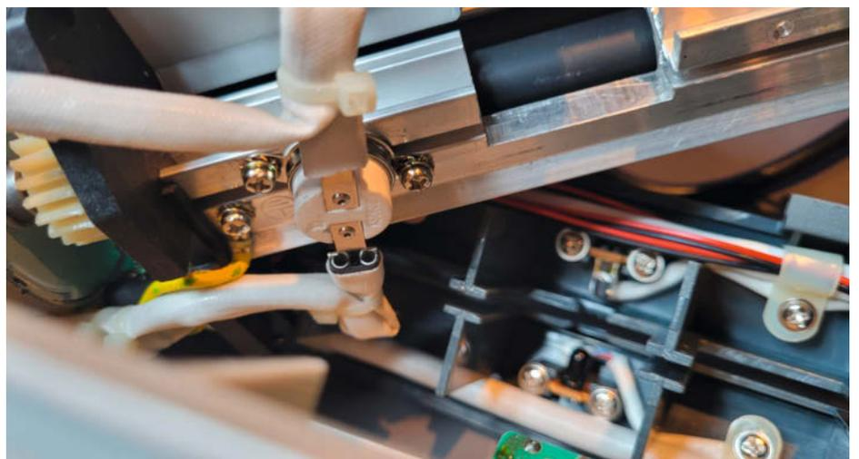
Unter dem Metallkörper ist das Heizelement angeschraubt. Rechts daneben im Hintergrund die Lichtschranke.
