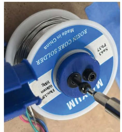
An diesen Muttern wird später von außen ein Stopper für die Lötzinnrolle angeschraubt.
