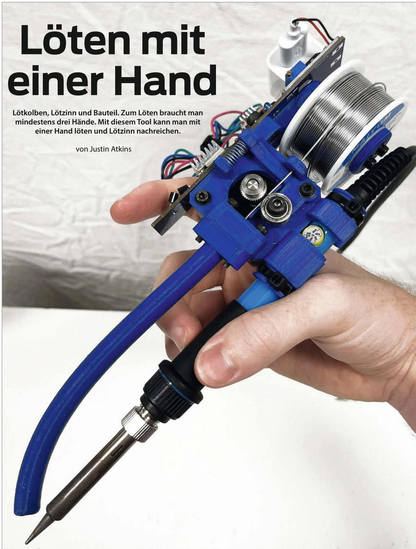
Dieses Gerät ist ein LötKolbenaufsatz, der die Extrusion von Lötzinn durch ein eingebautes System ermöglicht, sodass man beim Löten die zweite Hand frei hat.
