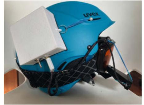
Die Befestigung am Helm mithilfe von Gummis und Stecknadeln sorgt im Falle eines Sturzes dafür, dass die Technik vom Helm abfällt, ohne den Nutzer zu verletzen.
