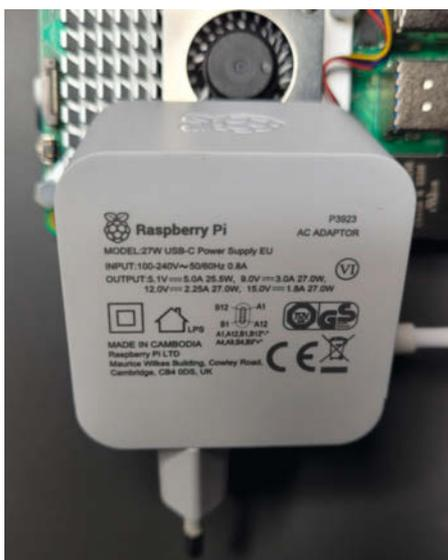
Das neue Netzteil liefert bei 5,1 V 5 A. Das unterstützt nicht jedes PD-fähige Netzteil. Also Augen auf beim Netzteilkauf!
