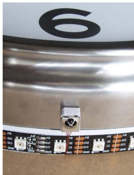
Bild 4: Der IR-Empfänger sitzt unterhalb der 6 des Zifferblatts.
