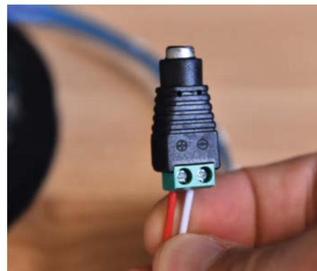
Die Stromkabel der LED-Ketten sind doppelt herausgeführt: einmal in einen Stecker und einmal lose. Die losen Enden kommen an den 5-V-Stromstecker.
