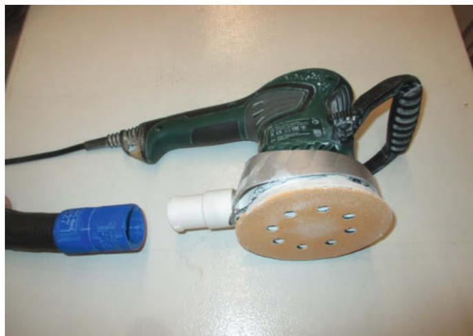
Mit selbstgedruckten Adaptern ist der Schlauch schnell eingekuppelt und kann dank Drehring flexibel in der Fassung rotieren.
