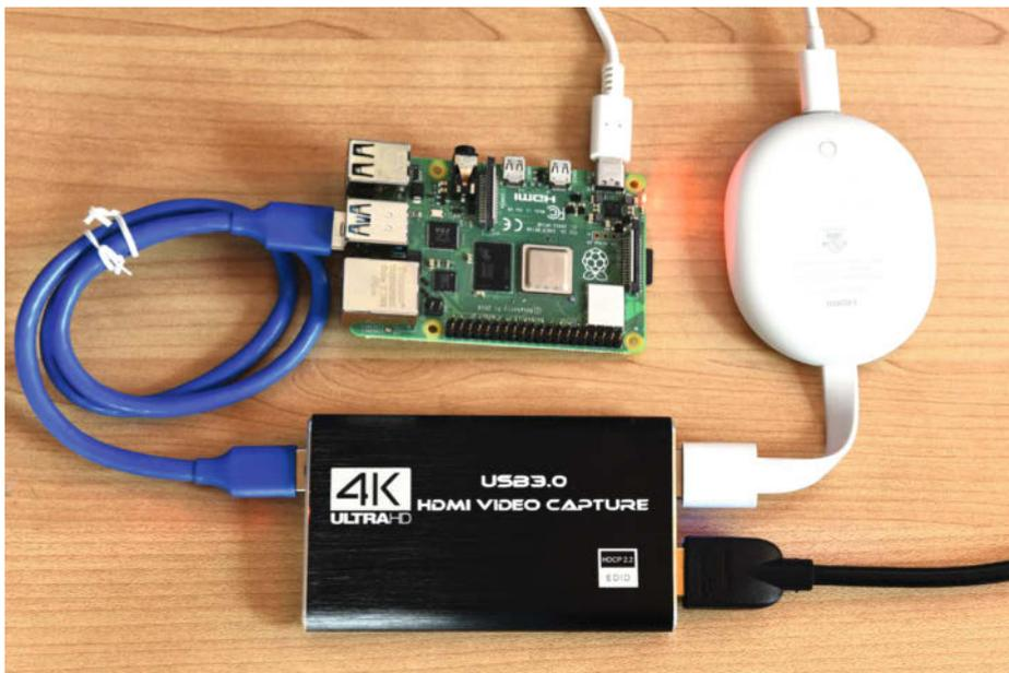
Die Capture-Card greift das Videosignal ab und sendet es per USB an den Raspberry Pi.
