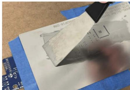
Mithilfe einer solchen Schablone kann Lötpaste über die ganze Platte hinweg in einem Arbeitsschritt aufgetragen werden.
