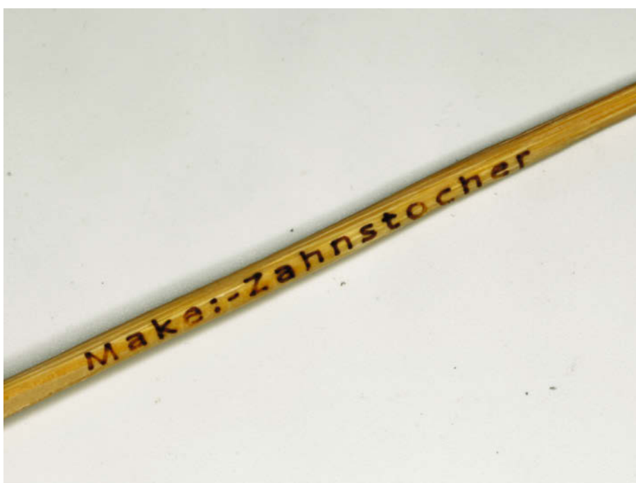
Bild 18: Ist der Text länger und der Zahnstocher liegt schräg im Cutter, muss man die exakte Drehung der Schrift etwas üben.
