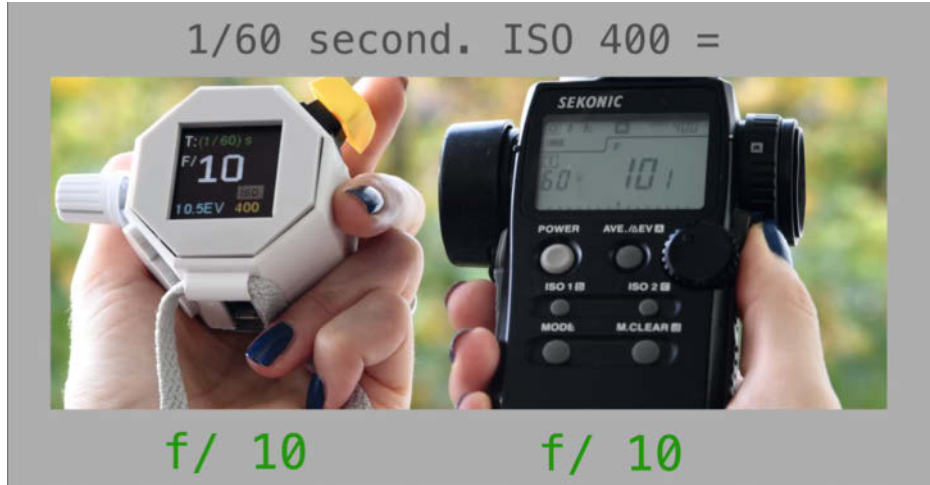
Bild 1: Der selbstgebaute Belichtungsmesser Photon braucht den Vergleich mit käuflichen Geräten nicht zu scheuen.
