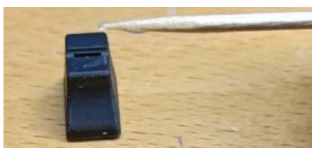
Bild 4: Einkleben des Lichtleiters mit einem winzigen Tropfen CA-Kleber. Das endgültige Design wurde aus Resin (Prusament Anthracite Grey) gedruckt.
