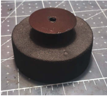
In den Schaumstoff werden Plastikteile eingeklebt, um die Motoren befestigen zu können.
