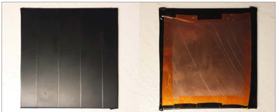
Bild 4: Die Verkleidung des Kupferblechs (links) geht bis auf die Rückseite (rechts).
