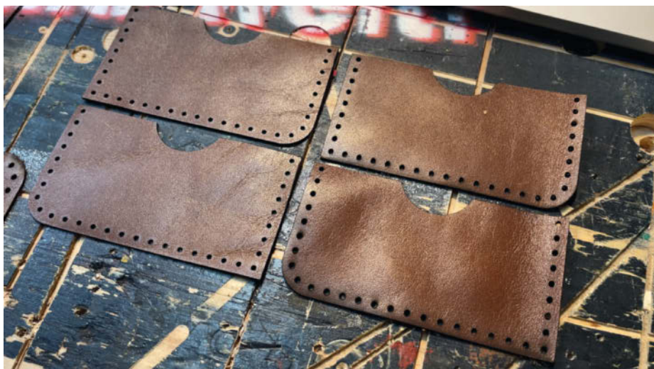
Bild 5: Auch bei diesen Versuchen mit Leder sieht man Schmauchspuren auf den Werkstücken des CO 2 -Lasers (rechts).
