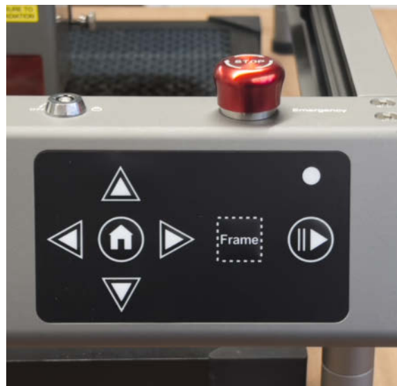
Bild 7: Der rote Ausschalter für Notfälle ist gut erreichbar. Sitzt aber das Zelt auf dem Falcon 2, kommt man nicht mehr ran.
