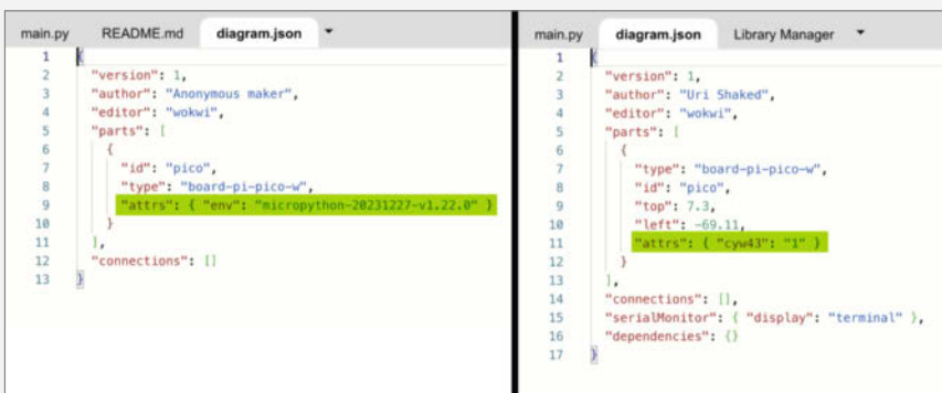
Bild 10: Die json-Konfiguration eines gegoogelten Beispiels (rechts) kann sich per WLAN verbinden – die Wokwi-Vorlage links kann das nicht.
