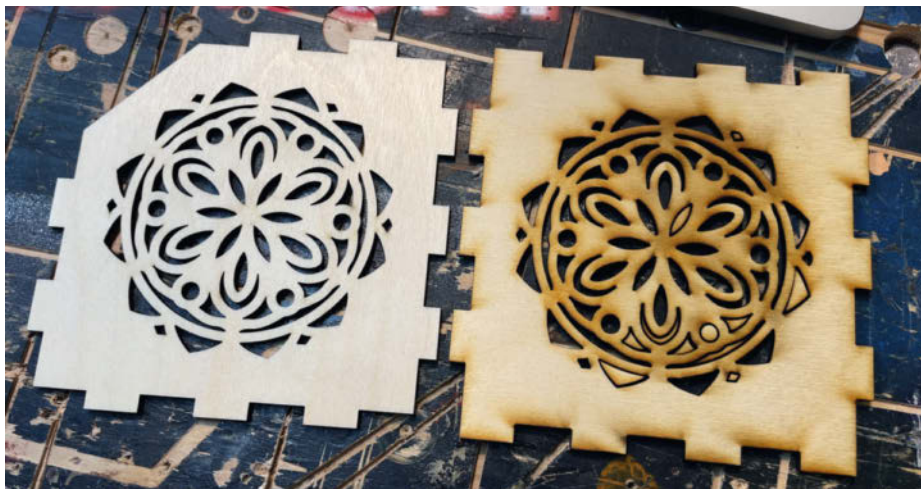
Bild 3: Die vom Falcon 2 geschnittene Oberfläche (links) ist frei von Schmauchspuren, der Redaktions-CO 2 -Laser (rechts) hat dagegen deutliche Rückstände hinterlassen.
