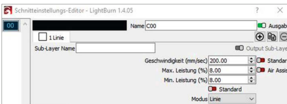
Bild 17: Bei solch kleinen Objekten sollten Sie die Leistung sehr gering einstellen und ein Air Assist ausschalten, sonst weht der Zahnstocher weg.
