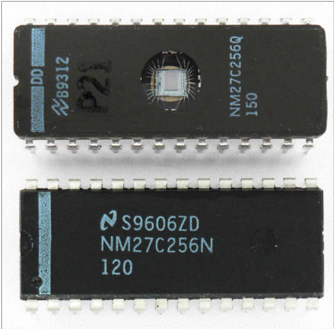
Bild 1: PROM und EPROM (oben): Das Fenster dient zum Zurücksetzen der Speicherzellen auf logisch 1.
