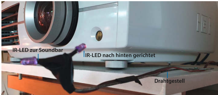
Bild 9: Zwei passgenau ausgerichtete Infrarot-LEDs schicken Signale an den Beamer und an die Soundbar.
