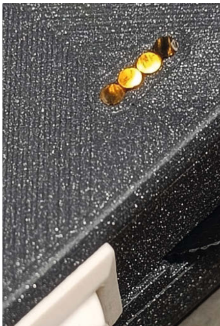
Bild 2: Klassische Anwendung, um das Licht der LEDs von der Platine nach außen zu bringen
