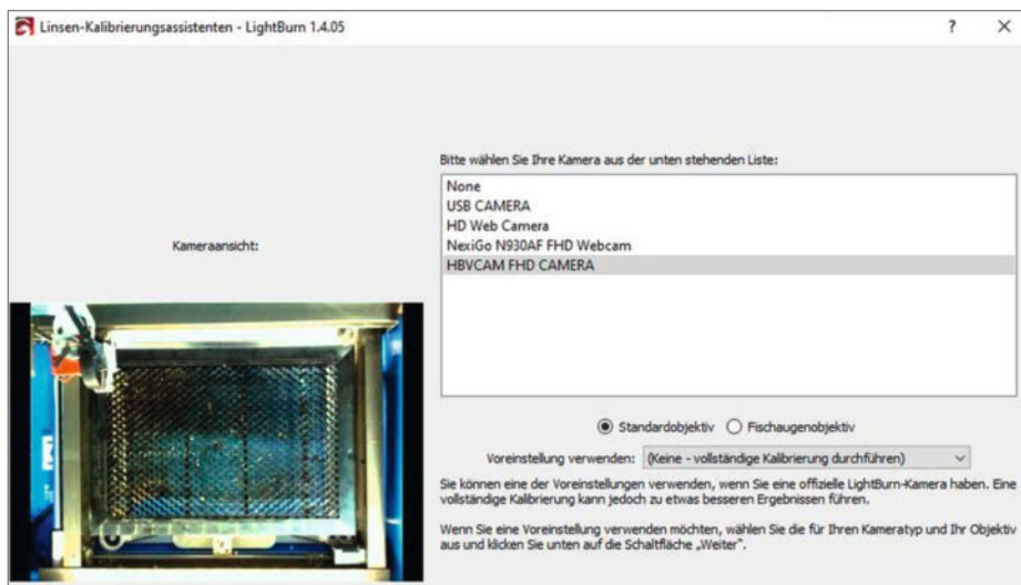
Bild 6: Wählen Sie die Laser-Kamera, stellen Sie das richtige Objektiv ein und klicken Sie auf weiter.
