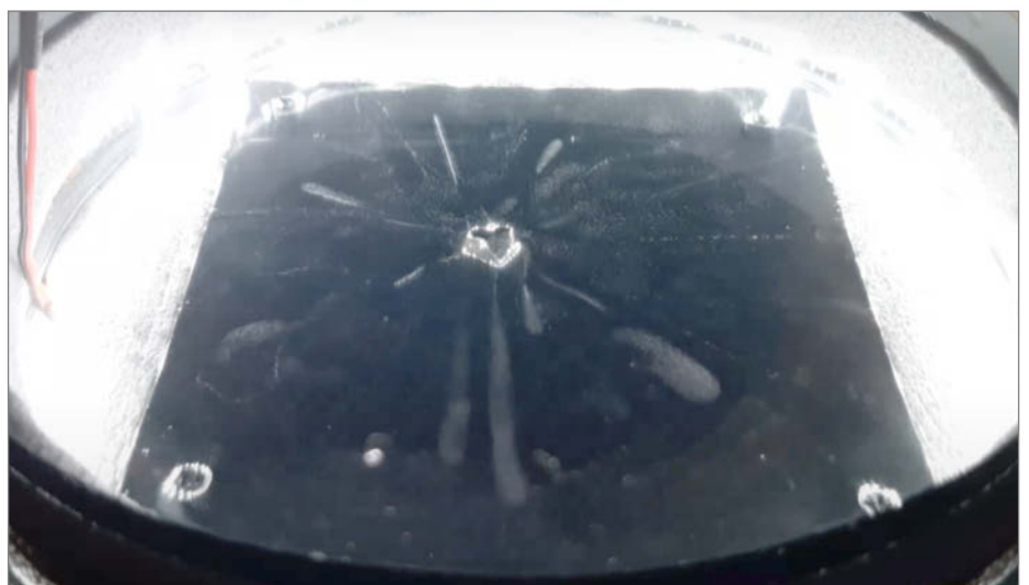
Bild 1: Dank des Nebels wird das Strahlen-Feuerwerk radioaktiver Stoffe sichtbar.
