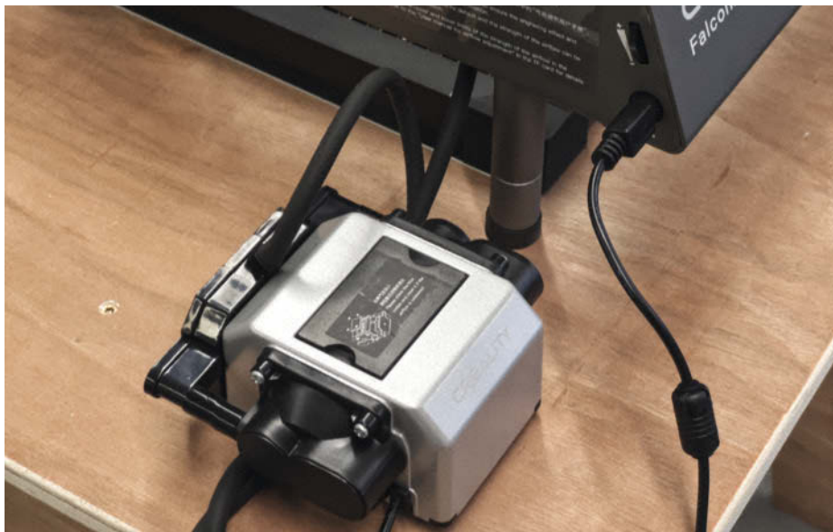
Bild 4: Der Air Assist ist mit dem Schneidkopf verbunden und verringert Schmauchspuren.
