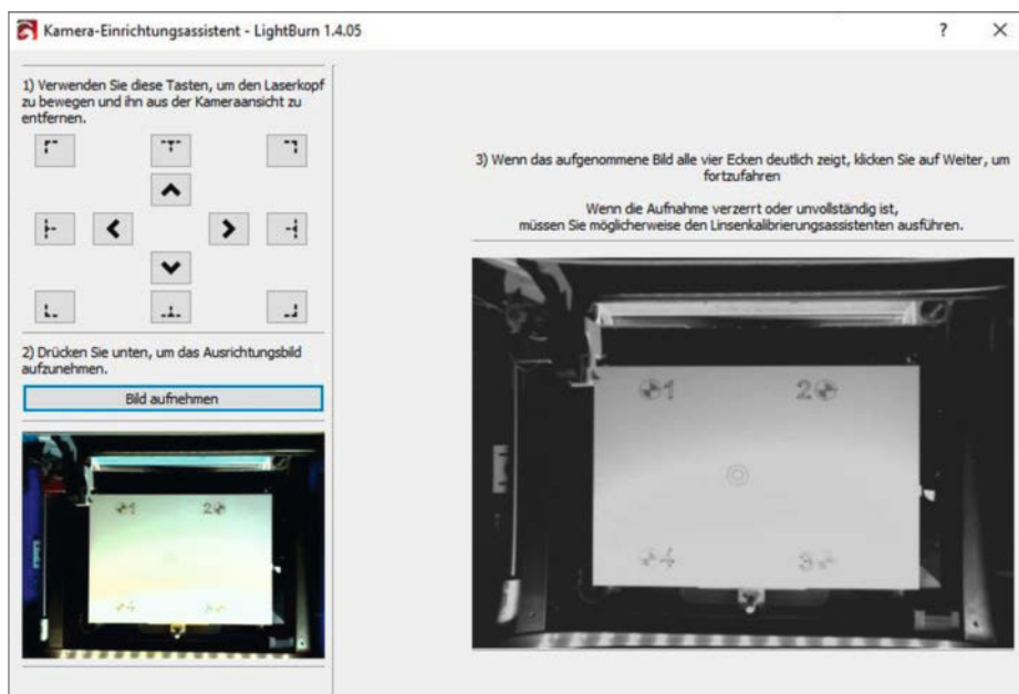
Bild 11: Falls der Laserkopf Teile verdeckt, verschieben Sie ihn mit den Pfeiltasten.
