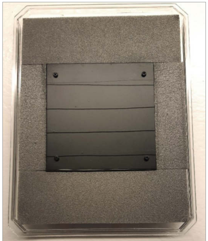
Bild 8: Mit PE-Isolierband verkleidet man zum Schluss die Oberseite des Acrylglases.
