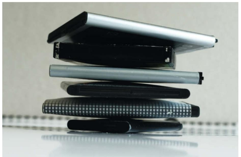
Bild 1: Aufgeblähte Akkus
