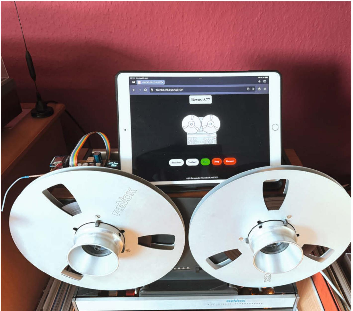
Für die Revox A77 existieren bereits Fernbedienungen. Allerdings handelt es sich bei diesen um Bedienelemente, die mit langen Kabeln am Gerät angeschlossen sind. Mit etwas Maker-Geschick lässt sich das aber auch in moderner Form kabellos umsetzen.
