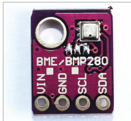
Bild 10: Der BME280 misst Temperatur, Luftfeuchtigkeit und Luftdruck.
