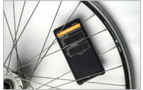
Bild 1: Anhand der Drehung einer Fahrradfelge wird die Zentripetalbeschleunigung mit Smartphone-Sensoren gemessen.
