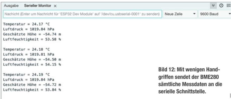
**Bild 12:** Mit wenigen Handgriffen sendet der BME280 sämtliche Messdaten an die serielle Schnittstelle.
