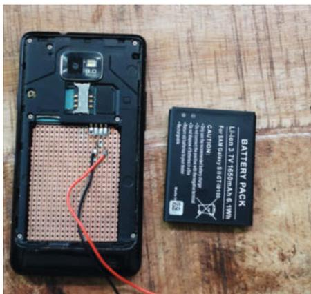
Abbildung 5: Modifiziertes Samsung Galaxy S2 für externe Stromversorgung.
