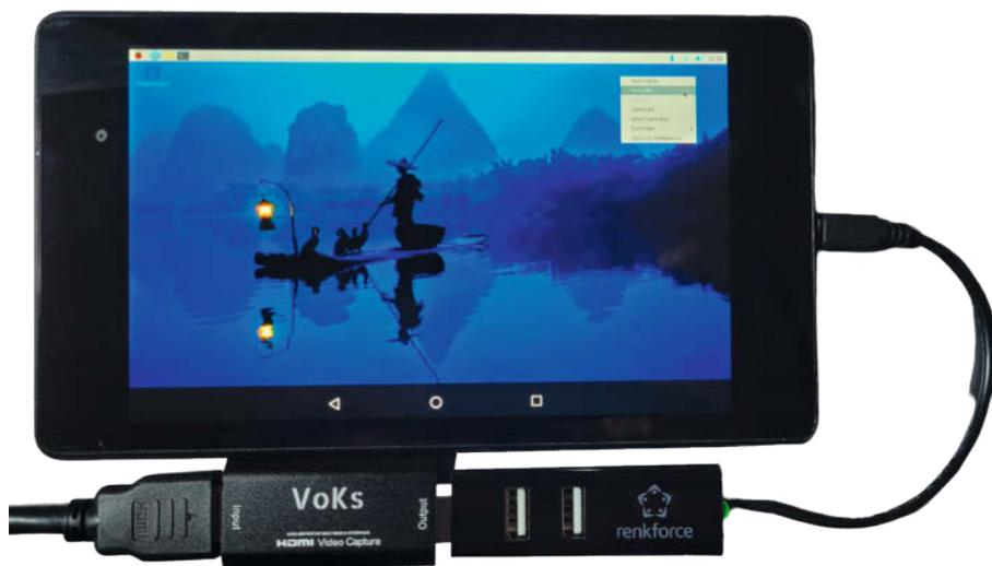
Der Desktop eines Raspberry Pi auf dem Display eines Nexus 7
