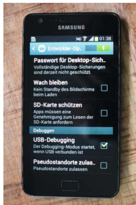
Abbildung 8: In den Entwickleroptionen kann man USB-Debugging aktivieren.
