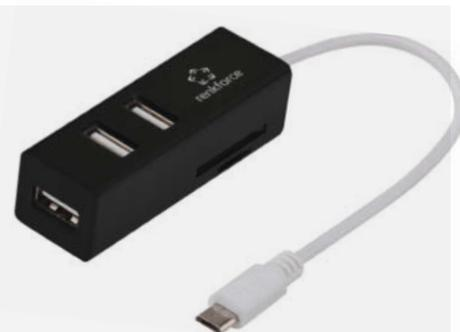
Über einen OTG-Adapter kann man PC-Peripherie an Tablets und Smartphones anschließen.
