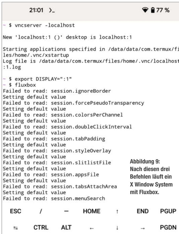
Abbildung 9: Nach diesen drei Befehlen läuft ein X Window System mit Fluxbox.
