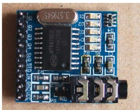
Bild 9: DTMF-Decodermodul
