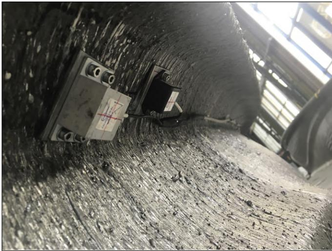
Bild 2. Sensoren an der MX3D-Brücke.
