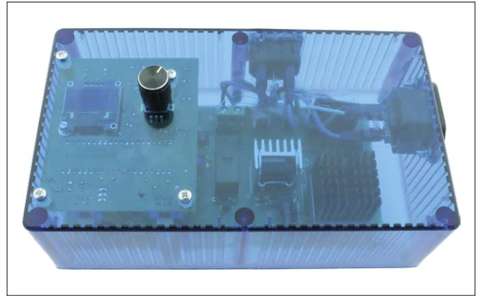
Bild 7. Geprüft, zugelassen und in seinem blau-transparenten Gehäuse gut geschützt: der 1-kW-AC-Motortreiber mit seinen drei Betriebsarten.
