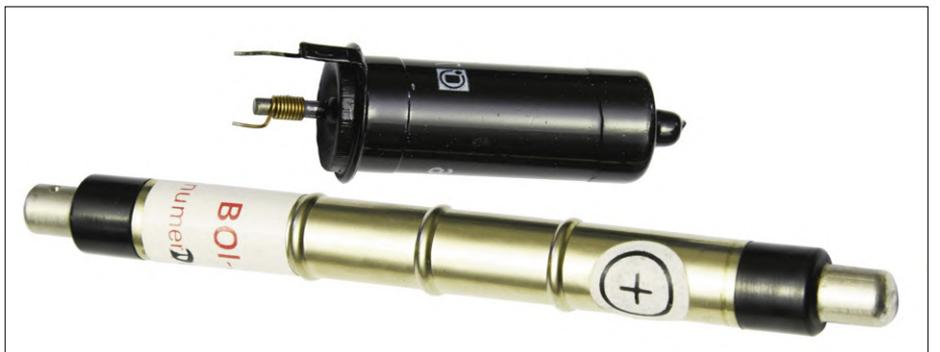
Bild 2. Zwei Beispiele für gängige Geiger-Müller-Zählröhren mit Metallwänden.
