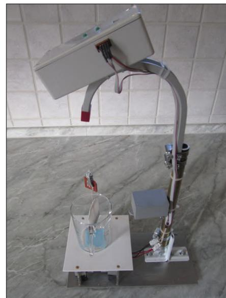
Bild 4. Noch im Versuchsstadium: Der funktionierende Prototyp der Teeuhr.
