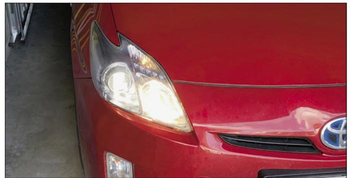
Bild 10. Tataaa: Mein Prius mit getuntem Abblendlicht. Man sieht die etwas weniger gelbliche Lichtfarbe des Abblendlichts, das jetzt mit 13,4 V (Fernlicht mit nur 11,8 V) betrieben wird.
