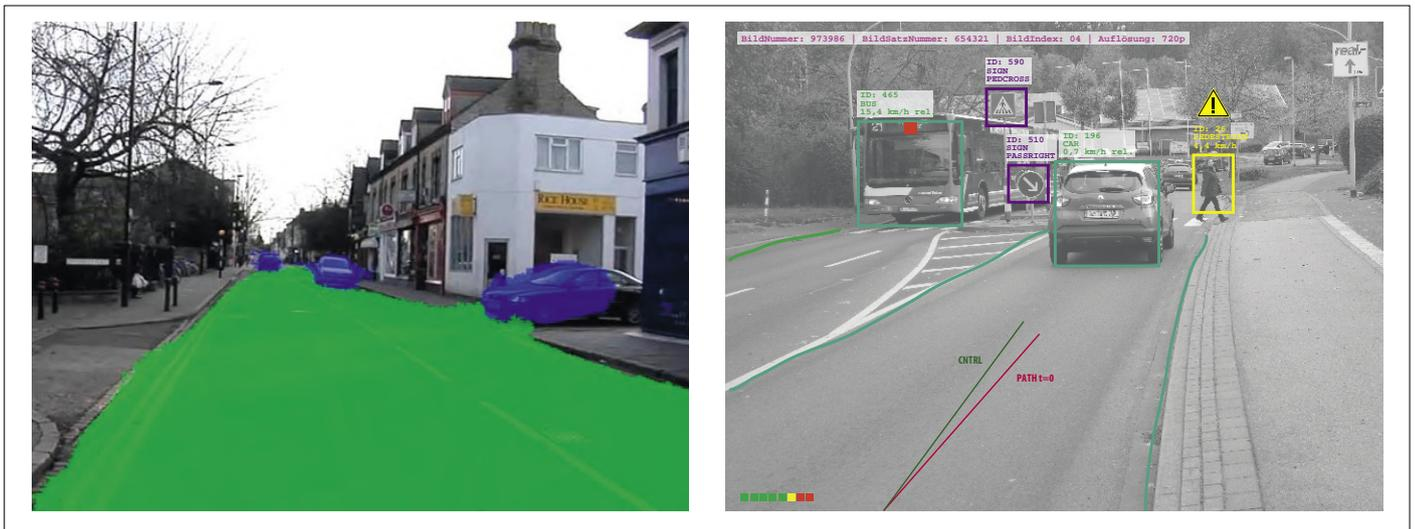
Bild 5. Zwei gängige Klassifizierungsarten: Links die semantische Segmentierung und rechts die Objekterkennung (Bild links mit Genehmigung von MathWorks, rechts: Symbolbild von Rolf Gerstendorf).
