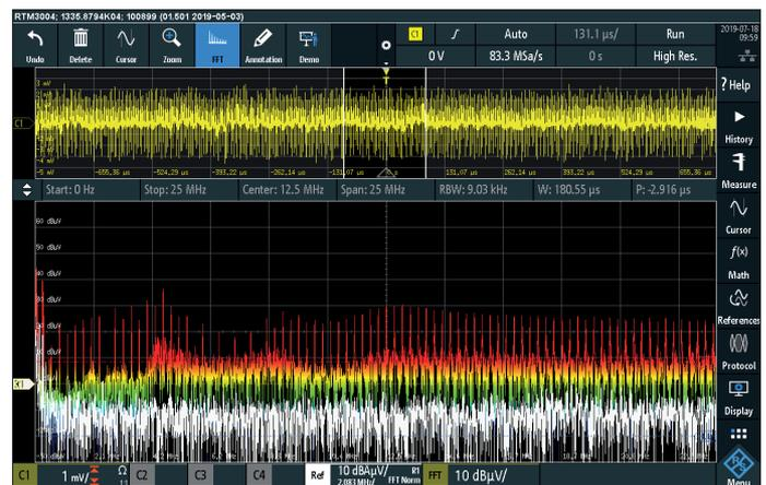
Bild 4. Störpektrum des Schaltnetzteils mit Eingangsfiler: Hier ist deutlich erkennbar, dass das Spektrum im unteren Frequenzbereich gedämpft ist. Die Messung muss mit Fokus auf diesen Frequenzbereich noch einmal durchgeführt werden (Quelle: Rohde & Schwarz).
