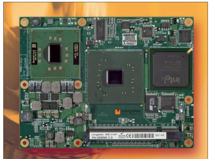
Bild 4. Die ersten COM Express Module wurden 2005 mit Intel Pentium M Prozessor zur Serienreife geführt, der für den Markt des Embedded Computings ein echter Meilensteinprozessor war.
