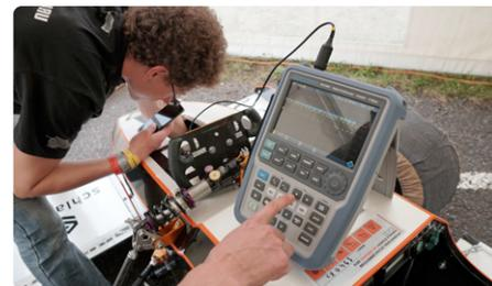
Bild 4. Fehlersuche am Streckenrand mit der Trigger & Decode Option für CAN-Bussignale (Quelle: Elefant Racing Team).
