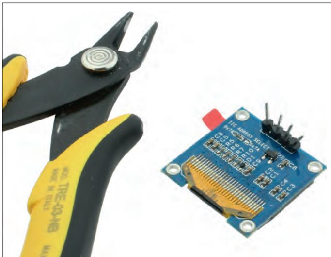
Bild 6. Mit einem scharfen Messer oder einem spitzen Seitenschneider wird dem Kunststoffkörper der Stiftleiste zu Leibe gerückt...
