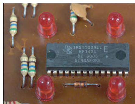
Bild 2. Der TMS1100 in einem Parker Brothers Merlin Game (Foto: Binarysequence - eigene Arbeit, Wikimedia Commons, CC BY-SA 4.0, <https://upload.wikimedia.org/wikipedia/commons/a/ad/Tms1100-merlin.png>).
