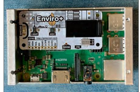
Bild 5. Enviro+ mit Tesa gesichert auf einem RPi 3B+.
