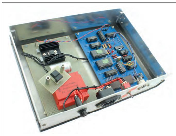
Bild 1. Intelektor mit abgenommenem Deckel. Der Interrupt-Taster ist ein „Digitast“-Typ mit taktilem Feedback auf einer kleinen Lochrasterplatine, die mit Abstandshaltern am Deckel befestigt ist.
