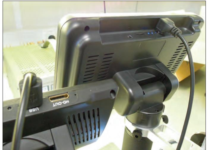
Bild 3. Der abgewinkelte USB-Stecker trägt zur Lebensdauer des Kabels bei.
