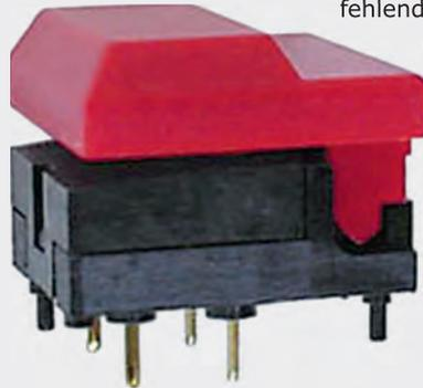
Art „Anti-Manipulationsloch“ gesichert ist. Problematisch an diesen Digitastern ist, dass sie alle den gleichen Platinen-Footprint haben, obwohl nur einige Modelle eine interne Drahtverbindung aufweisen. Wenn man also einen Digitast außerhalb der Platine montieren will, muss man die nun fehlende Verbindung auf der Platine durch eine Drahtbrücke ersetzen, damit das Ganze noch funktioniert.
