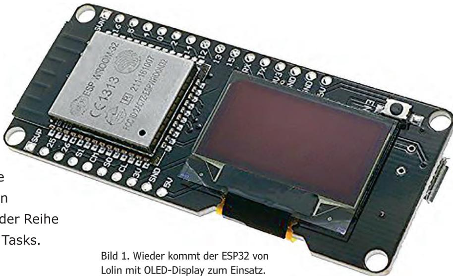
Bild 1. Wieder kommt der ESP32 von Lolin mit OLED-Display zum Einsatz.
