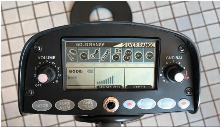
Bild 7. Display eines „richtigen“ Metalldetektors: Der Typ CS-400 von Velleman [1].
