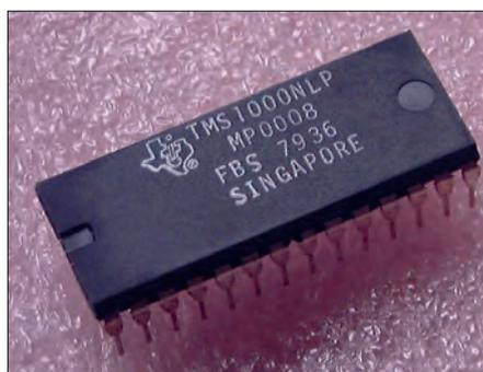
Bild 1. Ein TMS1000-Rechner auf einem Chip (Foto: Christian Bassow, Wikimedia Commons, CC BY-SA 4.0, [https://upload.wikimedia.org/wikipedia/commons/d/d1/TI\\_TMS1000NP\\_1.jpg](https://upload.wikimedia.org/wikipedia/commons/d/d1/TI_TMS1000NP_1.jpg))
