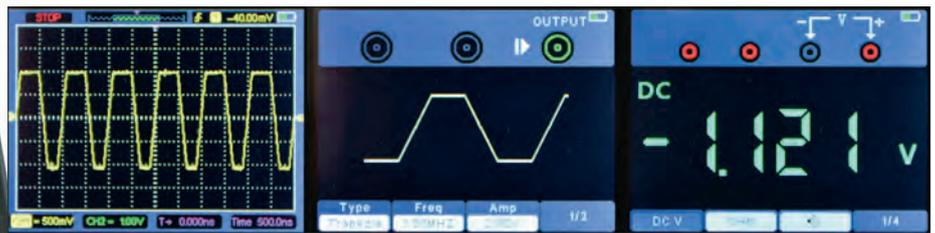
Trautes Nebeneinander: der Bildschirm des Oszilloskops, AWG und Multimeter.
