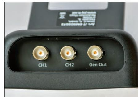
Die BNC-Buchsen sind ziemlich tief in die Oberseite des Gehäuses versenkt.
