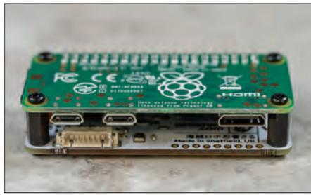
Bild 2. Zusammen mit einem RPi Zero W ergibt sich ein kompaktes Sandwich.
