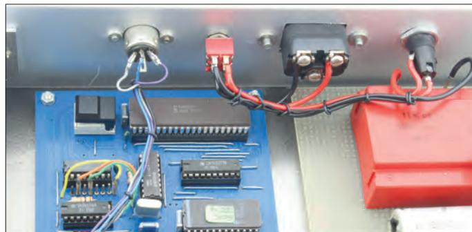
Bild 3. Die Rückseite des Intelektor-Gehäuses ist normalerweise nicht für das Publikum zugänglich. Beachten Sie auch den Platz auf der Platine für den INT-Taster, der extern per Kabel Teil angeschlossen ist.
