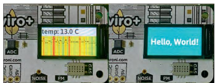
Bild 10. Das Display kann mit beliebigen Inhalten gefüttert werden. Auch hierfür stehen Python-Funktionen bereit.
