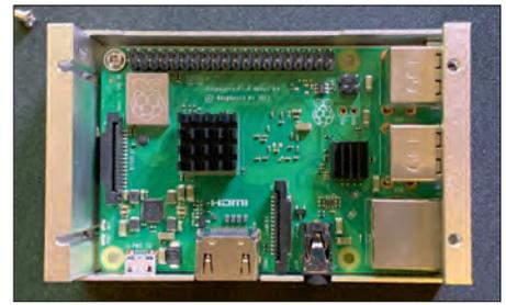
Bild 3. Bei einem RPi 3 oder 4 muss der Deckel ab, wenn das Board in ein blickdichtes oder gar ein Metallgehäuse eingebaut ist.
