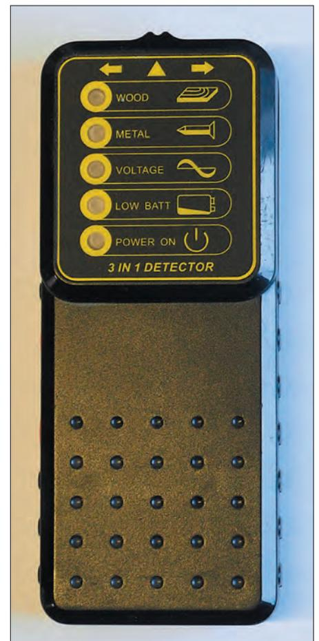
Bild 6. Einfacher Metalldetektor alias „Leitungssucher“ aus dem Baumarkt.
