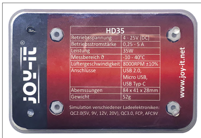
Bild 2. Die Plastik-Box von unten. Hier sind die technischen Daten und der Hersteller-URL angegeben.
