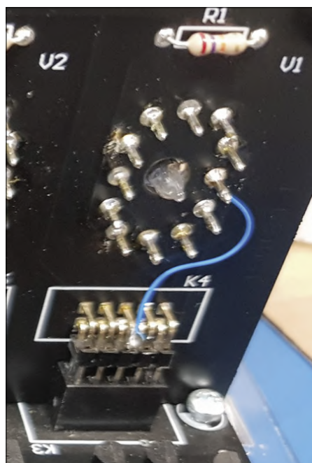
Bild 4. Verbindung des „3er-Elements“ der Nixie-Röhre V1 mit dem mittleren Pin auf der Oberseite von K4 (nur bei bestehenden Platinen).
