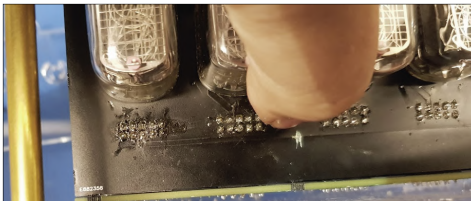
Bild 2. Die Leiterbahn muss (nur bei bestehenden Platinen) durchtrennt werden, um ein Neonlämpchen von seinem Treiber zu trennen.
