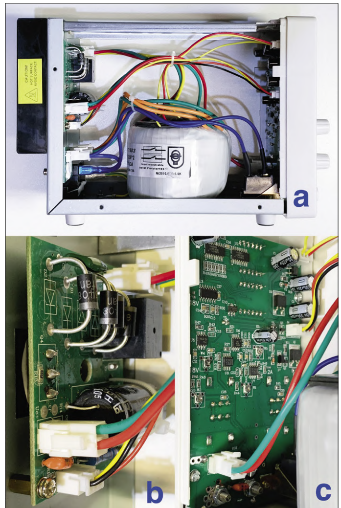
Bild 6. Innenleben des PT 6080 A mit Netztrafo, Leistungsplatine und Steuerteil mit SMDs.
