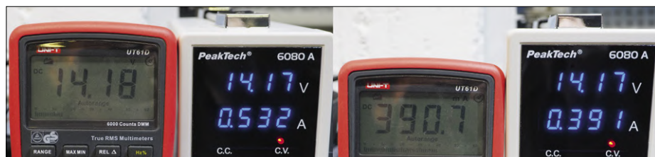
Bild 3. Vergleich von Multimeteranzeige und der Anzeige des Labornetzteils (links Spannung, rechts Strom).
