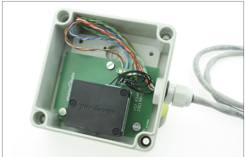
Bild 6. Die fertig bestückte Staub/Partikel-Sensorplatine, montiert in einem Gehäuse der Schutzklasse IP66.
