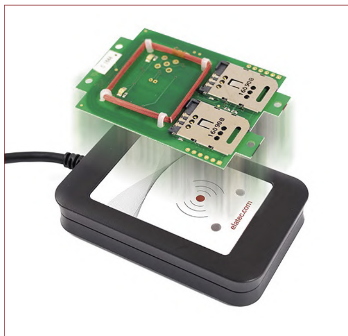
Bild 1. Externes Lesegerät TWN4 Multitech Legic 42.
