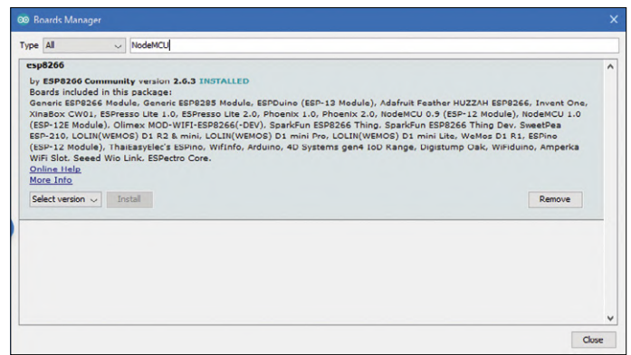
Bild 3. Installation der Bibliotheken für das Board ESP8266 NodeMCU.
