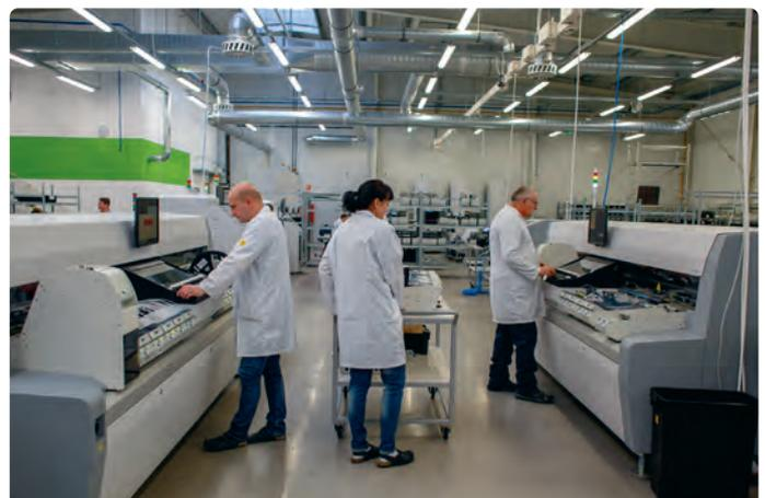
*Die Leiterplattenbestückung bei Eurocircuits in Eger/Ungarn ist für die Prototypenfertigung ab einer Baugruppe und sehr schnelle Produktwechsel optimiert.*
