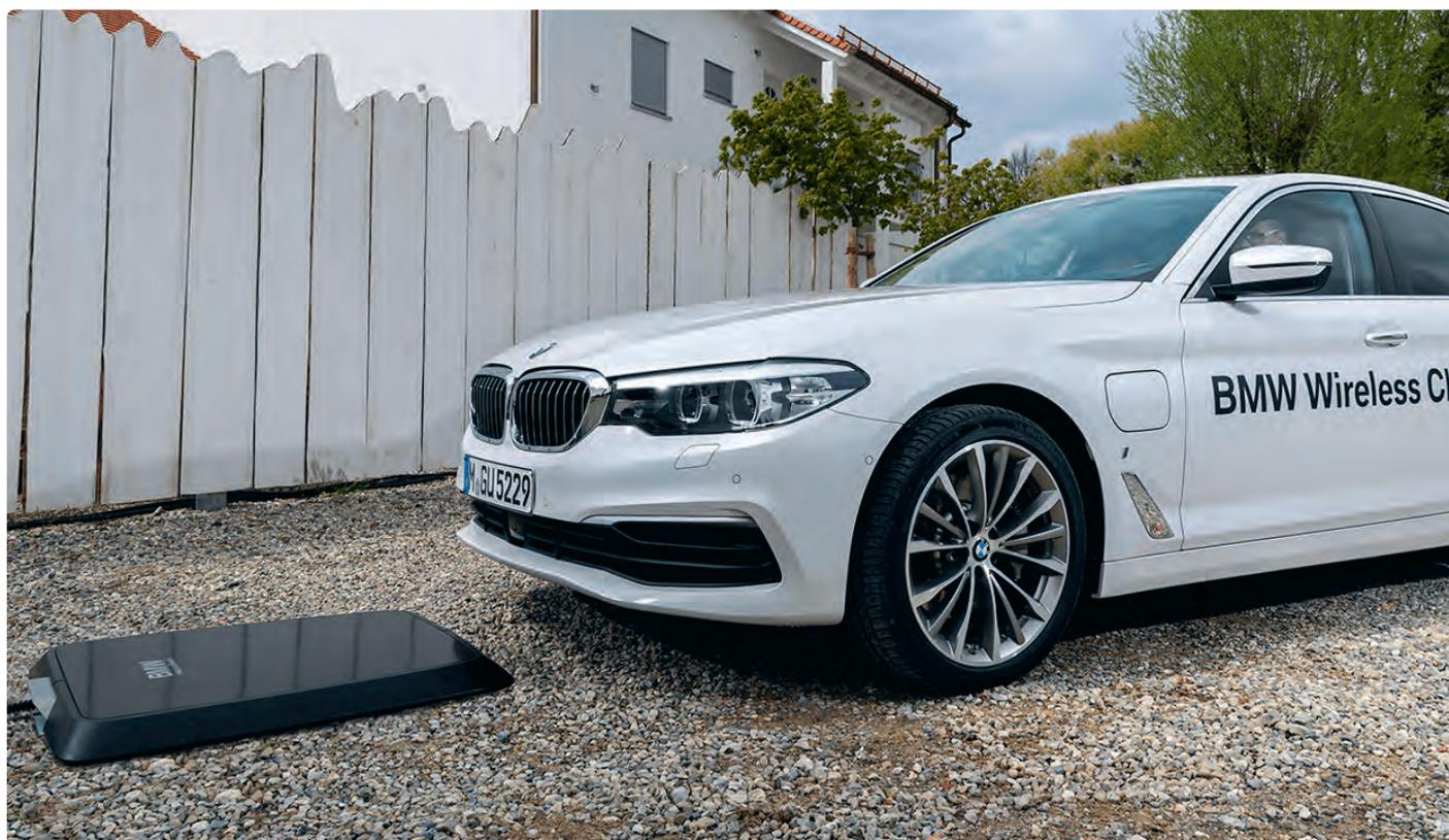
Bild 4. Kabelloses Laden von BMW mit Ladematte (Quelle: BMW).
