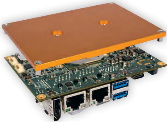
Bild 4. Die CPU befindet sich beim congatec Pico-ITX SBC auf der Unterseite. Lüfterlose passive Kühllösungen leiten die Abwärme direkt an das Gehäuse ab, für ein robustes System mit hoher Standzeit und MTBF ohne bewegte Teile.
