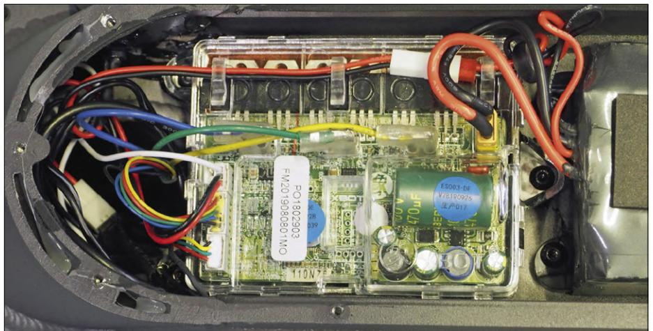
Bild 12. In der verkapselten Elektronik sind die sechs MOSFETs gut zu sehen.
