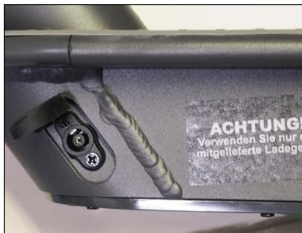
Bild 13. Ladebuchse auf der linken Seite des Scooters.
