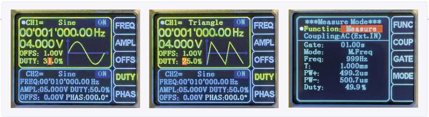
Bild 4. Bildschirm bei drei verschiedenen Modi: Sinus (links), Dreieck (Mitte) und Frequenzmessung (rechts).
