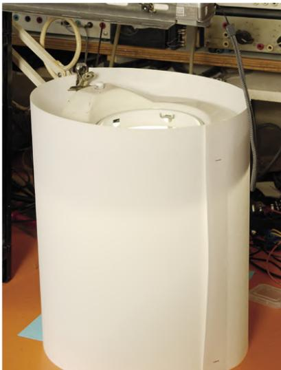
Bild 4. Mit ein paar Blatt Papier kann die Verteilung des Lichtes deutlich verbessert werden.
