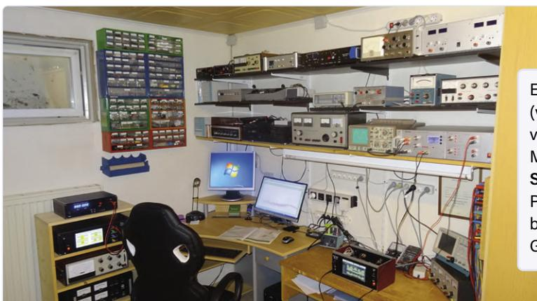
Eine Mischung aus Vintage-Instrumenten (vor allem Heathkit und Radio RIM) sowie vom Besitzer selbst entworfene und gebaute Mess- und Testgeräte zeichnen **Rainer Schusters** Heimlabor aus. Das aktuelle Projekt auf der Werkbank: ein Raspberry-Pi-4-basierter Gitarrenverstärker mit der virtuellen Gitarrenverstärker-Software „Guitarix“ für Linux.
