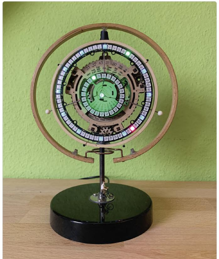
Bild 2. Nahaufnahme der kinetischen NeoPixel-Uhr.
