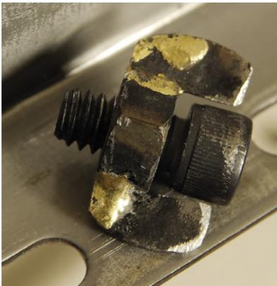
Bild 7. Selbstgemachte Flügelschraube.
