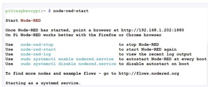
Bild 2. Starten von Node-RED von der Befehlszeile aus.
