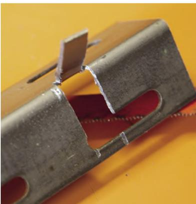
Bild 8. Damit die Schraube zur Stabilisierung des Galgens bei jeder Neujustierung nicht erneut extrem fest angezogen werden muss, wurde mit einer Metallsäge ein Blechstreifen ausgeschnitten und dieser nach außen gebogen.
