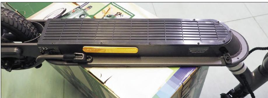
Bild 9. Der Unterboden ist aus Kunststoff und abschraubbar.
