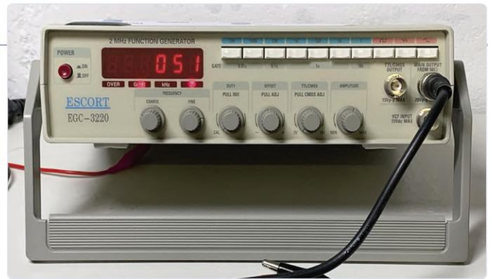
Bild 6. Zum Vergleich: So sieht mein alter, teleanaloger Funktionsgenerator aus. Ob da noch ein XR2206 drin steckt?
