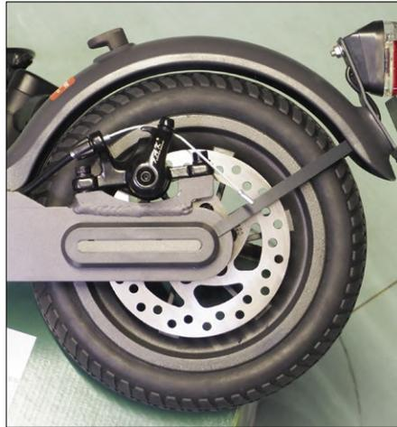
Bild 8. Hinterrad mit Scheibenbremse und Arretierung für den niedergeklappten Lenker.
