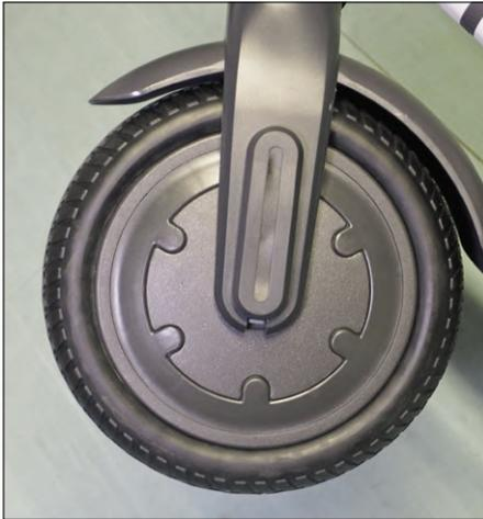
Bild 7. Vorderrad mit Nabenmotor und Vollgummireifen.
