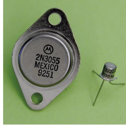
Bild 10. Größenvergleich zweier Transistoren.
