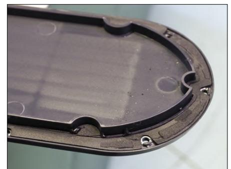
Bild 10. Abgeschraubter Deckel mit Schaumstoffdichtung.
