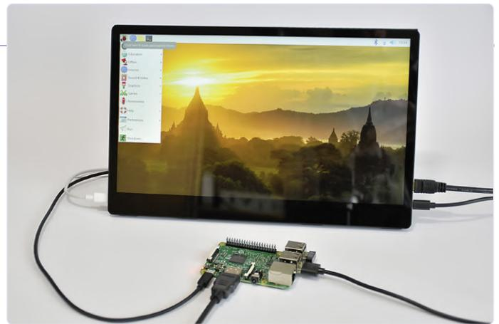
Bild 6. Joy-View 13 an einem Raspberry Pi 3B unter Raspbian.
