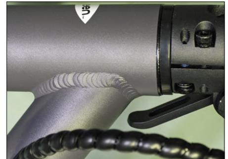
Bild 6. Stabile Schweißnähte und Klapp-Mechanismus.
