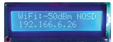
Bild 2. Das Display zeigt Statusmeldungen an. „NOSD“ bedeutet, dass keine Speicherkarte eingelegt ist.
