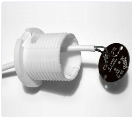
Bild 4. Die LED-Platine kommt oben auf die demontierte Lampenfassung.
