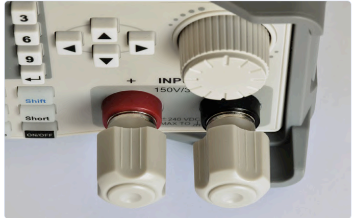
Die großen Schraubklemmen sind zwar robust, erlauben aber leider nicht die Verwendung von Bananensteckern.
