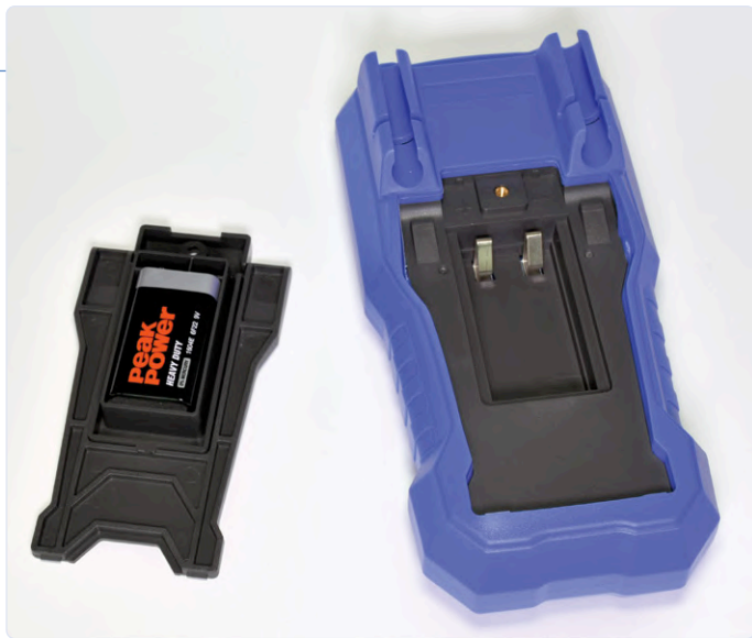
Die 9-V-Batterie befindet sich in einem separaten Halter, der in das Messgerät eingeklickt und angeschraubt wird.
