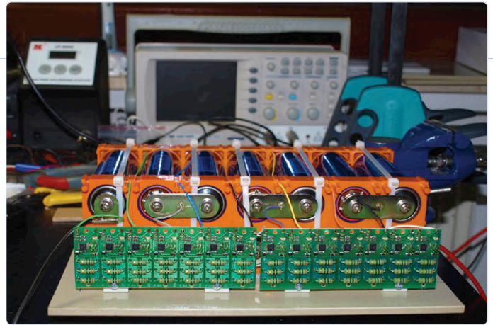
Bild 7. LiFePo-Akku mit Balancer aus dem Segway-Clone des Autors.
