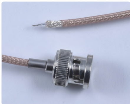
Bild 7. Koax-Kabel RG316 mit abisoliertem Ende und aufgedrimptem Stecker auf dem anderen Ende.
