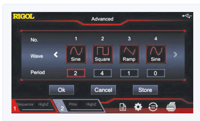
Bild 6. Der Sequenz-Modus ermöglicht die Verkettung mehrerer Wellenformen im „Direkt“-Modus.
