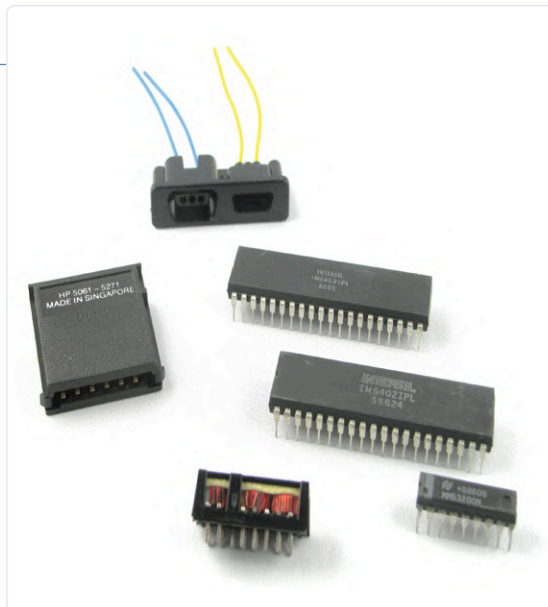
Bild 7. Die Spezial-Bauteile des HP-IL Interface Kits.
