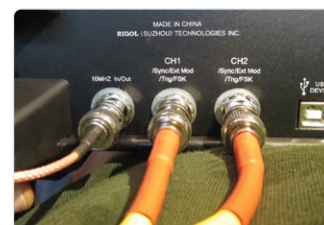
Bild 20. Der bedruckte Schrumpfschlauch hilft, Verwechslungen zu vermeiden.
