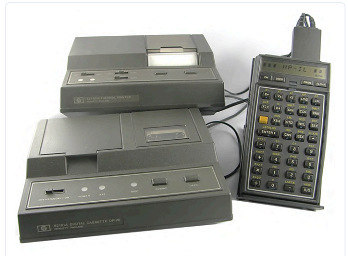
Bild 2. Ein HP-IL-System bestehend aus HP-41C, Kassettenlaufwerk und Thermodrucker.
