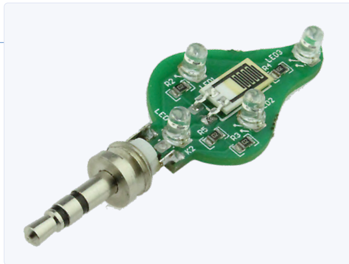
Bild 4a. Die Flammen-Platine mit den LEDs und dem Sensor mit angelötetem Klinkenstecker.
