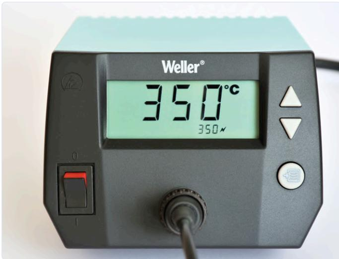
Bild 2. Das Display zeigt die Temperatur der Spitze und darunter etwas kleiner den Sollwert.
