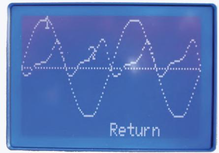
Bild 6c. Messung eines Transformators in Sättigung, Spannung und Leistung.
