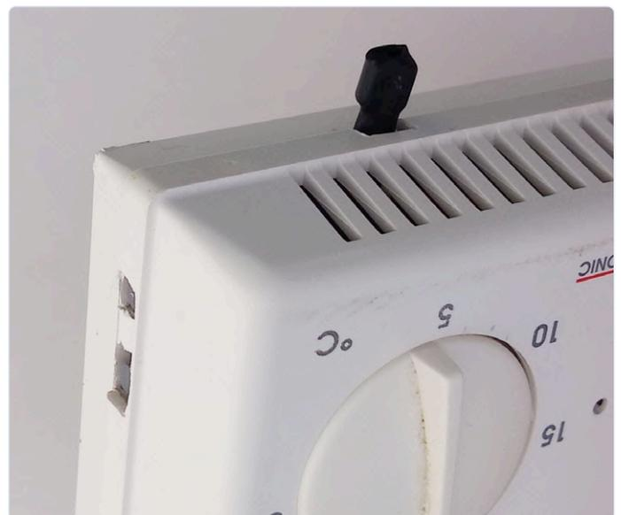
Bild 6. Mission accomplished! Die beiden Druckknöpfe sind durch zwei Ausschnitte (links) zugänglich und der Sensor ragt aus dem Boden heraus. Die grüne und die gelbe LED sind nur durch die Lüftungsschlitze sichtbar, um eine Illumination des Raumes bei Nacht zu vermeiden. Durch die unterschiedlichen Farben ist aber leicht zu erkennen, welche eingeschaltet ist.
