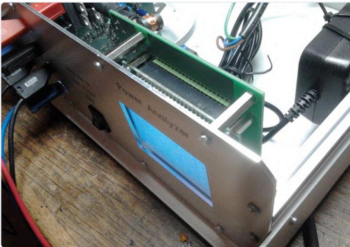
Bild 4a. Die Hauptplatine und das an der Frontplatte angebrachte Display.
