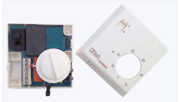
Bild 5. Dank einer geringfügigen Anpassung des alten Thermostatgehäuses (Abschneiden von etwas Kunststoff) passt die neue Platine gut.
