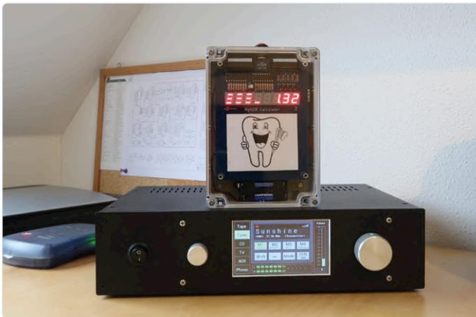
Bild 5. Dieser Zahnputztimer besteht aus MyNOR v1.0 plus der 7-Segment-Platine v1.0. Bei dem Gerät unter dem Timer handelt es sich übrigens um einen High-End-Empfänger (FM und DAB+) mit integriertem 11-Band-Equalizer und Touch-Control, den Dennis im vergangenen Jahr gebaut hat.
