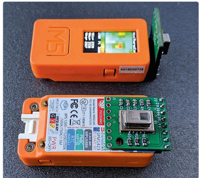
Bild 6. Gewinkelt oder gerade: zwei Befestigungsmöglichkeiten des Sensors am M5StickC.
