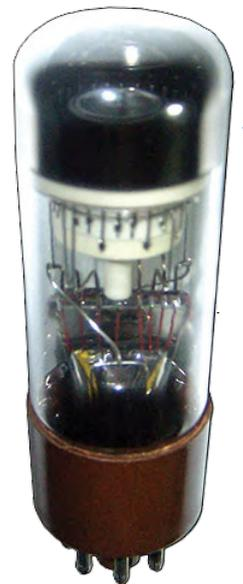
Bit mit einem eigenen Pin verdrahtet und die übrigen Zählkathoden sind mit einem einzigen Pin verbunden. Bei der Selektorkonfiguration in Bild 1 sind alle Zählkathoden auf separate Pins herausgeführt. Die meisten Dekatrons sind mit Wasserstoff gefüllt, der ihre Zählgeschwindigkeit auf etwa 4 kHz begrenzt, wobei in einigen Fällen auch eine maximale Geschwindigkeit von 10 kHz möglich ist.
