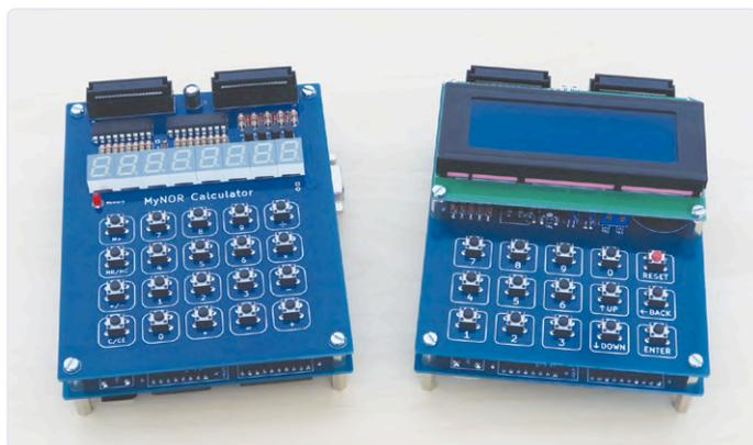
Bild 4. Links der Taschenrechner und rechts der MyNOR mit Tastatur und Display.
