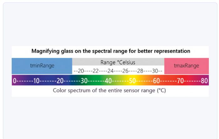
Bild 8. Der Messbereich wird über den gewünschten Ausschnitt des Spektrums gespannt.
