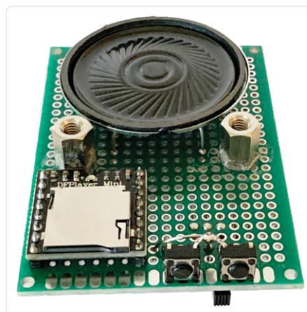
Bild 2. Die Elektronik kann kompakt auf einem Stück Lochrasterplatine aufgebaut werden.
