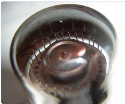
Bild 2. Foto einer Dekatron-Röhre mit seinen 30 Stiften [3].
