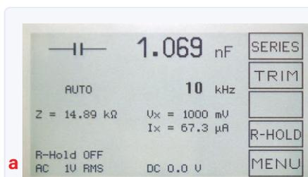
Bild 5a. Messung eines kleinen Kondensators bei höherer Frequenz.
