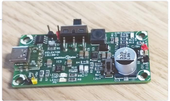
Bild 3. Die endgültige und vollständig bestückte Platinenversion.
