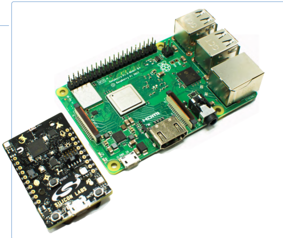
Bild 1. UrsaLeo IoT-Hardware – bestehend aus einem Thunderboard 2-Modul und einem Raspberry Pi 3B+.
