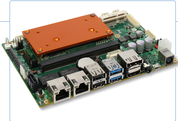
Bild 4. Congatec wird sein applikationsfertiges Embedded Vision Set nun auch mit dem neuen SMARC 2.1 conga-SMX8-Plus Modul mit i.MX 8M Plus Prozessoren ausrüsten.
