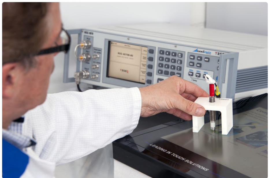
Bild 2. EMV-Prüfung der leitungsgebundenen Störfestigkeit eines Touchpanels.
