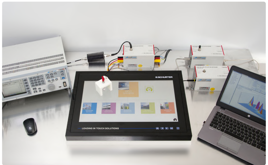
Bild 1. EMV-Prüfaufbau für die leitungsgebundene Störfestigkeit von Touchpanels.
