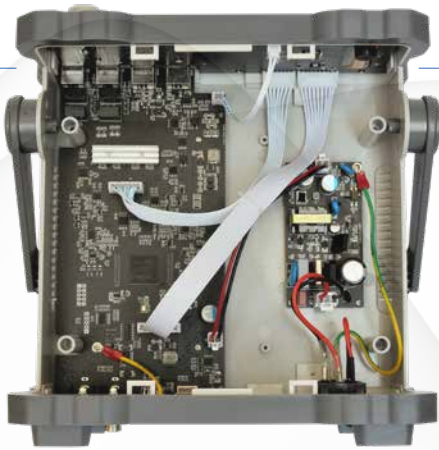
Bild 4. Das Innenleben des PSG9080. Das Herzstück ist ein Xilinx Spartan-6, der in der Mitte auf der großen Platine angeordnet ist. Rechts befindet sich die Spannungsversorgung.
