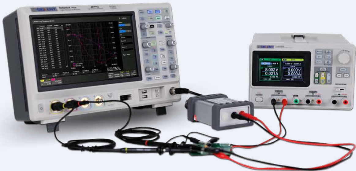
Bild 1. Um die Phasen- und Amplitudenreserve von rückgekoppelten Systemen zu messen, werden typischerweise Bode-Diagramme verwendet.
