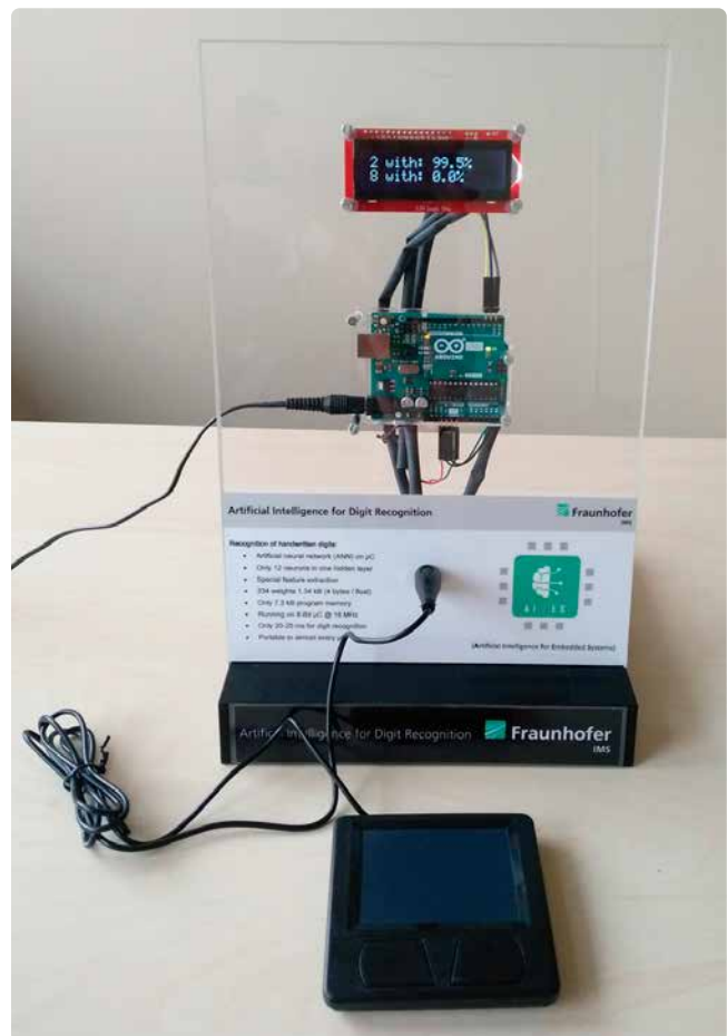
Bild 5. Das AIFES des Fraunhofer-Instituts für Mikroelektronische Schaltungen und Systeme betreibt Handschrifterkennung auf einem Arduino Uno (Copyright: Fraunhofer IMS).
