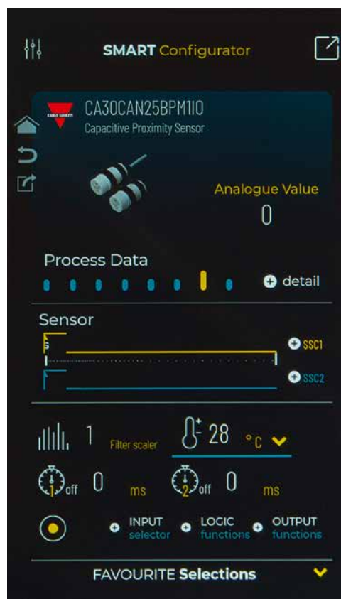
Bild 2: Der Smart Configurator von Carlo Gavazzi gibt Service-Technikern Zugriff auf Parameter, Prozessdaten und Diagnoseinformationen von Sensoren und ermöglicht Anpassungen vor Ort.
