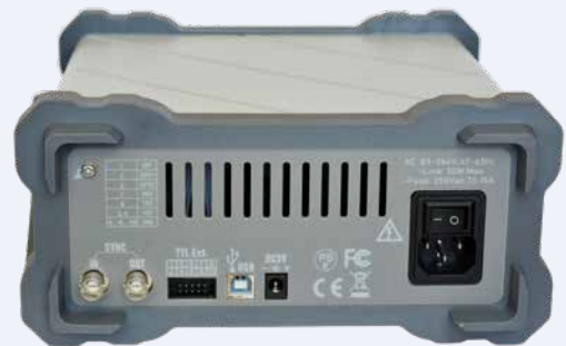
Bild 2. Die Rückseite des Generators, unter anderem mit einem echten Netzschalter und einem USB-Anschluss.
