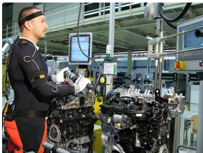
Bild 1. Bewegungs-Digitalisierungseinheit bei der Datenerfassung.
