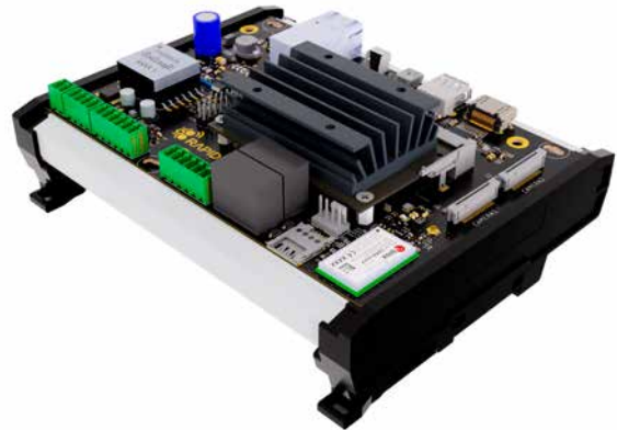
Bild 4. ML mit niedriger Latenz wird durch Lösungen wie das „Edge AI Gateway“ von RapidLab mit dem Jetson Nano von NVIDIA ermöglicht (Quelle: rapidLAB.io).
