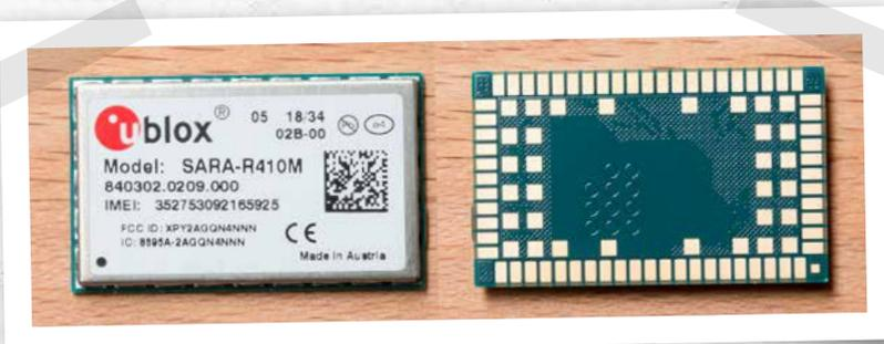
Bild 4. Vorder- und Rückseite des Ublox-SARA-Moduls.
