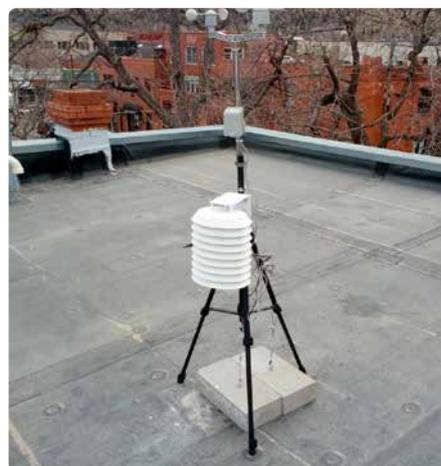
Bild 2. Die alte Wetterstation auf dem Stativ ist mit zwei schweren Betonsteinen gesichert.
