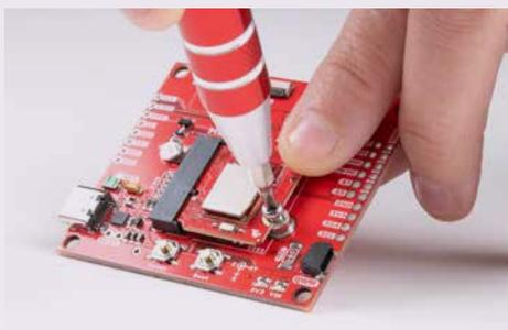
Bild 4. Halten Sie die MicroMod Prozessorplatine fest und ziehen Sie die Kreuzschlitzschraube vorsichtig an.
