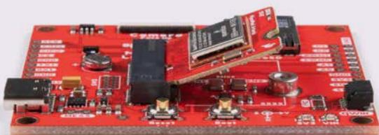
Bild 3. Das MicroMod-Prozessorboard wird in einem Winkel von etwa 25 Grad eingeschoben.
