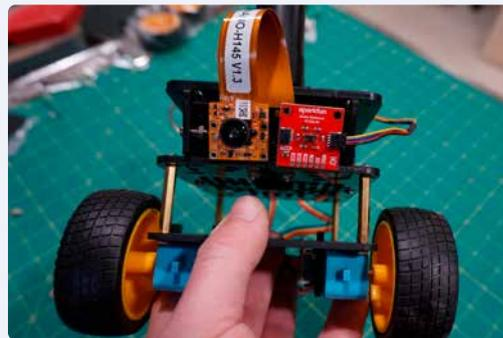
Bild 5. Vorderansicht mit dem Qwiic-kompatiblen ToF-Abstandssensor und dem Kameramodul auf der Halterung.
