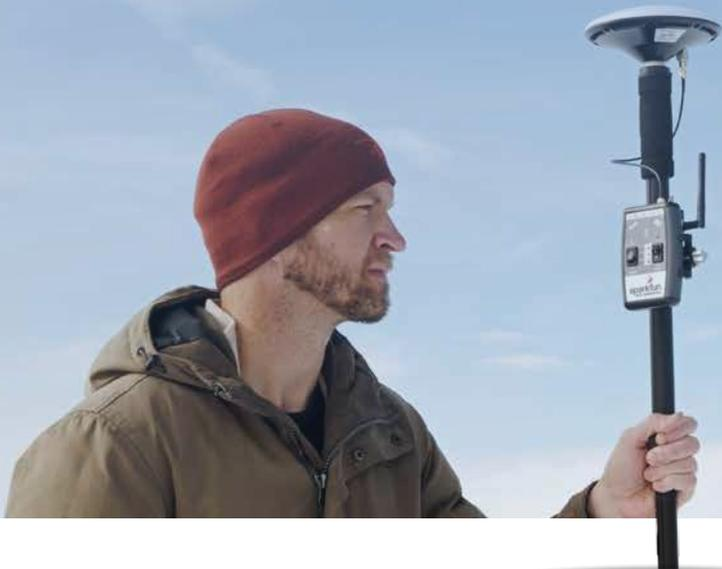
Der RTK-Surveyor ist ein GNSS-Empfänger, den Sie zur präzisen Positionsbestimmung verwenden können. Neugierig auf den Entwicklungsprozess bis zur Markteinführung? Dann lassen Sie uns einen Blick darauf werfen!
