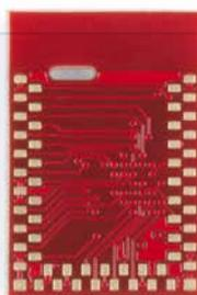
Bild 4. Rückansicht des Artemis-Moduls.
