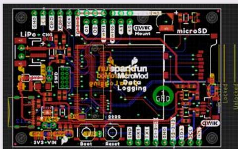
Bild 6. Fertiges Platinenlayout mit Schaltplan für eine Trägerplatine im Eagle-PCB-Format.
