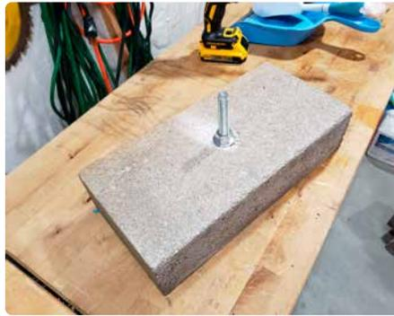
Bild 5. Der Bolzenanker wird nur leicht angezogen - und der Betonstein bleibt intakt!
