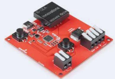
Bild 14. Zugangscontrolle basierend auf RFID.
