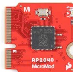
Bild 7. MicroMod RP2040 Processor Board
