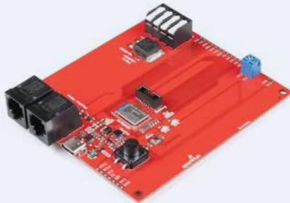
Bild 12. Platine für eine Wetterstation.
