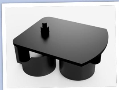
Dieses Bild zeigt die beiden Ausgangswellen. Die mittlere, längere Welle ist direkt mit dem Motor verbunden. Die äußere Welle ist mit dem Getriebe gekoppelt, das durch den zweiten, versetzten Motor angetrieben wird. Die Stunden- und Minutenzeiger sind auf diesen beiden Wellen aufgesteckt, aber nicht fest verbunden.
