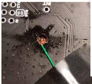
Bild 14c. Die Litze ist erfolgreich durch die Leiterplatte auf das Pad gelötet.
