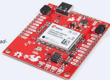
Bild 4. Qwiic-Sensorik mit dem GPS-RTK-Dead-Reckoning-Breakout ZED-F9.
