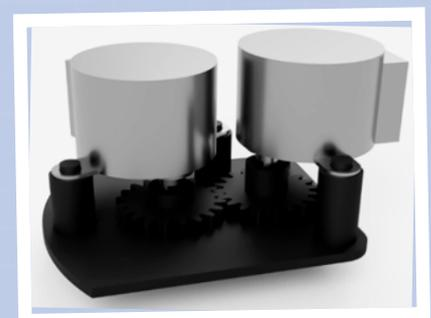
Die Motoren wurden einfach auf die Montagezapfen geklebt. Alle Teile wurden auf meinem Prusa MK3S in schwarzem PLA gedruckt.
