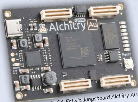
Bild 1. Das FPGA-Entwicklungsboard Alchitry Au.
