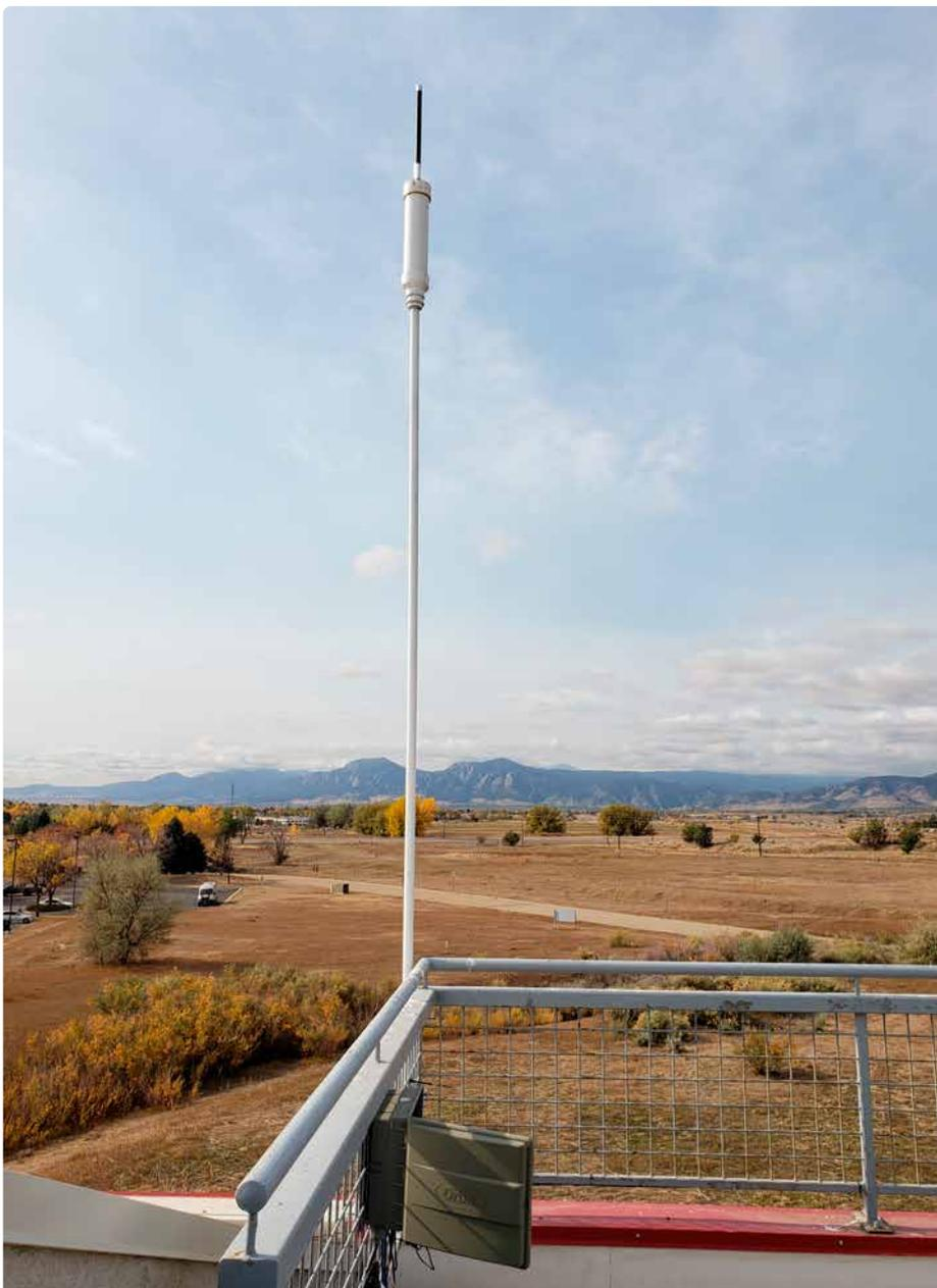
Bild 25. Die ISM-Antenne von SparkFun.
