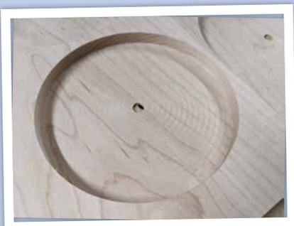
Die Frontplatte geriet leider etwas dünner, als ich ursprünglich geplant hatte. Das führte dazu, dass die Böden der runden Vertiefungen nach dem Fräsen nur 1,5 mm dick wurden. Zum Glück trotzdem noch ausreichend stark.
