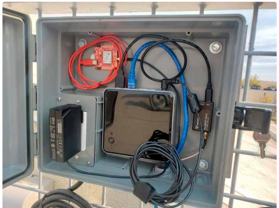
Bild 19. Mini-PC, verbunden mit einem ZED-F9P und einem über USB angeschlossenen ISM-Funkmodul.
