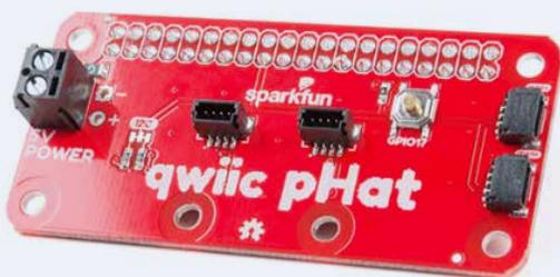
Bild 3. pHat v. 3.0 für den Raspberry Pi.
