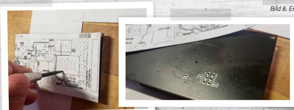
Bild 6a. Der gefederte Körner markiert die Stelle.
