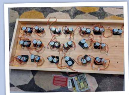
Die einzelnen Uhrwerke wurden von hinten an die Frontplatte geklebt. Vier von ihnen sind in abweichenden Winkeln angeordnet, um Platz für die Stromversorgung zu schaffen, ein 12-V-6-A-Netzteil, das für alle Motoren ausreicht.
