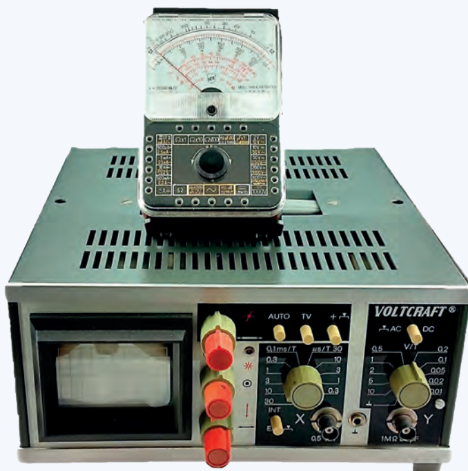
Bild 3. Analoges Oszilloskop und Multimeter – die wichtigsten Messgeräte der 70er Jahre!
