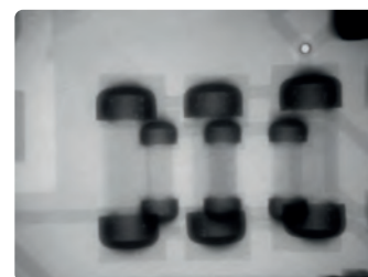
Bild 3b. MELF ohne Mid-Chip-Lotkugeln.
