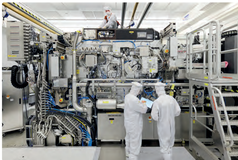
Bild 1: Montage von EUV-Lithografieanlagen, die die Massenproduktion der neuesten 7- und 5-nm-Knoten ermöglichen. (Quelle: ASML Holding N.V.)
