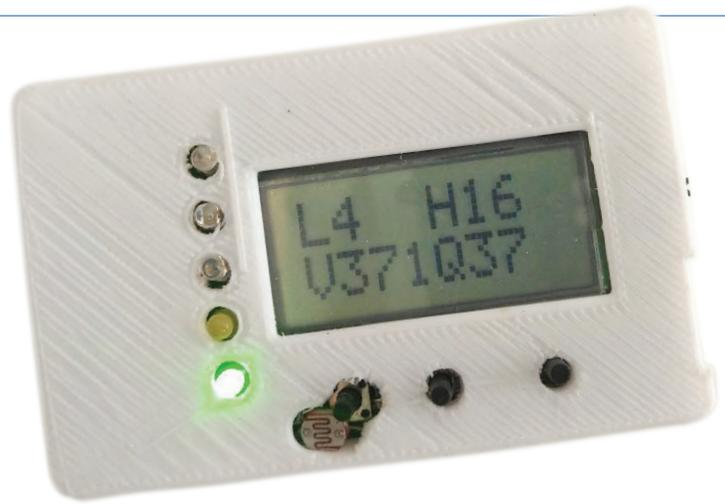
Bild 3. Vorderansicht des  $PM_{2,5}$ -Messgeräts im 3D-gedruckten Gehäuse.
