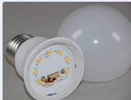
Bild 4. Bei defekten LED-Lampen ist in der Regel die Steuerschaltung beschädigt. Die LEDs sind meist nicht betroffen und dürfen weiterleben.
