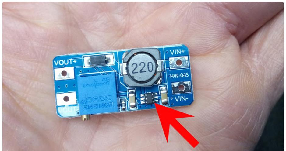
Bild 1. Das preiswerte Aufwärtswandler-Modul MT3608 kann aus einer Eingangsspannung von nur 2 V bis zu 28 V erzeugen. Der Pfeil zeigt auf Pin 4.
