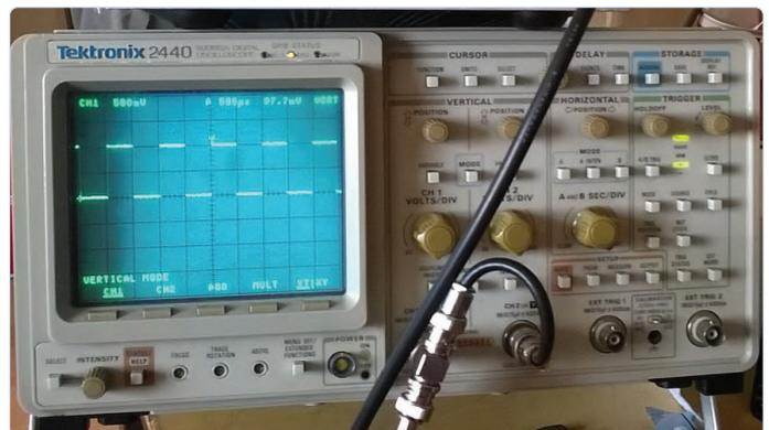
Bild 2. Das zweikanalige Digital Sampling Oszilloskop Tektronix 2400 (300 MHz, 500 MS/s) aus den späten 1980er Jahren (Quelle: tekwiki [2]).
