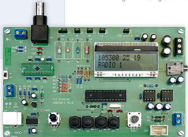
Bild 10. Das Elektor-DSP-Radio.
