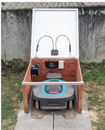
Bild 10. Alles fertig: Solargarage mit eingebauter Elektronik.
