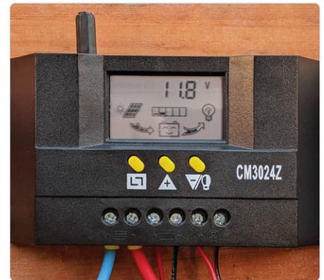
Bild 4. Preiswerter Solar-Laderegler in PWM-Technik mit Strömen bis zu 30 A.
