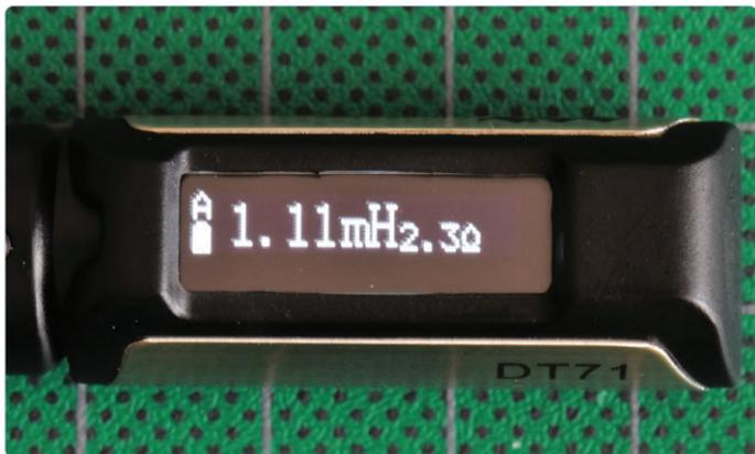
Bild 4. Das OLED-Display zeigt normalerweise nur den Wert an, aber in der Auto-Einstellung erscheint wie bei dieser Induktivität manchmal auch ein zweiter Wert.
