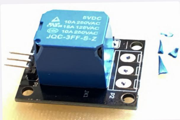
Bild 3a. Nach Auslöten der Platinenanschlussklemme wird der Relaisabdeckung zu Leibe gerückt.
