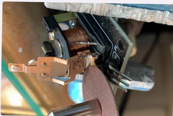
Bild 3c. Der Schaltkontakt wird entfernt und der Kern abgeflex.
