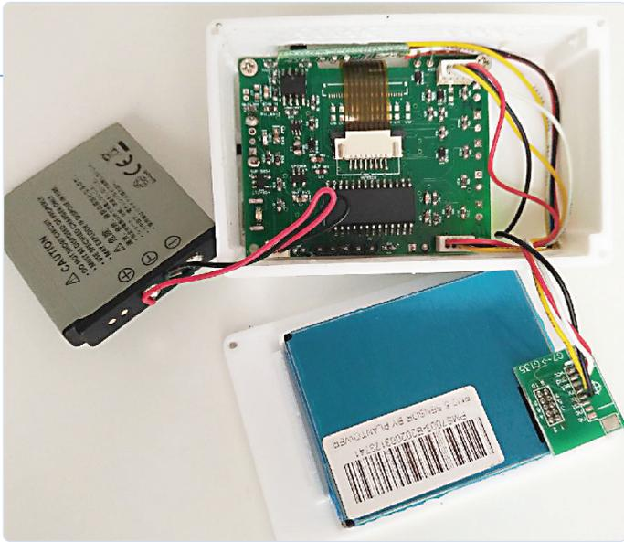
Bild 2. Platine, Batterie und PMS7003-Sensor bei geöffnetem Gehäuse.
