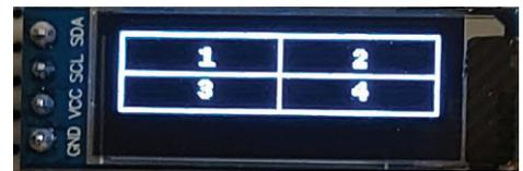
Bild 9. OLEDShape1.py erzeugt Rechtecke auf dem Bildschirm.
