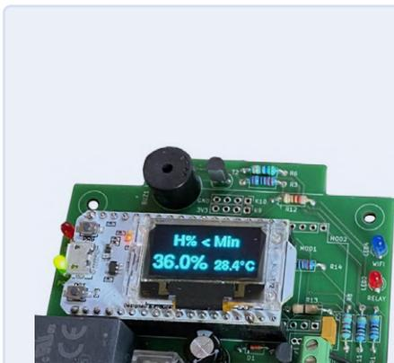
Bild 4. Das zum Feuchteregler umprogrammierte Thermostat ist mit einem WiFi-Kit 32 von Heltec versehen, das ein eigenes OLED-Display mitbringt.
