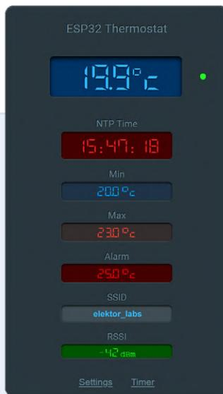
Bild 5. Die Hauptseite des GUI zeigt die aktuelle Temperatur und die eingestellten Schalt- und Alarmschwellen.
