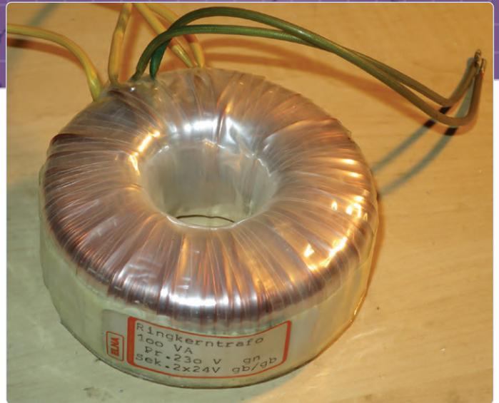
Bild 4. Der für die Experimente verwendete 100-W-Ringkerntransformator.
