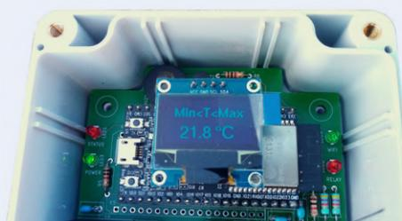
Bild 3. Der Prototyp aus dem Elektor-Labor verwendet ein ESP32-DevKitC-Modul mit einem separaten OLED-Display-Modul.
