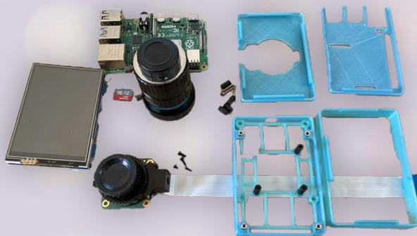
Bild 7. Alle Teile des Kamera-Baukastens.
