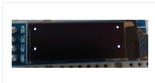
Bild 6. Wir haben Pixel an den vier Ecken des OLED-Displays gezeichnet!
