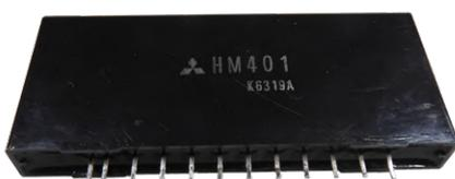
Bild 4. Durch den Vollverguss ist die Funktionsweise dieses Treibers für Klimageräte nicht einfach zu ermitteln.
