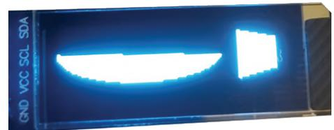
Bild 10. Die Anzeige nach dem Ausführen von OLEDShape2.py (Kreissegment und Polygon).
