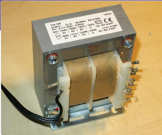
Bild 7. Verhält sich dieser 120-W-EI-Kern-Transformator anders als der Ringkerntransformator?
