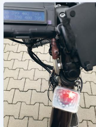
Bild 5. Der aufgebaute Kompass am Fahrradrahmen.
