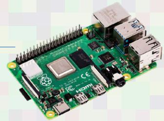
Bild 4. Raspberry Pi 4 Board (Quelle: Raspberry Pi Foundation).
