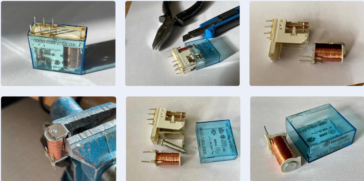
Bild 3. Demontage des Relais und Vorbereitung der Magnetspule.
