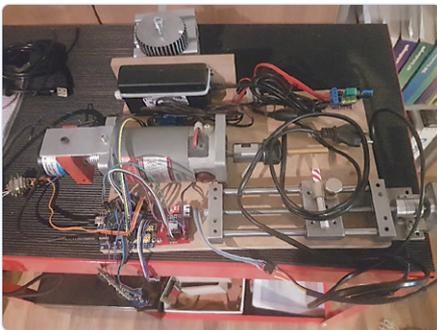
*Bild 1. Ein früher Prototyp mit einem Gleichstrommotor für die „Hauptspindel“, einem Nema-17-Schrittmotor für die Führungsspindel und einer Motorsteuerung mit einem einfachen PWM-Modul.*
