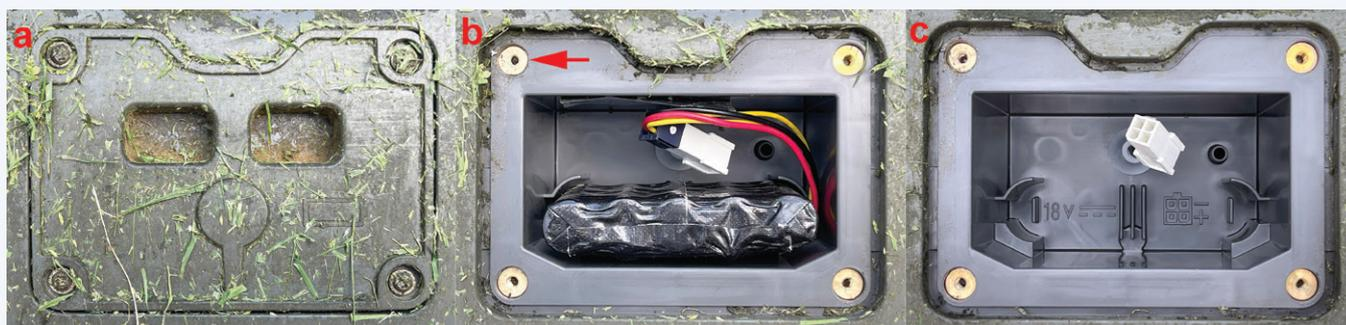
*Bild 2. Der Deckel des Akkufachs (2a), der alte Akku im Akku-Fach (2b) und das leere Akku-Fach (2c).*
