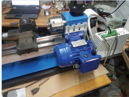
Bild 7. Hier ist schon der 0,37-kW-Motor mit einer Adapterplatte montiert.
