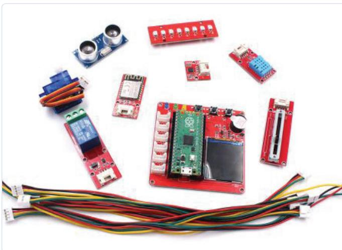
Bild 8. Elektor Raspberry Pi Pico Experimenting Kit (Quelle: Makerfabs).
