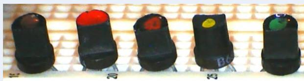
Bild 1. 2N2926-Transistoren. Die Farbe gibt die Transistorverstärkung  $h_{FE}$  an: braun 35...70, rot 55...110, orange 90...180, gelb 150...300 und grün 235...470.
