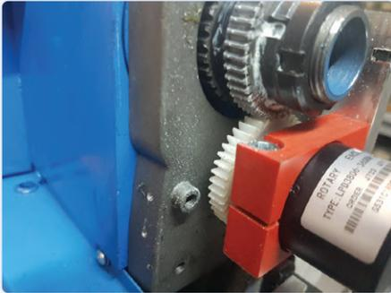
Bild 6. ...und über ein aus dem demontierten Getriebe „gerettetes“ Zahnrad angetrieben.
