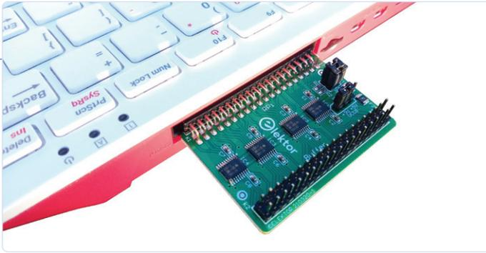
Bild 3. Die Pufferplatine, eingesteckt in den Raspberry Pi 400.
