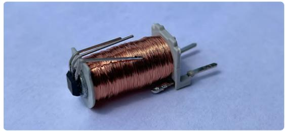
Bild 4. Der Hallsensor, der auf den Eisenkern der Spule geklebt ist.
