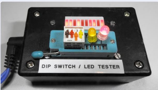
Bild 3. Eine selbstgebaute Testeinrichtung für DIP-Schalter und LEDs im Einsatz.
