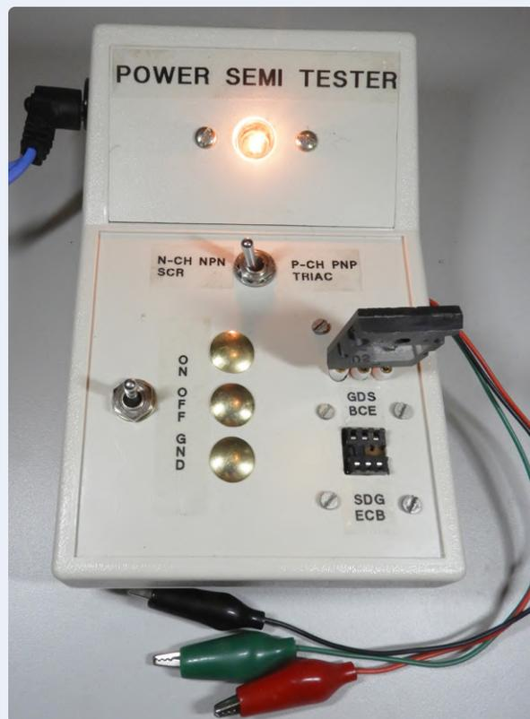
Bild 2. Ein einfacher Leistungshalbleitertester testet MOSFETs, Transistoren, Thyristoren und Triacs.
