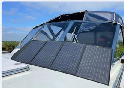
Bild 9. Das von Martin und Detlev verwendete faltbare Solarpanel liefert 120 Wp und wird bei Fahrt unter Deck verstaut (Bild: Martin Jepkens).
