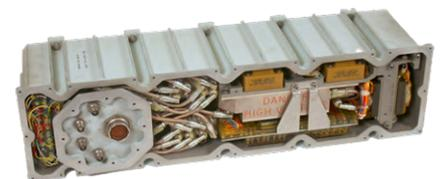
Bild 3. Der Collins-Radio-Verstärker, der mit mehreren Volt arbeitet, war ein dicht gepacktes Gewirr von Koaxialkabeln. (Quelle: Ken Shirriff)
