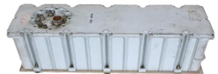
Bild 2. S-Band Wanderfeldröhrenverstärker „Collins Radio“, der während der Apollo-Mission für die Kommunikation mit der Erde verwendet wurde. (Quelle: Ken Shirriff)
