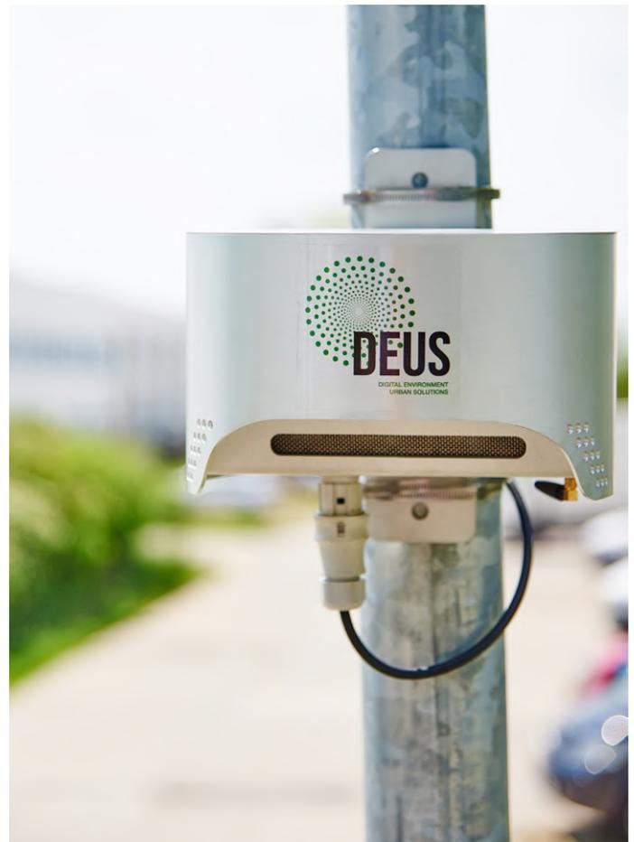
Bild 5. Feinstaubsensoren von DEUS POLLUTRACK sammeln Daten von stationären und mobilen IoT-Geräten. Die Daten werden über 4G- und 5G-Mobilfunknetze an das Backend übermittelt. (Quelle: DEUS POLLUTRACK)
