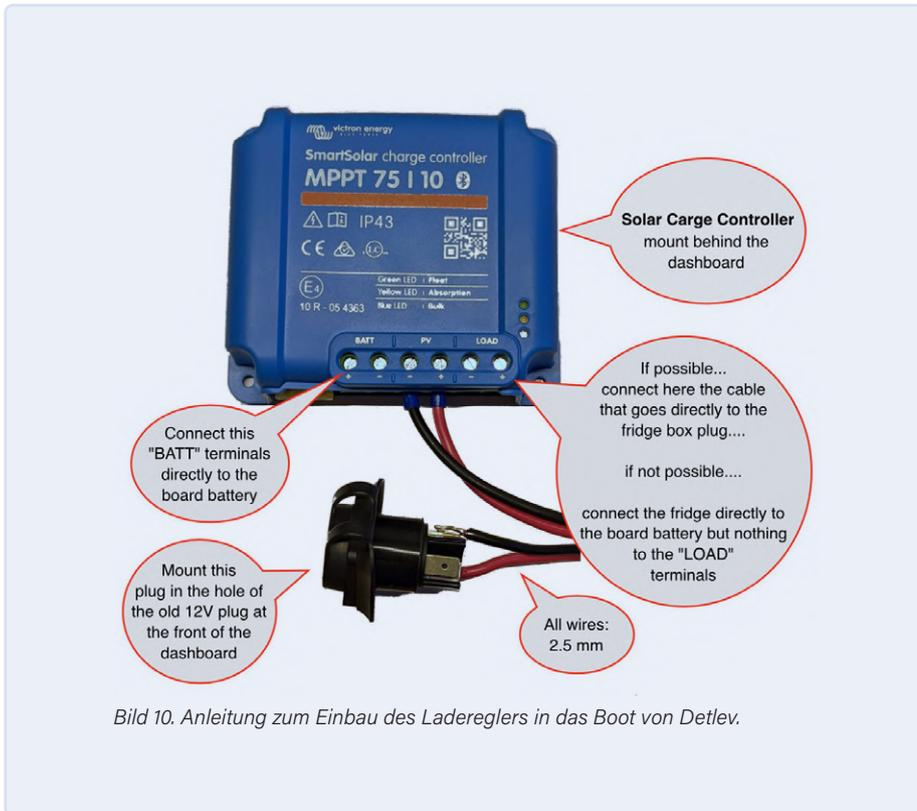
Bild 10. Anleitung zum Einbau des Ladereglers in das Boot von Detlev.
