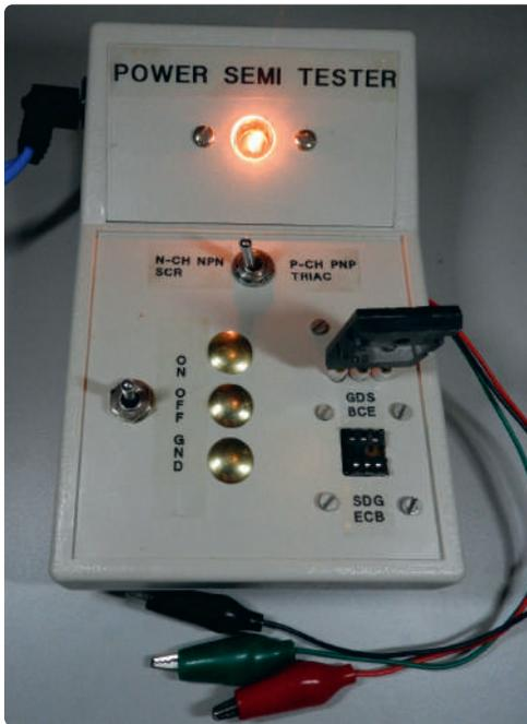
Bild 2. Der fertige Leistungshalbleiter-Tester.
