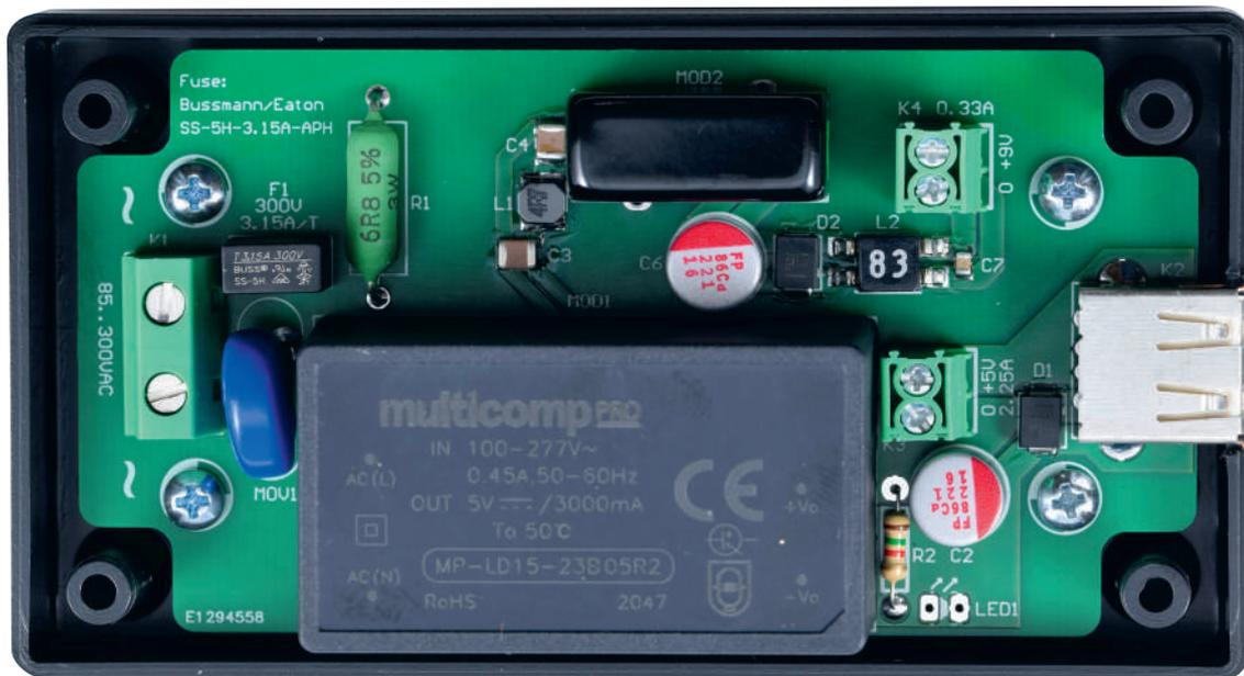
Bild 3. Ein früher Prototyp, montiert im Gehäuse.
