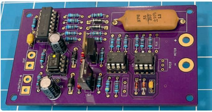
Bild 6. Die bestückte Platine ist bereit zum Test.
