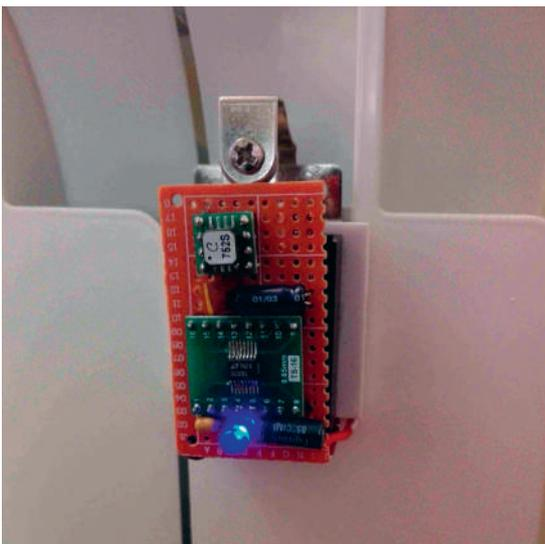
Bild 2. Die an der Vorderseite eines Heizkörpers befestigte Schaltung wird bei einem Temperaturanstieg aktiv.
