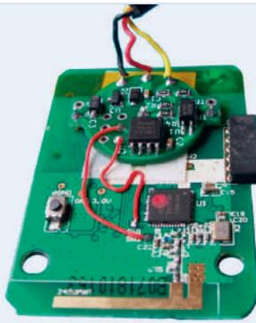
Bild 2. Die Platine ersetzt die Batterie der Fernbedienung.
