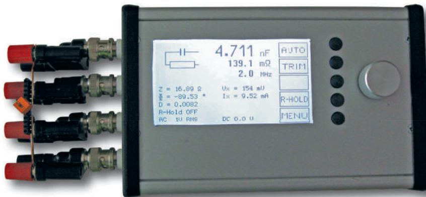
Bild 3. Das 2-MHz-LCR-Messgerät mit selbstgebautem Messadapter und einem 4,7-nF-Kondensator mit einer Toleranz von 1%.
