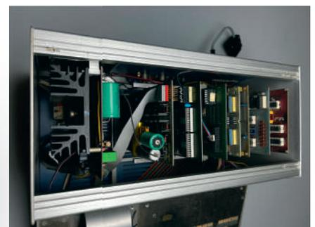
Überblick über ein komplettes SC/MP-System, das Elektor Retronics 2021 geschenkt wurde. Nach dem Öffnen des Gehäuses kommt die DIN-64C-Backplane mit der CPU und den verschiedenen aufgesteckten Erweiterungsplatinen zum Vorschein.
