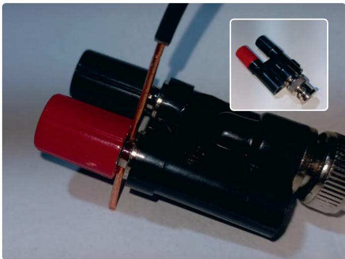
Bild 1. Vier dieser BNC-zu-Bananenbuchsen-Adapter werden verwendet. Der 1,5-mm<sup>2</sup>-Draht kann leicht angebracht werden.
