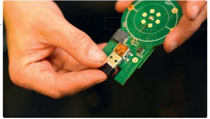
Bild 5. Zertifizierte Standardmodule und „Dongles“ erleichtert die Entwicklung eines komplexen Geräts wie dem Hautanalysegerät Observ 520x.
