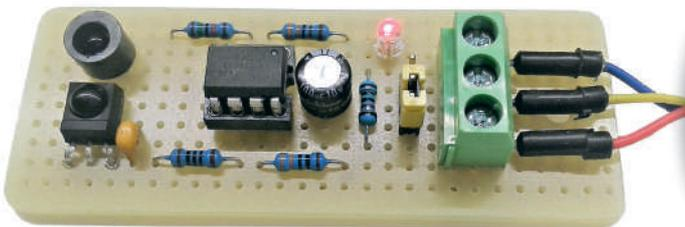
Bild 3. Es kann erforderlich sein, die IR-LED mit einem kurzen Röhrchen oder einem Stück Plastikschlauch abzuschirmen, um einen instabilen Betrieb aufgrund eines zu breiten IR-Lichtstrahls zu vermeiden.
