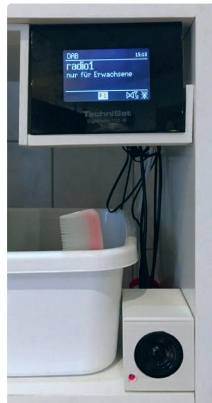
Bild 1. Im Badezimmer: Unter dem verstärkerlosen Digitalradio sitzt unten der selbstgebaute, automatisch einschaltende Aktivlautsprecher.
