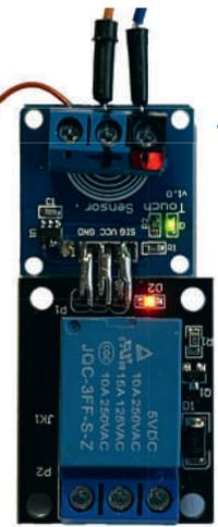
Bild 1. Der blaue Sensor und die Relaisplatine sind angeschlossen.
