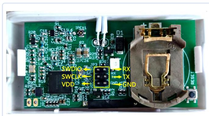
Bild 14. Dragino LDS01 mit geöffnetem Gehäuse.
