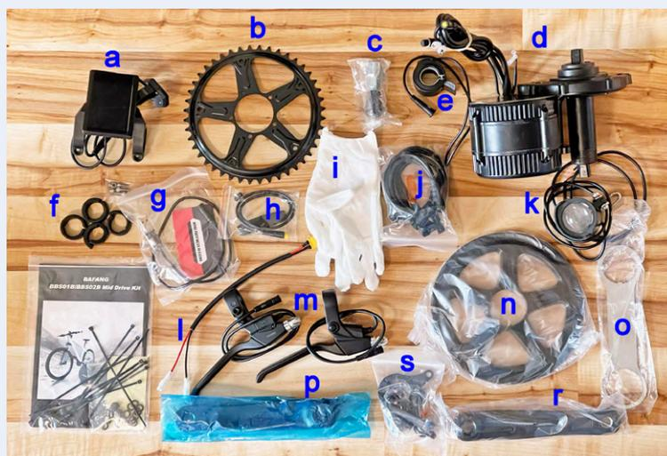
Bild 3. Der Lieferumfang ohne Akku. a: Display mit Halterung, b: Kettenblatt, c: Kurbelabzieher, e: Daumengas, d: Motor, f: Lenker-Distanzringe, g: USB/TTL-Interface, h: Schaltunterbrecher, i: Handschuhe, j: Kabelbaum, k: LED-Scheinwerfer vorne, h: Anleitung und Kleinkram, l: Akkuanschluss, m: Bremsgriffe, n: Kettenblattabdeckung, o: Radlagerschlüssel, p: Pedalkurbel links, s: Motorbefestigung, r: Pedalkurbel rechts.
