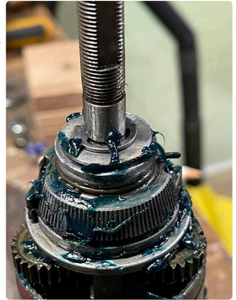
Bild 6. Innenleben einer Siebengang-Nabenschaltung, nach entferntem Rücktritt neu gefettet.
