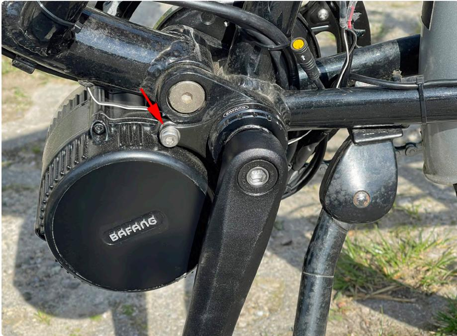
Bild 8. Motor und Befestigung links. Da mein Tretlager 70 mm breit war, brauchte der Halter noch Edelstahl-U-Scheiben (Pfeil) mit 6-mm-Bohrung.
