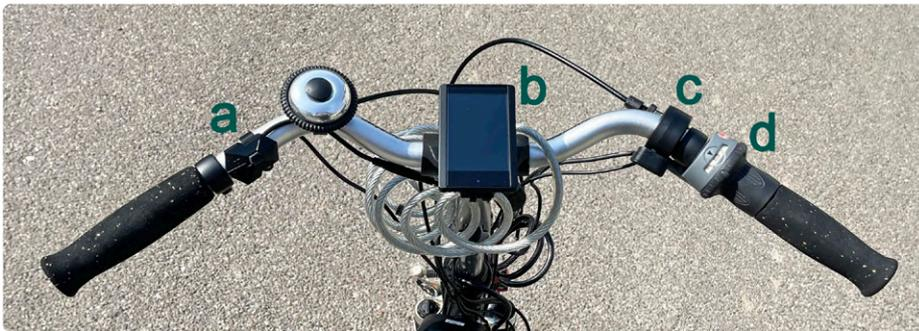
Bild 9. Neue Lenkerbestückung. a: Bedientastenfeld, b: Display, c: Daumengas (Anfahrhilfe), d: Schaltgriff vor Umbau auf Inter-5E.
