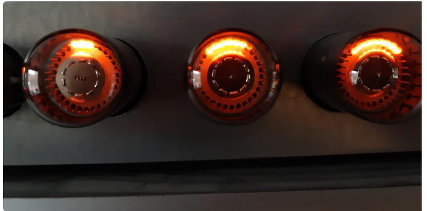
Bild 7. Nahaufnahme der Dekatron-Punktanzeige.
