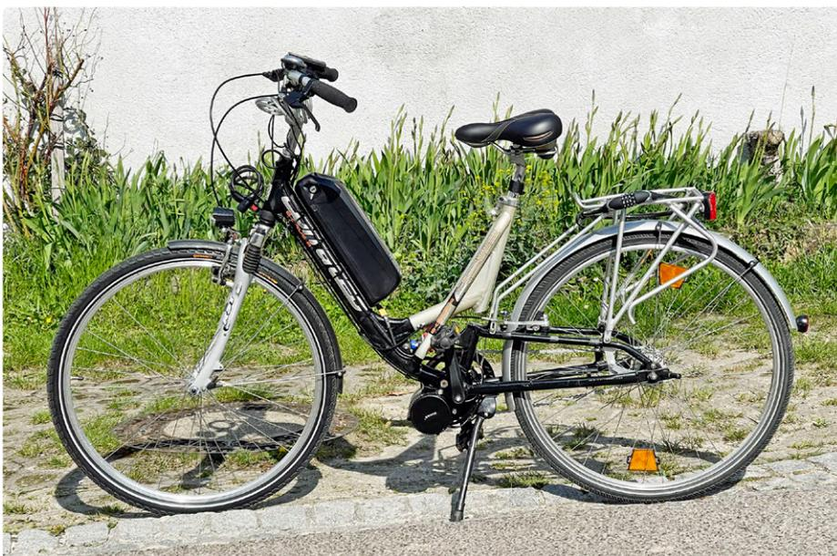
Bild 10. Nachher: Das aufgerüstete Elektrofahrrad, noch mit alter Siebengang-Nabenschaltung. Aber es fährt!
