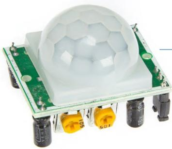
Bild 4. Das PIR-Sensormodul.
