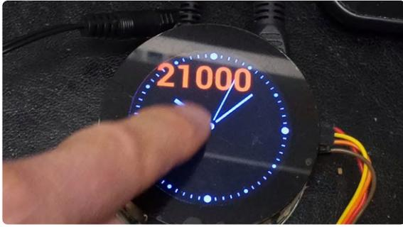
Bild 2. Der Zählwert des YouTube-Abonnentenzählers kann über die Touchfläche gezogen werden.
