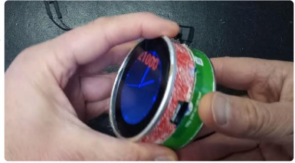
Bild 3. Das Display HyperPixel 2.1 Round hat den gleichen Durchmesser wie das Innere einer Pringles-Dose.
