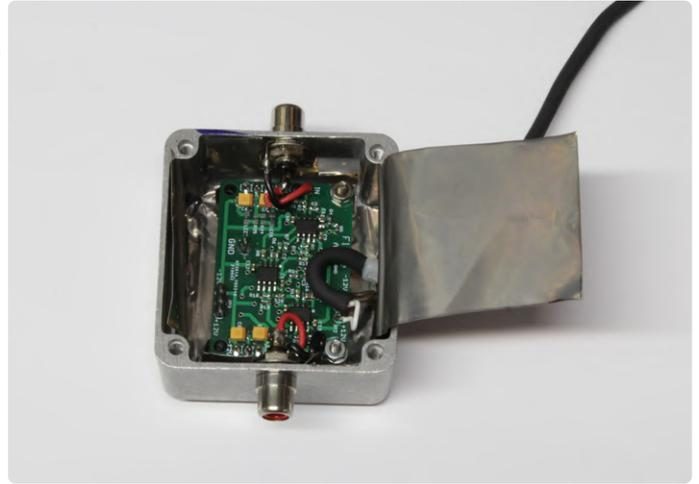
Bild 5. Platinen-Sandwich, eingebaut in ein Alu-Gehäuse.
