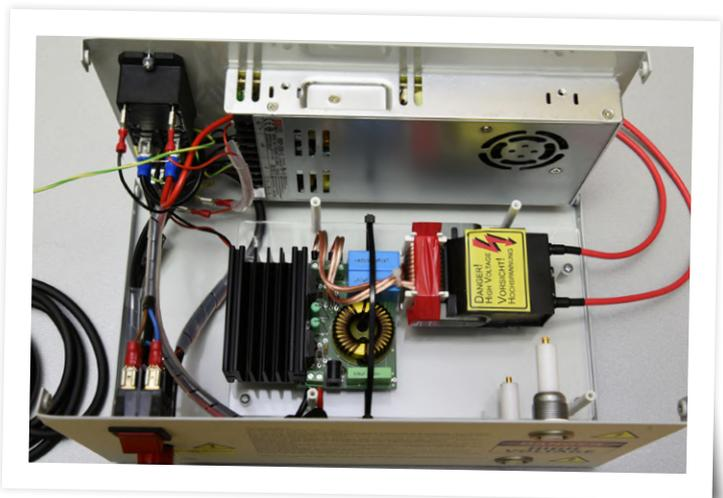
Bild 1: Lichtenberg-Generator (Foto: Ilse Joostens).
