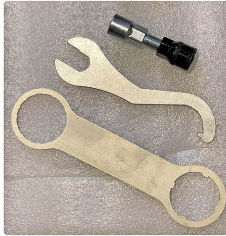
Bild 5. Der Kurbelabzieher oben und der Schlüssel unten waren im Lieferumfang enthalten, der Lockringschlüssel in der Mitte musste nachbestellt werden.
