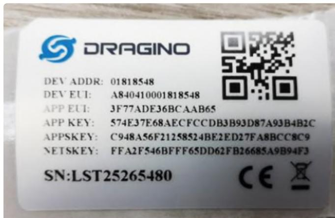
Bild 2. EUIs und Softwareschlüssel für den LHT65.
