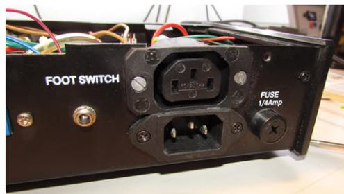
Bild 6. Der neue Netzanschluss des Kompressors.
