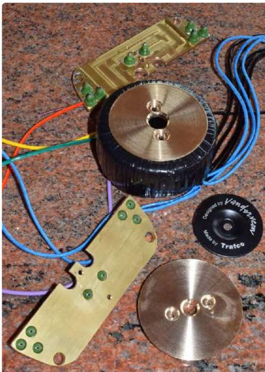
Bild 15. Ein runder Trafo für einen runden Verstärker. Auch hier ist extra Mechanik zur Befestigung erforderlich.
