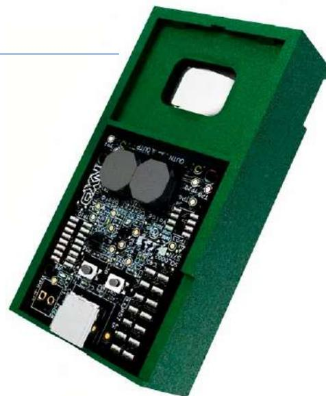
Bild 3. SLN-LOCAL2-IOT Offline-Sprachsteuerungslösung von NXP. (Quelle: NXP [10])
