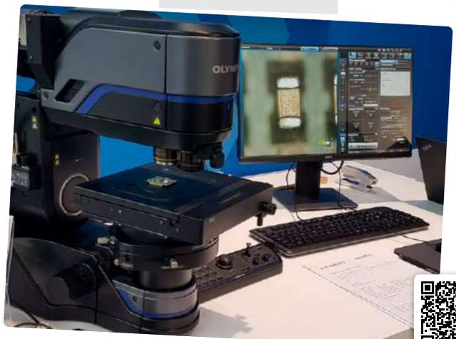
Digitale Mikroskope verdrängen mehr und mehr die Vertreter mit Okular. Sie sind bedienfreundlich auch für mikroskopie-ungeübtes Prüfpersonal und erlauben eine automatische Durchmusterung von Proben. Das hier gezeigte Exemplar von Olympus fertigt sogar 3D-Bilder an, die aus allen Perspektiven betrachtbar sind.
