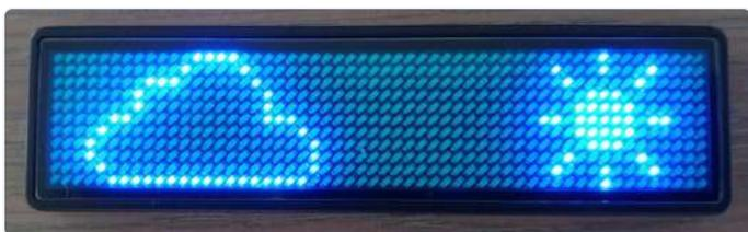
Bild 6. Wenn Sie die entsprechenden BLE-Befehle senden, können Sie Ihre eigenen 11 x 55 Pixel großen Bilder auf dem LED-Badge anzeigen.
