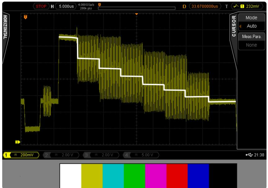
Bild 16. Oszillogramm eines PAL-Farbsignals.
