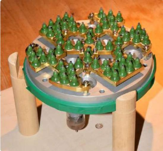
Bild 12. Die „Löt-Pads“ mit fast antiken, grünen Glasisolatoren.
