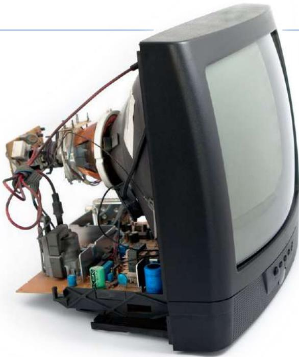
Bild 2. Geöffneter Fernseher mit Kathodenstrahlröhre (Quelle: Shutterstock / Sergio Sergio).
