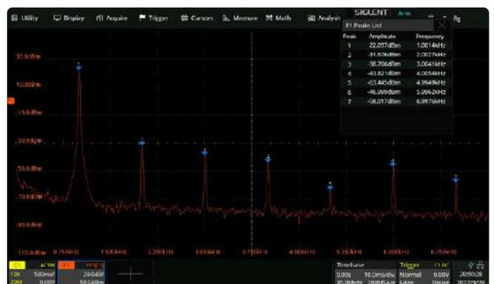
Bild 4. FFT-Spektrum des Ausgangssignals.
