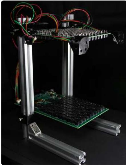
Bild 1. Zwei Arrays aus jeweils 100 Ultraschallwandlern werden verwendet, um einen kleinen Schaumstoffball in der Luft schweben zu lassen.
