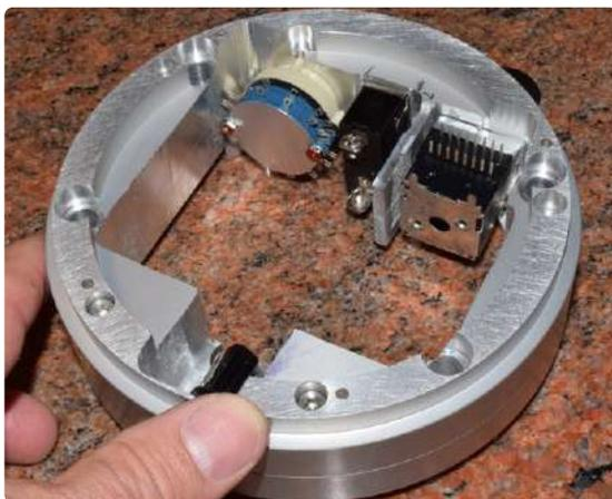
Bild 17. Der komplette Verstärker provisorisch zusammengebaut, noch ohne schützendes, röhrenförmiges Gehäuse.
