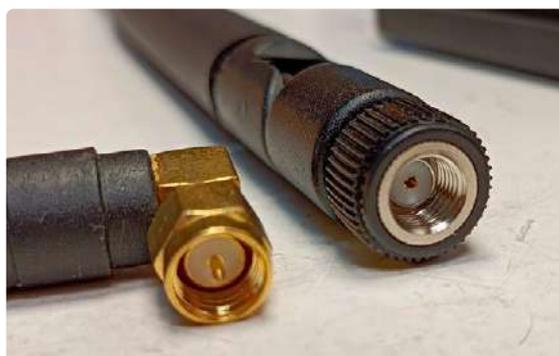
Bild 2. Antennen mit SMA-Anschlüssen. Links ist der richtige und rechts der falsche Anschluss für Opera Cake und HackRF One zu sehen.
