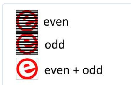
Bild 6. Bildaufbau mit zwei Halbbildern.
