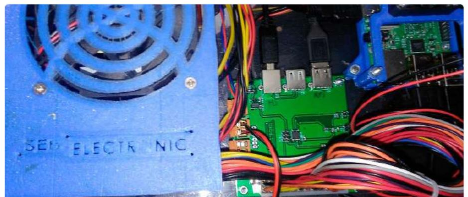
Bild 4. ATX-Netzteil, angeschlossen an die Platine.
