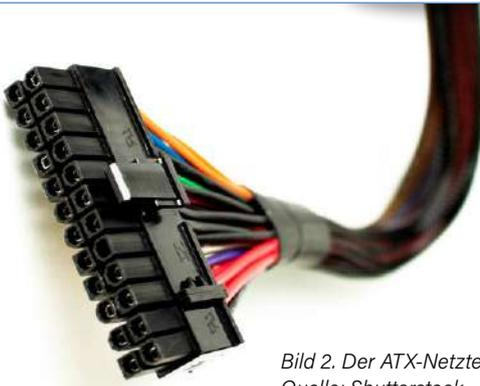
Bild 2. Der ATX-Netzteilstecker.
