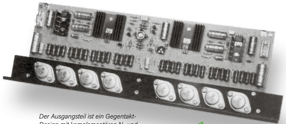
Der Ausgangsteil ist ein Gegentakt-Design mit komplementären N- und P-Kanal-Leistungs-MOSFETs, die für gutes Einschwingverhalten und Linearität bei allen möglichen Ansteuerungspegeln ausgewählt wurden.
