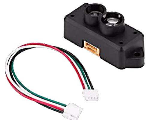
*Bild 1. Das kostengünstige LiDAR-Modul TFMMini-S hat eine Reichweite von 12 m und eine Auflösung von 1 cm.*
