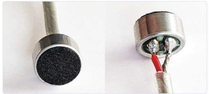
Bild 7. Eine kleine Elektret-Kapsel mit einer 5-mm-Membran.
