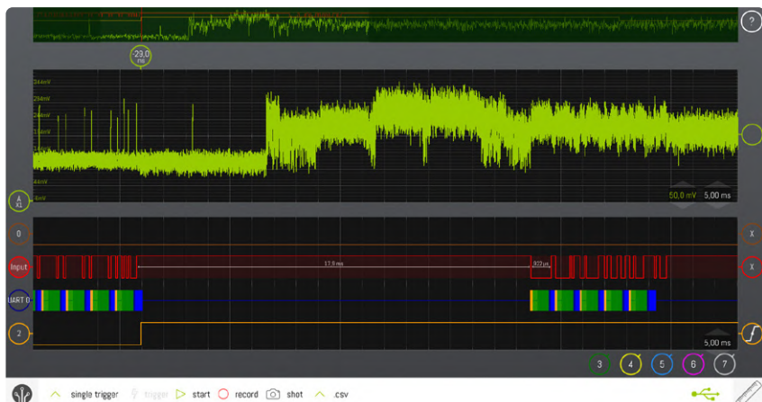
Bild 10. Versorgungsstrom einer Bankkarte bei der Überprüfung einer falschen PIN.
