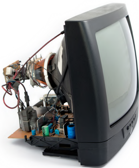
Bild 3. Geöffneter Fernseher mit Kathodenstrahlröhre (Bild: Shutterstock / Sergio Sergio).
