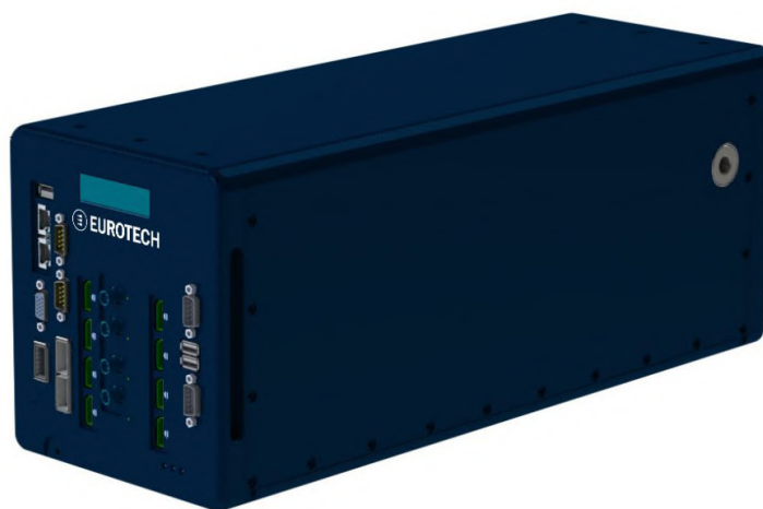
Bild 5. Die Entwicklung von KI-Algorithmen wird durch den Einsatz von Hochleistungsrechnern im Fahrzeug wie in diesem flüssigkeitsgekühlten DYNACOR 40-36 beschleunigt. (Quelle: Eurotech)
