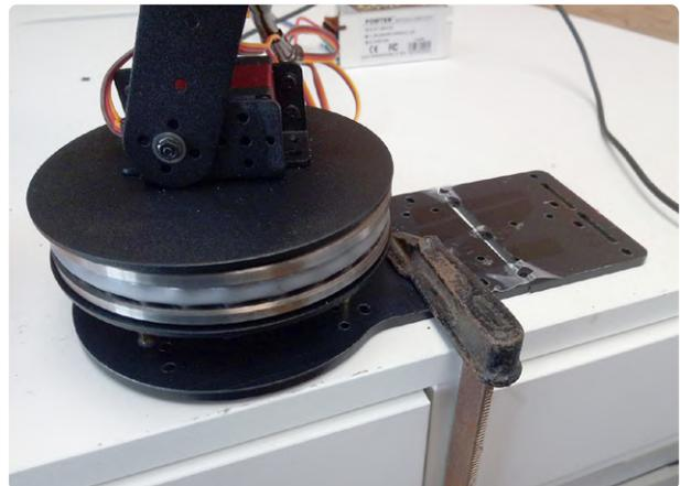
*Bild 6. Festklemmen des Roboterarms an der Werkbank sorgt für Sicherheit beim Experimentieren.*
