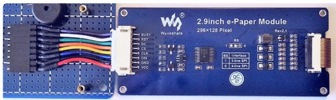
Bild 5. Das im Projekt verwendete e-Paper-Modul mit seinem „maßgeschneiderten“ Anschluss. (Quelle: Waveshare)
