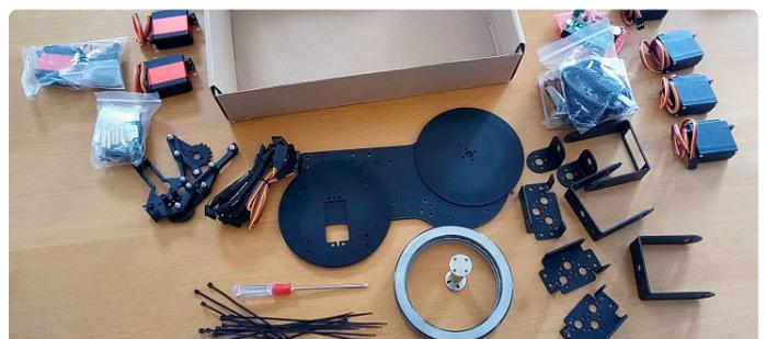
Bild 2. Der 6-DOF-Roboterarm wird als Bausatz geliefert.
