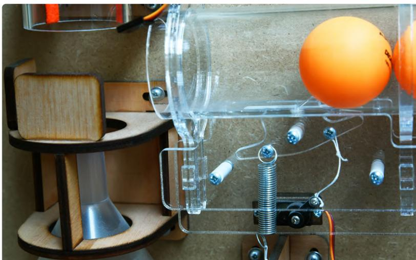
Bei jeder Hin- und Herbewegung der Nocke wird ein Tischtennisball freigegeben, während die übrigen Bälle automatisch blockiert werden. Die Nocke wird durch eine Zugfeder in einer Grundstellung gehalten und von einem Modellbau-Servo mithilfe einer Schnur bewegt (siehe **Bild 3**).
