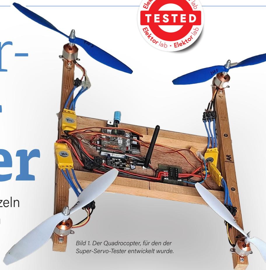
Bild 1. Der Quadcopter, für den der Super-Servo-Tester entwickelt wurde.
