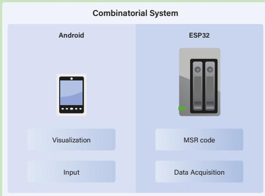
Bild 1. Das Android-Smartphone kümmert sich um das GUI, während der ESP32 für die Hardware-Kommunikation zuständig ist.
