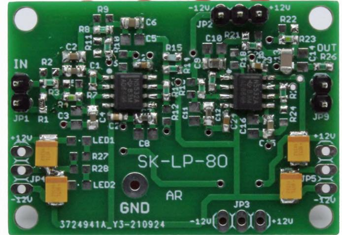
Bild 5. Fertig bestückter Tiefpass-Prototyp des Autors.
