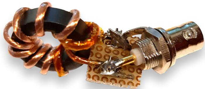
Bild 1. Nahaufnahme meiner HF-Stromsonde.
