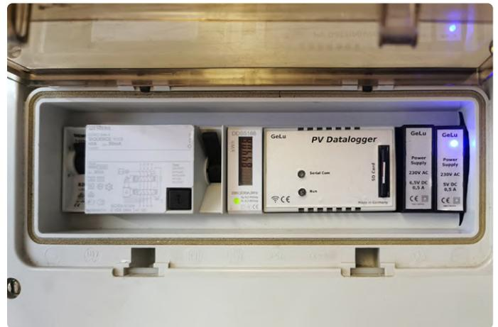
Bild 1. Der fertige Energielogger mit Zähler und Netzteil, eingebaut in einen kleinen Kunststoff-Verteiler.
