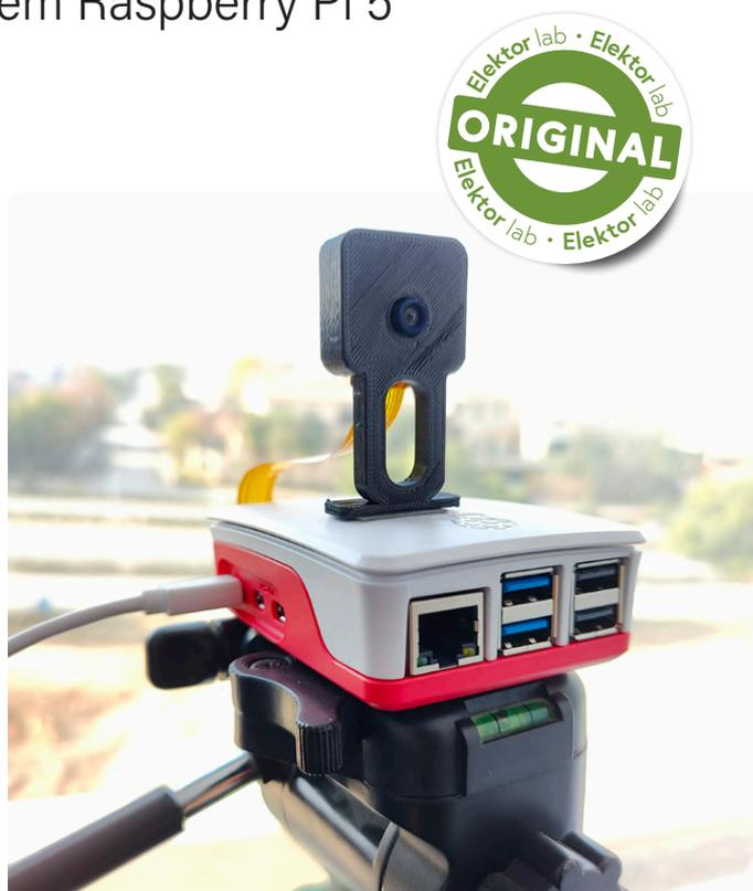
Bild 1. CaptureCount läuft auf einem Raspberry Pi 5 mit dem Camera Module 3 Wide von Raspberry Pi.
