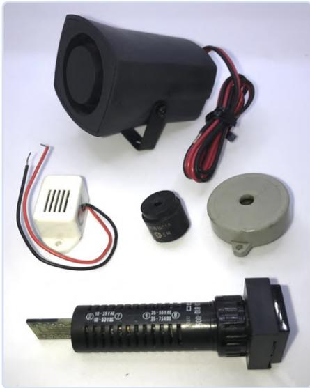
Bild 3. Eine Auswahl von Piezo-Summern (Piepser) mit Elektronik im Inneren, die das Element ansteuert. Hinten: Eine 12-V-Piezosirene, Mitte: drei verschiedene Piezo-Buzzer, vorne: Ein AC/DC-Multispannungs-Piezosummer für den Einsatz in industriellen Schalttafeln.
