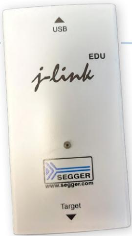
Bild 3. In vielen (aber nicht allen) Situationen ist ein JTAG- oder SWD-Programmier/Debug-Pod für die Zephyr-Experimente erforderlich.
