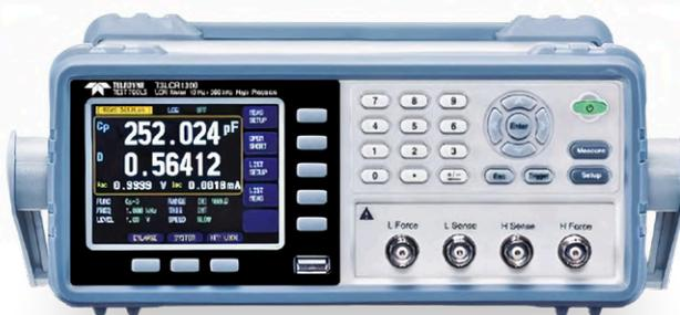
Bild 4. Im Entwicklungslabor kann der T3LCR von Teledyne LeCroy zur Charakterisierung von Bauteilen eingesetzt werden, während er in einer Produktionsumgebung für das Binning von Bauteilen verwendet werden kann.
