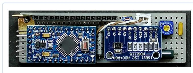
Bild 9. Die vollständig bestückte DVM-Platine.
