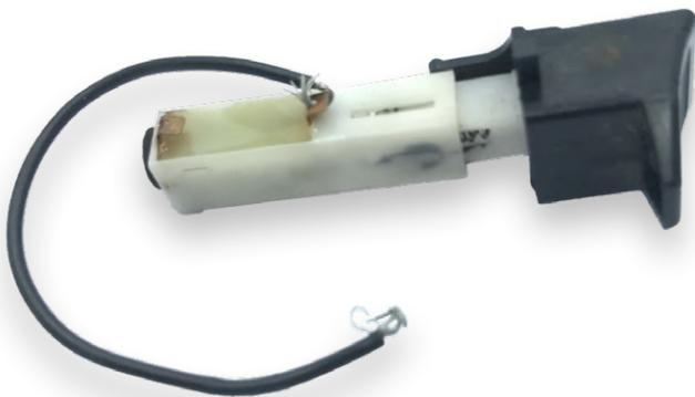
Bild 4. Ein Piezo-Zünder aus einem Gasfeuerzeug. Drückt man den Knopf am Ende, macht es „klick“ und es wird ein Hochspannungsimpuls erzeugt, der einen Funken zwischen zwei Elektroden schlägt.
