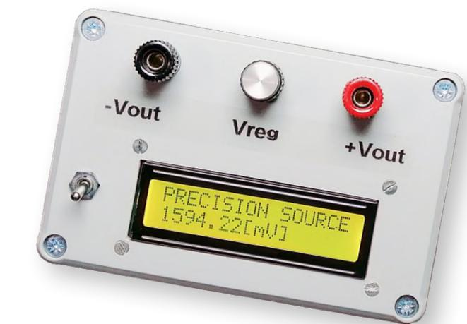
und führen eine lineare Regression durch, um die Steigung und den Achsenabschnitt abzuleiten. Wir benötigen diese Werte, um eine Ausgabe in Volt oder Millivolt zu erhalten. Dieses Projekt kombiniert die beiden benötigten Instrumente: einen sehr stabilen, rauscharmen Spannungsgenerator und ein extrem genaues Digitalvoltmeter mit einem Messbereich von 0...5 V und einer Auflösung von etwa 0,2 mV.
