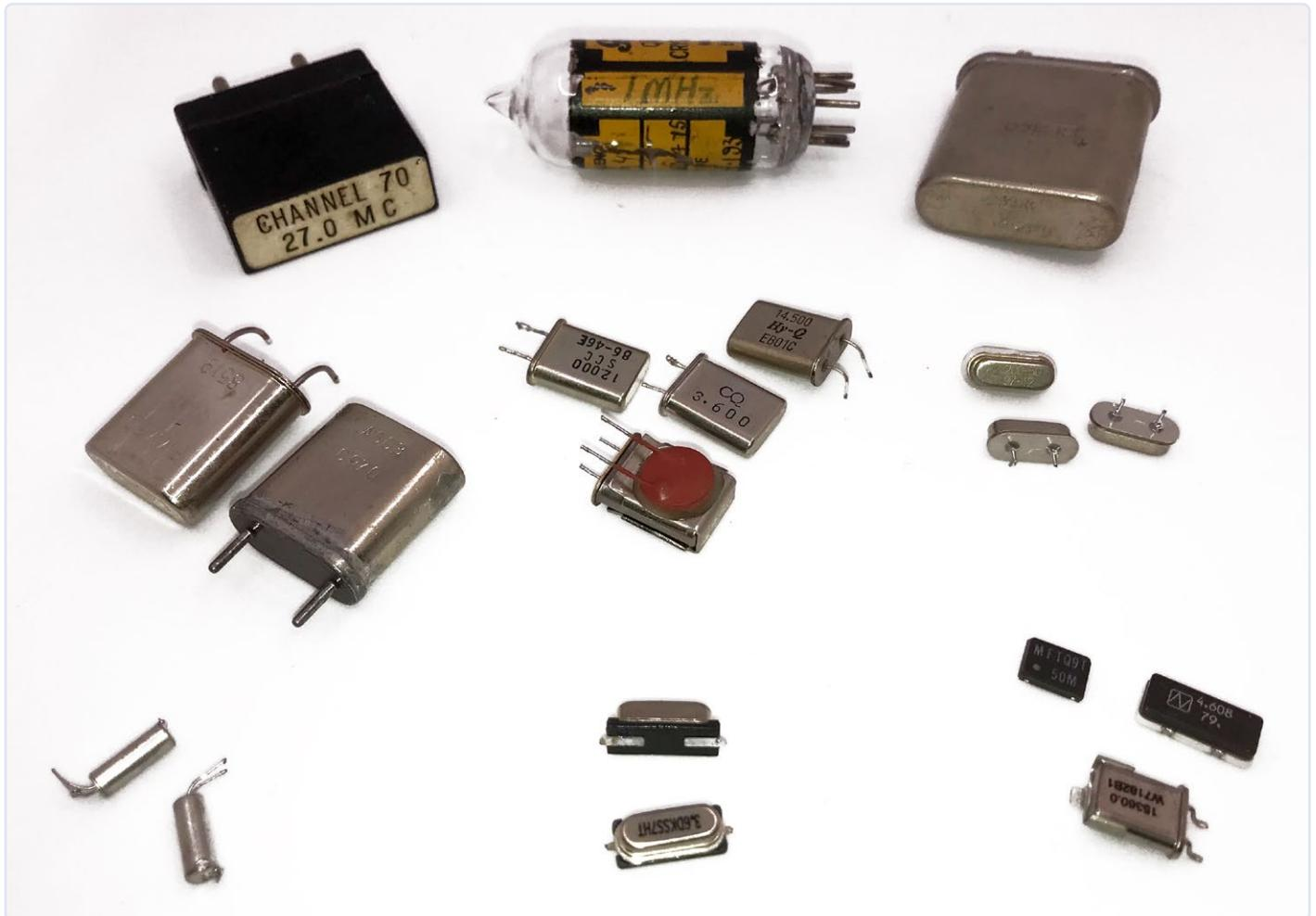
Bild 2. Verschiedene alte und moderne Quarze. Oben: ältere Typen. Mitte (von links nach rechts): HC6/U, HC49/U (einer mit einem roten PTC-Widerstand, der als Ofen dient) und HC49S mit Low-Profile-Typen. Unten (von links nach rechts): 32.768-Hz-Uhrenquarze, HC49SMD und andere oberflächenmontierbare Typen.
