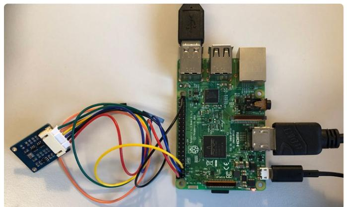
Bild 7. Versuchsaufbau von Raspberry Pi und Sensorplatine BME280.
