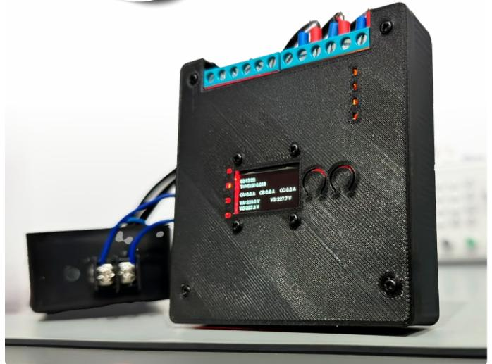
Bild 1. Das zusammengebaute ESP32-Energiemessgerät mit seinem OLED-Display und den Statusanzeigen.
