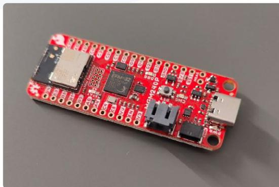
Bild 1. SparkFun-Board Thing Plus Matter MGM240P
