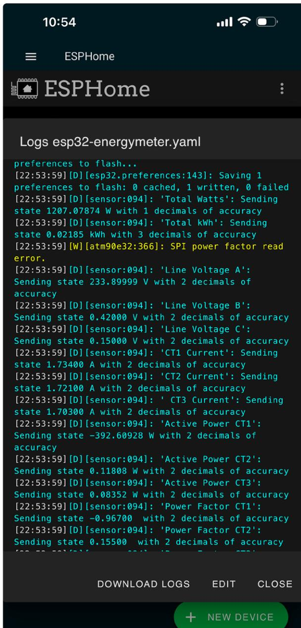
Bild 9. Die endgültigen Ergebnisse der Kalibrierung zeigen eine bessere Genauigkeit der Messung.
