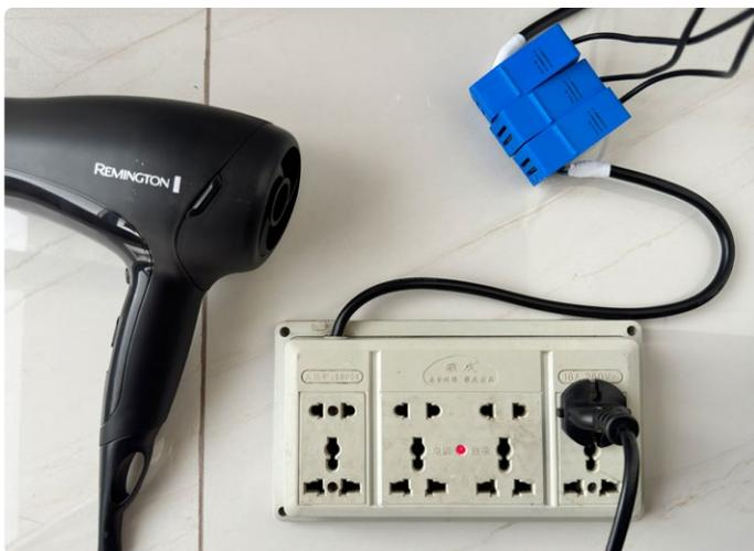
Bild 7. Aufbau zum Testen und Kalibrieren des ESP32-Energiemessgeräts mit einer variablen Last.
