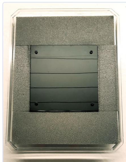
Bild 6. Schwarzes Kupferblech mit der Acrylplatte drum herum. Ich habe das Acrylglas mit einer weiteren Isolierung überzogen, um eine weiche Dichtung für die Glasglocke zu schaffen.
