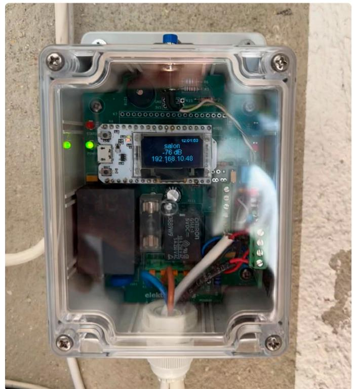
Bild 9: Die Platinenmontage in einem Gehäuse.
