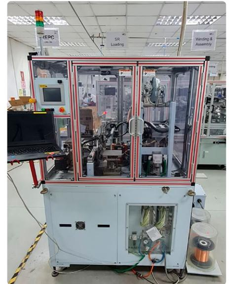
Bild 4. Maschine mit Schweißmodul für den Retrofit.
