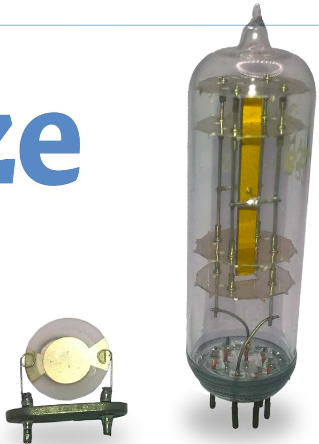
Bild 1. Ein kleiner Scheibenquarz mit einer Resonanzfrequenz von einigen Megahertz aus dem Jahre 1975 für die Platinenmontage, bei dem die Abdeckung entfernt wurde, und ein größerer Quarzblock (100 kHz) in einer Röhre von 1959.
