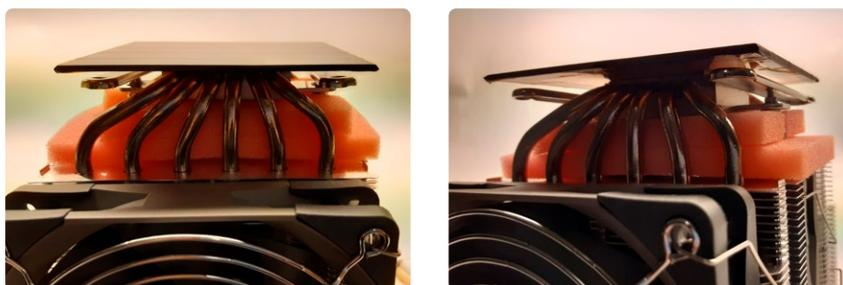
Bild 4. Kupferblech auf der Oberseite des CPU-Lüfters.
