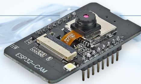
Bild 4. Die Plattform ESP32-CAM ist das Herzstück dieses Projekts.
