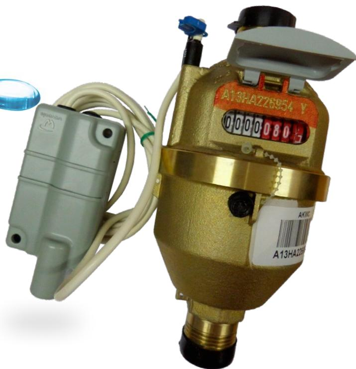
Bild 1. Mein Wasserverbrauchszähler mit angebaurem Durchflusssensor.
