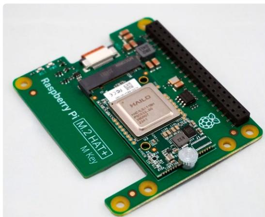
◀ Bild 2. Das Kit besteht aus dem Hailo-8L-Chip auf seiner Beschleunigerplatine im M.2-Format, die mit dem Raspberry Pi M.2-HAT+ verbunden ist.
