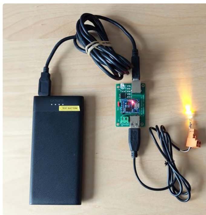
Bild 6. USB-Batterieschnittstelle in Aktion.
