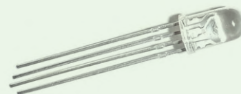
Bild 9. Eine RGB-LED ist transparent.
