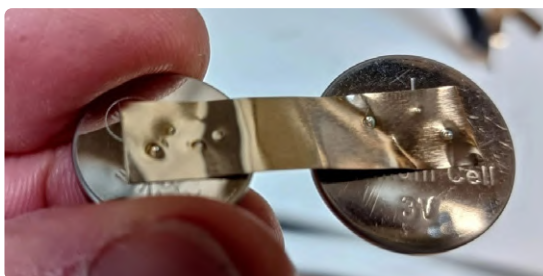
Bild 5. Schweißen des Nickelbands an eine Knopfzelle.
