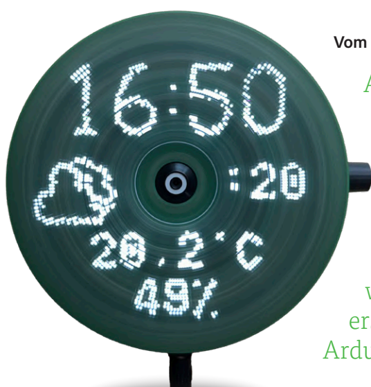
Bild 1. Rotierende LED-Anzeige von Zeit- und Wetterdaten.
