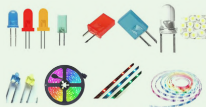
Bild 8. Verschiedene Arten von LEDs.
