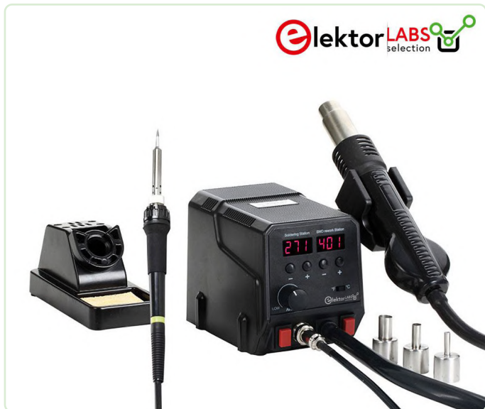
Bild 14. Eine kombinierte Lötstation zum Bestücken und Nachbearbeiten, die sowohl einen StiftlötKolben als auch eine Heißluftpistole für SMDs besitzt [8].
