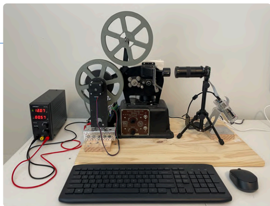
▲ Bild 3. Aufbau eines Film-Digitalisierers.
