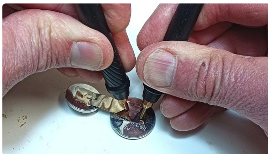
Bild 4. So funktioniert das Schweißen: Leicht drücken und ein paar Sekunden warten.
