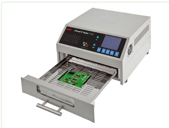
Bild 16. Der Infrarot-Reflow-Ofen T-962 mit besonderen Merkmalen, die exklusiv bei Elektor erhältlich sind [9].
