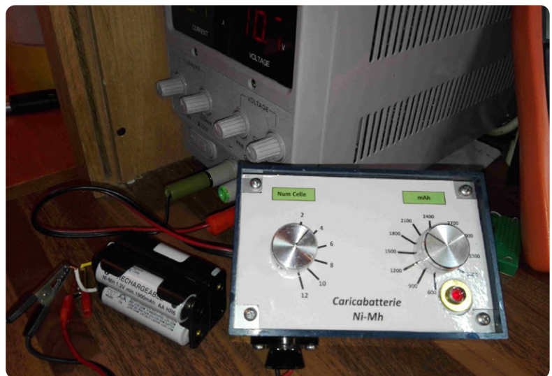
Bild 4. Das fertige Ladegerät bei der Arbeit mit einem vierzelligen Akkupack.
